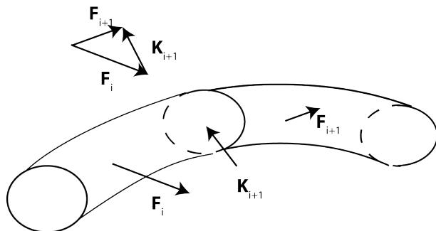
Slika 14: Podjela konture tankog štapa na segmente, odijeljene točkama u kojima lokalno djeluju vanjske sile.
