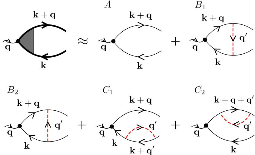
Slika 4.1: Dijagrami propagacije elektron-šupljina para u nultom redu, dijagram  $A$ , te u drugom redu elektron-fonon interakcije, dijagrami  $B_1$ ,  $B_2$ ,  $C_1$  i  $C_2$ . Dijagrami  $C_1$  i  $C_2$  opisuju doprinose povezane s vlastitom energijom elektrona i šupljine, dok dijagrami  $B_1$  i  $B_2$  opisuju renormalizaciju strujnog vrha.
