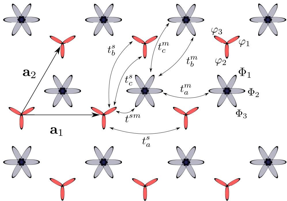
Slika 2.7: Shematski prikaz ravnine 2DMoS<sub>2</sub> s atomima molibdena (plavo) i molekulama sumpora (crveno). Na svakom objektu prikazani su i relevantni hibridi kao i pripadni matrični elementi preskoka elektrona među hibridnim orbitalama.
