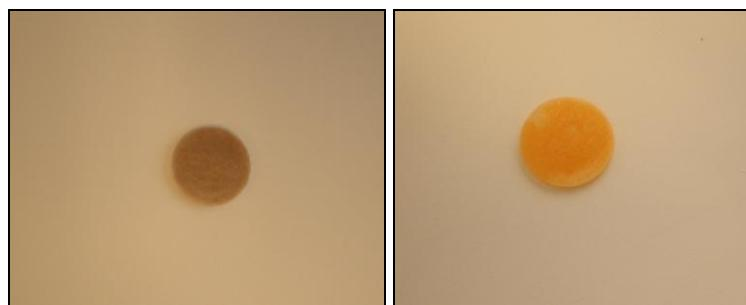
**Slika 87:** KBr pastila pripremljena iz taloga smjese spoja **1** i DDQ i spoja **2a** i DDQ
