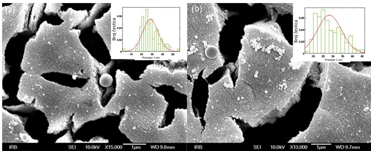
Slika 65 SEM slike uzoraka porognog Si nakon ablacija sa zlatom: a) uzorak #2 (povećanje 15 000x) i c) uzorak #3 (povećanje 13 000x) s odgovarajućim raspodjelama veličine čestica (umetci).
