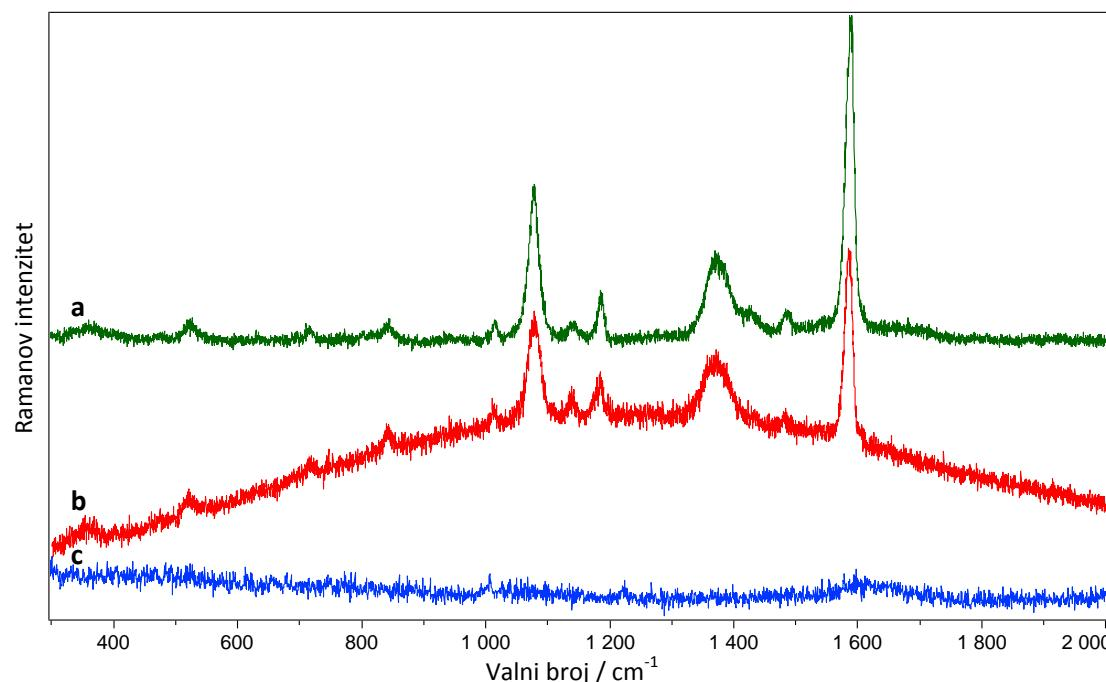
Slika P2 a) Ramanovi spektri AGF koloidne suspenzije prije i b) nakon ispiranja s etanolom; c) SERS spektar piridina (0,12 M) u zlatnom (AUC) koloidu ( $\lambda=514,5 \text{ nm}$ ).
