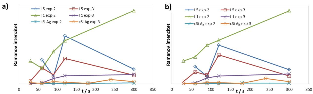
Slika 75 SERS intenzitet  $10^{-6}$  M R6G na mezoporoznom Si (1 i 5 mA  $\text{cm}^{-2}$ ) i kristalnom Si u ovisnosti o vremenu uranjanja u  $\text{AgNO}_3$  ( $10^{-2}$  i  $10^{-3}$  M): a) vrpca na  $1360 \text{ cm}^{-1}$  i b) vrpca na  $1648 \text{ cm}^{-1}$ .
