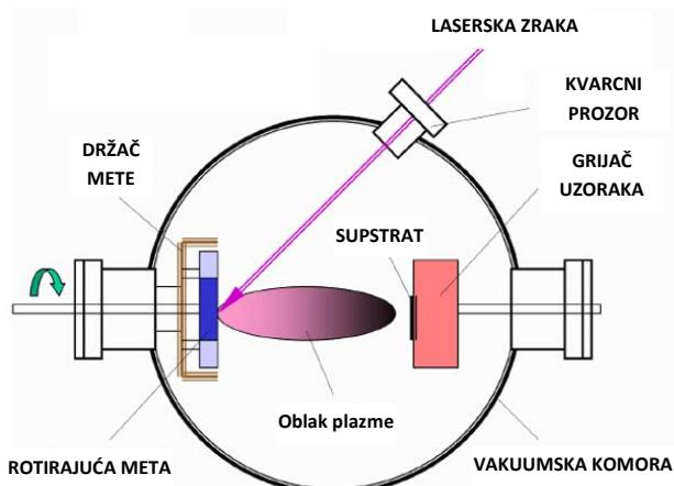
Slika 25 Shematski prikaz pulsne laserske depozicije.<sup>178</sup>
