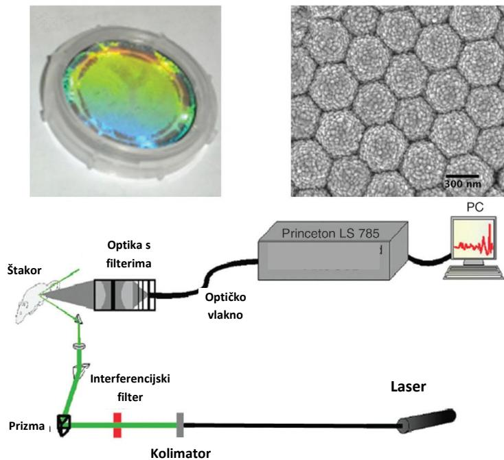
Slika 29 a) Ag film (200 nm) na 880 nm Si nanosferama (AgFON); b) SEM prikaz AgFON; c) shematski prikaz SESORS senzora.<sup>44</sup>
