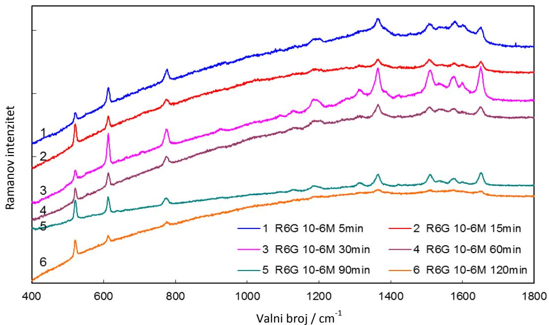
Slika P3 SERS spektri  $10^{-6}$  M R6G na makroporoznom Si (uzorak #2) za različita vremena inkubacije - 5, 15, 30, 60, 90 i 120 min (vrijeme se povećava odozgo prema dolje), ( $\lambda=514,5$  nm; 1 mW; vrijeme snimanja 10 s).
