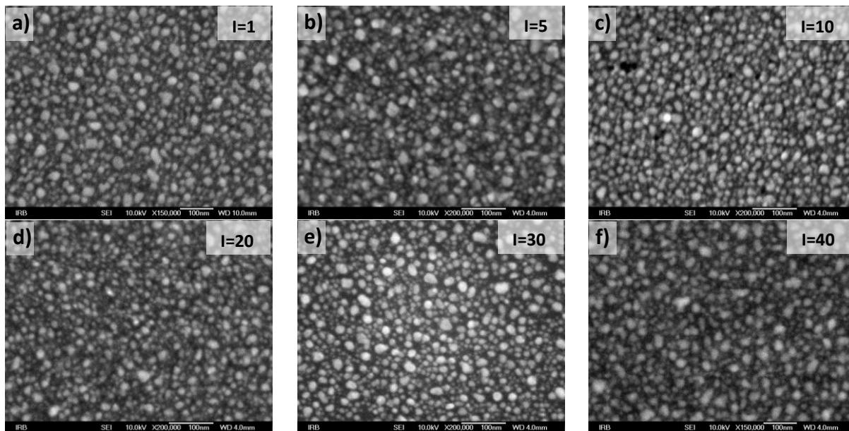
Slika 70 SEM slike Ag nanočestica dobivenih uranjanjem PSi 1 min u  $10^{-3}$  M  $\text{AgNO}_3$  (a i f povećanje 150 000x; b, c, d i e povećanje 200 000x).
