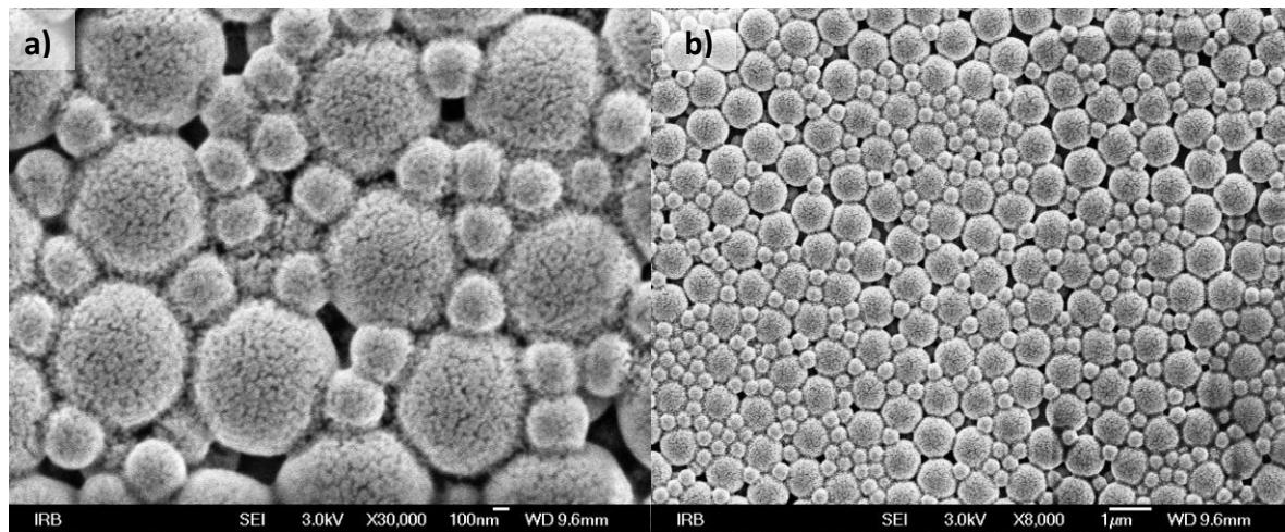
Slika 81 Polistirenske sfere veličine 1000 nm i 370 nm pomiješane zajedno, nakon depozicije 80 nm srebra: a) povećanje 30 000x, b) povećanje 8000x.
