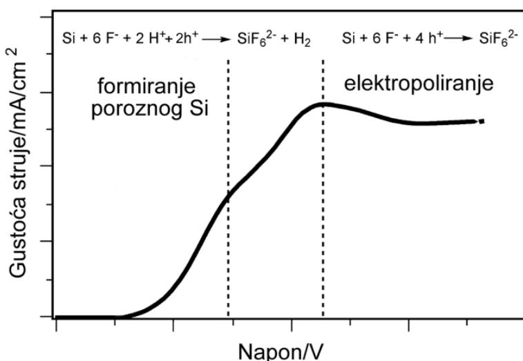
Slika 18 Ovisnost gustoće struje o potencijalu kod elektrokemijskog jetkanja silicija u HF elektrolitu na umjereno dopiranom p-tipu Si ( $\text{h}^+$  - šupljina u valentnoj Si vrpcu).<sup>154</sup>
