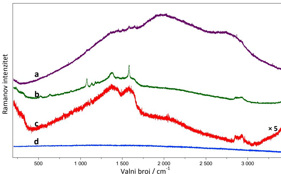
Slika 93 Spektri tekućine X: a, b i c – SERS spektri različitih koncentracija tekućine X i d – Ramanov spektar tekućine X ( $\lambda=514,5$  nm).
