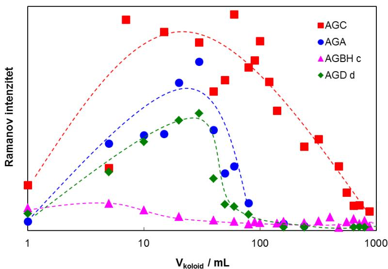
Slika 54 SERS intenziteti vrpce piridina na  $1008 \text{ cm}^{-1}$  kao funkcija volumena koloida u logaritamskoj skali od 1 do  $900 \mu\text{L}$ . Iscrtkane linije dodane su kao vizualna pomoć. Omjer agregirajućeg sredstva i koloida održavan je konstantnim tijekom eksperimenta.
