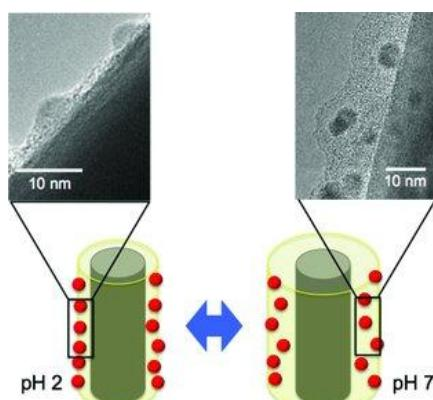
**Slika 31 Shematski prikaz promjene debljine polimera (PAA) pokrenute promjenom pH koja dovodi do različite udaljenosti među česticama.<sup>198</sup>**
