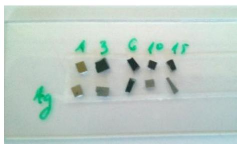
**Slika 47 Uzorci poroznog silicija (prvi red uzoraka bez deponiranog srebra i drugi red uzoraka s Ag) spremni za mjeru Ramanovom spektroskopijom.**
