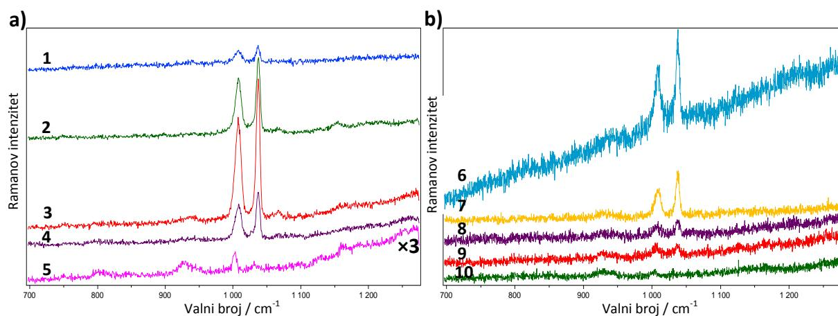
Slika 86 SERS spektri piridina: a) na uzorku 180 nm / 1000 nm: 1) 1,2 M, 2) 0,12 M, 3)  $1,2 \times 10^{-2}$  M, 4)  $1,2 \times 10^{-3}$  M i 5)  $1,2 \times 10^{-4}$  M i b) na uzorku 80 nm Ag / (350 nm + 1000 nm): 6) 1,2 M, 7) 0,12 M, 8)  $1,2 \times 10^{-2}$  M, 9)  $1,2 \times 10^{-3}$  M i 10)  $1,2 \times 10^{-4}$  M ( $\lambda=514,5$  nm; 0,5 mW; 10 s; 50 x).
