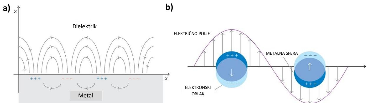
**Slika 3 Shematski prikaz a) površinske plazmonske rezonancije i b) lokalizirane površinske plazmonske rezonancije koja je rezultat kolektivnih oscilacija delokaliziranih elektrona uslijed djelovanja vanjskog električnog polja.<sup>37</sup>**
