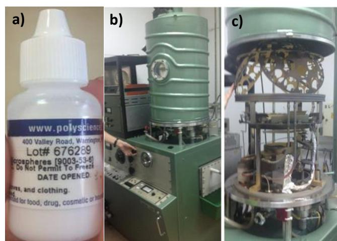
**Slika 44 a) Komercijalna suspenzija mikrosfera; b) i c) evaporator za depoziciju filmova srebra i zlata.**
