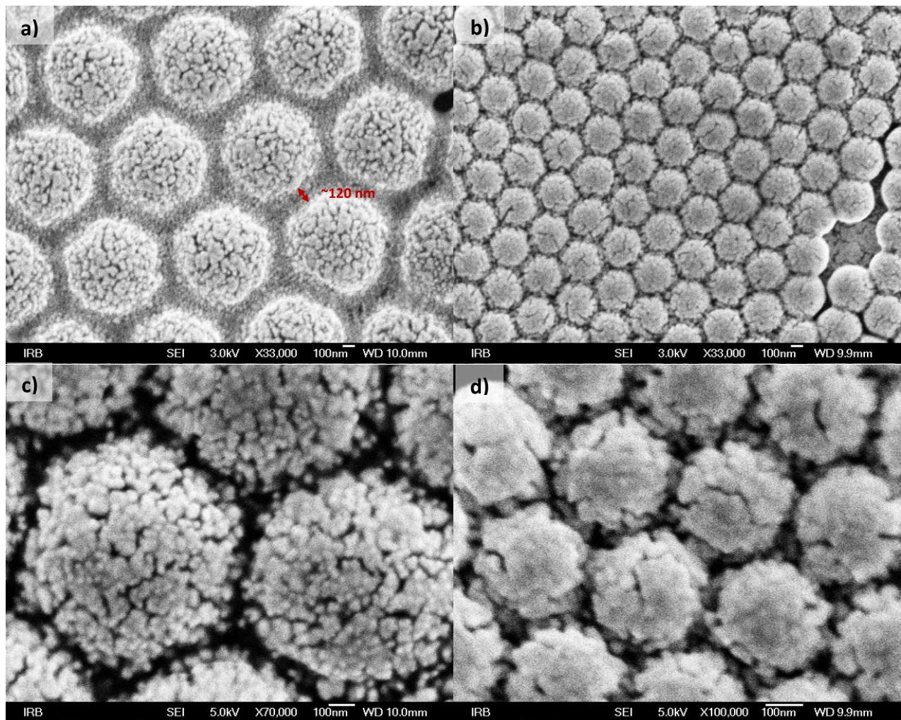
**Slika 79** SEM slike polistirenskih sfera: a) sfere 1000 nm sa 180 nm srebra (povećanje 33 000×), b) sfere 370 nm sa 80 nm srebra (povećanje 33 000×), c) sfere 1000 nm sa 180 nm srebra (povećanje 70 000×) i d) sfere 370 nm sa 80 nm srebra (povećanje 100 000×). Na slici se vidi organizacija sfera u heksagonsku gusto slagalinu.
