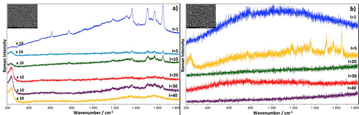
Slika 74 SERS spektri  $10^{-8}$  M rodamina 6G na mezoporoznom Si: a) Ag deponiran 1 min uranjanjem u  $10^{-2}$  M  $\text{AgNO}_3$  i b) Ag deponiran 1 min uranjanjem u  $10^{-3}$  M  $\text{AgNO}_3$  ( $\lambda=514,5 \text{ nm}$ ).
