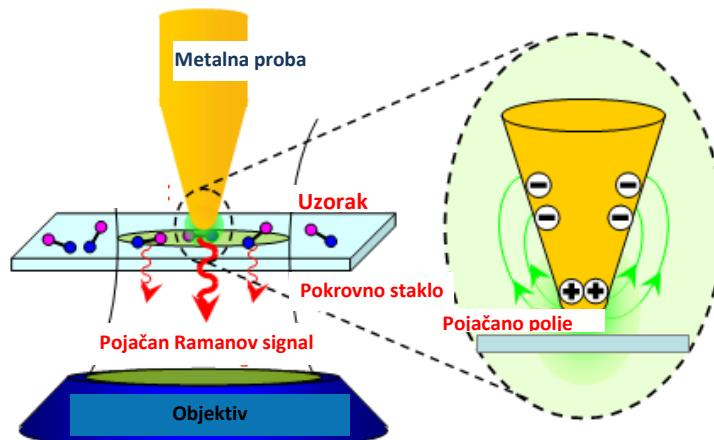
Slika 32 Prikaz vrhom pojačane Ramanove spektroskopije (TERS).<sup>213</sup> Snažno polje stvara se na oštrom metalnom vrhu.
