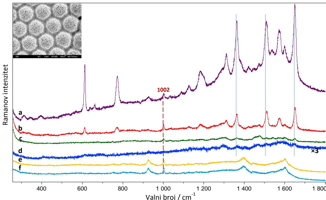
Slika 83 SERS spektri R6G na uzorku 180 nm / 1000 nm: a)  $10^{-6}\text{ M}$ , b)  $10^{-8}\text{ M}$  i c)  $10^{-9}\text{ M}$ , d)  $10^{-6}\text{ M}$  na uzorku s Ag bez sfera i Ramanovi spektri e) monosloja mikrosfera ( $1\text{ }\mu\text{m}$ ) i f) 180 nm Ag na sferama 1000 nm ( $\lambda=514,5\text{ nm}$ ;  $0,5\text{ mW}$ ; vrijeme snimanja 30 s; objektiv 100 x).
