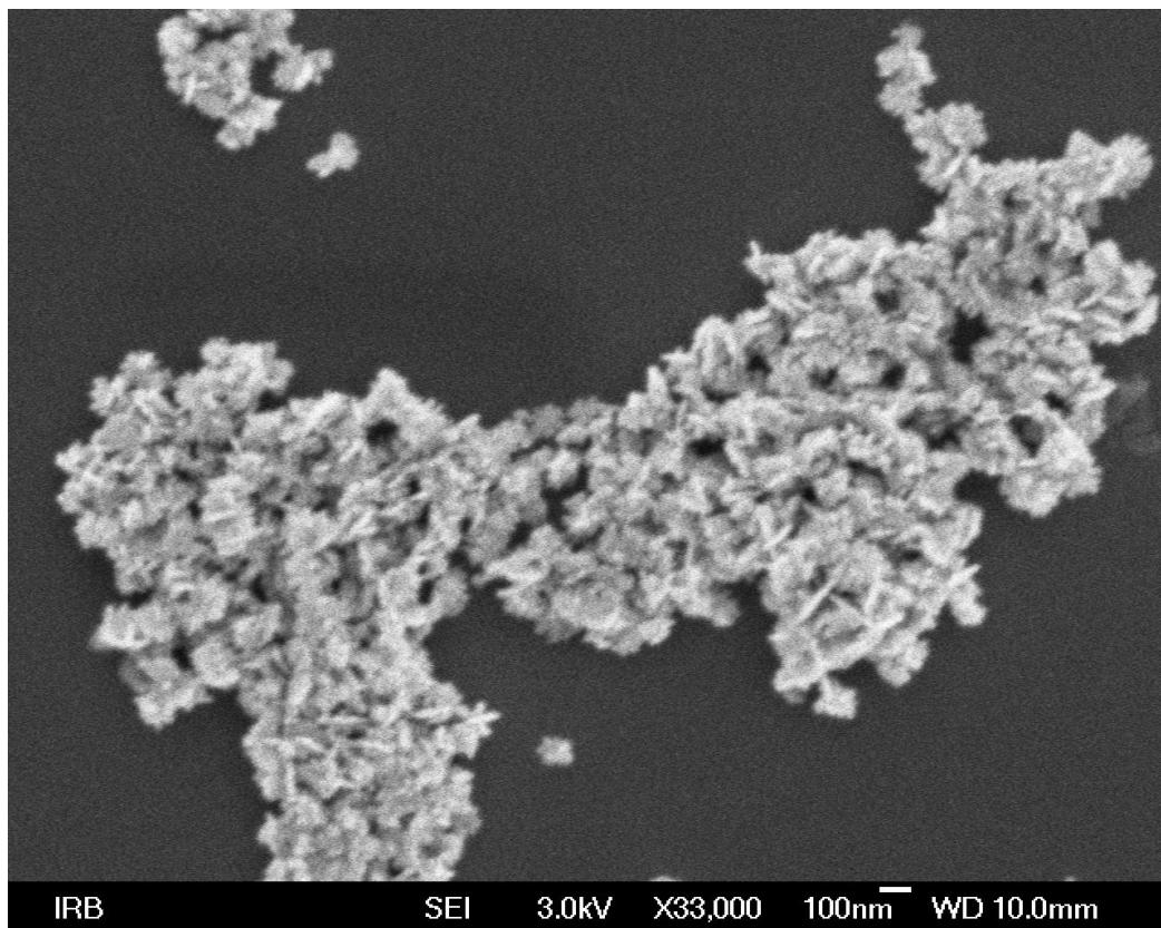
Slika 48 SEM slika AGF koloida (povećanje 33 000×).
