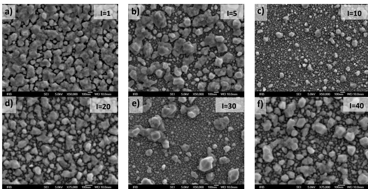
Slika 71 SEM slike Ag nanočestica dobivenih uranjanjem PSi 1 min u  $10^{-2}$  M  $\text{AgNO}_3$  (a, b, c i e povećanje 50 000x; d i f povećanje 75 000x).
