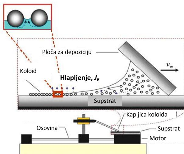
Slika 16 Shematski prikaz konveksnog samouređivanja (samoudruživanja).<sup>116</sup>
