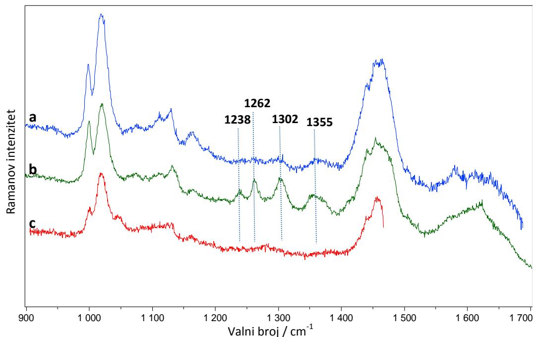
**Slika 92 SERS spektar AFB1 u AGC koloidu: a)  $6 \times 10^{-3} \text{ M}$ , b)  $6 \times 10^{-4} \text{ M}$  i c) metanol u AGC koloidu (514,5 nm; vrijeme snimanja 120 s).**
