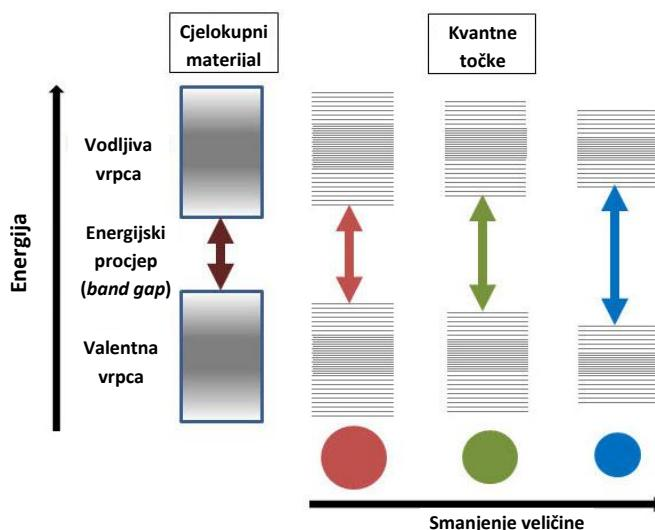
Slika 10 Podjela energetskih nivoa kod kvantnih točaka uslijed efekta kvantnog zatočenja; poluvodički energijski procjep se povećava sa smanjenjem veličine nanokristala.<sup>58</sup>
