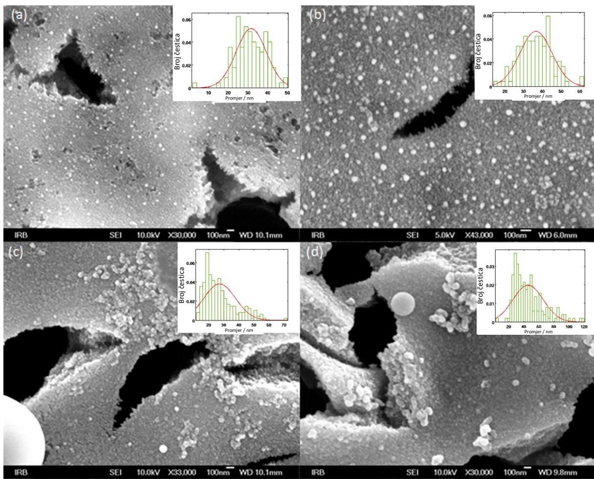
Slika 64 SEM slike PSI uzoraka nakon ablacija srebrrom: a) 30 000 pulseva, uzorak #1 (povećanje 30 000x), b) 30 000 pulseva, uzorak #2 (povećanje 43 000x), c) 45 000 pulseva, uzorak #2 (povećanje 33 000x) i d) 45 000 pulseva, uzorak #3 (povećanje 30 000x) s odgovarajućim raspodjelama veličine čestica (umetci).
