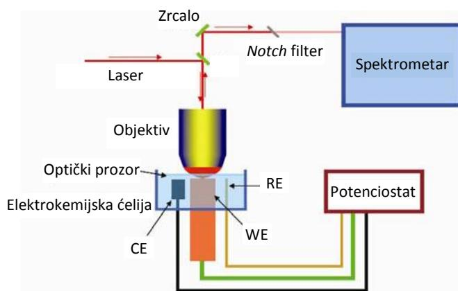
**Slika 6 Shema elektrokemijske čelije s potenciostatom za in situ SERS: RE – referentna elektroda, WE – radna elektroda, CE – protuelektroda.<sup>51</sup>**
