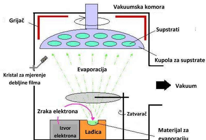
Slika 24 Shematski prikaz *e-beam* evaporacije. Metal za depoziciju stavlja se u lađicu (engl. *crucible*), filament se zagrijava, a korištenjem magnetskog polja e<sup>-</sup> se usmjeravaju na supstrat.<sup>176</sup>
