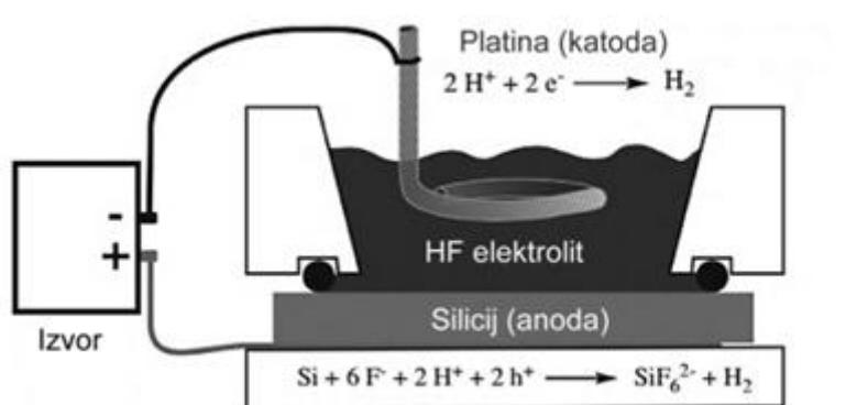
Slika 17 Shematski prikaz elektrokemijske ćelije za pripremu porognog Si.<sup>151</sup>
