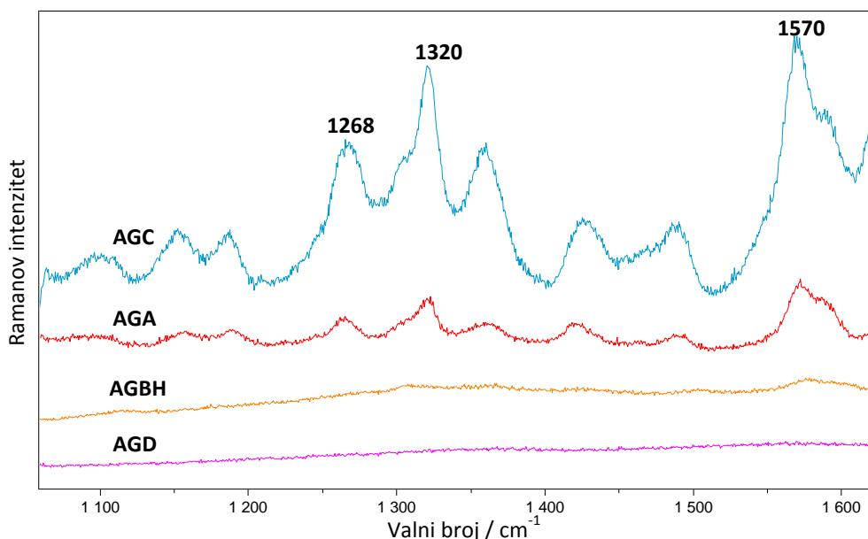
**Slika 89 SERS spektri histamina ( $10^{-3}$  M) u području  $1050$  do  $1650\text{ cm}^{-1}$  u različitim koloidnim suspenzijama ( $\lambda=514,5\text{ nm}$ ).**
