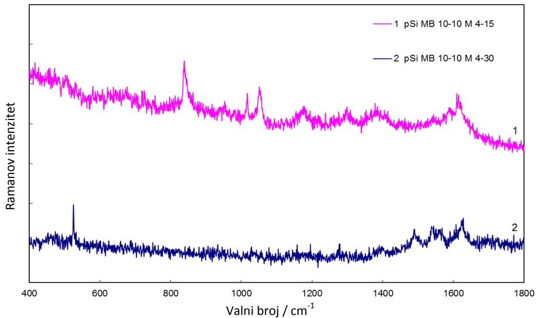
Slika P5 SERS spektri  $10^{-10}$  M MB na makroporoznom Si nakon ablacija srebrom (45 000 pulseva):
