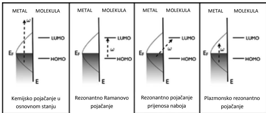
Slika 4 Shematski prikaz različitih mehanizama pojačanja u SERS-u.<sup>39</sup>
