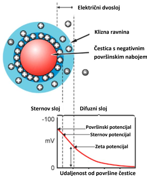
Slika 8 Shematski prikaz električnog dvosloja na površini nanočestice.<sup>57</sup>
