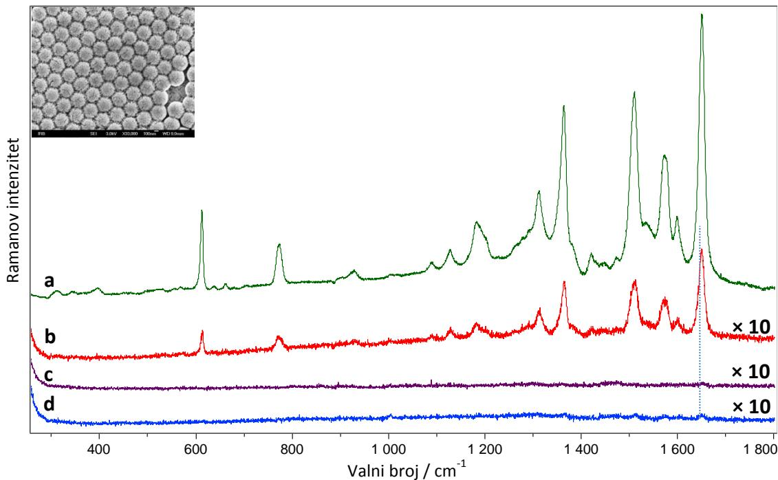
Slika 84 SERS spektri R6G na uzorku 80 nm / 350 nm: a)  $10^{-6}$  M, b)  $10^{-8}$  M, c)  $10^{-9}$  M i d) R6G  $10^{-5}$  M na uzorku s Ag bez sfera ( $\lambda=514,5$  nm; 0,5 mW; vrijeme snimanja 30 s; 100 x).
