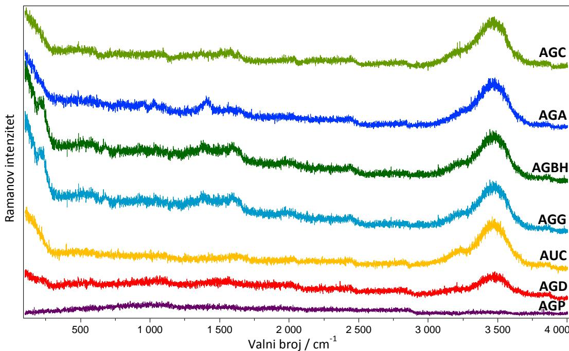
Slika P1 Ramanovi spektri koloidnih suspenzija ( $\lambda=514,5 \text{ nm}$ ); vrijeme snimanja 30 s osim AGP - 3s i AGG - 0,3 s).
