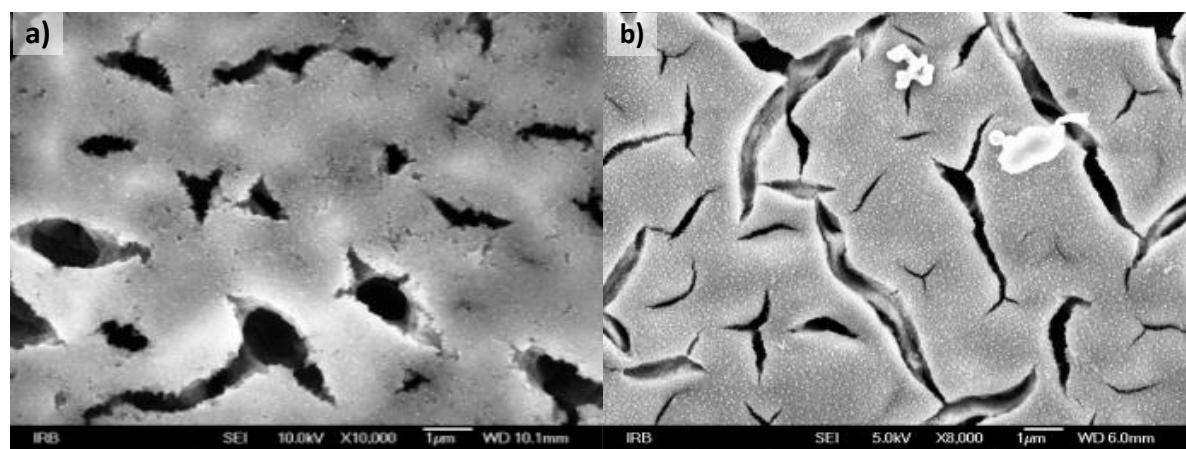
Slika P4 SEM slike porognog Si nakon ablacija s Ag (30 000 pulseva): a) uzorak #1 (povećanje 10000×) i b) uzorak #2 (povećanje 8000×).
