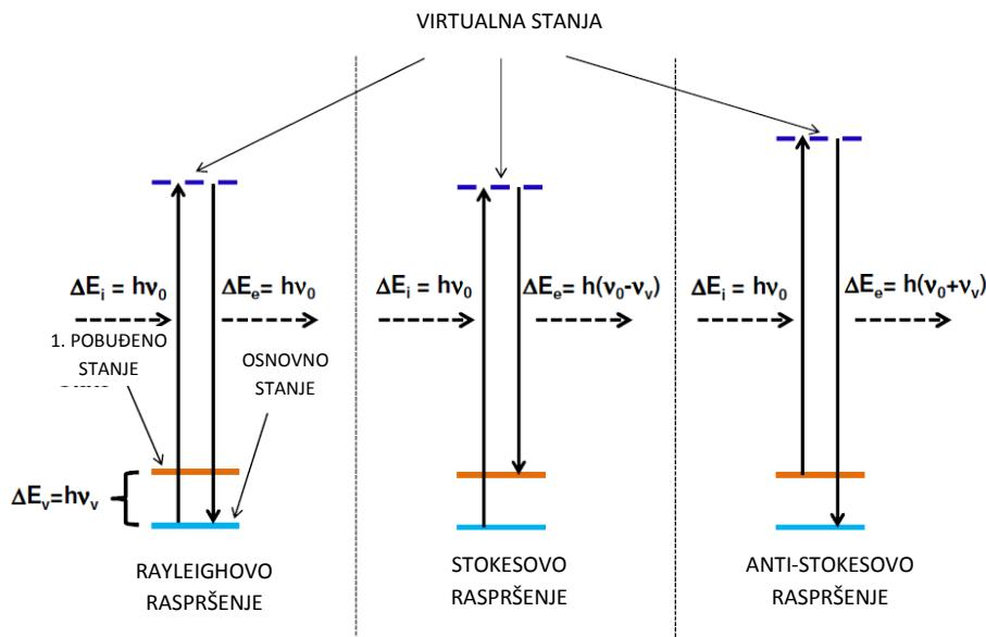
Slika 1 Shematski prikaz tri tipa raspršenja svjetlosti na molekuli pobuđenoj fotonom.  $\Delta E_i$ ,  $\Delta E_e$  i  $\Delta E_v$  su redom energija upadnog fotona, raspršenog fotona i vibracijska energija molekule.<sup>14</sup>
