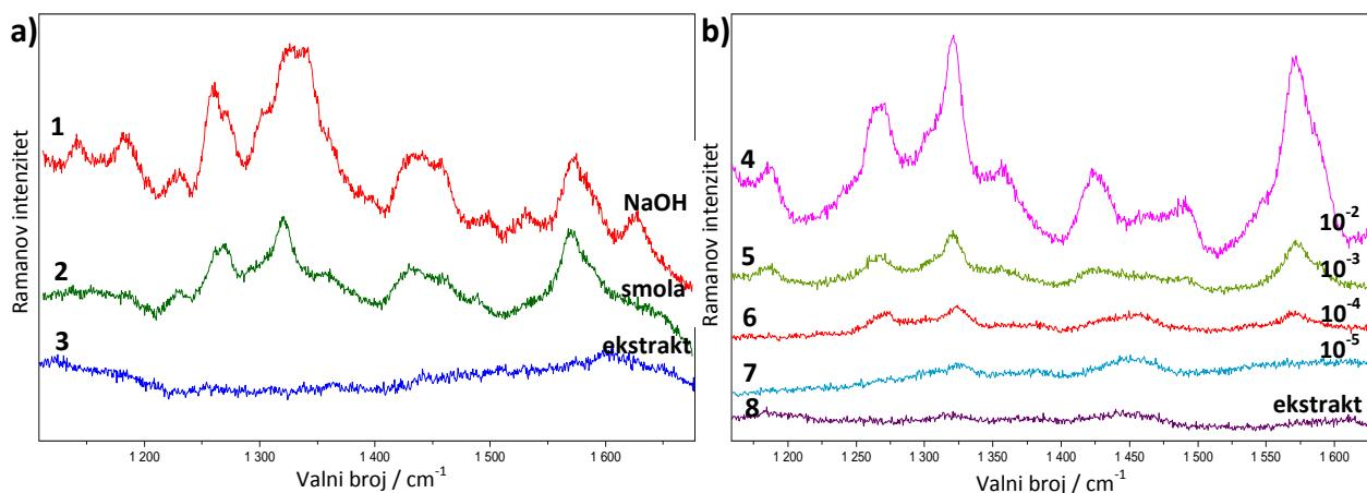
**Slika 91 SERS spektri:** a)  $10^{-3}$  mol L<sup>-1</sup> histamina u ribljem ekstraktu u AGC koloidu: 1) ekstrakt tretiran s NaOH, 2) ekstrakt tretiran sa smolom za anionsku izmjenu i 3) ekstrakt bez tretmana i b) histamina u ribljem ekstraktu nakon obrade smolom za anionsku izmjenu: 4)  $10^{-2}$  M, 5)  $10^{-3}$  M, 6)  $10^{-4}$  M, 7)  $10^{-5}$  M i 8) ekstrakt (514,5 nm).
