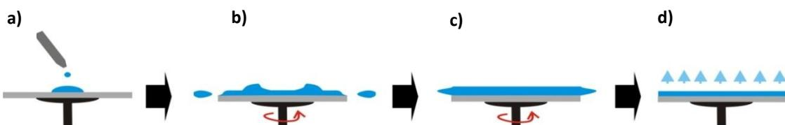
**Slika 26 Princip depozicije vrtnjom: a) postavljanje uzorka, b) ubrzavanje, c) konstantna vrtnja i d) isparavanje otapala (sušenje).**
