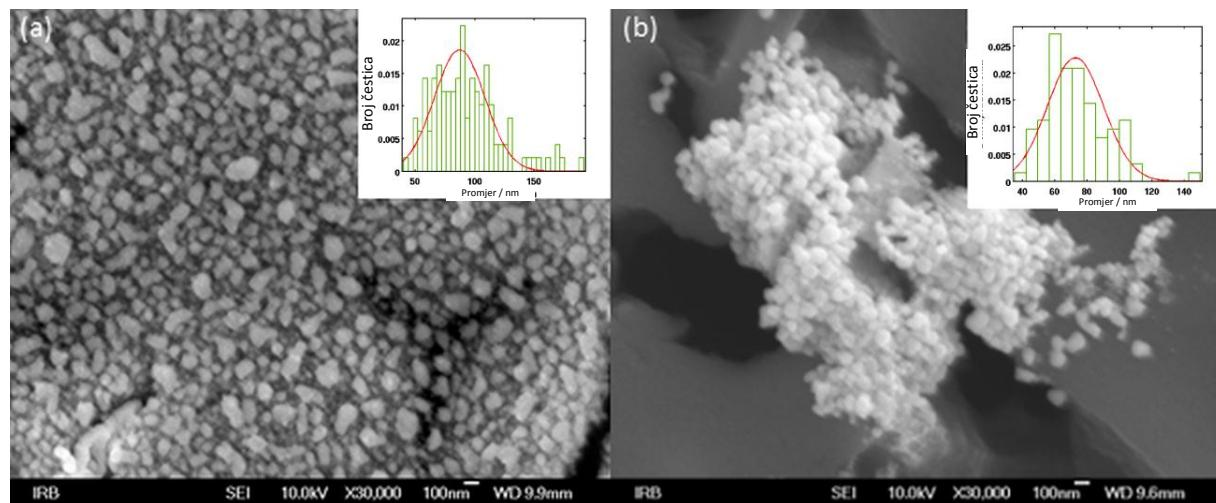
**Slika 63 SEM mikrografije srebrnih nanostruktura deponiranih na PSi (uzorak #2) a) iz 0,01 M  $\text{AgNO}_3$  otopine kroz dvije minute i b) kapanjem srebrovog koloida (povećanje 30 000×); raspodjelje veličine čestica prikazane su kao umetnute slike.**
