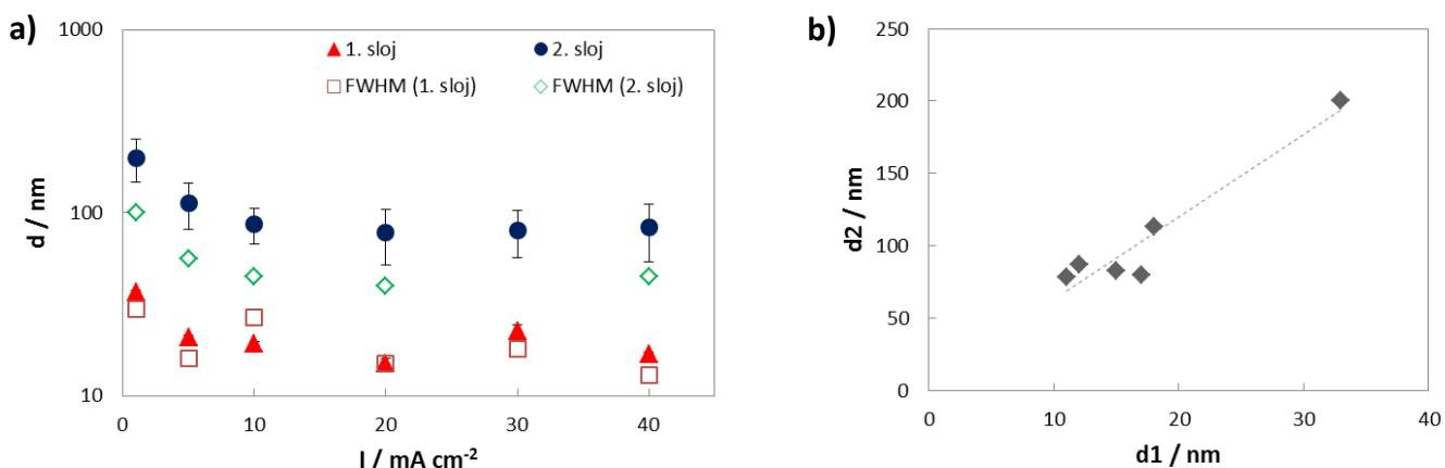
**Slika 72 a)** promjer Ag čestica (za oba sloja) formiranih 1 min uranjanjem u  $10^{-2}$  M  $\text{AgNO}_3$  u ovisnosti o struci jetkanja i **b)** promjer Ag agregata u drugom sloju u odnosu na promjer Ag čestica u prvom sloju.
