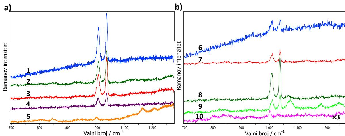
Slika 87 SERS spektri piridina a) na uzorku 80 nm / 350 nm: 1) 1,2 M, 2) 0,12 M, 3) 1,2 × 10<sup>-2</sup> M, 4) 1,2 × 10<sup>-3</sup> M, 5) 1,2 × 10<sup>-4</sup> M i b) na uzorku 160 nm / 350 nm: 6) 1,2 M, 7) 0,12 M, 8) 1,2 × 10<sup>-2</sup> M, 9) 1,2 × 10<sup>-3</sup> M i 10) 1,2 × 10<sup>-4</sup> M ( $\lambda=514,5$ ; 0,5 mW; vrijeme snimanja 10 s; 50 x).
