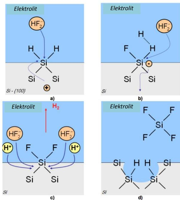
**Slika 20** Shematski prikaz elektrokemijskih reakcija u procesu nastajanja poroznog Si u otopini fluoridnih iona.<sup>151</sup>
