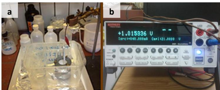
**Slika 42 a) Ćelija za elektrokemijsko jetkanje u plastičnoj posudi i b) uređaj Keithley za kontrolu struje i naponu prilikom elektrokemijskog jetkanja.**
