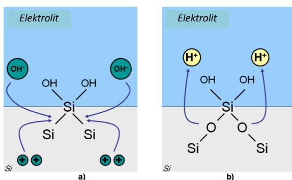
**Slika 21** Shematski prikaz elektrokemijskih reakcija kod nastajanja PSi (jača struja ili manja koncentracija  $\text{F}^-$ ).<sup>151</sup>
