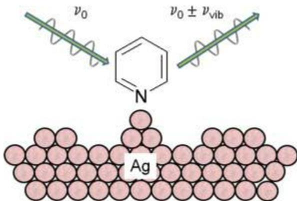
**Slika 2** Shematski prikaz SERS efekta s molekulom piridina adsorbiranim na srebro. Vidi se upadna laserska zraka i Ramanovo raspršenje te promjena njihovih intenziteta zbog pojačanog polja na Ag površini uslijed površinskih plazmonske pobuda.<sup>25</sup>
