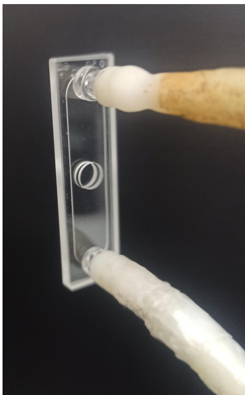
Slika 3.5: Protočna kiveta optičkog puta 0.5mm korištena u mjerenjima.
