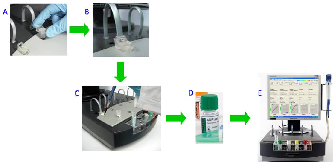
**Slika 8.** Provđenja agregacijskog testa. A –postavljanje kiveta s magnetskim mješačem u inkubacijski blok Multiplate® analizatora, B –spajanje mjernih elektroda na instrument, C – dodavanje krvi i reagensa, D –inicijacija agregacije dodatkom induktora, E –iskazivanje rezultata (površina ispod krivulje).
