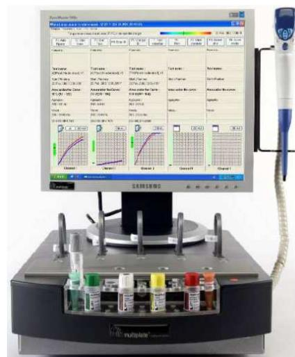
**Slika 6.** Multiplate® uređaj za praćenje agregacije trombocita.
