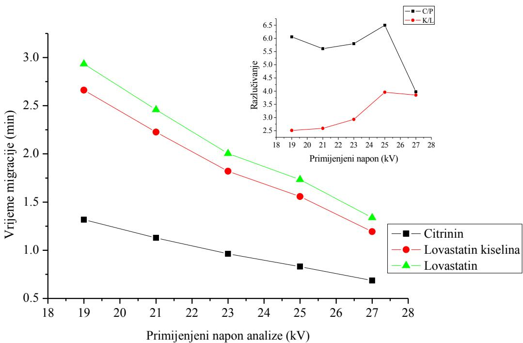
**Slika 43.** Ovisnost vremena migracije o primjenjenom naponu analize. Umetak sliji: Ovisnost razlučivanja između analita o primjenjenom naponu analize.
