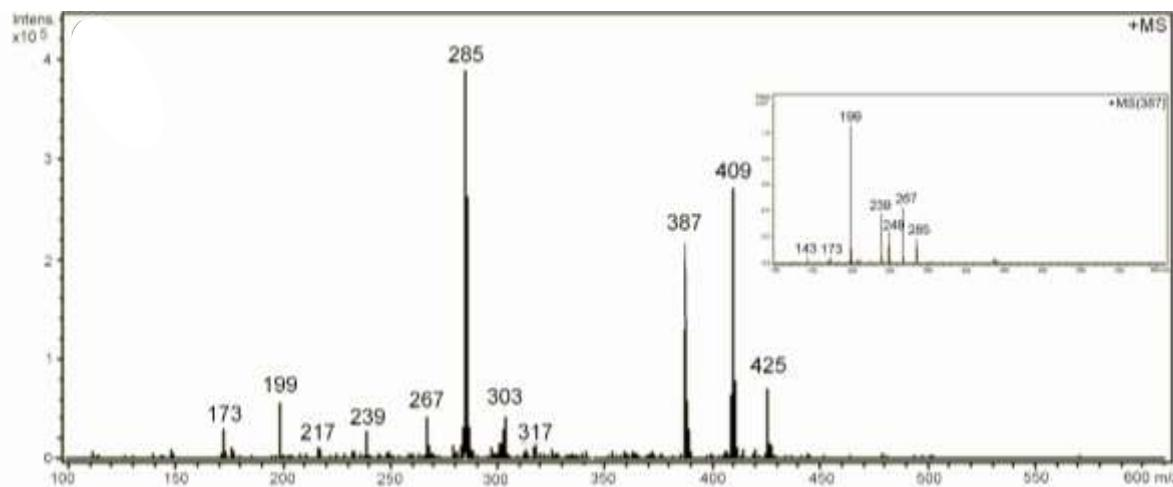
**Slika 56.** Maseni spektar dehidromonakolina K. Umetak slici: ESI-MS<sup>2</sup> spektar molekulskog iona  $m/z$  387.
