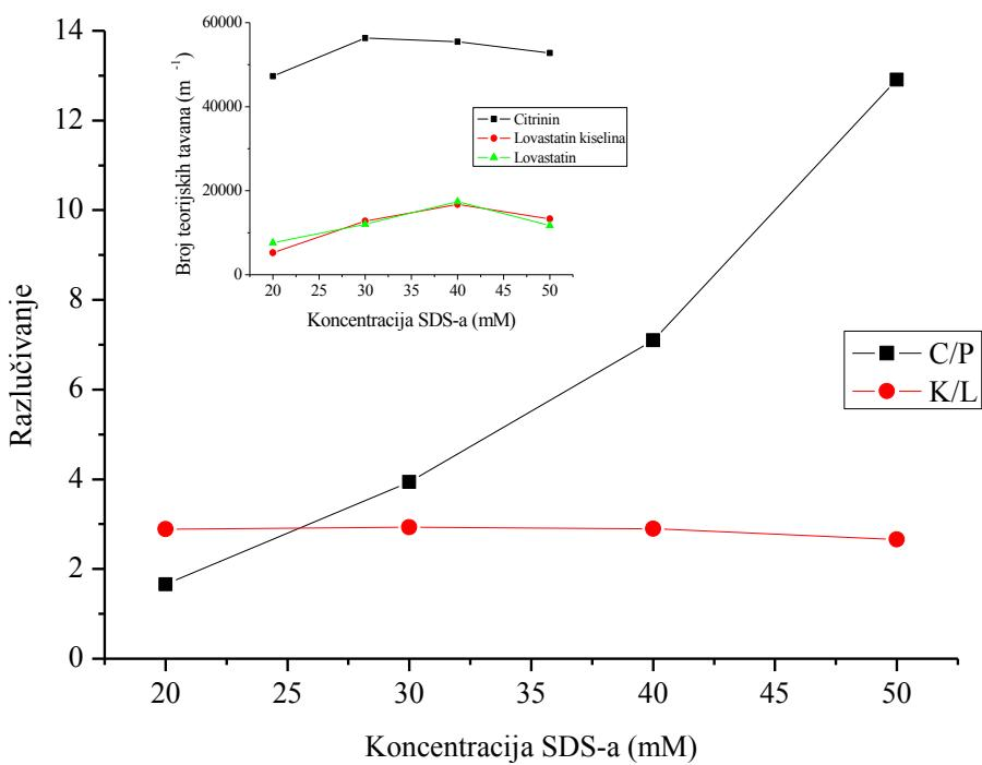
**Slika 42.** Ovisnost razlučivanja između analita o koncentraciji SDS-a. Umetak slići: Ovisnost broja teorijskih tavana o koncentraciji SDS-a.
