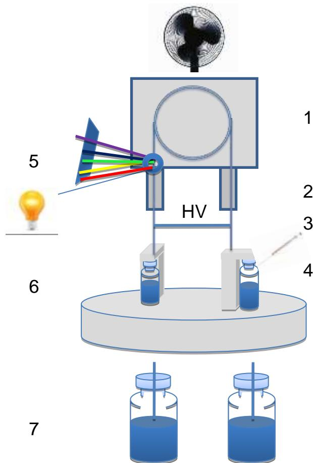
**Slika 4.** Shema uređaja za kapilarnu elektroforezu: termostatirana kapilara (1), dvije elektrode (2), visokonaponski izvor istosmjerne struje (3), sustav za unošenje uzorka (4), detektor (5), ulazni/izlazni spremnik za pufere (6) i sustav za izmjenu pufera (7).
