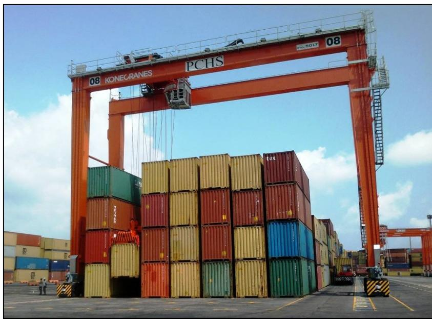
Slika 8 Kontejnerski blok slagališta opremljen RTG dizalicom
