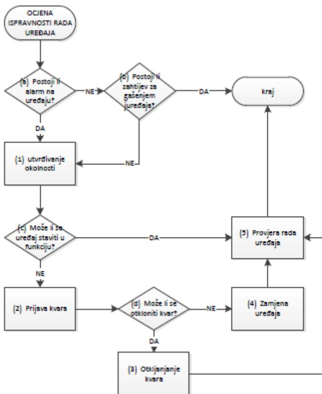
Slika 3: Dijagram toka ocjene ispravnosti rada uređaja
