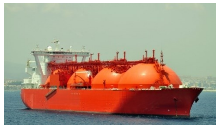
Slika: 2.2.2. Kvaerner-Moss sferični tip broda
