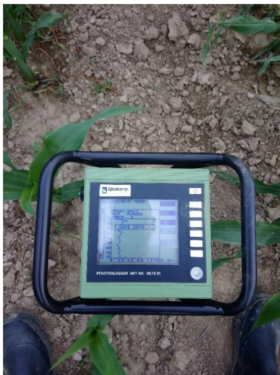
Slika 2.12. Penetrometar "Eijkelkamp Penetrologger SN" (izvor: vlastita fotografija)
