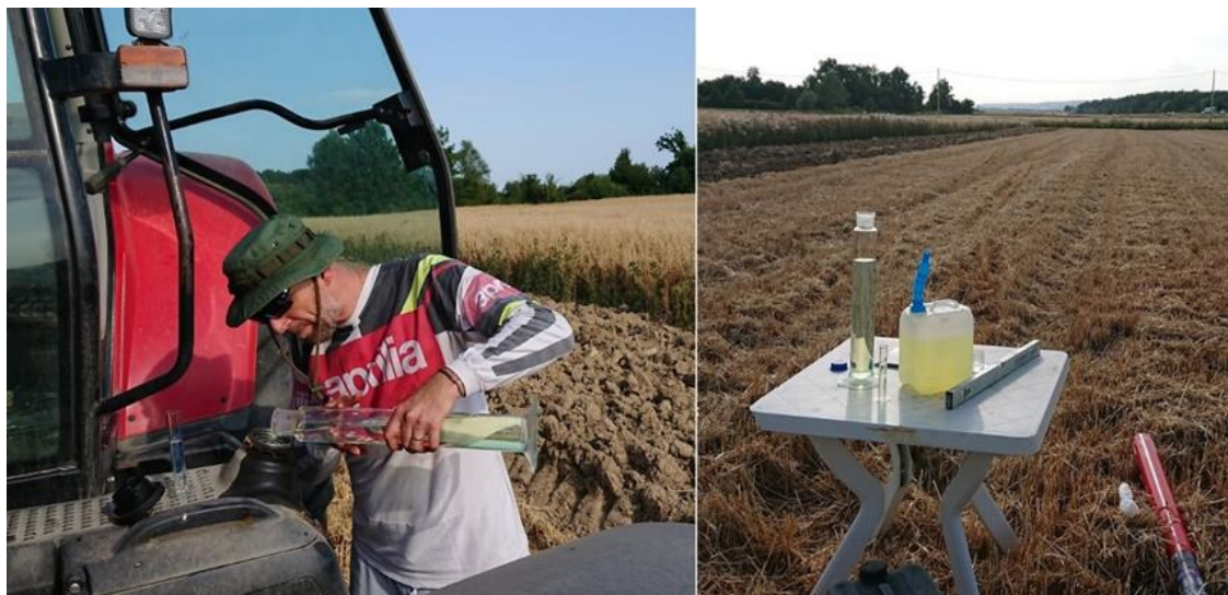
Slika 2.13. Ispitivanje točnosti rada putnog računala (izvor: vlastita fotografija)
