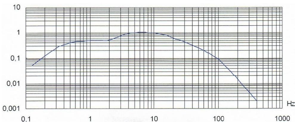
Slika 11. Težinski filteri za mjerenje vibracija koje utječu na trup rukovatelja u smjeru z osi ( $W_k$ )
