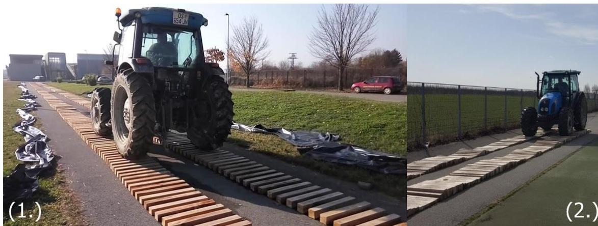
Slika 4. Testne trake (glatka (1.) i gruba (2.))
