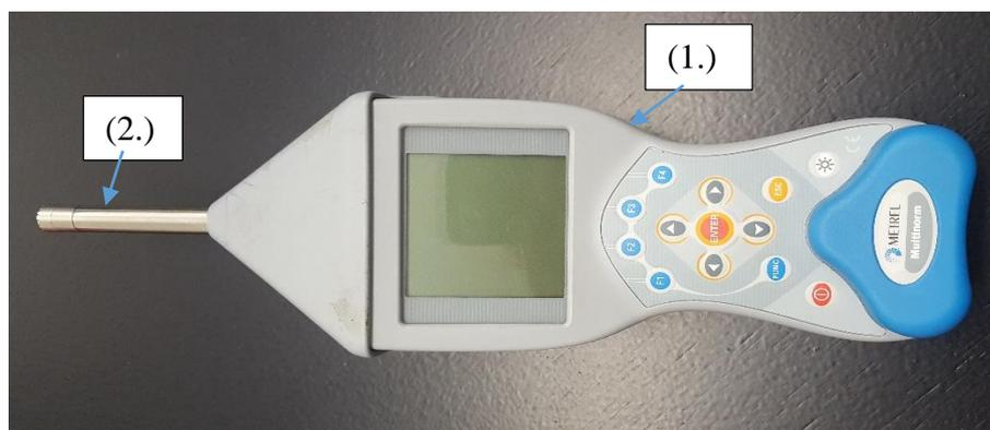
Slika 7. Uređaj za mjerenje buke (1.) s pripadajućim senzorom (2.)
