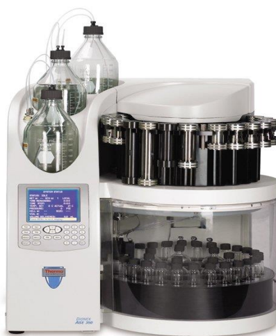
Slika 19. Uređaj za ubrzanu ekstrakciju otapalima pri povišenom tlaku Thermo Scientific™ Dionex™ ASE™ 350 (Anonymous 4, 2020)
