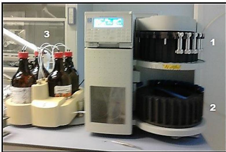
**Slika 3.4.2.2.** Uređaj za ekstrakciju otapalom pod visokim tlakom (ASE): 1) čelije za ekstrakciju s uzorkom 2) epruvete za skupljanje ekstrakta 3) otapala za ekstrakciju.
