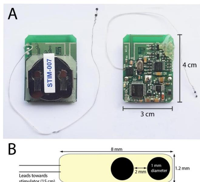
**Slika 1.** A) NeuroMod stimulator s baterijom i elektrodom. B) Shematski prikaz elektrode za stimulaciju spinalnog ganglia
