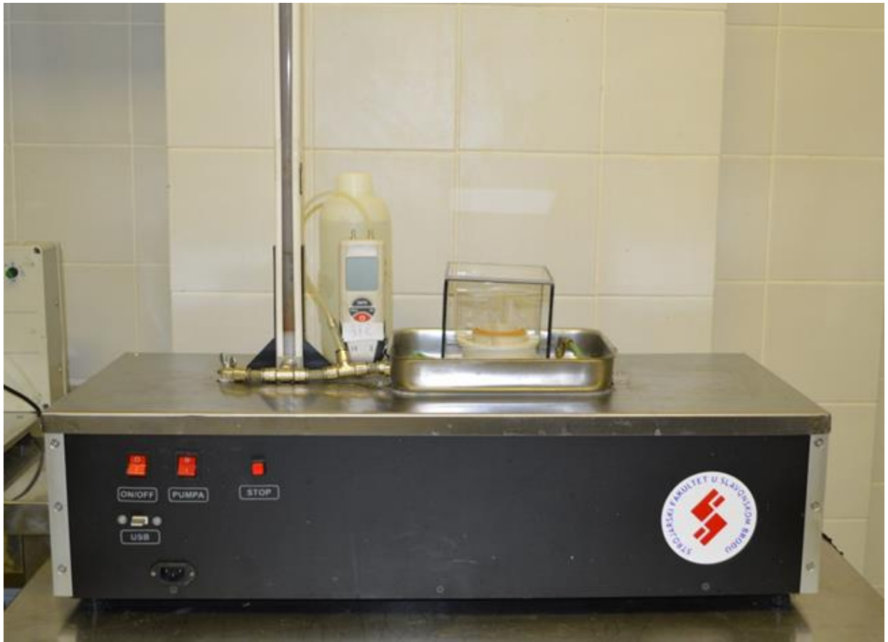
Slika 4.18. Uređaj za ispitivanje plodovih ovoja hidrauličkim udubljivanjem – pogled sprijeda
