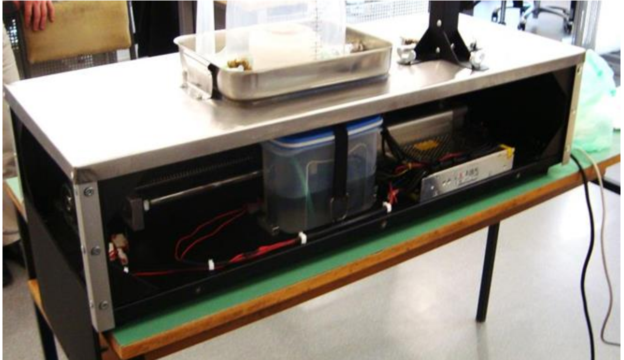
Slika 4.19. Uređaj za ispitivanje plodovih ovoja hidrauličkim udublivanjem – izgled unutrašnjosti
