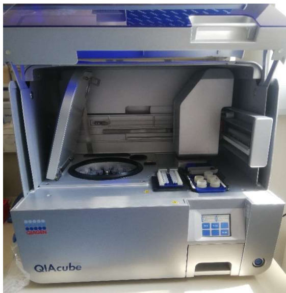
Slika 6. a) QIAcube uređaj za izolaciju DNA (slikano u HZTM)
