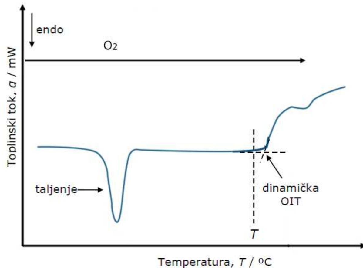
Određivanje indukcijske temperature oksidacije metodom tangente
