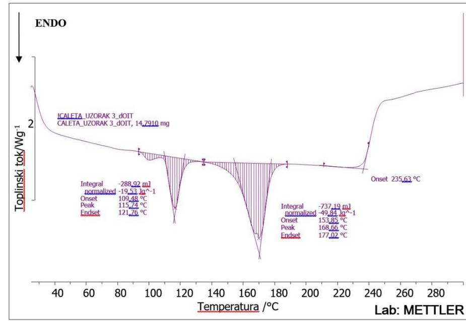
Određivanje induksijske temperature oksidacije uzorka 3
