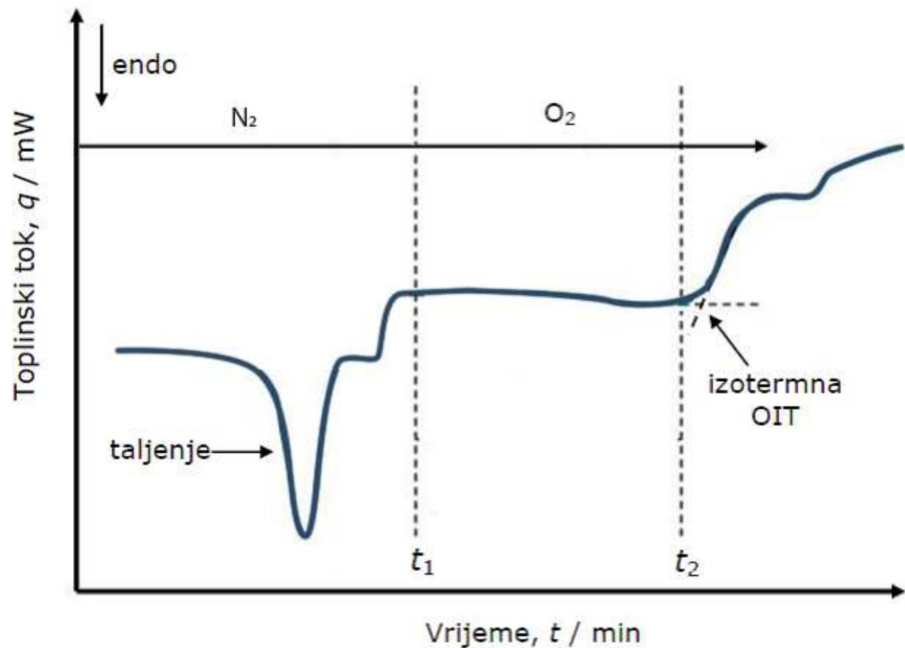
Određivanje induksijskog vremena oksidacije metodom tangente
