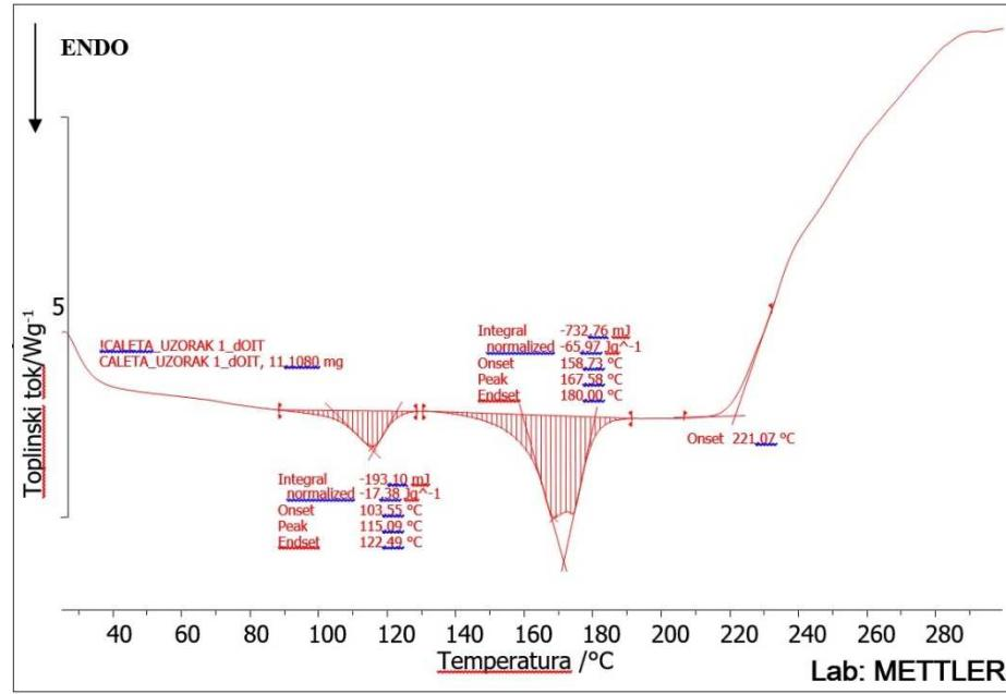
Određivanje induksijske temperature oksidacije uzorka 1
