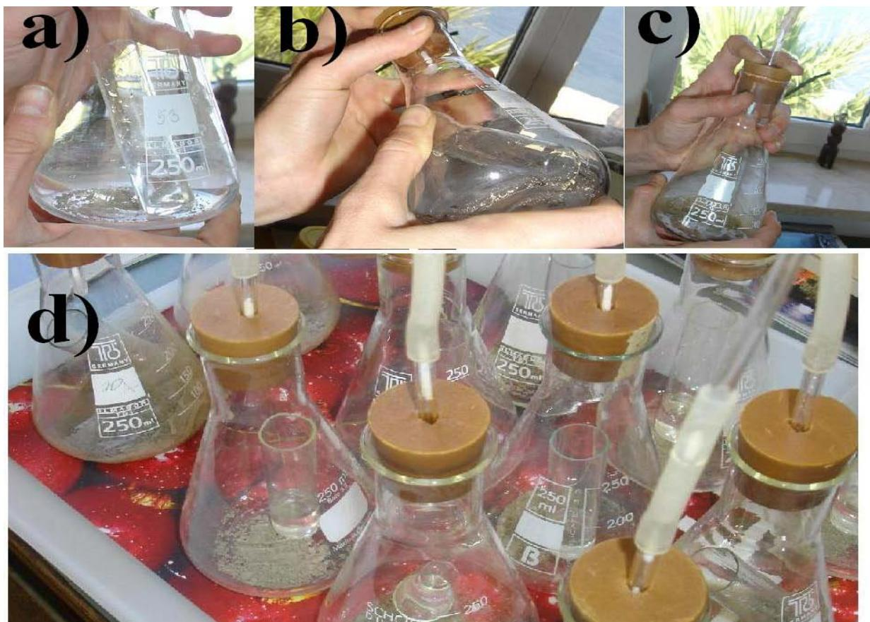
**Slika 7.** Određivanje karbonata u sedimentu gravimetrijskom metodom  $m^{144}$
