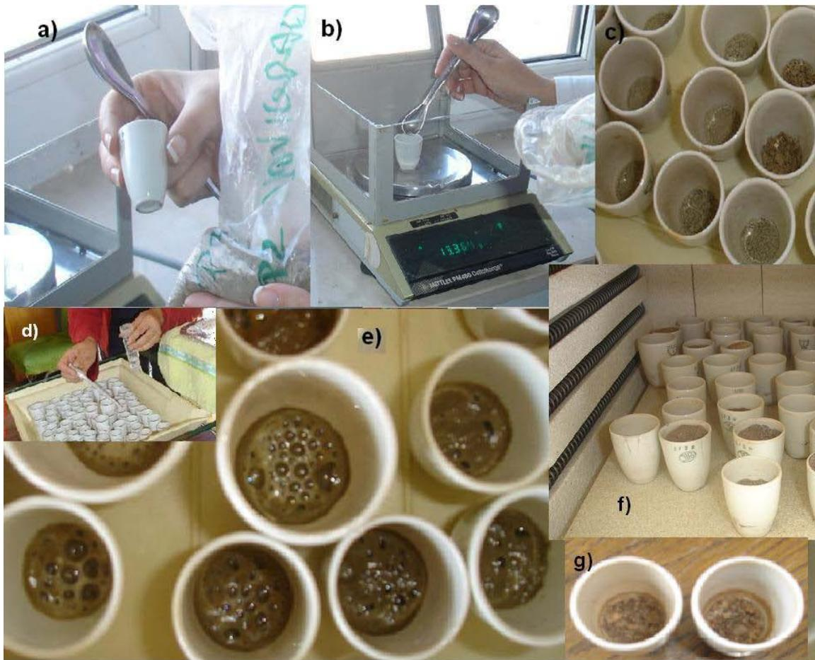
**Slika 6.** Određivanje organske tvari u sedimentu gravimetrijskom metodom
