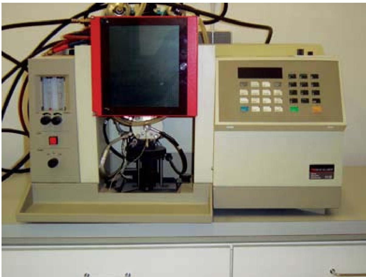
**Slika 5.** Atomski apsorpc ijski spektrofotometar
