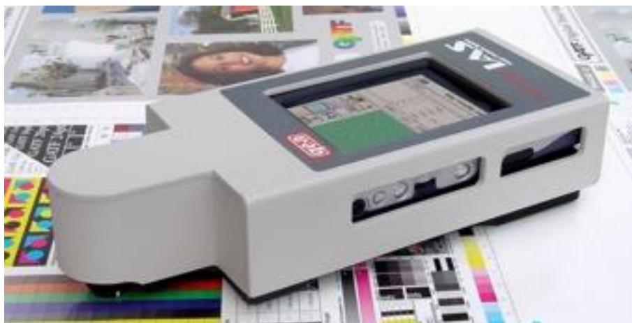
Slika 48. Uređaj za slikovnu analizu QEA Personal IAS
