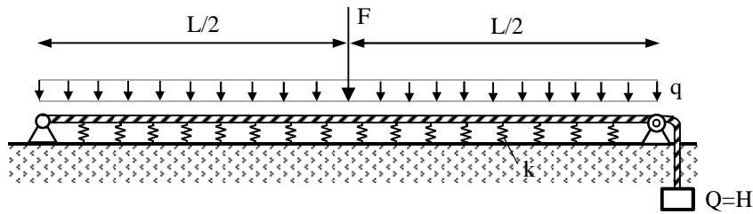
Crtež 7.16 Cijev ili kabel na elastičnoj podlozi
