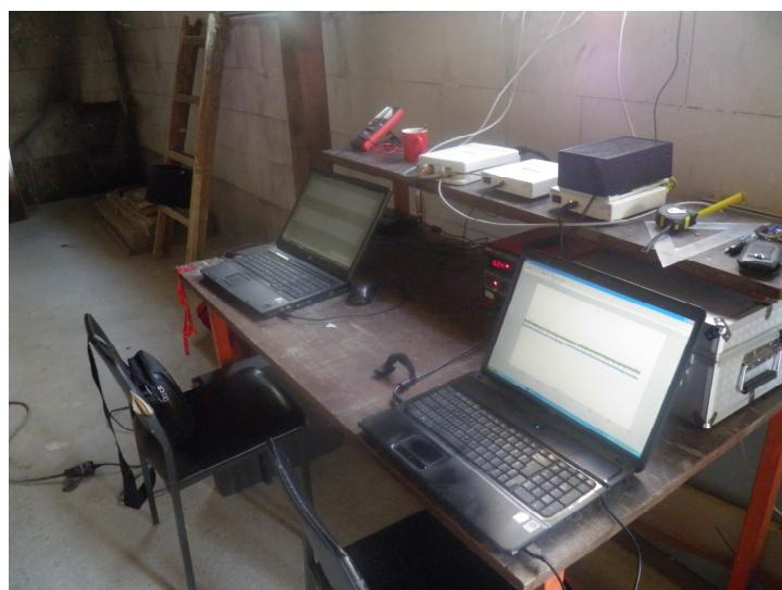
Fotografija 6.9. Prikaz uređaja za akviziciju podataka mehaničkog odgovora ploče
