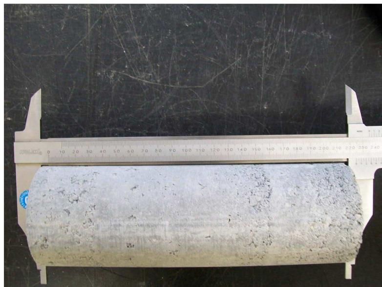
*Fotografija 5.1. Dimenzijske vrijednosti valjka za određivanje tlačne čvrstoće i modula elastičnosti betona*
