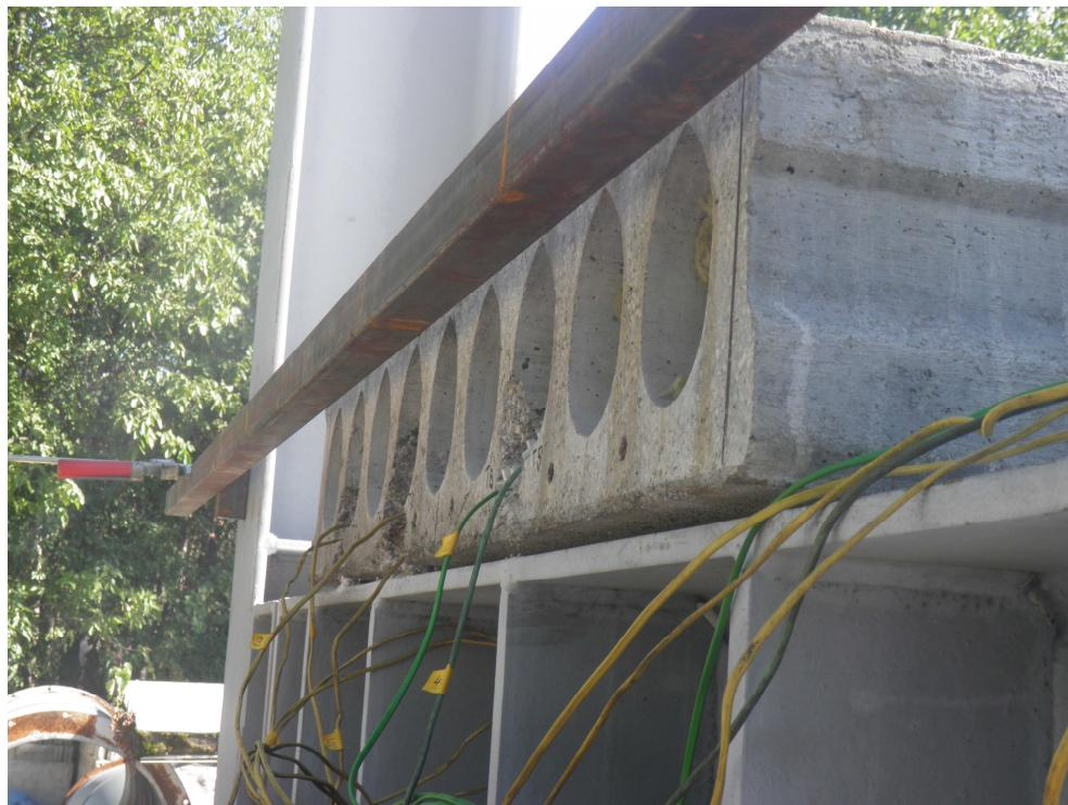
*Fotografija 6.5. Prikaz termoparova za mjerjenje temperature*
