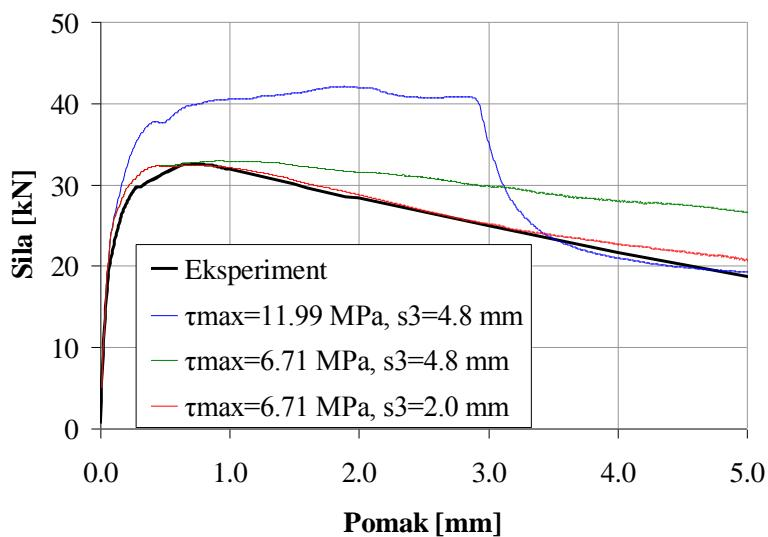
Slika 5.19 Usporedba eksperimentalno dobivenog dijagrama sila-pomak i dijagraama sila-pomak dobivenog numeričkim proračunom za model (M2\_15\_) (kalibracija)
