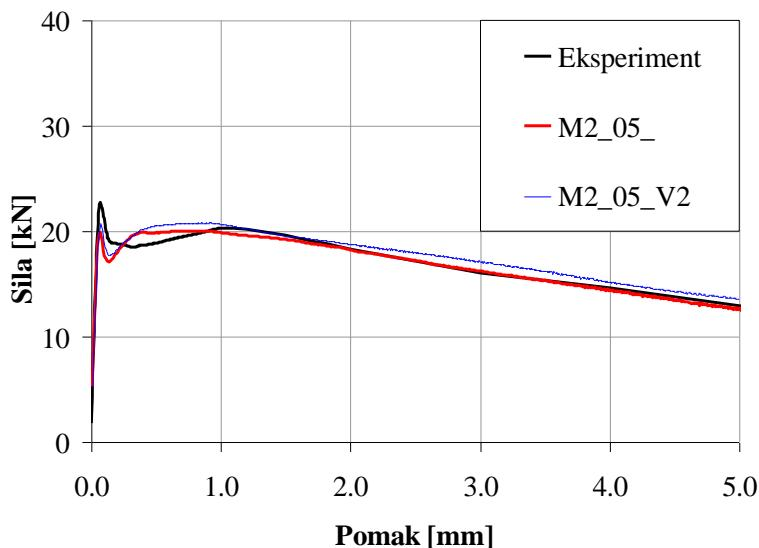
Slika 6.10 Usporedba eksperimentalno dobivenog dijagrama sila-pomak i dijagrama sila-pomak dobivenog numeričkim proračunom za modele M2\_05\_ i M2\_05\_V2
