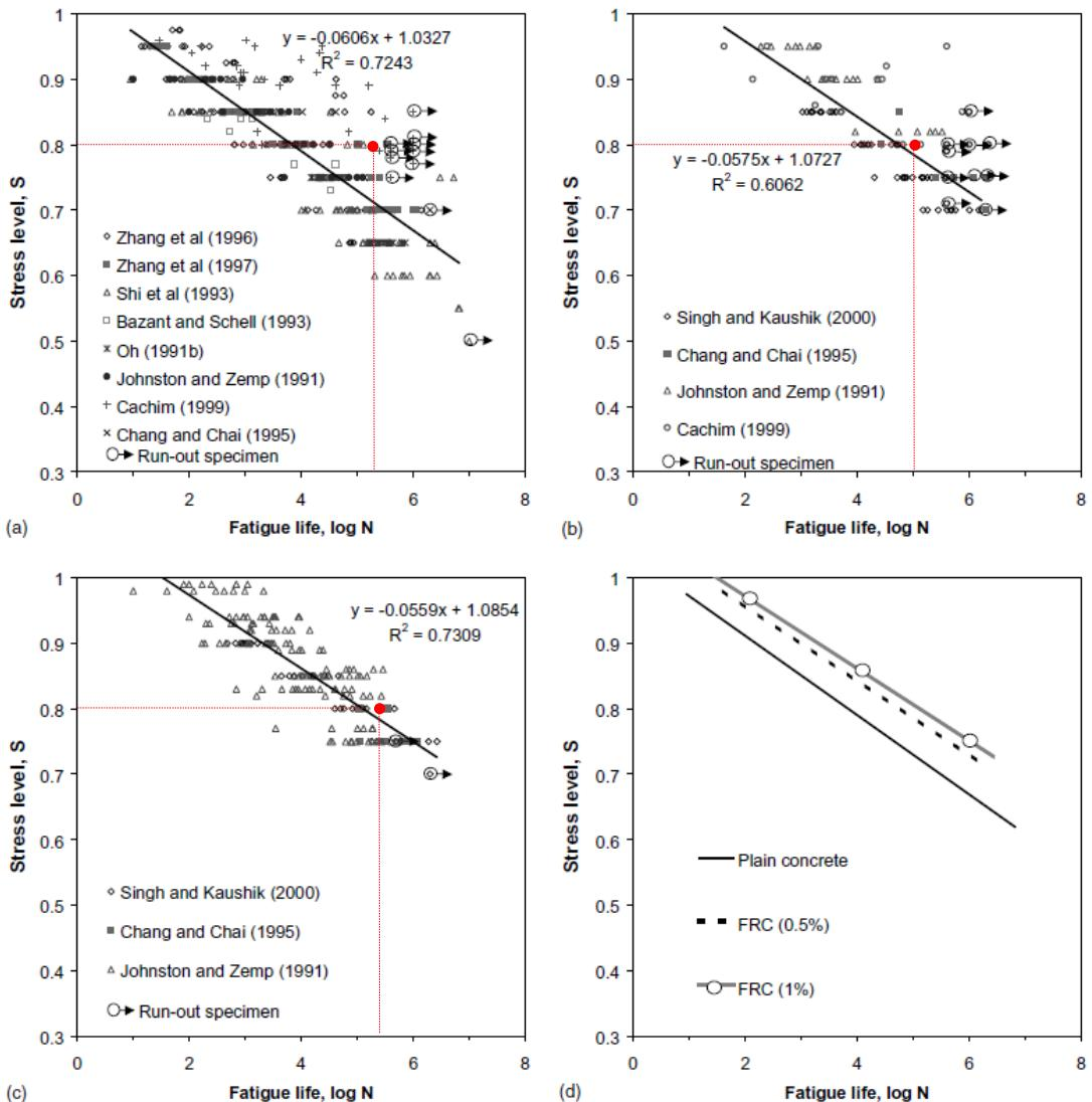
Slika 3.17 Usporedba  $S$ - $N$  krivulje za beton armiran vlaknima pri savijanju [27] s provedenim eksperimentima: (a)  $V_f=0.0\%$ , (b)  $V_f=0.5\%$ , (c)  $V_f=1.0\%$  i (d)  $V_f=0.0\%$ ,  $V_f=0.5\%$  i  $V_f=1.0\%$
