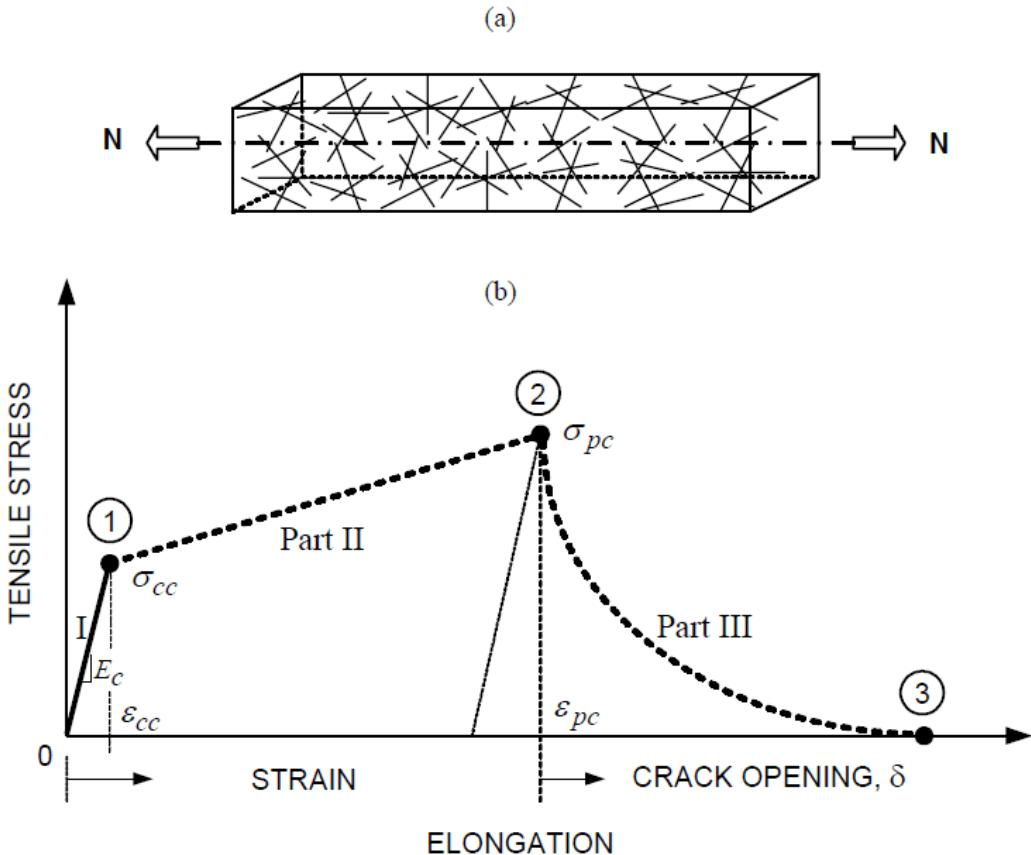
Slika 2.11 Jednostavni model: (a) vlačni element i (b) idealizirani dijagram naprezanje-pomak u vlaku [54]
