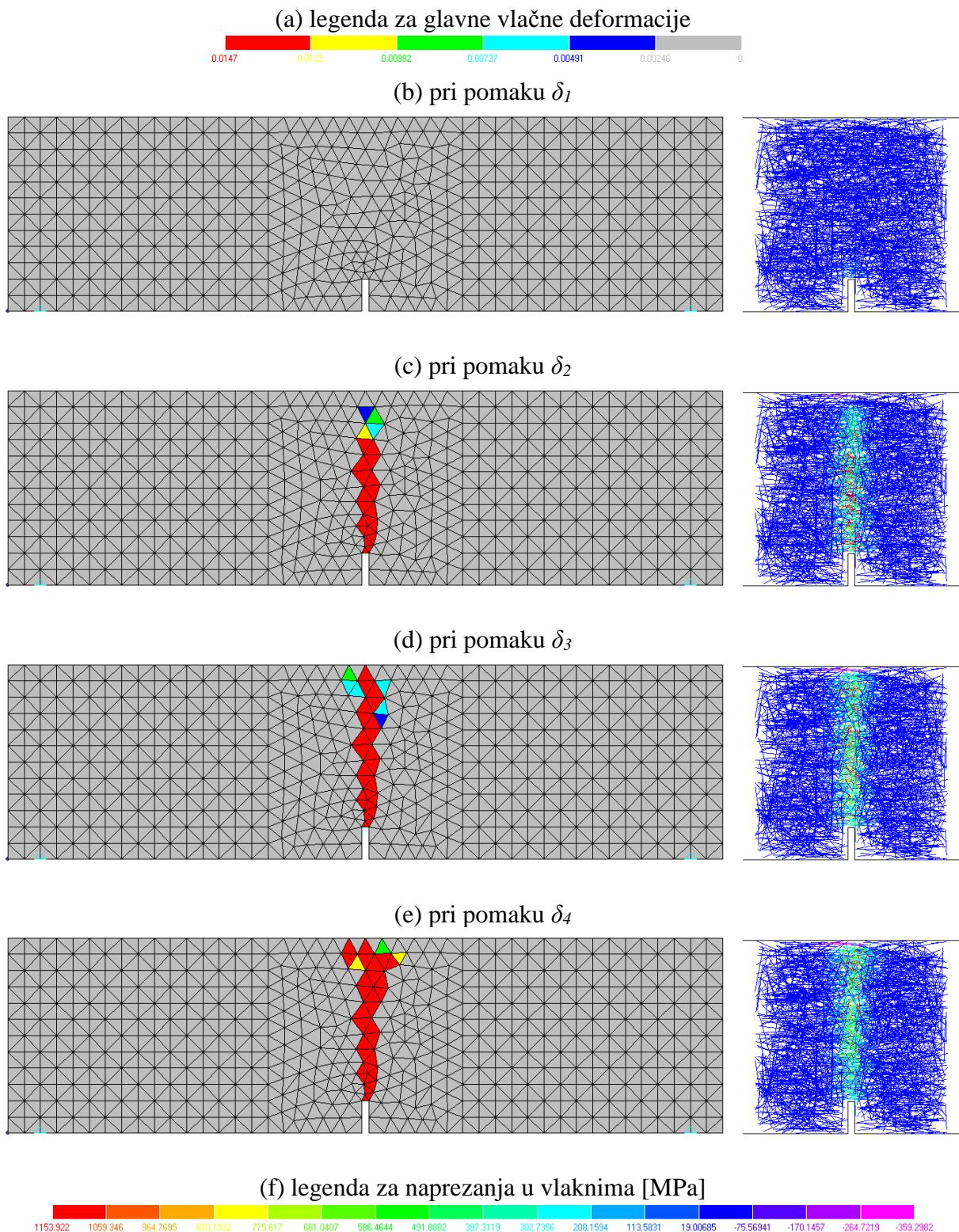
Slika 5.11 Prikaz pukotina (lokalizacija glavne vlačne deformacije) i naprezanja u vlaknima za model M2\_05\_
