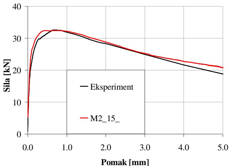
Slika 5.20 Usporedba eksperimentalno dobivenog dijagrama sila-pomak i dijagraama sila-pomak dobivenog numeričkim proračunom za model M2\_15\_
