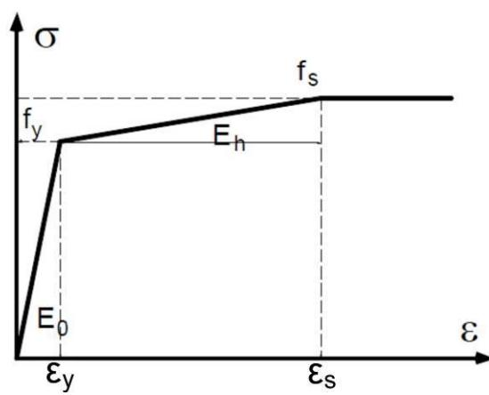
Slika 4.4 Ulagani parametri za modeliranje vlakna
