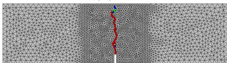
Slika 5.30 Prikaz pukotina (lokalizacija glavne vlačne deformacije) za model M1\_10\_BV
