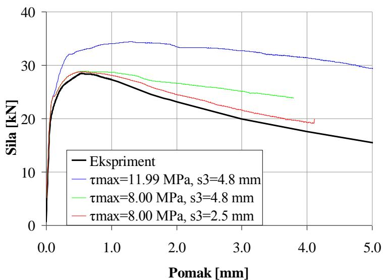
Slika 5.16 Usporedba eksperimentalno dobivenog dijagrama sila-pomak i dijagraama sila-pomak dobivenog numeričkim proračunom za model (M2\_10\_) (kalibracija)
