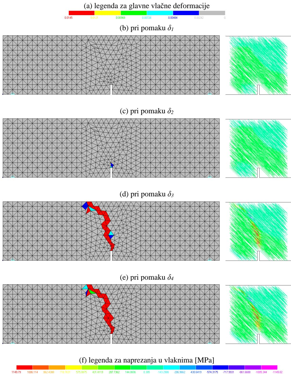
Slika 6.8 Prikaz pukotina (lokalizacija glavne vlačne deformacije) i naprezanja u vlaknima za
