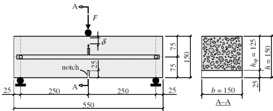
Slika 3.8 Uzorak za eksperiment statičkog ispitivanja grede na savijanje pod kontrolom pomaka [58]
