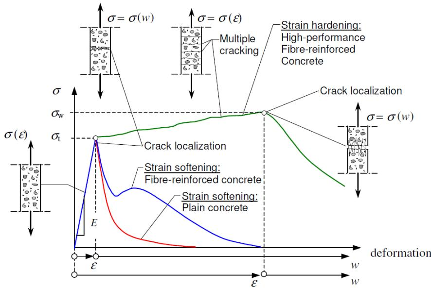
Slika 2.4 Klasifikacija vlačnog ponašanja materijala baziranih na cementu [29]
