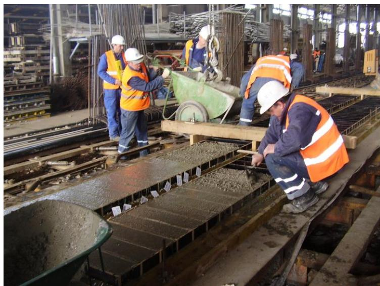
Slika 3.12 Betoniranje kalupa za statičko ispitivanje grede na savijanje pod kontrolom pomaka
