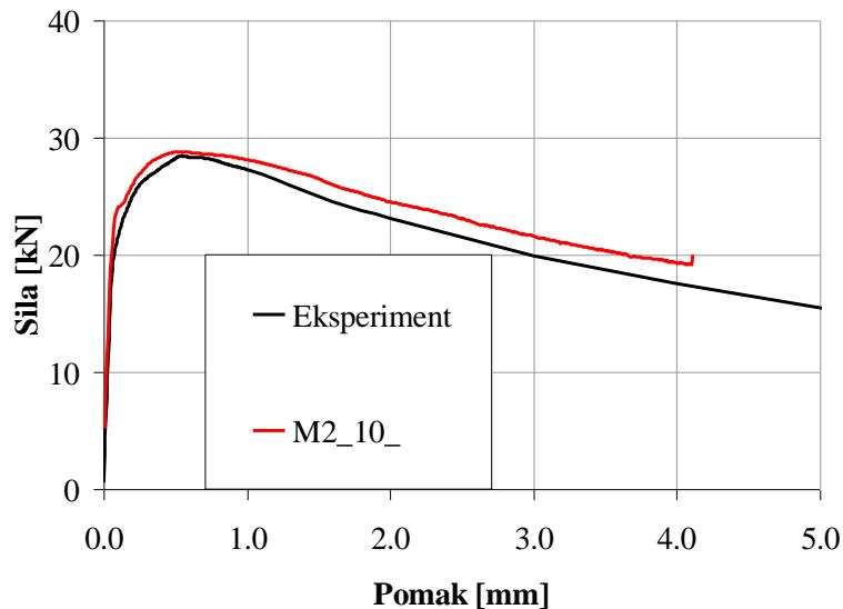
Slika 5.17 Usporedba eksperimentalno dobivenog dijagrama sila-pomak i dijagrama sila-pomak dobivenog numeričkim proračunom za model M2\_10\_
