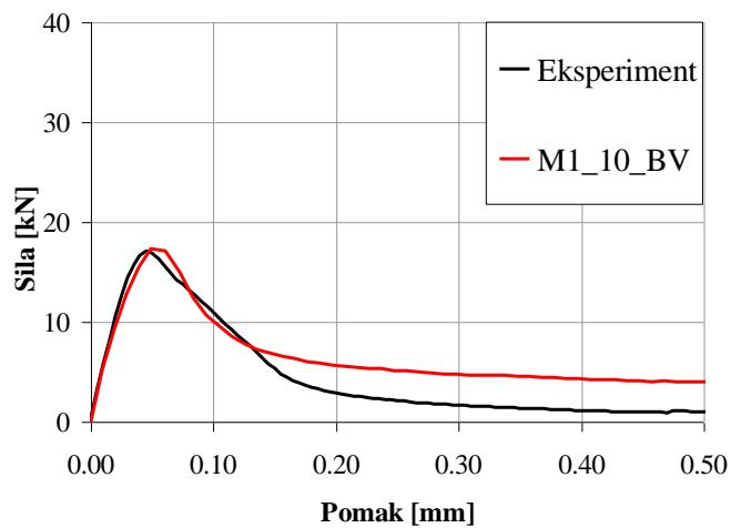
Slika 5.29 Usporedba eksperimentalno dobivenog dijagraama sila-pomak i dijagraama sila-pomak dobivenog numeričkim proračunom za model M1\_10\_BV
