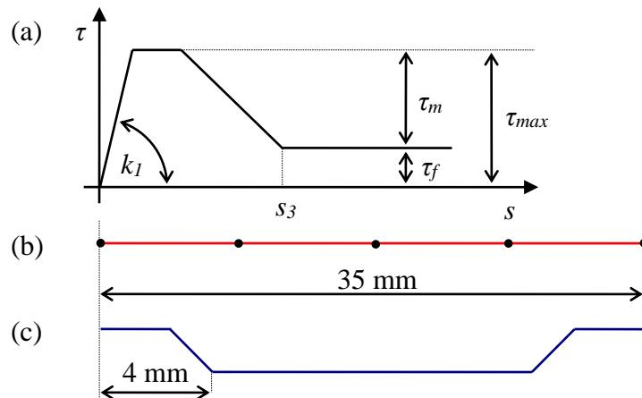
Slika 4.11 Način modeliranja vlakna: (a) veze posmično naprezanje-prokliznuće vlakna ( $\tau$ -s), (b) štapni konačni elementi i čvorovi vlakna i (c) stvarni oblik vlakna
