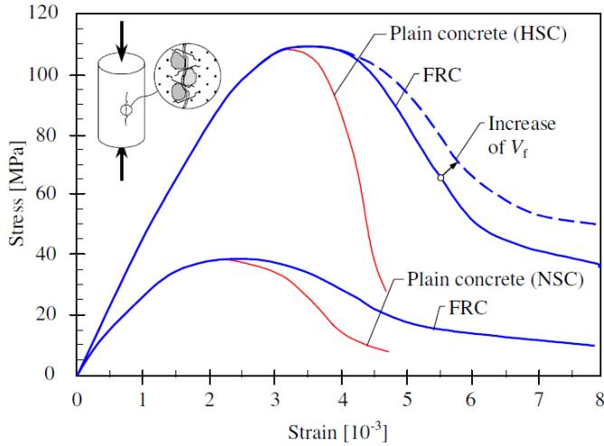
Slika 2.3 Dijagrami naprezanje-deformacija za beton i beton armiran vlknima [29]
