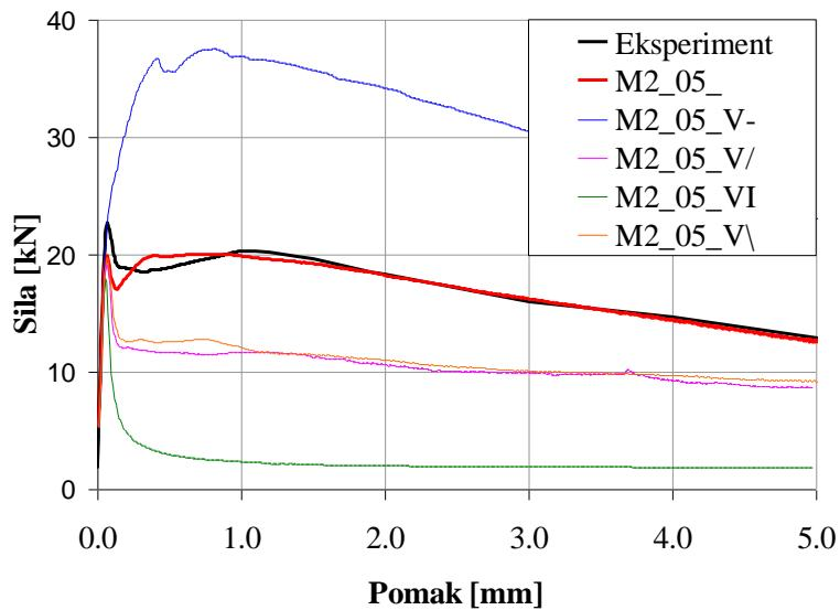
Slika 6.9 Usporedba eksperimentalno dobivenog dijagrama sila-pomak i dijagrama sila-pomak dobivenog numeričkim proračunom za model M2\_05\_ i sve modele pri predefiniranoj orientaciji vlakana
