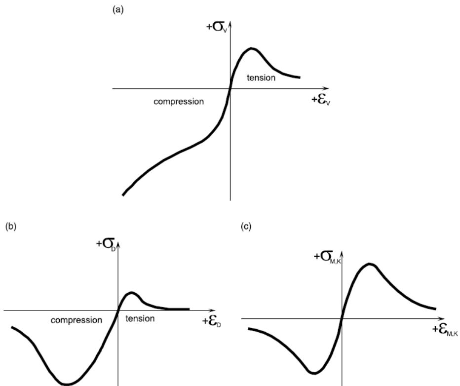
Slika 4.2 Veza između naprezanja i deformacije (prikazana kvalitativno): (a) volumenska komponenta, (b) devijatorska komponenta i (c) posmične komponente  $M$  i  $K$  [48]
