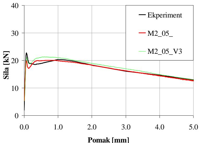
Slika 6.12 Usporedba eksperimentalno dobivenog dijagrama sila-pomak i dijagrama sila-pomak dobivenog numeričkim proračunom za modele M2\_05\_ i M2\_05\_V3
