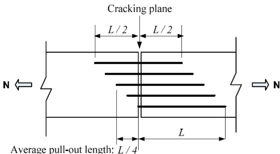
Slika 2.15 Definiranje srednje vrijednost odnosa kraće duljine sidrenja vlakna preko pukotine i duljine vlakna [54]
