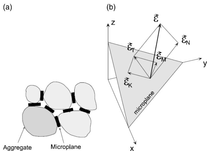
Slika 4.1 Mikroravninski model betona: (a) kontaktni slojevi između zrna agregata i (b) dekompozicija ukupnog makroskopskog tenzora deformacije na mikroravnini [48]
