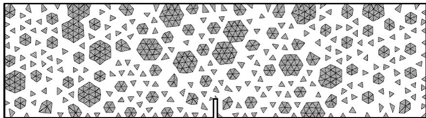
(c) konačni elementi vlakana za model s udjelom vlakana od  $25 \text{ kg/m}^3$  betona ( $V_f=0.325 \%$ )
