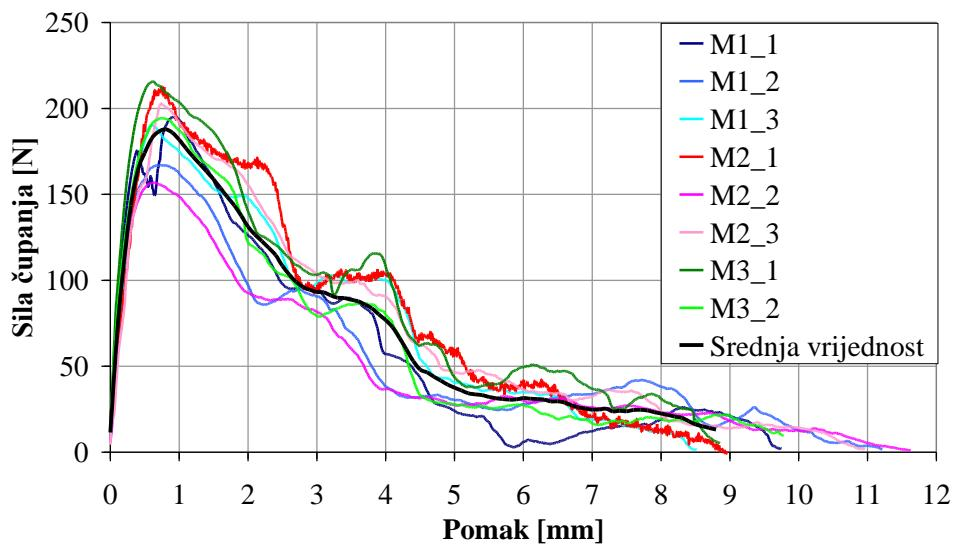
Slika 3.6 Prikaz svih eksperimentalnih rezultata čupanja pojedinačnog vlakna
