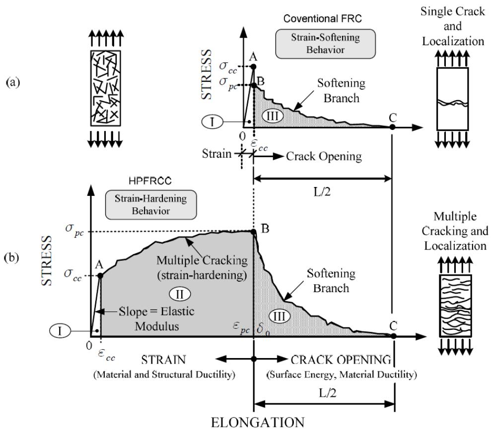
Slika 2.8 Tipični dijagrami naprezanje-deformacija ili naprezanje-pomak u vlaku za betone armirane vlaknima: (a) kompozit koji pokazuje deformacijsko omekšanje (FRC) i (b) kompozit koji pokazuje deformacijsko očvršćivanje (HPFRCC) [54]
