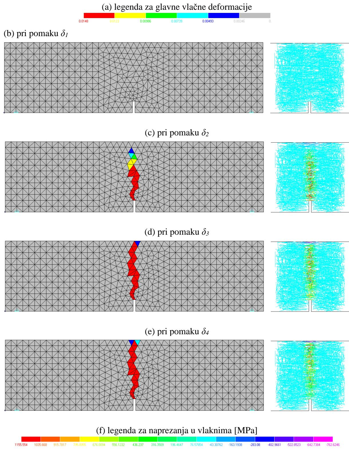
Slika 6.13 Prikaz pukotina (lokalizacija glavne vlačne deformacije) i naprezanja u vlaknima za model M2\_05\_V3
