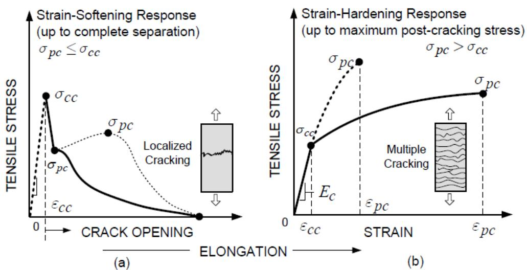
Slika 2.9 Tipični dijagrami naprezanje-pomak u vlaku za betone armirane vlknima: (a) deformacijsko omekšanje i (b) deformacijsko očvršćivanje (HPFRCC) [54]
