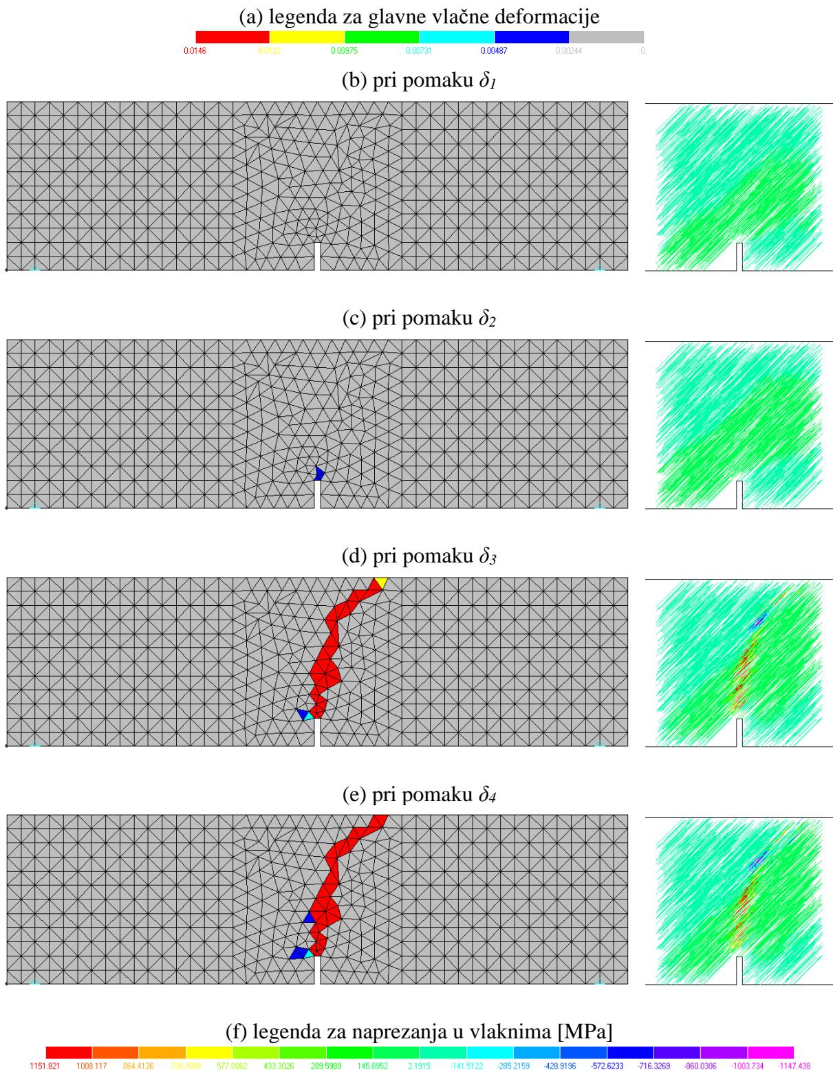
Slika 6.4 Prikaz pukotina (lokalizacija glavne vlačne deformacije) i naprezanja u vlaknima za
