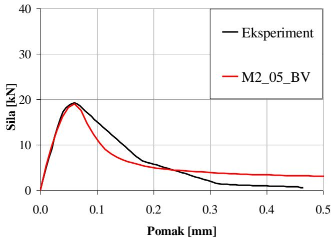
Slika 5.5 Usporedba eksperimentalno dobivenog dijagraama sila-pomak i dijagraama sila-pomak dobivenog numeričkim proračunom za model M2\_05\_BV
