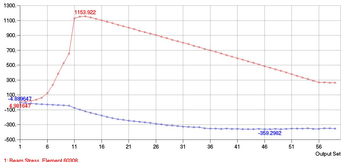
Slika 5.13. Najveća i najmanja naprezanja u vlaknima za model M2\_05
