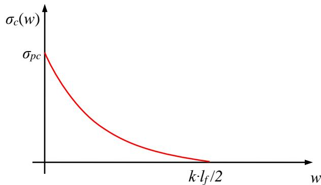
Slika 2.17 Veza vlačno naprezanje kompozita-širina pukotine ( $\sigma_c-w$ )
