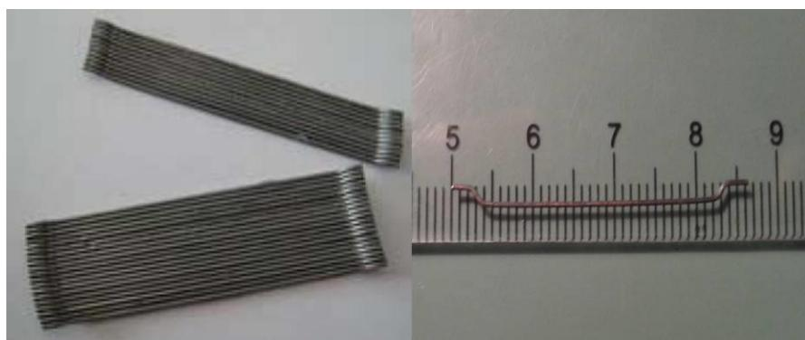
Slika 3.1 Čelična vlakna s kukama Dramix RC 65/35 BN
