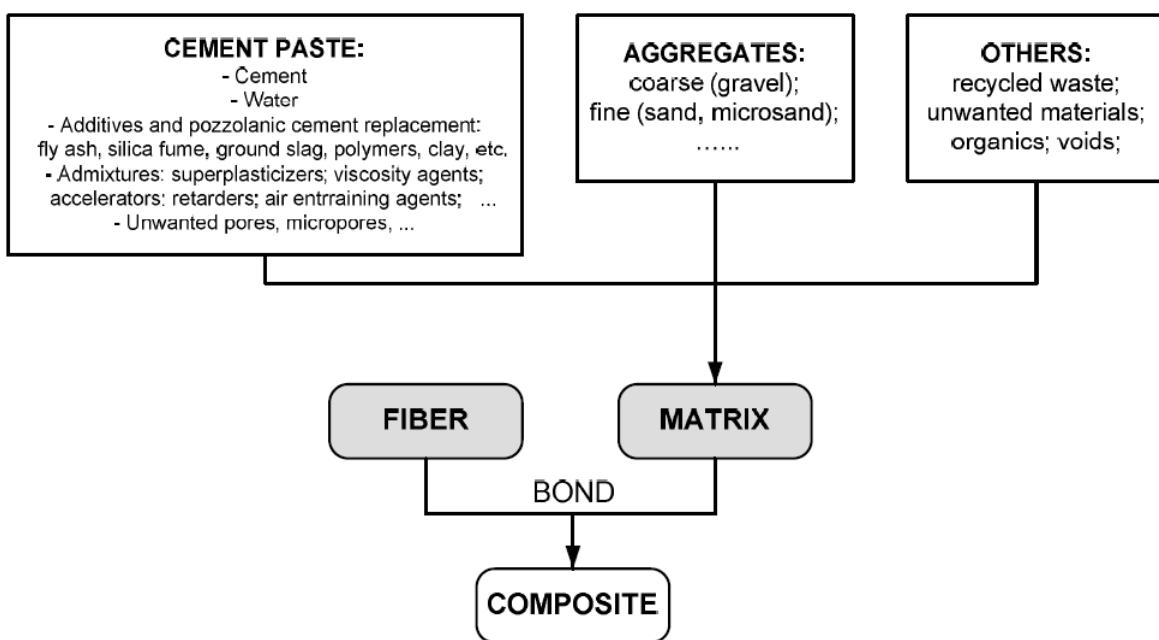
Slika 2.7 Beton armiran vlaknima prikazan kao kompozit [54]
