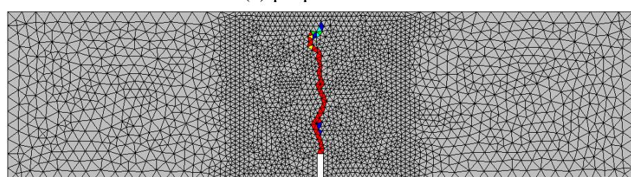
Slika 5.8 Prikaz pukotina (lokalizacija glavne vlačne deformacije) za model M2\_10\_BV
