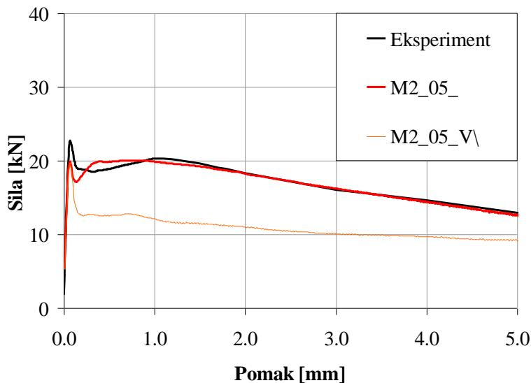
Slika 6.7 Usporedba eksperimentalno dobivenog dijagrama sila-pomak i dijagrama sila-pomak dobivenog numeričkim proračunom za modele M2\_05\_ i M2\_05\_V\
