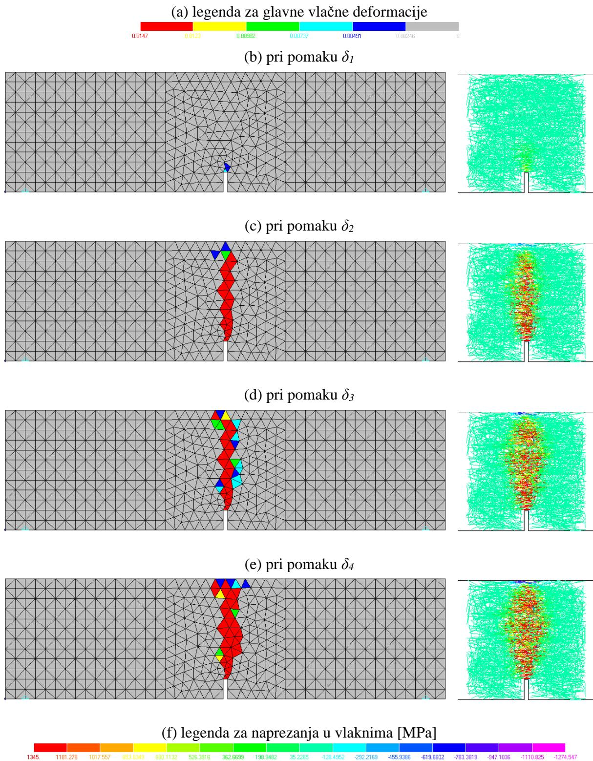
Slika 5.23 Prikaz pukotina (lokalizacija glavne vlačne deformacije) i naprezanja u vlaknima za model M2\_05\_BB
