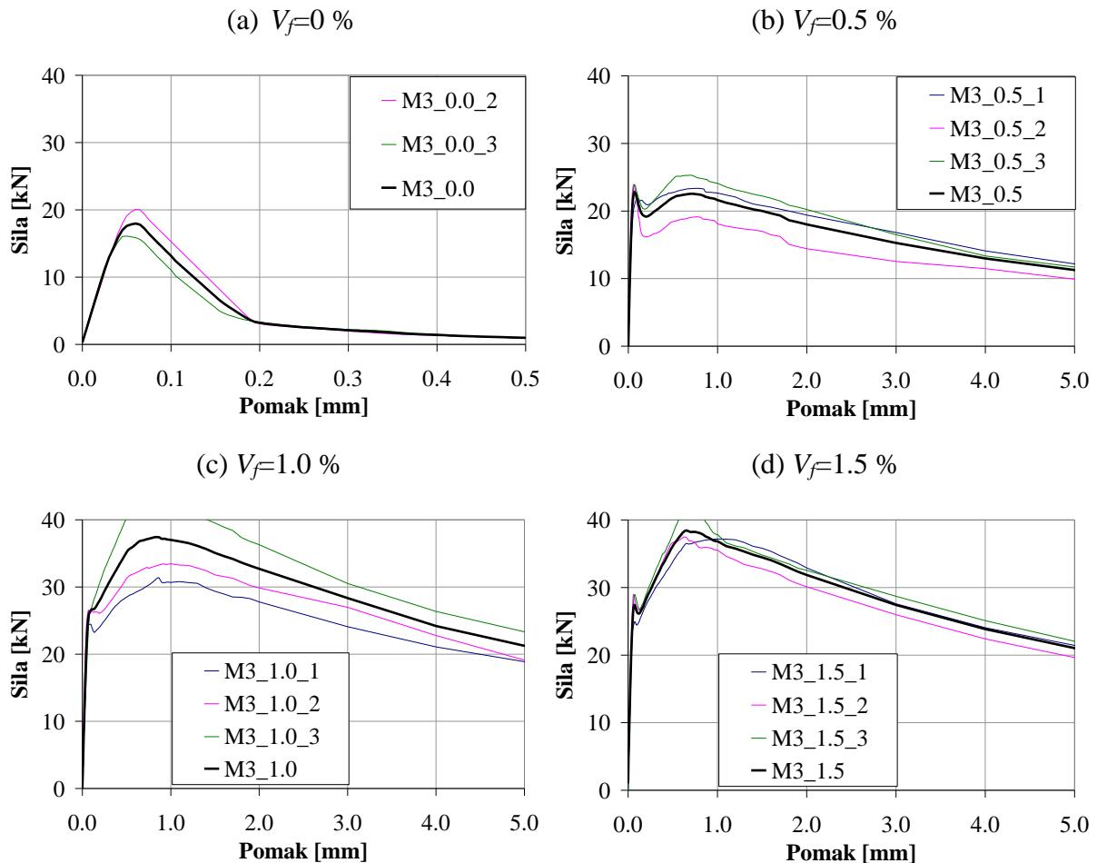
Slika 3.15 Eksperimentalno dobiveni dijagrami sila-pomak greda za različite volumne udjele vlakana i za beton mješavine M3
