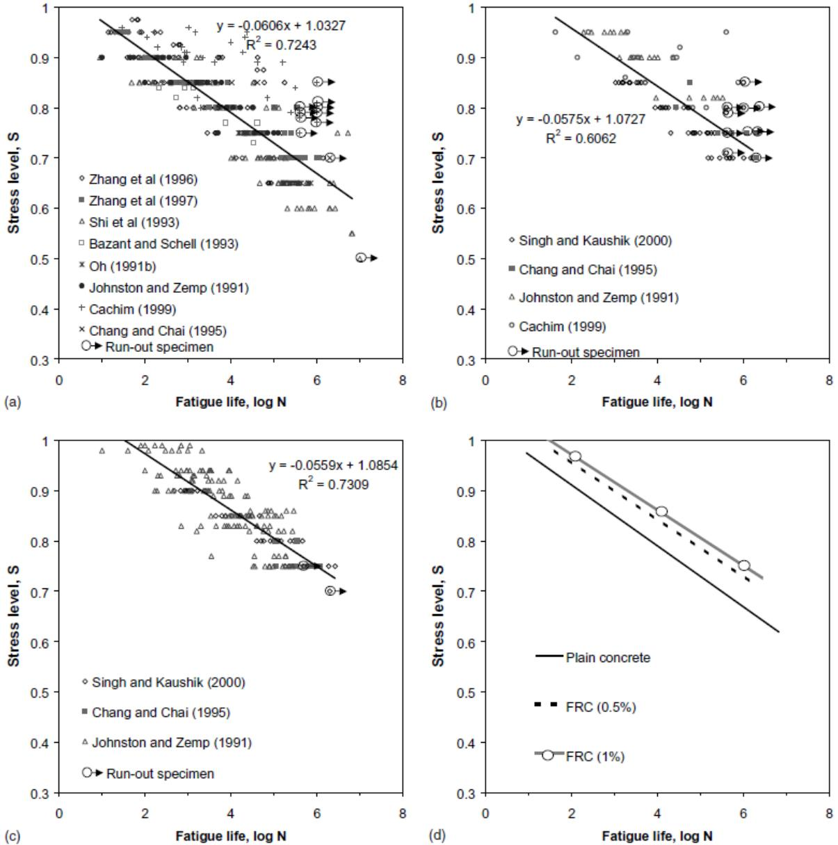
Slika 2.26 S-N krivulje za beton armiran vlaknima pri savijanju: (a)  $V_f=0.0\%$ , (b)  $V_f=0.5\%$ ,
