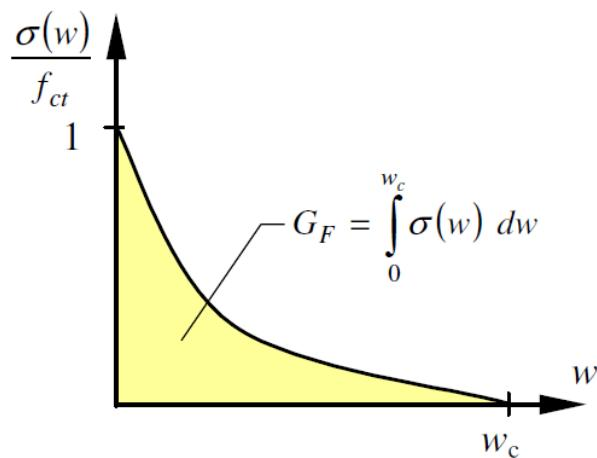
Slika 5.2 Dijagram naprezanje u betonu - širina pukotine ( $\sigma$ - $w$ ) [29]
