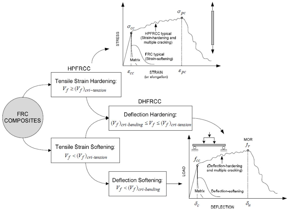
Slika 2.10 Podjela betona armiranih vlknima na osnovu njihovog ponašanja pri vlaku i savijanju [54]
