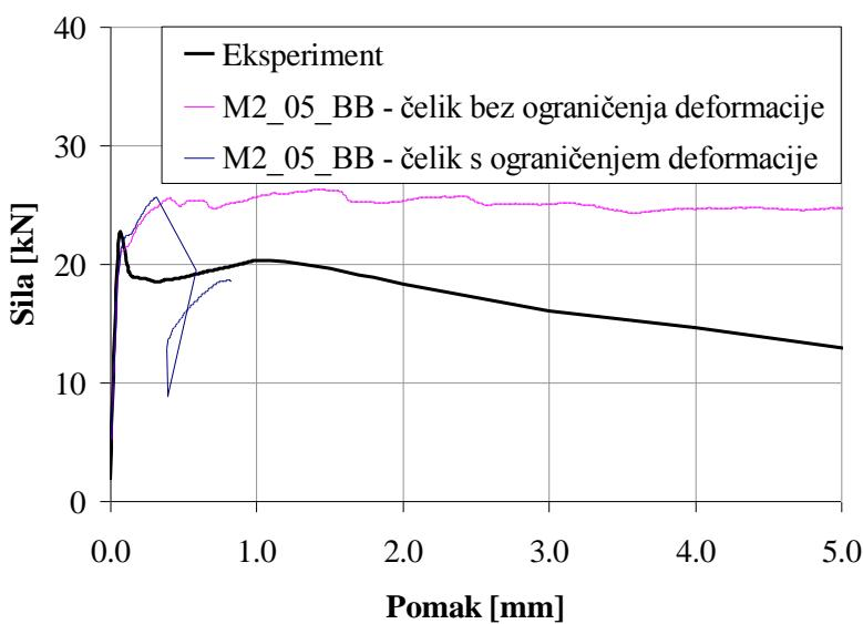
Slika 5.22 Usporedba eksperimentalno dobivenog dijagrama sila-pomak i dijagrama sila-pomak dobivenog numeričkim proračunom za modele M2\_05\_BB
