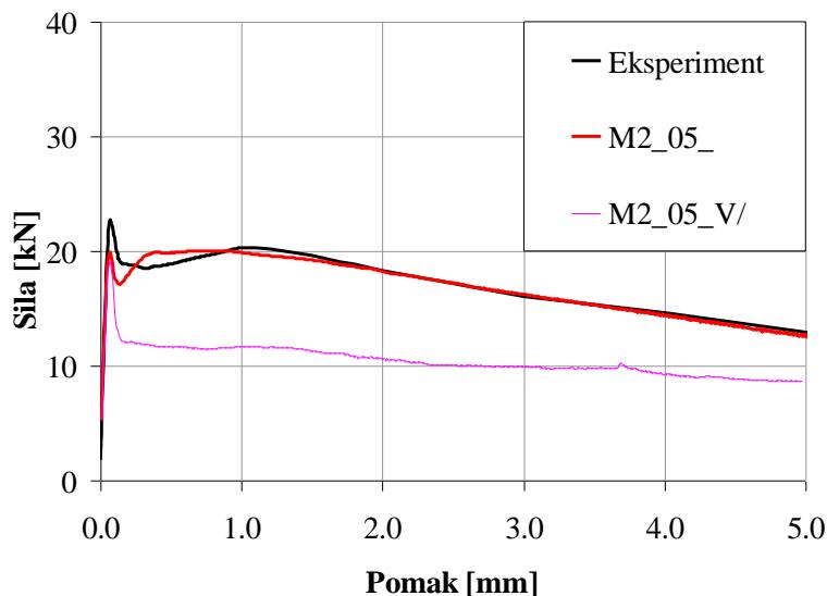
Slika 6.3 Usporedba eksperimentalno dobivenog dijagrama sila-pomak i dijagrama sila-pomak dobivenog numeričkim proračunom za modele M2\_05\_ i M2\_05\_V/
