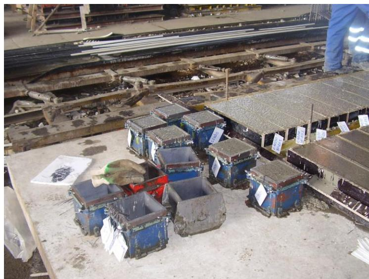
Slika 3.3 Betoniranje kalupa za ispitivanje tlačne čvrstoće betona i vlačne čvrstoće betona cijepanjem
