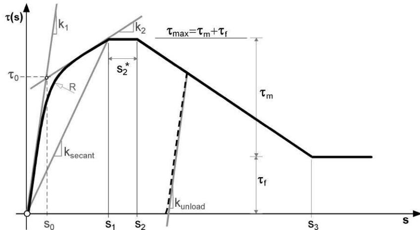
Slika 4.5 Ulagni parametri za modeliranje veze posmično naprezanje-prokliznuće vlakna
