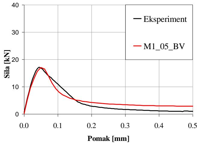
Slika 5.27 Usporedba eksperimentalno dobivenog dijagraama sila-pomak i dijagraama sila-pomak dobivenog numeričkim proračunom za model M1\_05\_BV
