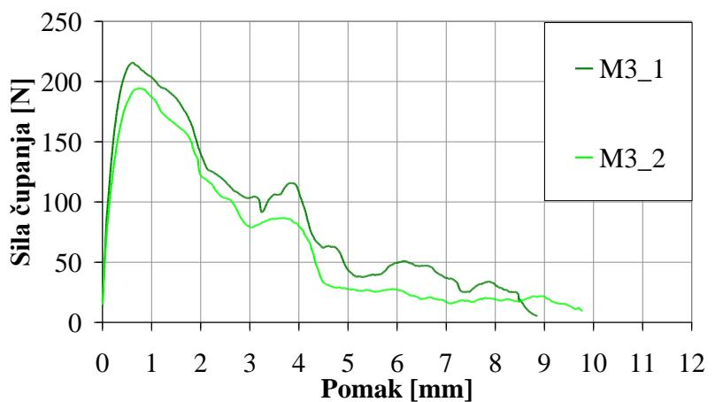
Slika 3.5 Eksperimentalni rezultati čupanja pojedinačnog vlakna za betone mješavina M1, M2 i M3
