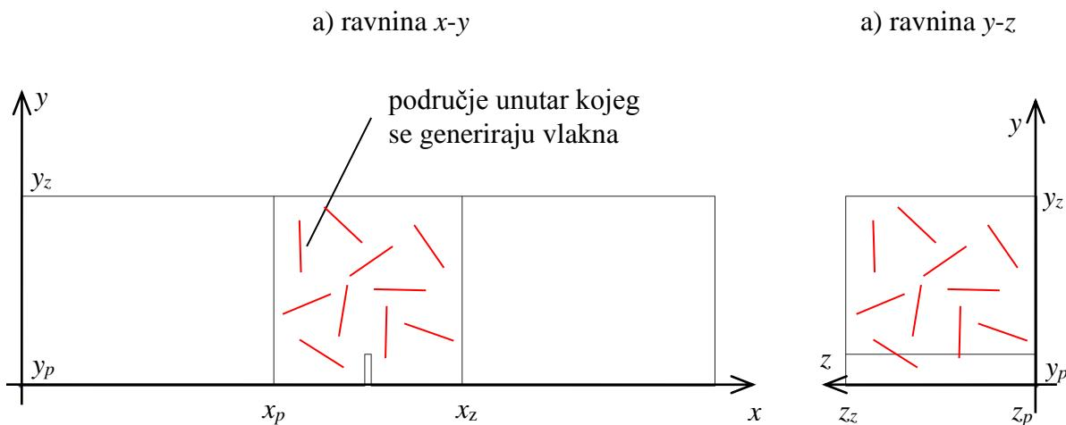
Slika 4.10 Zarezane grede s područjem unutar kojega se generiraju vlakna
