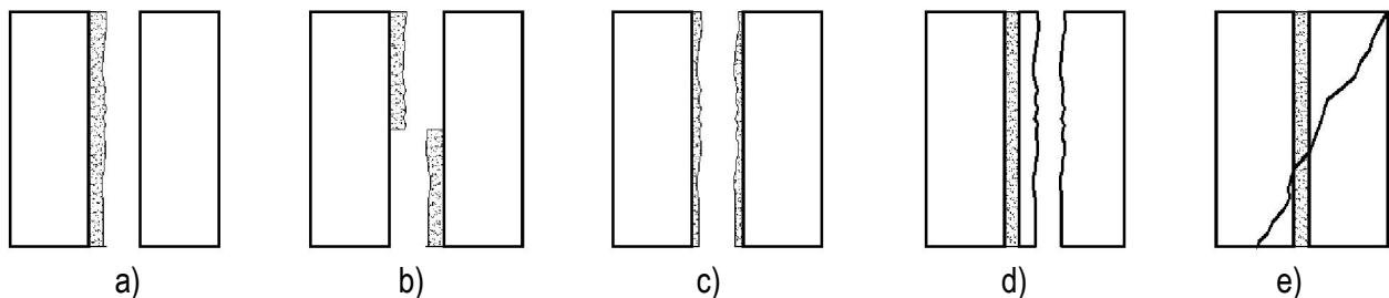
Slika 3.6–Mogući oblici sloma pri ispitivanju posmične čvrstoće zida
