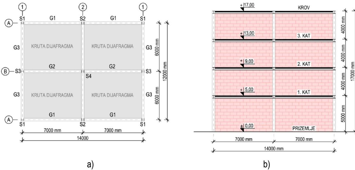
Slika 7.1 – Analizirana konstrukcija: a) tlocrt karakteristične etaže, b) glavni okviri A i B
