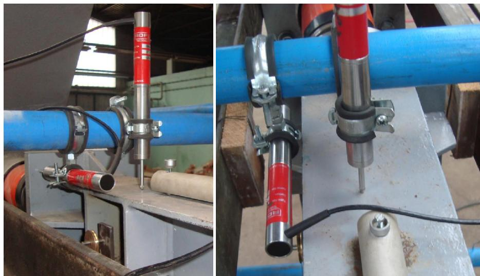
**Slika 4.31** - LVDT-i za mjerjenje horizontalnih i vertikalnih pomaka
