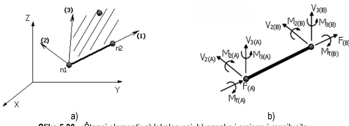
Slika 5.30 – Štapni elementi: a) lokalne osi, b) označke i smjerovi reznih sila
