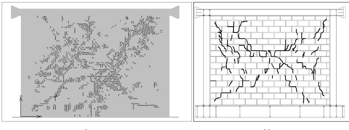
**Slika 5.65 – Raspored pukotina:** a) model okvira s glinenim zidanim ispunom pri međukatnom pomaku od 0,50 %, b) raspored pukotina ispitnog uzorka OG-1
