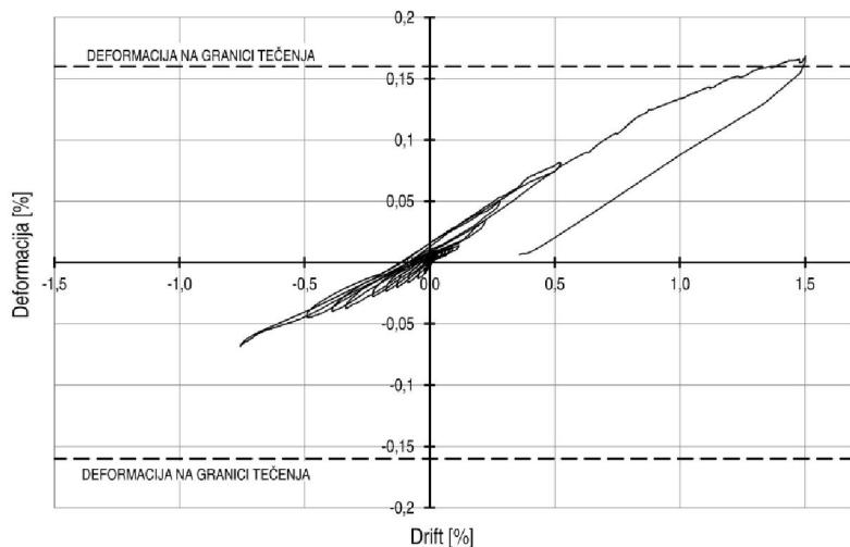
**Slika 4.47 – Deformacije pri dnu stupa – okvir OG-3**
