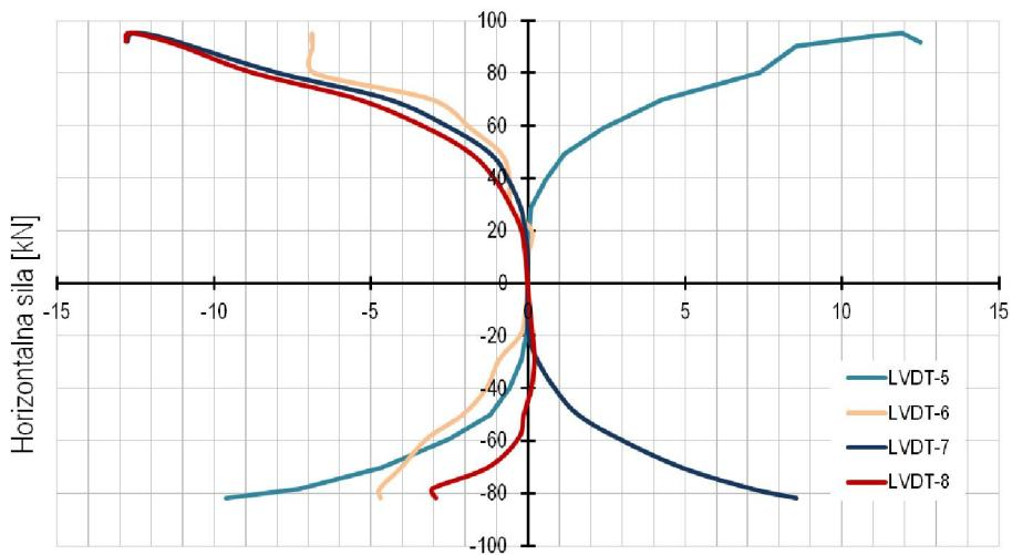
Dijagonalni pomak čeličnog okvira i zidanog ispuna [mm]
