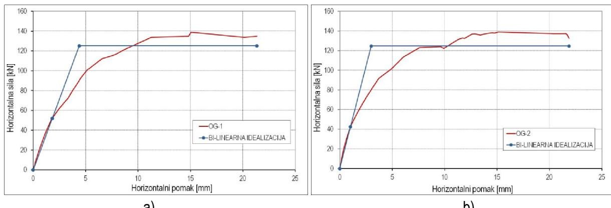
**Slika 8.2 – Eksperimentalna i idealizirana bi-linearna anvelopa nosivosti: a) uzorak OG-1, b) uzorak OG-2**
