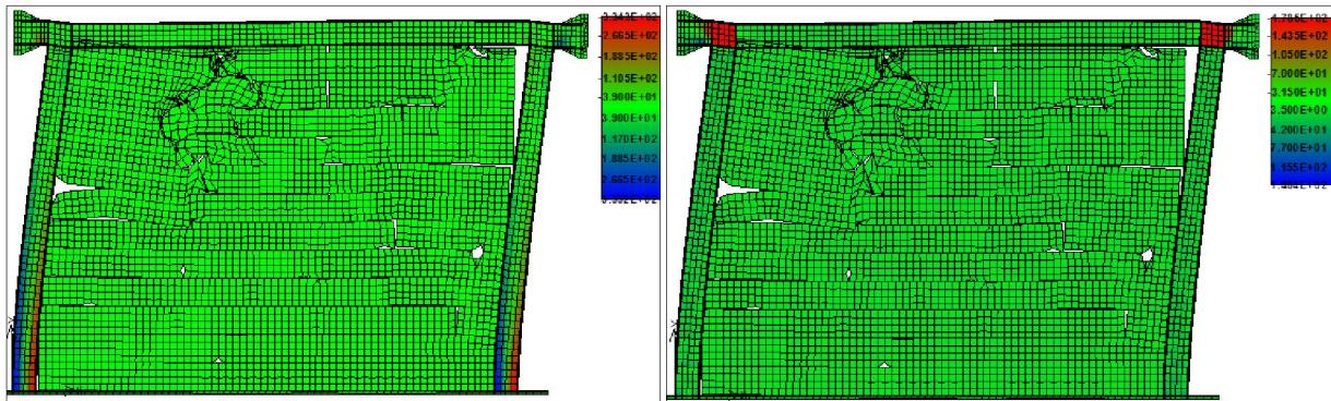
**Slika 5.89 – Normalna (a) i posmična naprezanja (b) u čeličnom okviru pri slomu**
