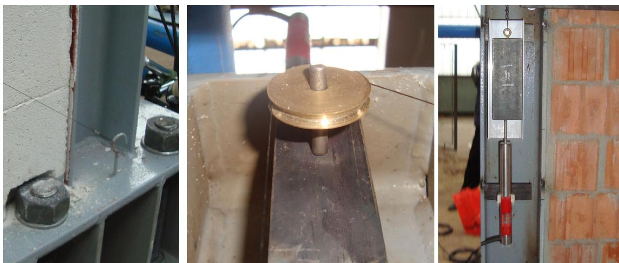
**Slika 4.33** - Mjerenje produljenja/skraćenja dijagonalna čeličnog okvira
