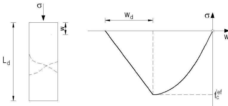
Slika 5.51 - Zakonitost omekšanja deformacija u tlaku
