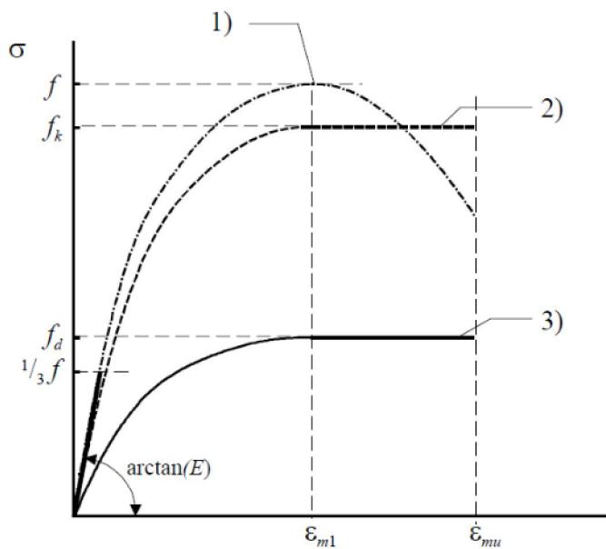
**Slika 3.4 - Odnos naprezanje-deformacija za tlačno opterećeno zidu**
