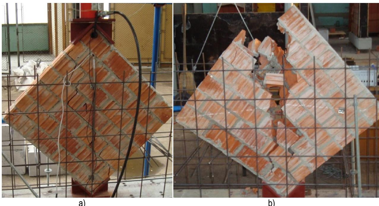
**Slika 4.23 – Ispitivanje vlačne čvrstoće ziđa od šupljih glinenih blokova: a) uzorak prije ispitivanja, b) uzorak nakon sloma**
