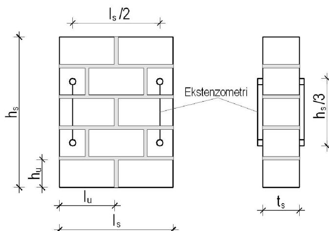
Slika 3.3–Uzorci zida za ispitivanje tlačne čvrstoće zida
