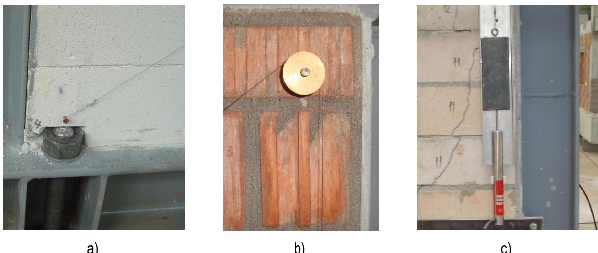
**Slika 4.32** - Mjerjenje produljenja/skraćenja dijagonala zidanog ispuna
