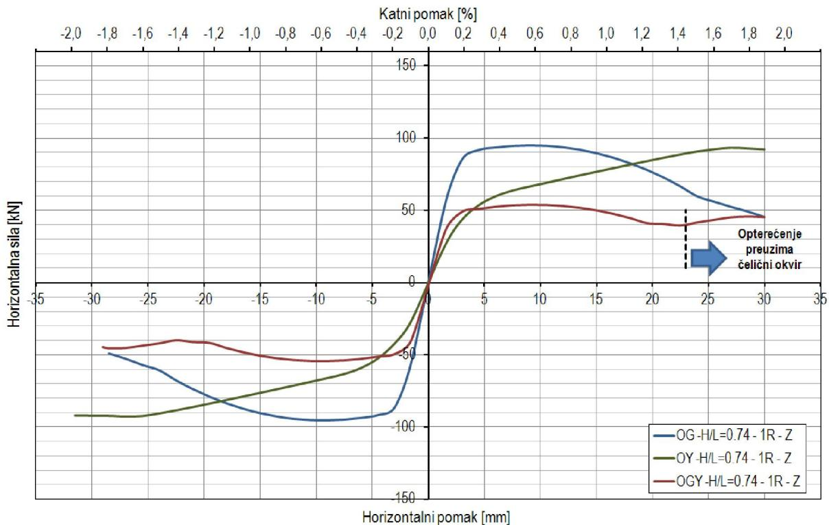
**Slika 6.33 - Nosivost čeličnih okvira sa zidanim ispunom – nominalno zglobni priključak (Z) –  $H/L=0.74$ ;  $R=1$ ; glineni (OG), porobetonski (OY) i kombinirani ispun (OGY)**
