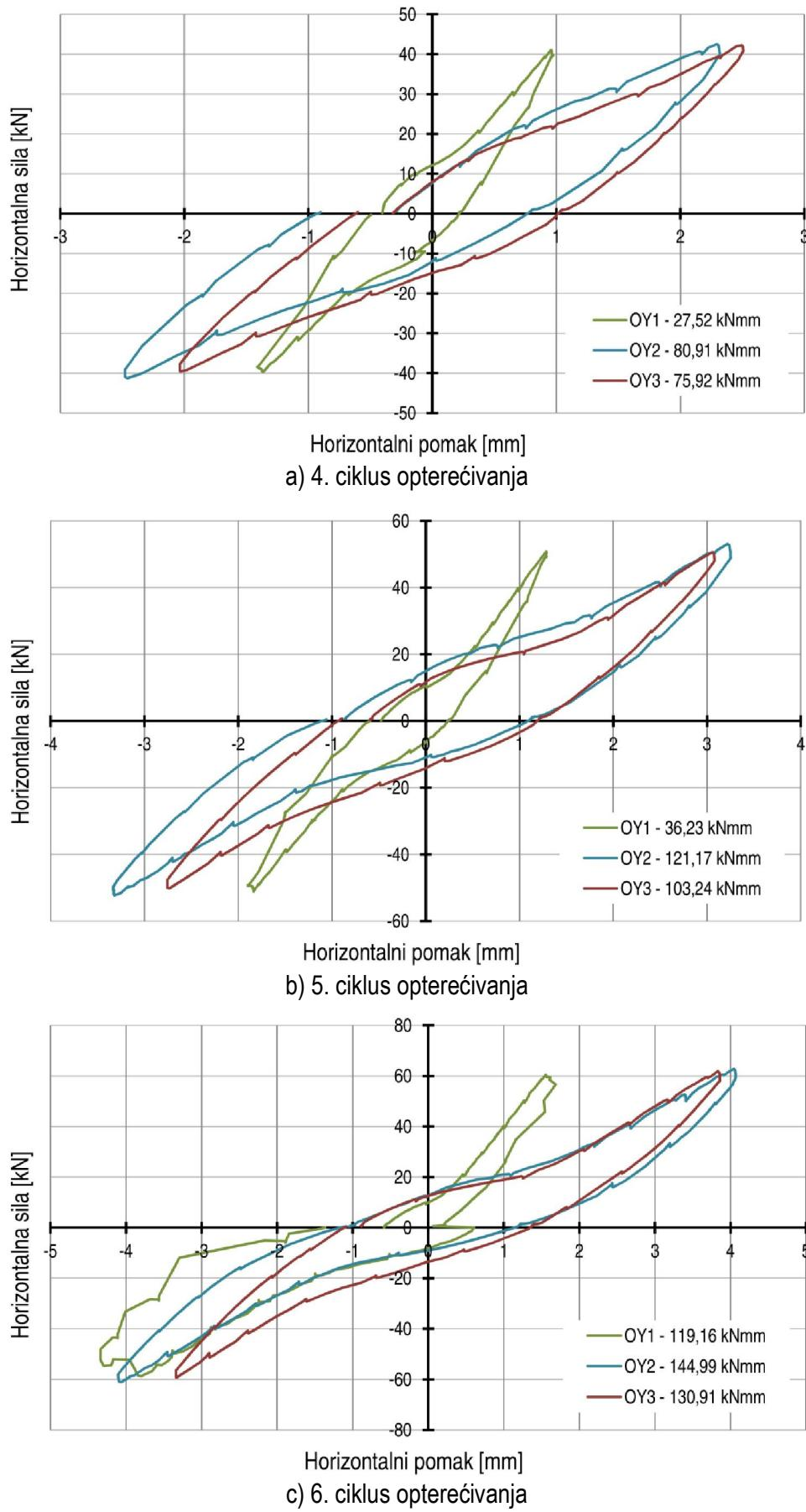
**Slika B7 – Disipacija energije okvira s porobetonskim ispunom: a) 4. ciklus, b) 5. ciklus i c) 6. ciklus opterećivanja**
