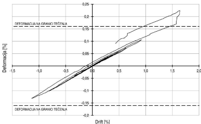
**Slika 4.56 – Deformacije pri dnu stupa – okvir OY-3**
