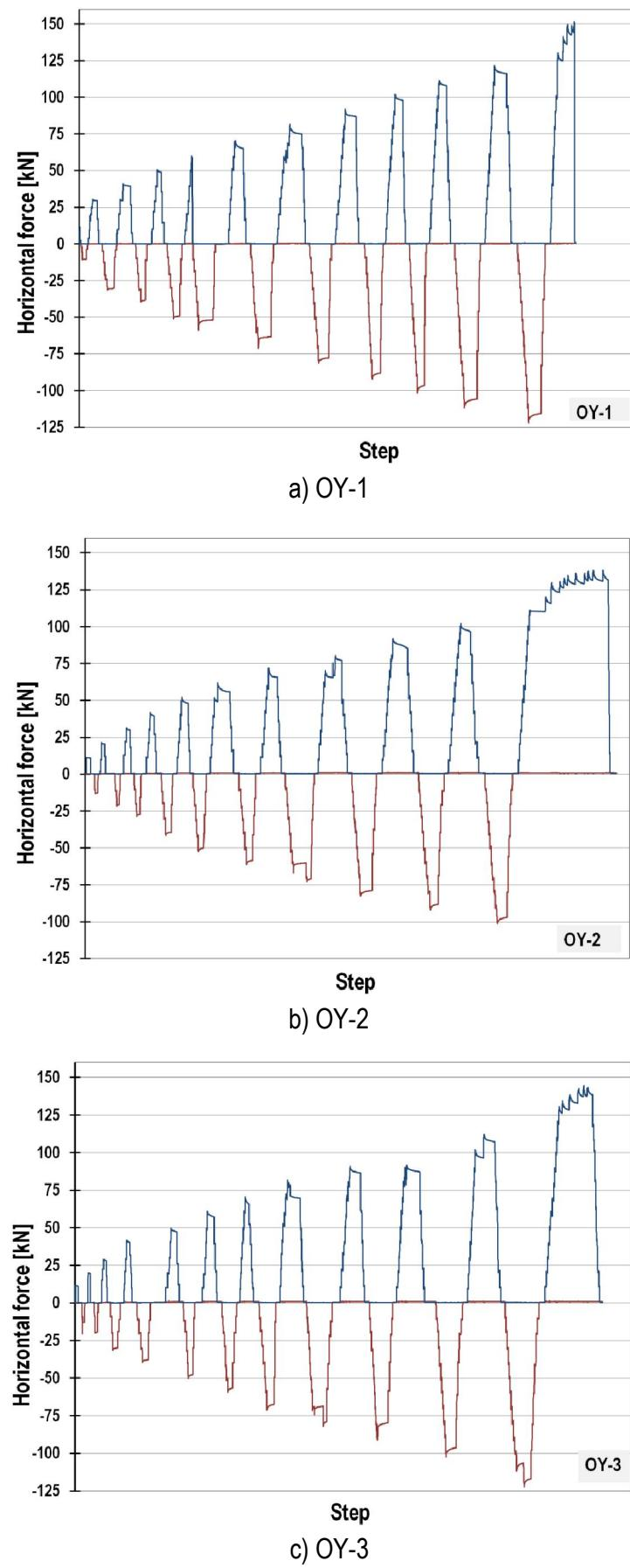
**Slika C2 – Opterećivanje okvira s porobetonskim ispunom: a) OY-1, b) OY-2 i c) OY-3**
