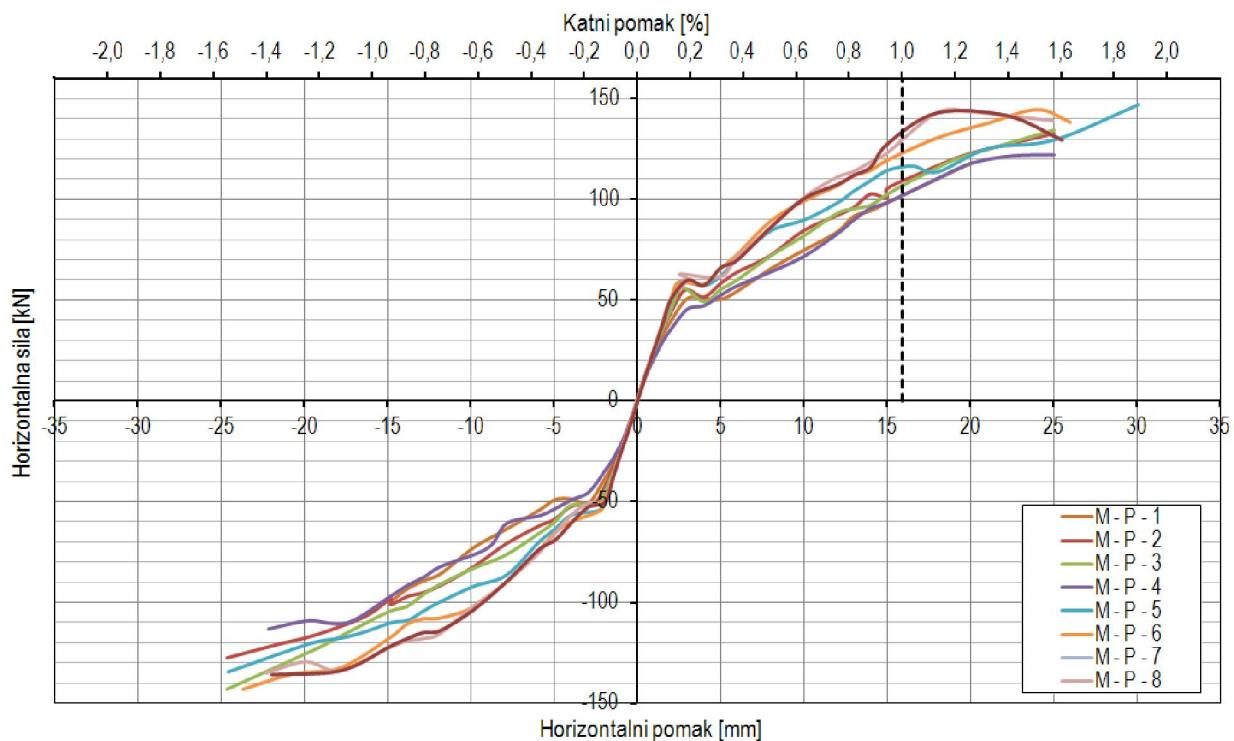
**Slika 6.38** - Nosivost čeličnih okvira s kombiniranim ispunom – varijacije kvalitete porobetonskih elemenata – 1, 2, 3, 4, 5, 6, 7, 8
