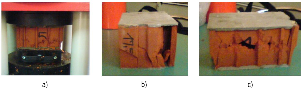
**Slika 4.4 – Ispitivanje tlačne čvrstoće zidnih elemenata: a) zidni element u tlačnoj preši, b) i c) zidni elementi nakon sloma**
