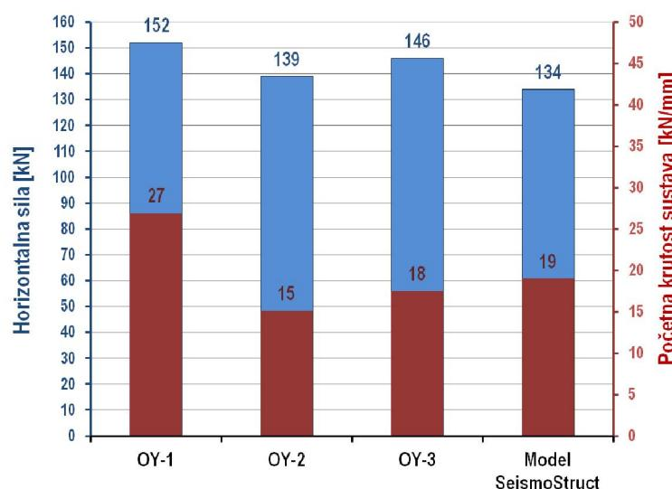
**Slika 5.37 – Nosivost i krutost ispitivanih okvira OY-i i modela izrađenog u *SeismoStruct*-u**
