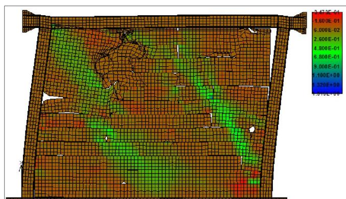
**Slika 5.87** – Posmična naprezanja u porobetonskom ispunu pri slomu
