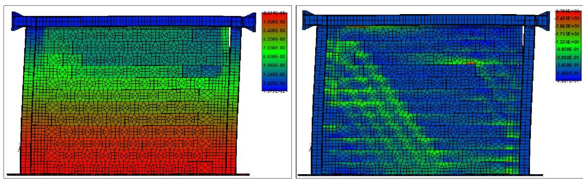
**Slika 5.101** – Horizontalni pomaci okvira (a) i normalna naprezanja (b) u kombiniranom ispunu pri međukatnom pomaku od 1,0 %
