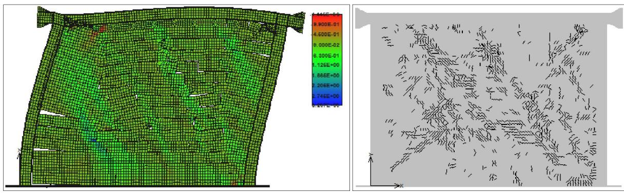
**Slika 5.67 – Posmična naprezanja (a) i raspored pukotina (b) u glinenom zidanom ispunu pri međukatnom pomaku od 1,0 %**
