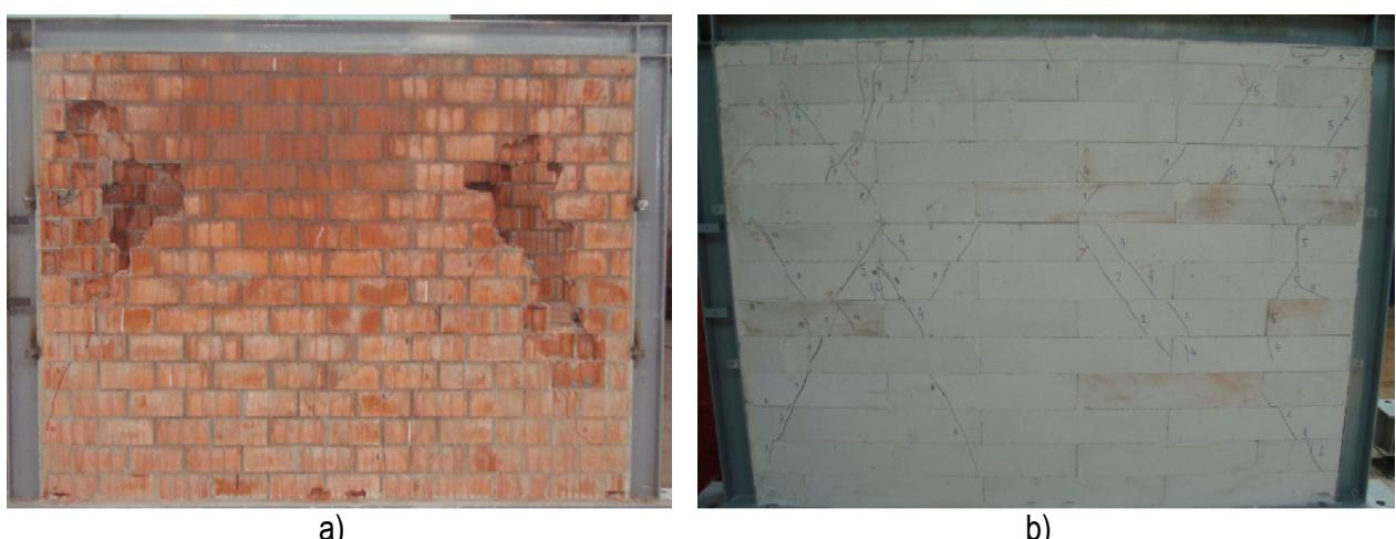
**Slika 4.74 – Oštećenja okvira sa zidanim ispunom: a) okvir OG-3, b) okvir OY-1**
