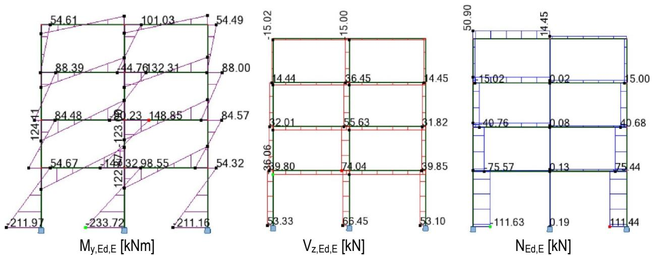
**Slika D9 - Dijagrami unutarnjih sila uslijed potresa**
