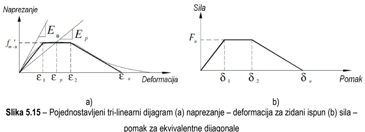
**Slika 5.15 – Pojednostavljeni tri-linearni dijagram (a) naprezanje – deformacija za zidani ispun (b) sila – pomak za ekvivalentne dijagonale**
