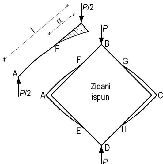
Slika 2.2 – Kontaktna duljina i raspodjela naprezanja na kontaktu okvira i ispuna
