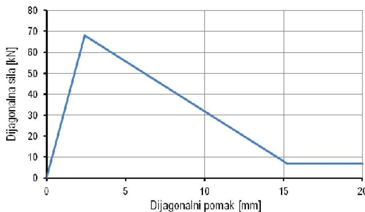
**Slika 5.10 – Anvelopa nosivosti kombiniranog zidanog ispuna**
