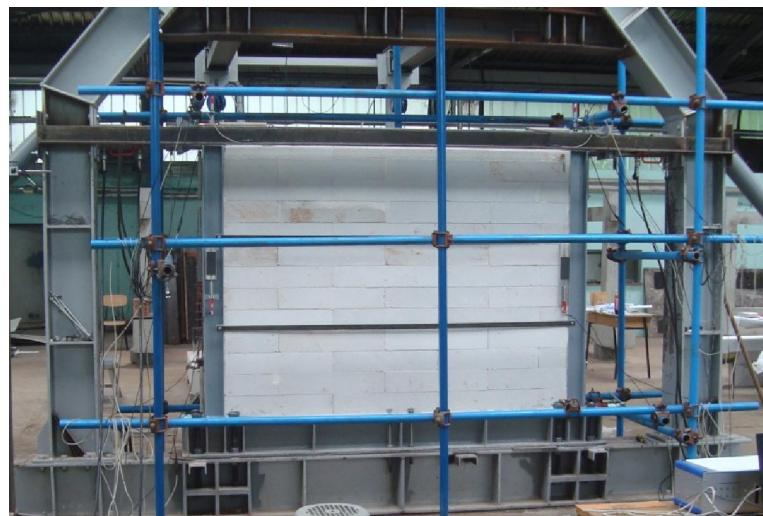
**Slika 4.36** - Ispitivanje čeličnog okvira sa zidanim ispunom od porobetonskih blokova (OY-i)
