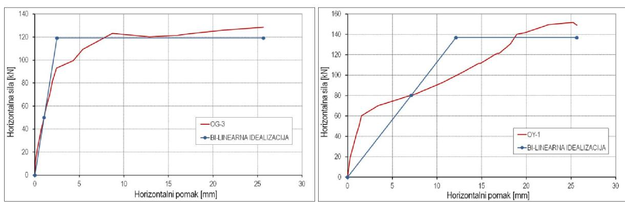
**Slika 8.3 – Eksperimentalna i idealizirana bi-linearna anvelopa nosivosti: a) uzorak OG-3, b) uzorak OY-1**
