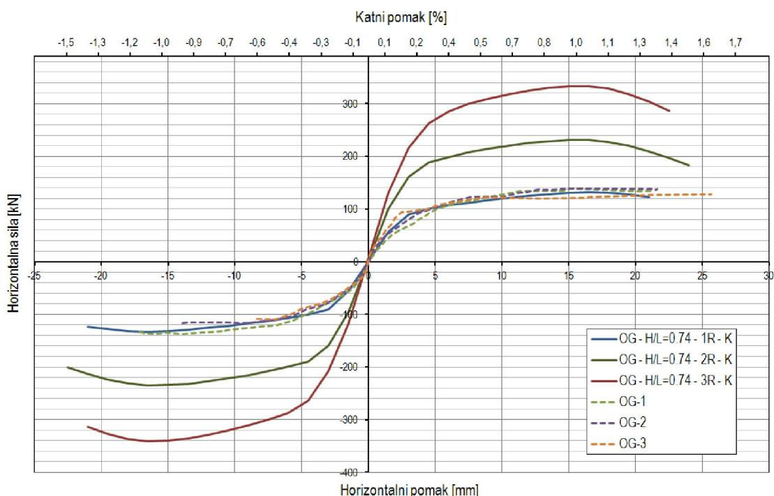
Slika 6.7 – Nosivost čeličnih okvira s glinenim zidanim ispunom – nepopustljivi priključak (K),  $H/L=0,74$ ;
