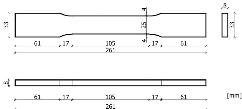
Slika 4.13 – Geometrija čeličnih epruveta osnovnog materijala
