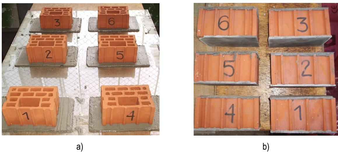
**Slika 4.3 – Priprema šupljih glinenih zidnih elemenata za ispitivanje tlačne čvrstoće**
