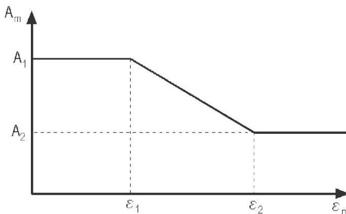
**Slika 5.29 – Smanjenje površine ekvivalentne dijagonale uslijed pukotina**
