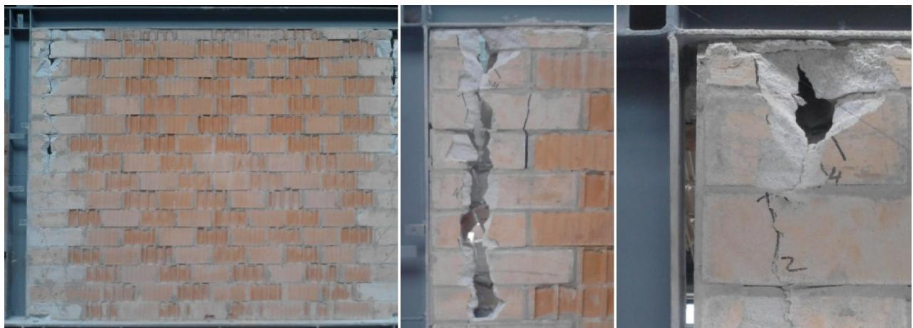
Slika 4.78– Oštećenja okvira sa zidanim ispunom – OGY-3
