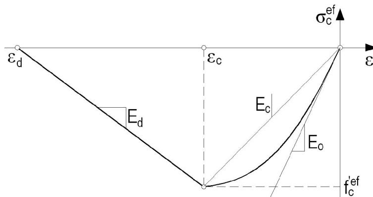
**Slika 5.50** - Dijagram naprezanje-deformacija SBETA modela izloženog tlačnim naprezanjima
