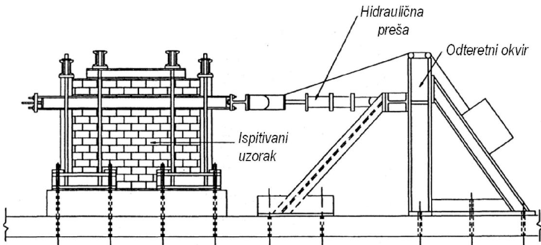
Slika 2.8 – Ispitivanje okvira s zidanim ispunom
