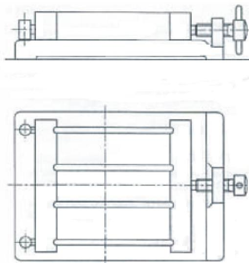
Slika 3.1 – Čelični kalup za izradu prizmi morta
