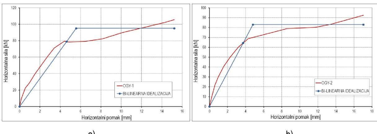
**Slika 8.5 – Eksperimentalna i idealizirana bi-linearna anvelopa nosivosti: a) uzorak OGY-1, b) uzorak OGY-2**
