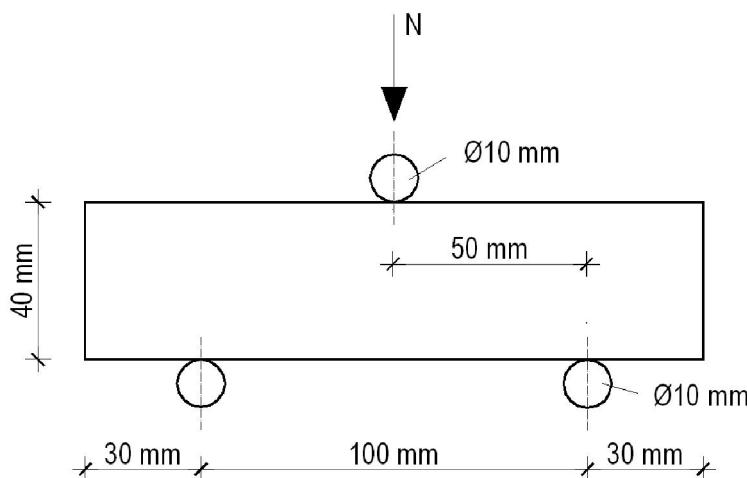
**Slika 3.2 – Ispitivanje prizmi morta na savijanje**
