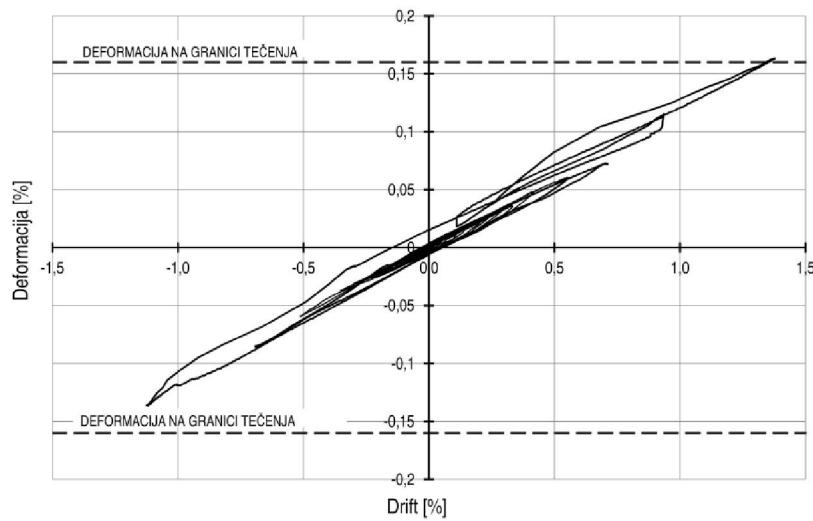
Slika 4.41 – Deformacije pri dnu stupa – okvir OG-1
