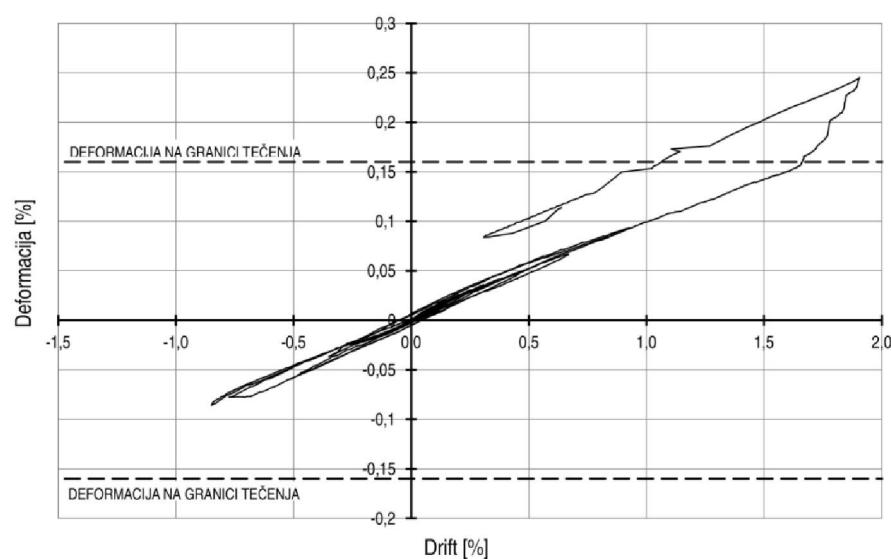
Slika 4.53 – Deformacije pri dnu stupa – okvir OY-2
