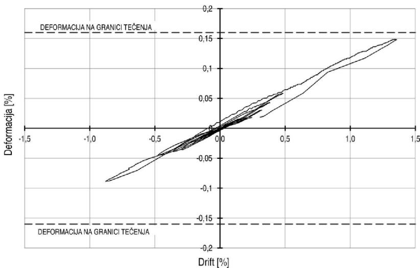
**Slika 4.44 – Deformacije pri dnu stupa – okvir OG-2**
