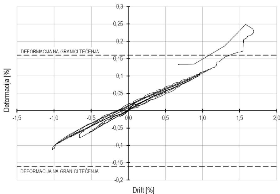
**Slika 4.50– Deformacije pri dnu stupa – okvir OY-1**
