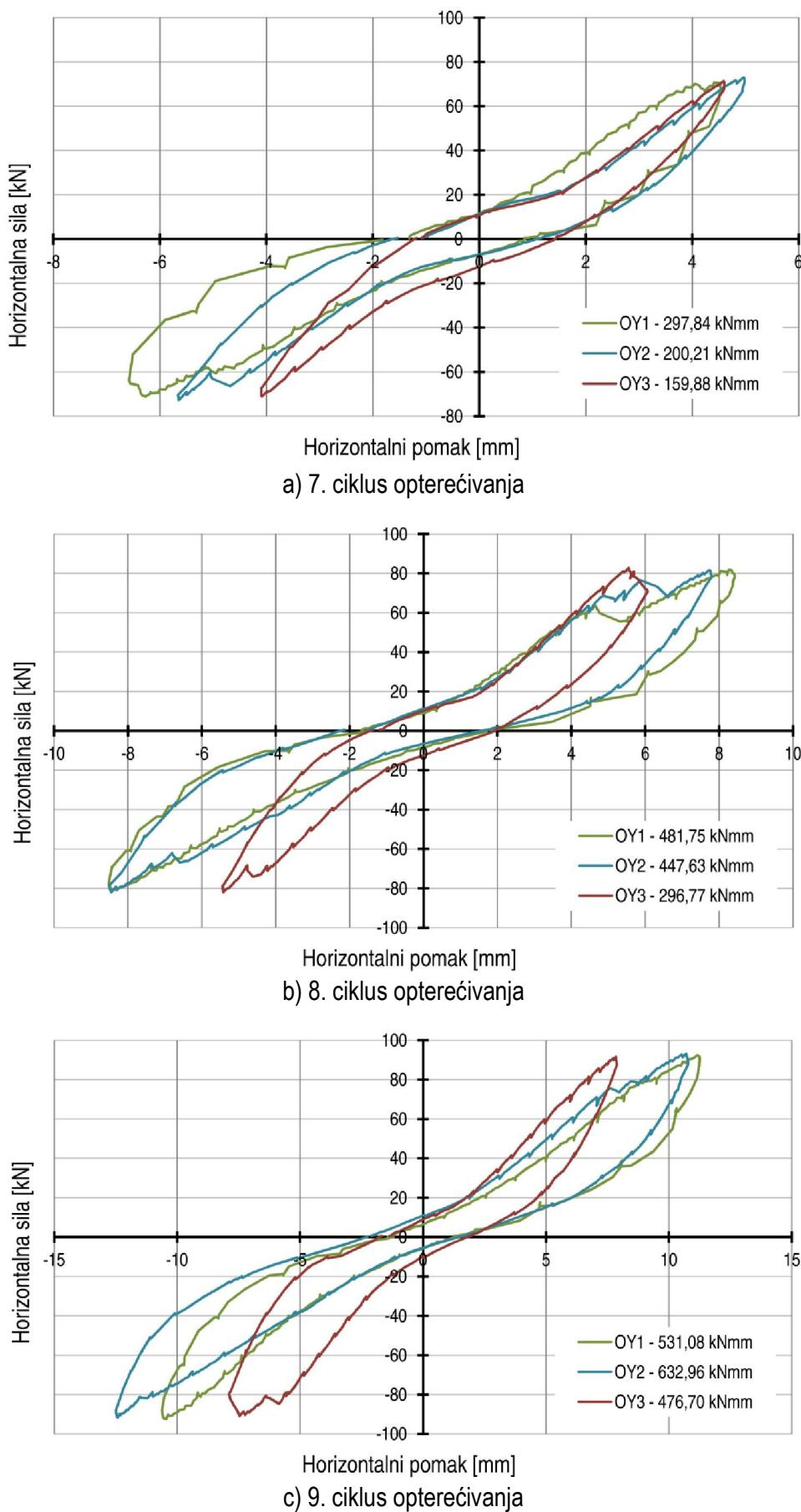
**Slika B8 – Disipacija energije okvira s porobetonskim ispunom: a) 7. ciklus, b) 8. ciklus i c) 9. ciklus opterećivanja**
