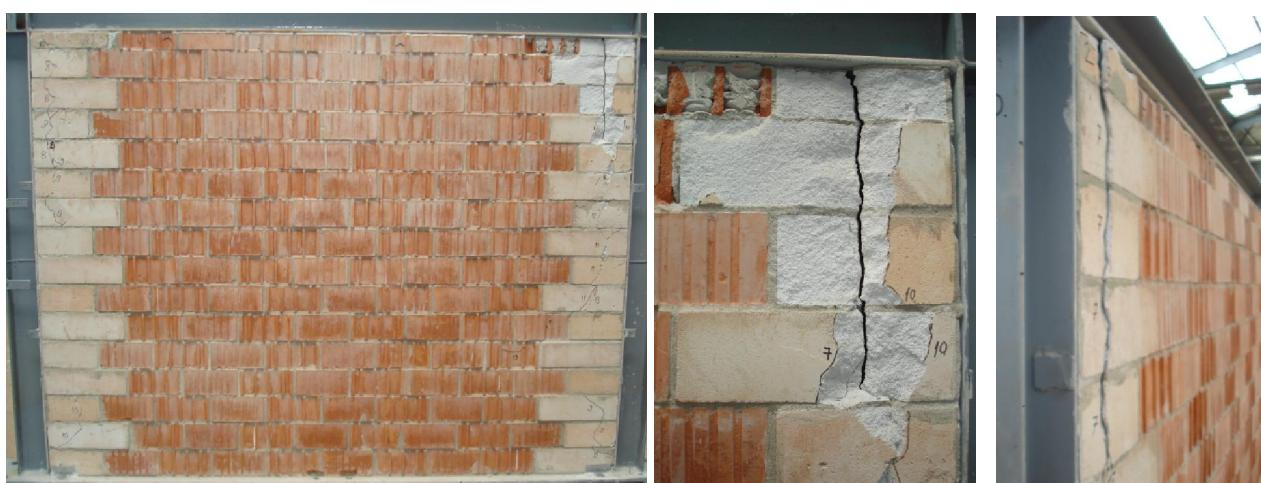
Slika 4.77– Oštećenja okvira sa zidanim ispunom – OGY-2
