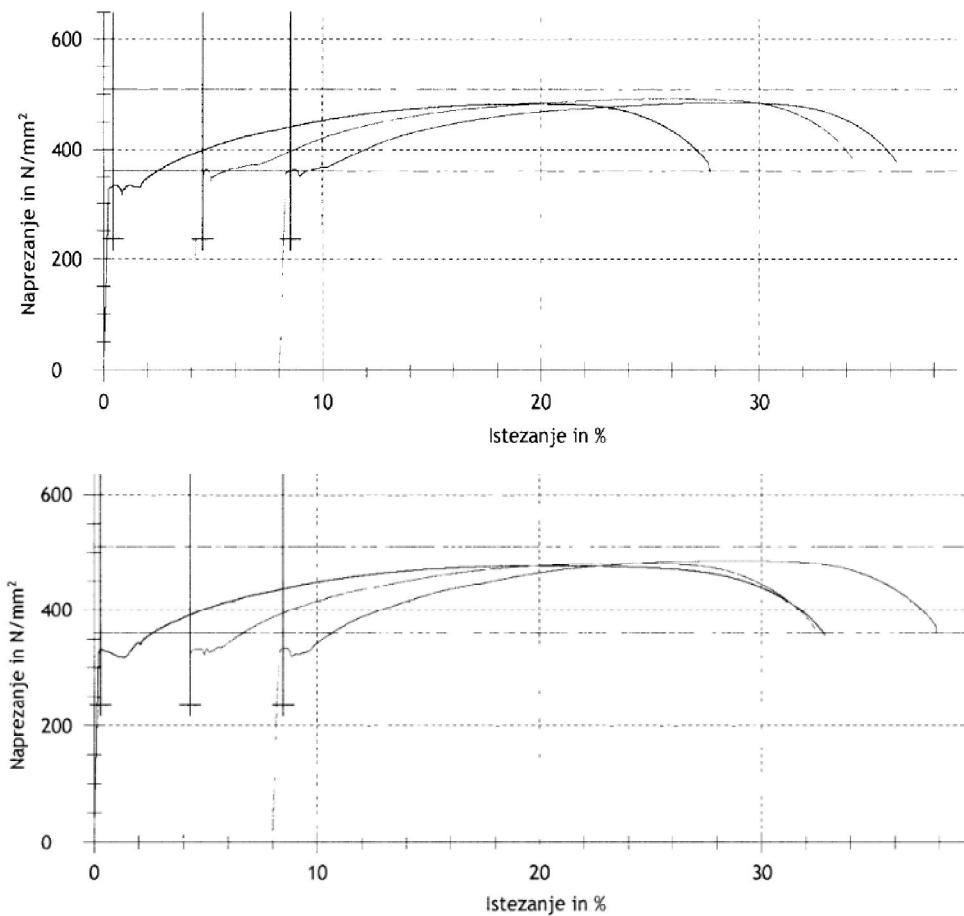
Slika 4.14 – Radni dijagrami čelika dobiveni ispitivanjem
