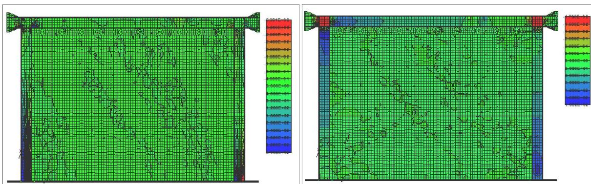
**Slika 5.70 – Normalna (a) i posmična naprezanja (b) u čeličnom okviru pri slomu**
