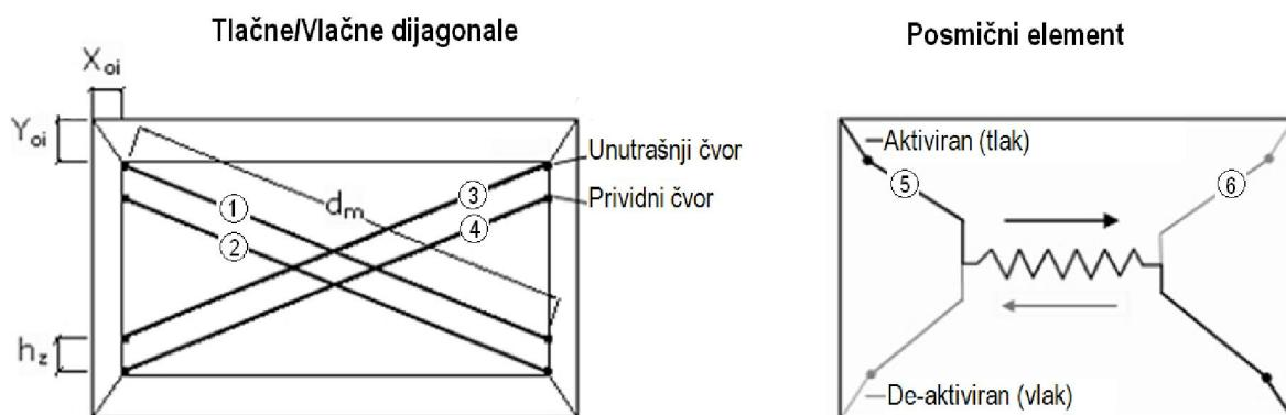
Slika 5.28 – Panel element – tlačne/vlačne i posmične dijagonale
