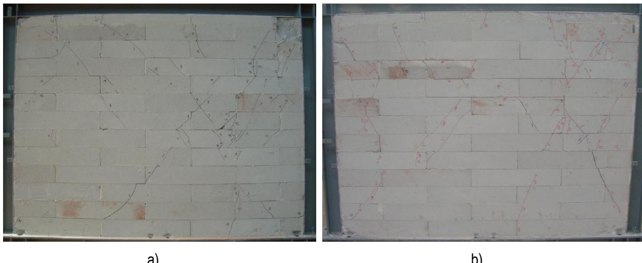
Slika 4.75 – Oštećenja okvira sa zidanim ispunom: a) okvir OY-2, b) okvir OY-3
