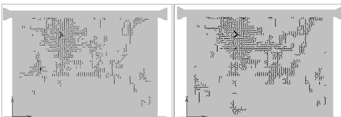
**Slika 5.85 – Raspored pukotina u porobetonskom zidanom ispunu pri međukatnom pomaku od 1,0 %**
