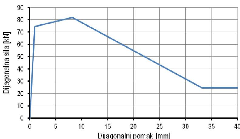
**Slika 5.7 – Anvelopa nosivosti zidanog ispuna od porobetonskih blokova**
