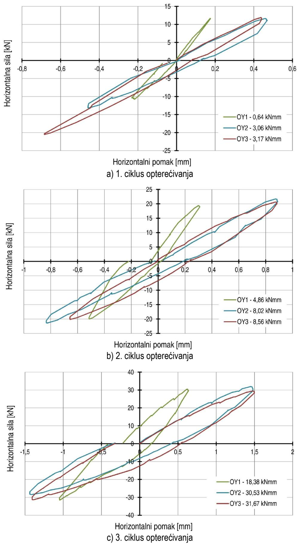
**Slika B6 – Disipacija energije okvira s porobetonskim ispunom: a) 1. ciklus, b) 2. ciklus i c) 3. ciklus opterećivanja**
