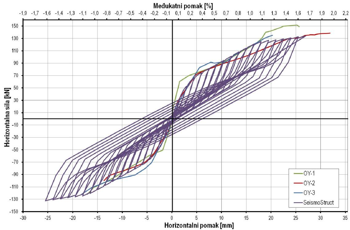
Slika 5.38 – Dijagram horizontalna sile - horizontalni pomak za okvire OY-i i model iz SeismoStruct-a
