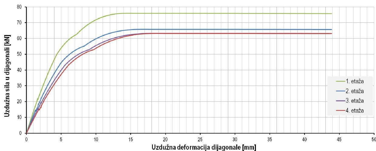
Slika 7.7 – Dijagram uzdužna sila u dijagonali – uzdužna deformacija porobetonorskog zidanog ispuna OY-N
