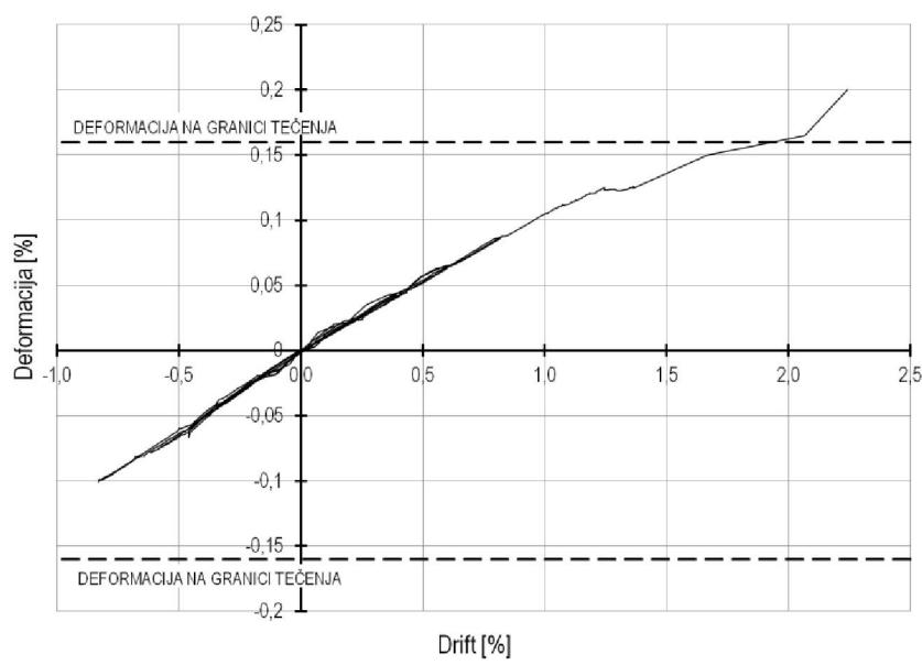
Slika 4.67 – Deformacije pri dnu stupa – okvir OS
