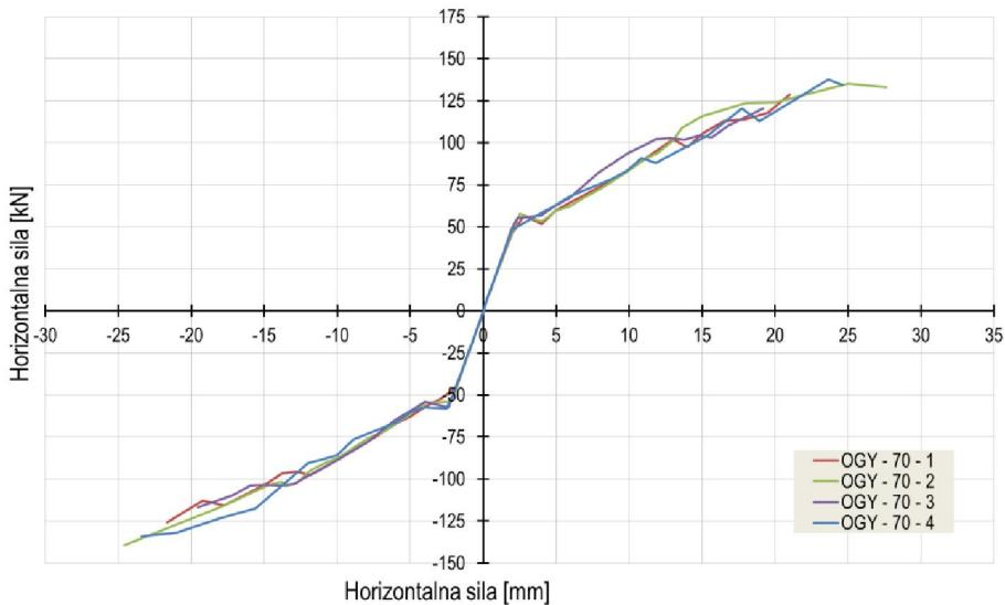
**Slika A70** - Nosivost čeličnih okvira s kombiniranim ispunom – varijacije kvalitete porobetonskih elemenata
