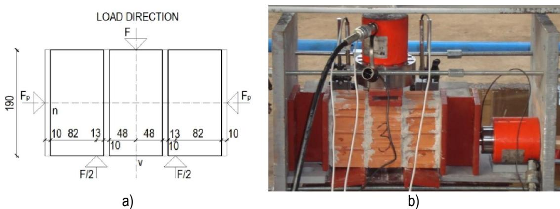
**Slika 4.19 – Ispitivanje posmične čvrstoće zidnih prizmi: a) dimenzije uzorka, b) postavke mjerne opreme**
