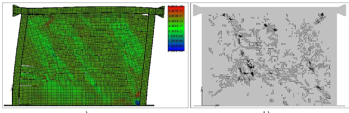
**Slika 5.69 – Posmična naprezanja (a) i raspored pukotina (b) u glinenom ispunu pri slomu**
