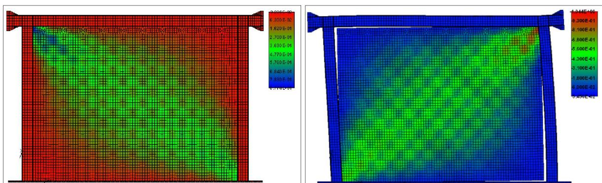
Slika 5.61 – Posmična naprezanja u glinem zidanome ispunu pri međukatnom pomaku od 0,10 %
