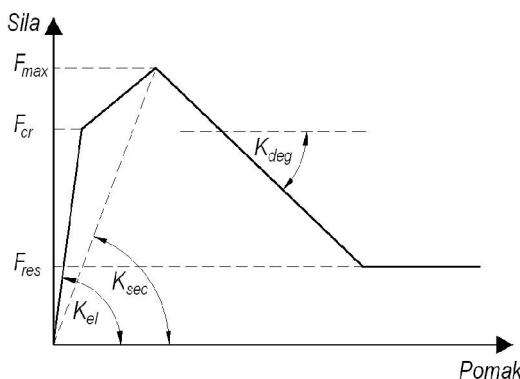
**Slika 5.1 – Anvelopa nosivosti zidnog ispuna prema [46]**
