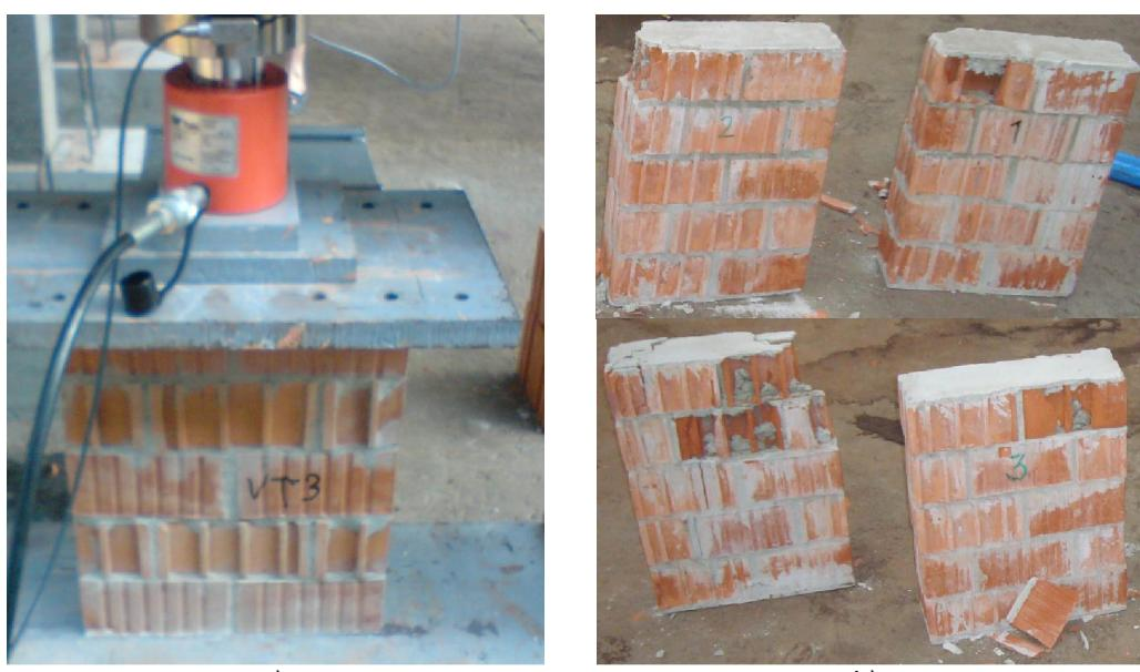
**Slika 4.16 – Ispitivanje tlačne čvrstoće šupljih glinenih blokova: a) Uzorak pri ispitivanju, b) uzorak od porobetona nakon sloma**
