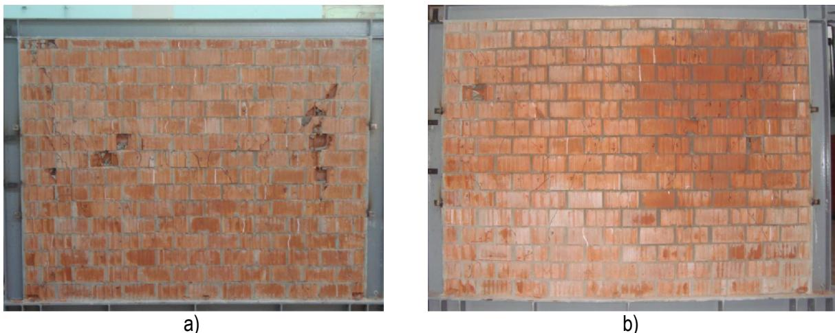
**Slika 4.73 – Oštećenja okvira sa zidanim ispunom: a) okvir OG-1, b) okvir OG-2**
