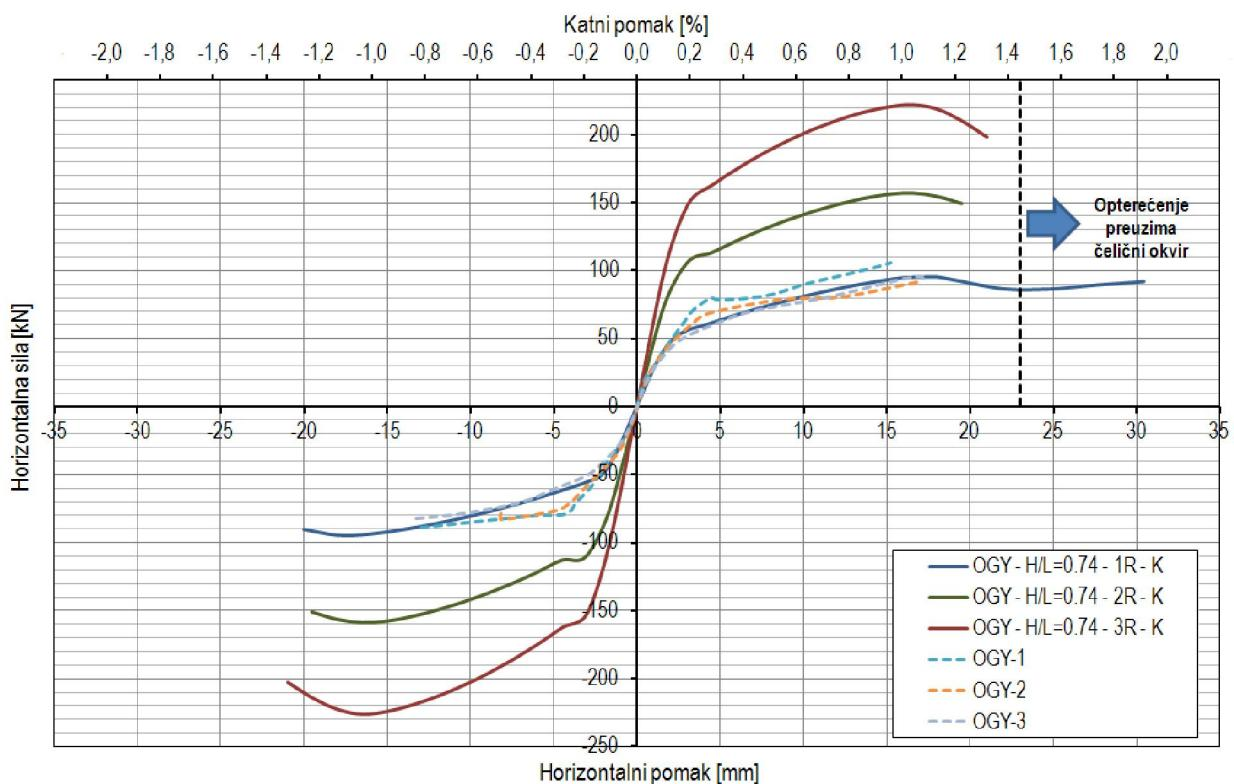
Slika 6.22 – Nosivost čeličnih okvira s kombiniranim zidanim ispunom – nepopustljivi priključak (K),
