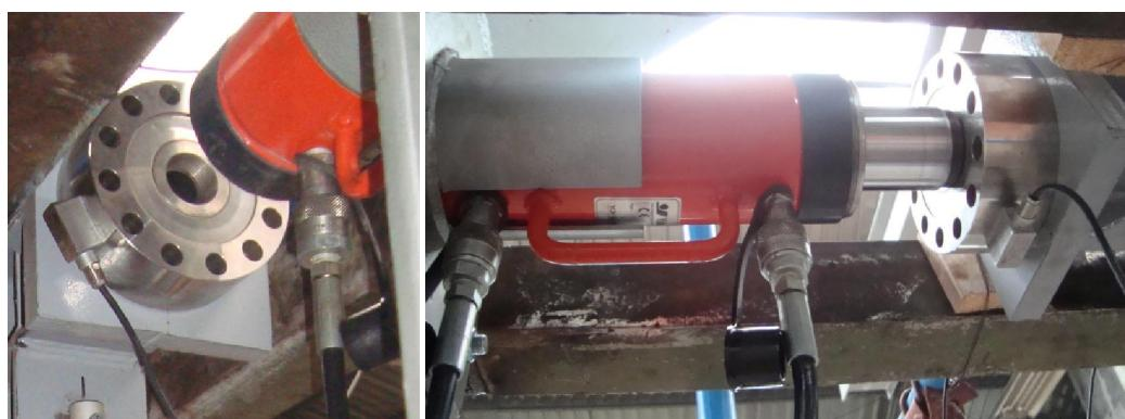
**Slika 4.27 – Unošenje opterećenja u čelični okvir**
