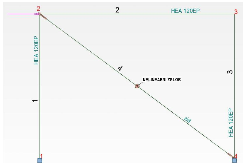
Slika 5.2 – Štapni model s jednom zamjenskom dijagonalom
