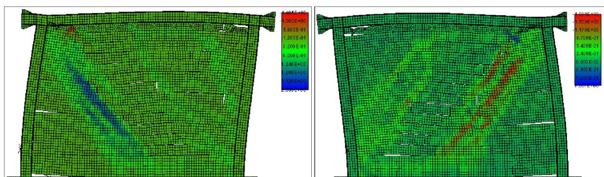
Slika 5.64 – Posmična naprezanja u glinem zidanom ispunu pri međukatnom pomaku od 0,50 %
