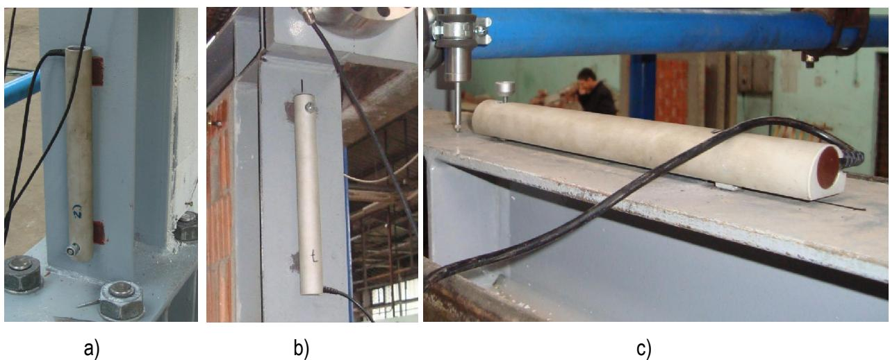
**Slika 4.34** - Mjerenje relativnih deformacija čeličnog okvira
