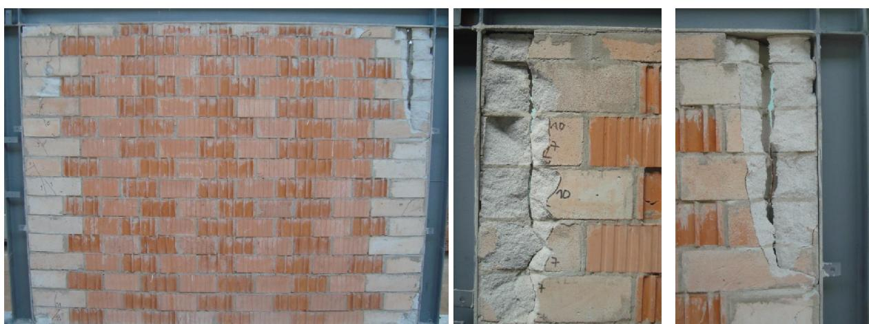
Slika 4.76 – Oštećenja okvira sa zidanim ispunom – OGY-1
