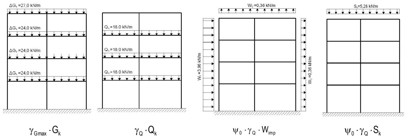
Slika D4 - Shema opterećenja za mjerodavnu kombinaciju
