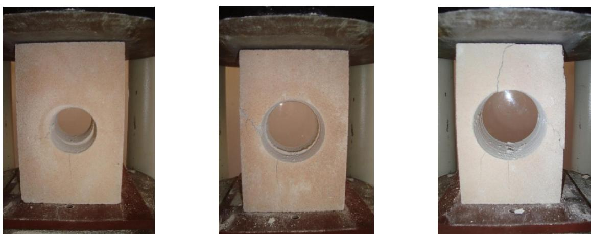
**Slika 4.8– Ispitivanje izbušenih porobetonskih blokova**
