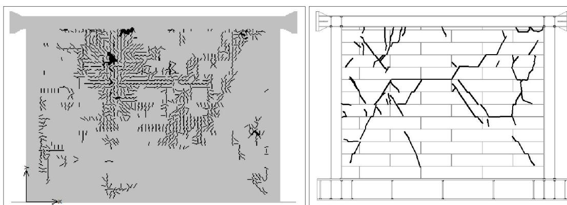
**Slika 5.88** – Raspored pukotina: a) model okvira s porobetonskim zidanim ispunom pri slomu, b) raspored pukotina ispitnog uzorka OY-1
