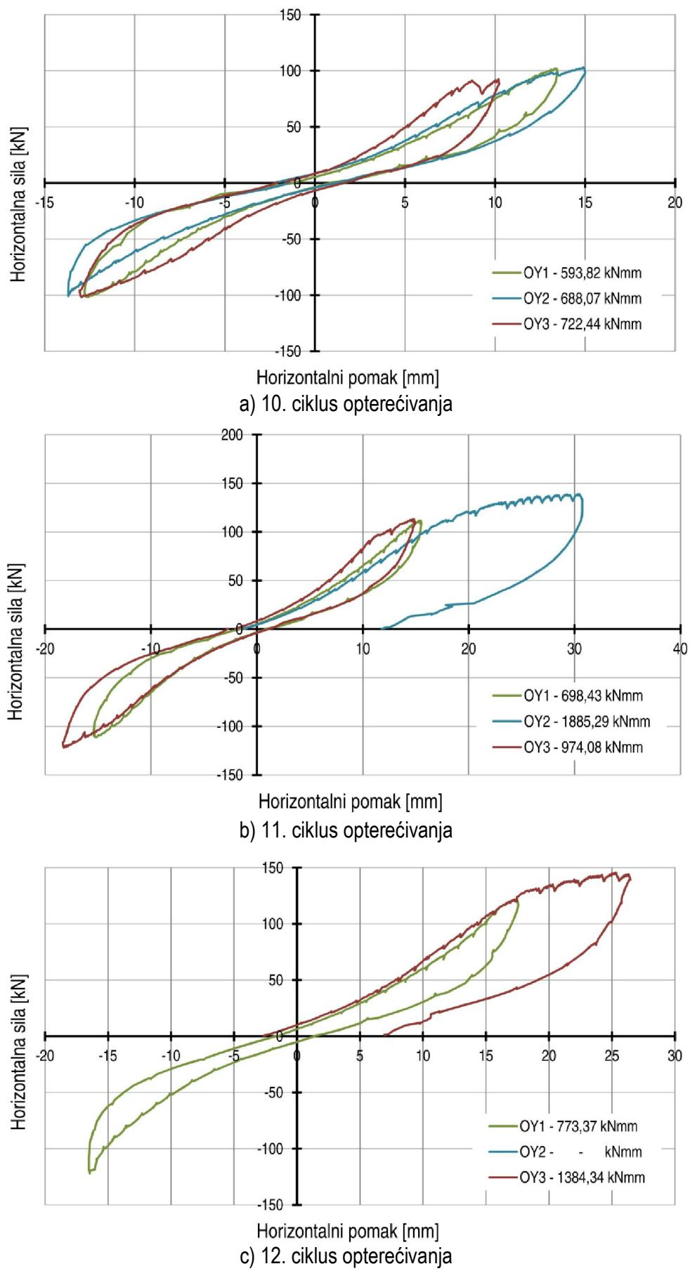
**Slika B9 – Disipacija energije okvira s porobetonskim ispunom: a) 10. ciklus, b) 11. ciklus i c) 12. ciklus opterećivanja**
