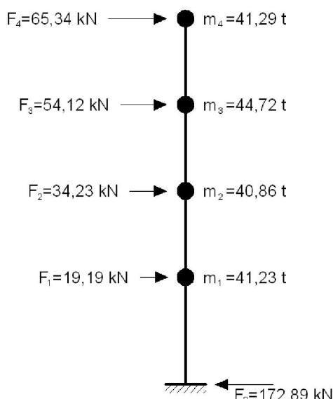
**Slika D8 - Prikaz potresnih sila po visini konstrukcije**
