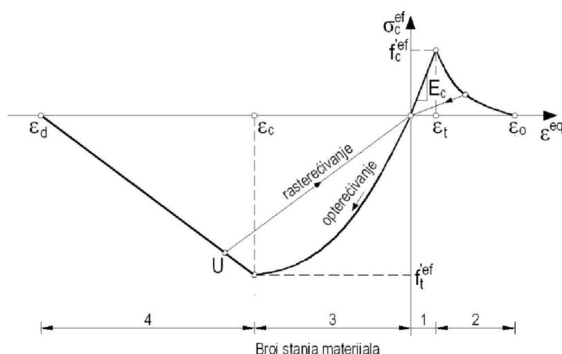
Slika 5.44 - Jednoosni dijagram naprezanje-deformacija za beton
