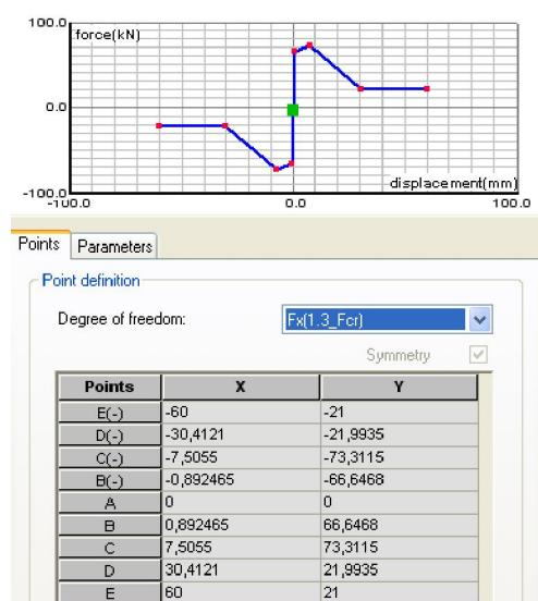
Slika 5.3 – Zadavanje nelinearnog zgloba - Autodesk Robot Structural Analysis
