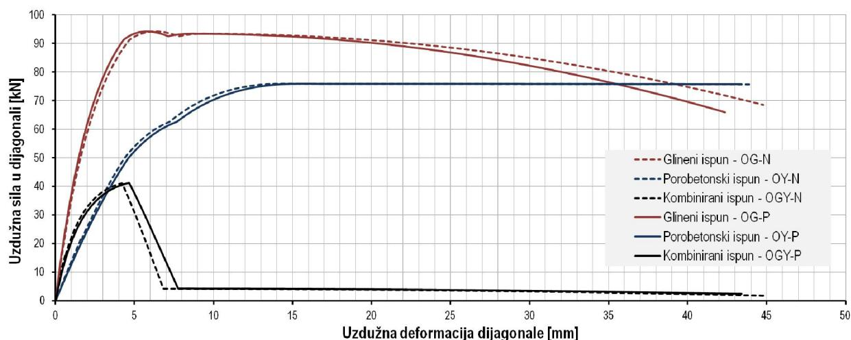
Slika 7.18 - Dijagrami uzdužna sile u dijagonali – uzdužna deformacija zidanih ispuna OG-i, OY-i i OGY-i
