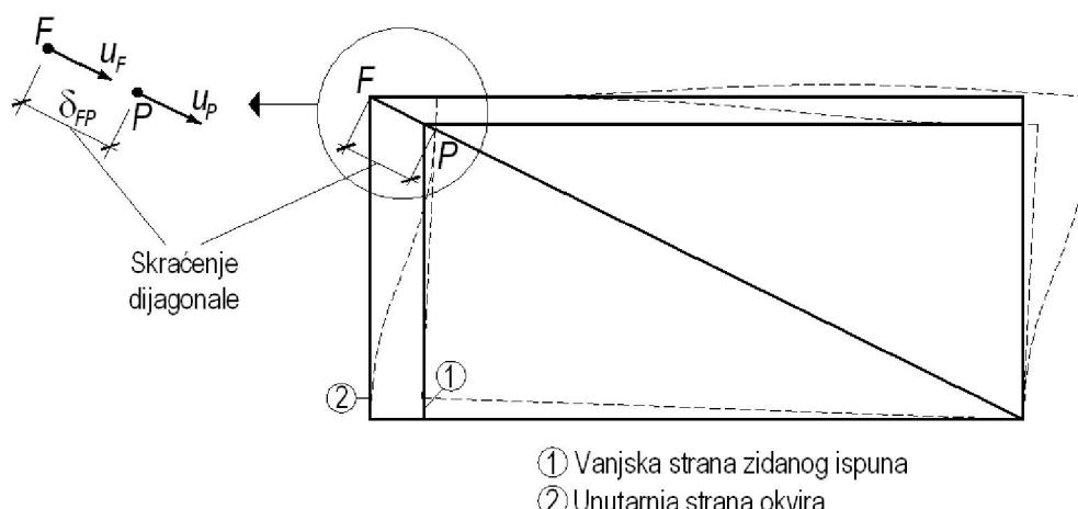
**Slika 2.4 – Model zidanog ispuna prema [16]**
