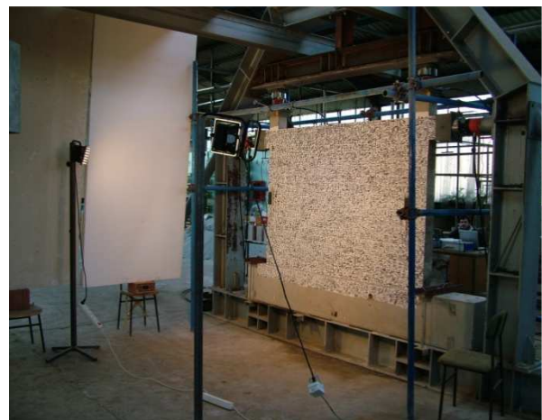
Slika 6.5 Osvjetljenje ispitnog uzorka
