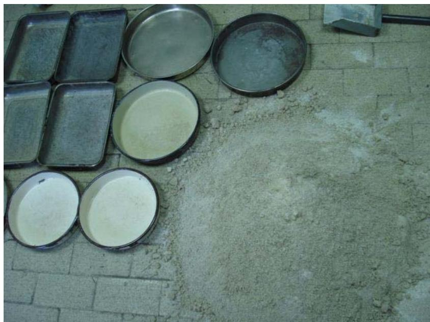
*Slika 6-6: Homogenizirani i pripremljeni uzorak za ispitivanje*
