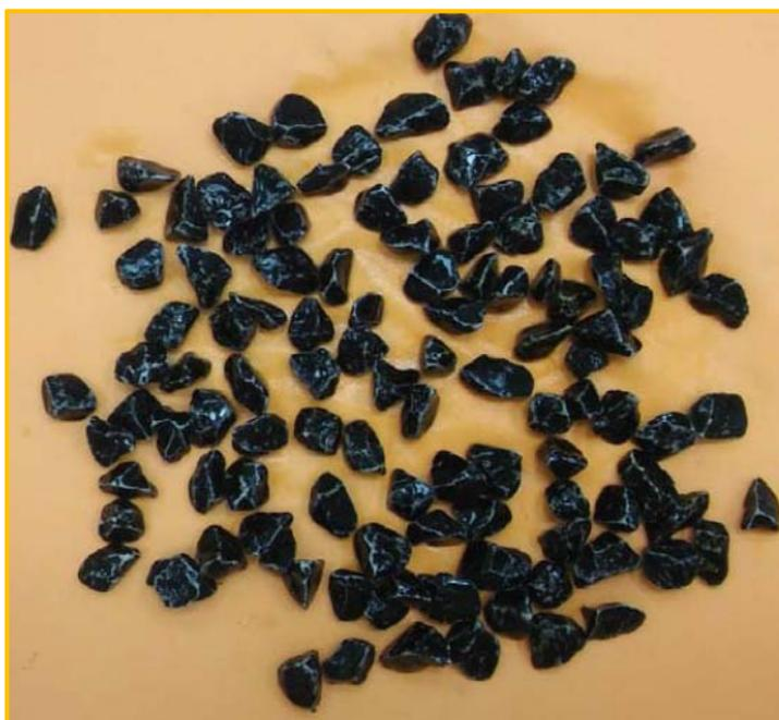
*Slika 7-19: Uzorak nakon 6 sati ispitivanja prionjivosti agregata i bitumena*
