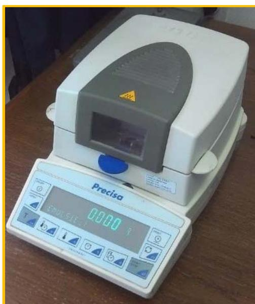
*Slika 6-25: Uređaj za ispitivanje vlažnosti*
