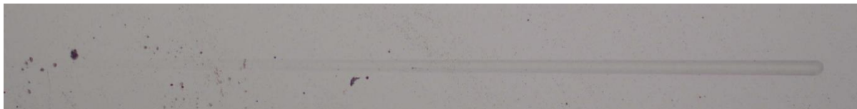
Slika 5.84 Trag trošenja na uzorku SH-10-B-2 pri ispitivanju brazdanjem
