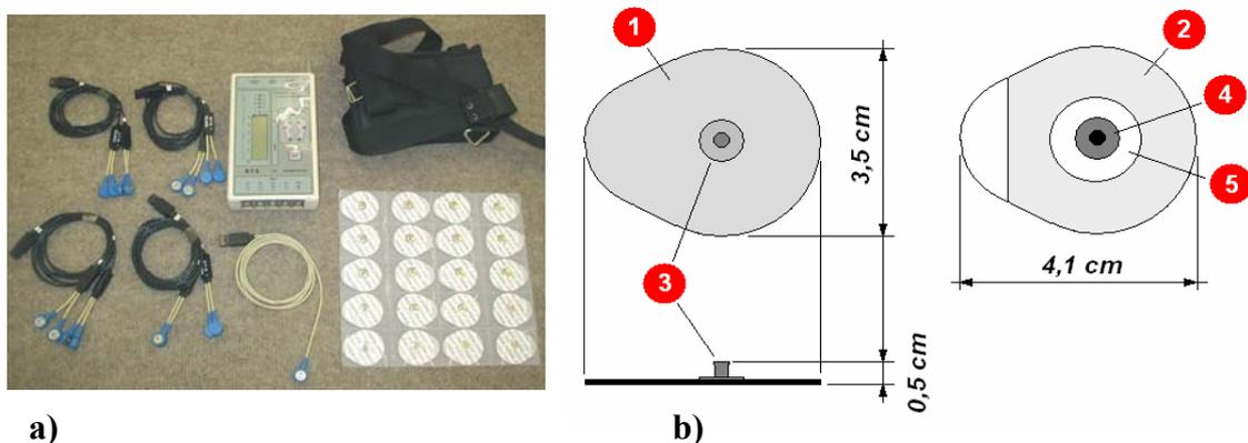
**Slika 17.** Prikaz EMG elektroda i prijenosne jedinice:
