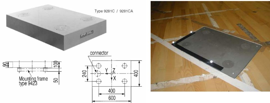
**Slika 19.** Platforma KISTLER 9821 za mjerenje sila reakcije podloge.
