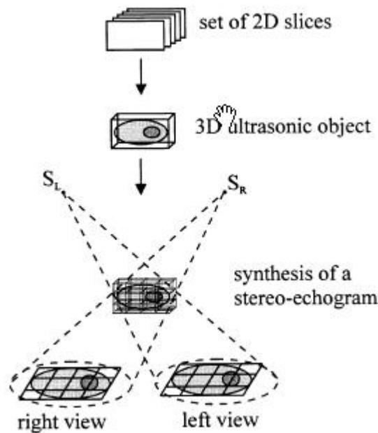
**Slika 2.** Princip primjene stereoskopskog predodjenja trodimenzionalnog objekta [13].
