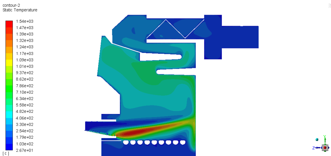
a) temperaturna polja u centralnom presjeku
