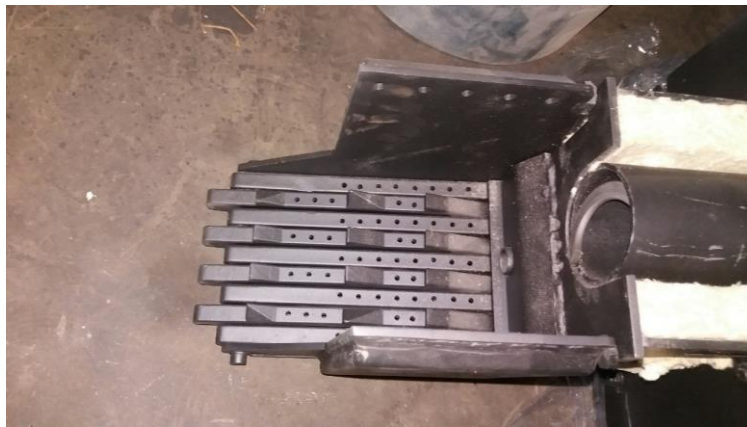
Slika 100. Plamenik s pomičnom rešetkom [92]
