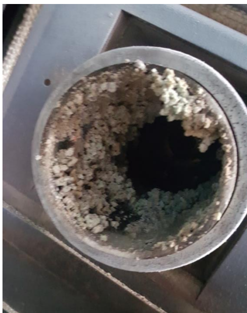
Slika 102. Nakupljanje i lijepljenje pepela na rešetki plamenika
