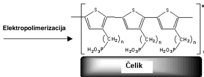
**Slika 2.** Shematski prikaz elektropolimerizacije nanešenog monosloja [7]
