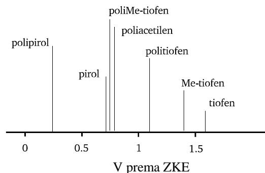
**Slika 27.** Oksidacijski potencijali nekih odabralih primjera monomera i njihovih odgovarajućih polimera (ZKE je zasićena kalomel elektroda).
