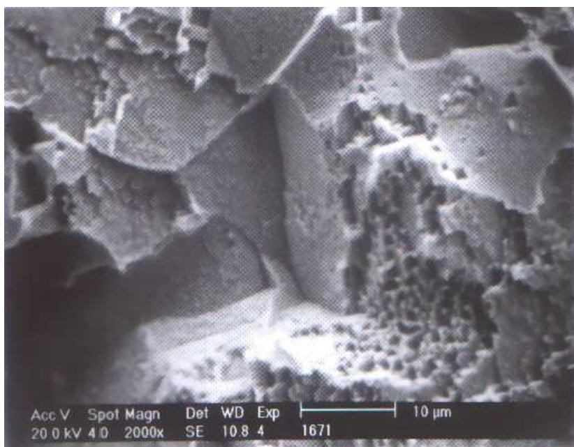
**Slika 77.** Željezna elektroda nakon obrade u  $\text{HNO}_3$  i nanošenja BTHPS monosloja (2000x); vidljivi tragovi nagrizanja kiseline
