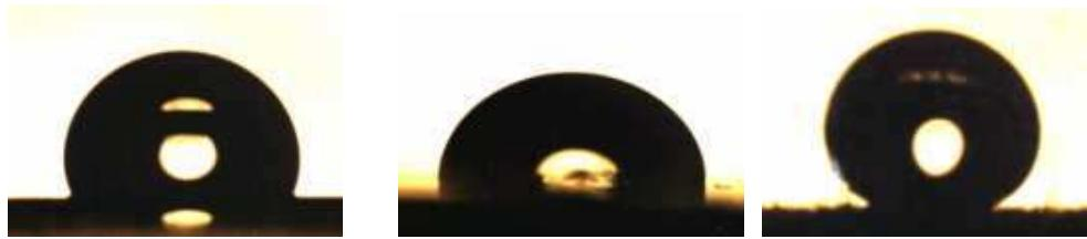
a) Voda na netretiranoj FEP
