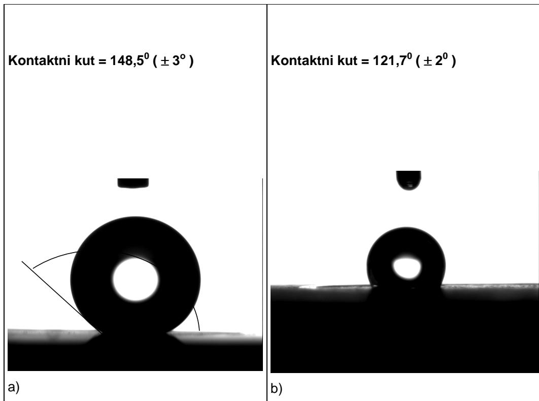
**Slika 58.** Kontaktni kut površine željezne elektrode (predobrađene u dušičnoj kiselini) nakon nanošenja sloja SOM-a iz dodecilfosfonske kiseline [ DPS ] (lijevo), te iz bitiofen heksanfosfonske kiseline [ BTHPS ] (desno) .
