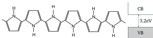
Slika 28. Nedopirano stanje polipirola - loš električni vodič
