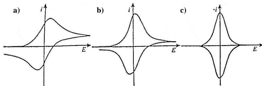
**Slika 50.** Shematski prikaz voltametrijskog ponašanja kod elektroaktivnih polimernih filmova: (a) debeli filmovi / velika brzina promjene potencijala, otežani protok naboja uzrokuje kvazi difuzijsku prirodu (b) srednja situacija s obzirom na debljinu sloja i brzinu promjene potencijala, prisutni efekti koncentracijske polarizacije; (c) debeli film / mala brzina promjene potencijala, nema koncentracijske polarizacije redoks mesta u filmu [35].
