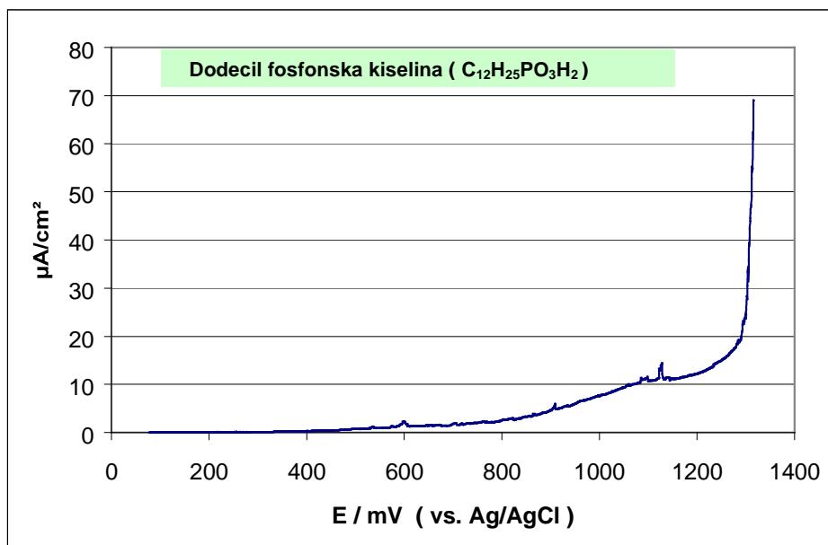
Slika 54. Krivulja gustoće struje i potencijala željezne elektrode (predobrada u dušičnoj kiselini) dobivena u 0,1 M  $\text{NaClO}_4$  s prethodno odstranjenim kisikom uz 50 mV  $\text{min}^{-1}$  nakon nanesenog SOM-a s dodecil fosfonskom kiselinom.
