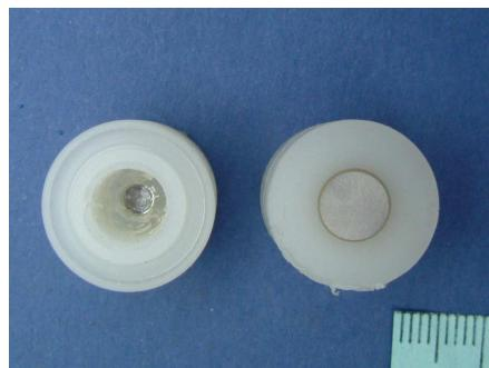
**Slika 51.** Pripremljene željezne elektrode u teflonskim držaćima
