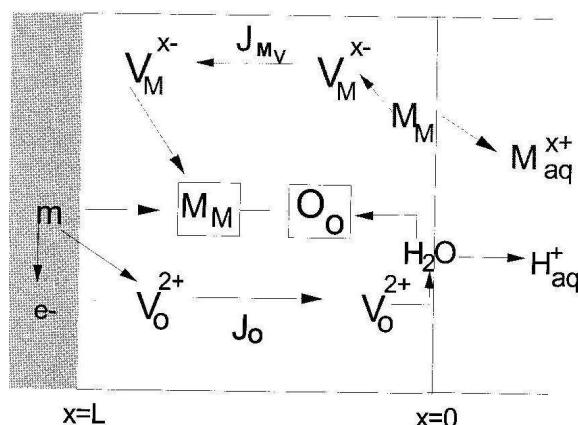
Slika 9. Shematski prikaz modela točkaste greške [28]
