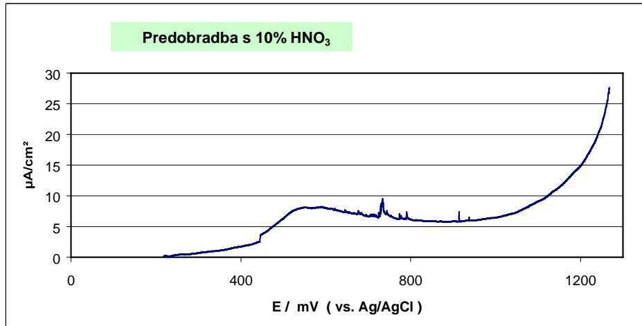
Slika 53. Krivulja gustoće struje i potencijala željezne elektrode (predobrada u dušičnoj kiselini) dobivena u 0,1 M  $\text{NaClO}_4$  s prethodno odstranjenim kisikom uz 50 mV  $\text{min}^{-1}$
