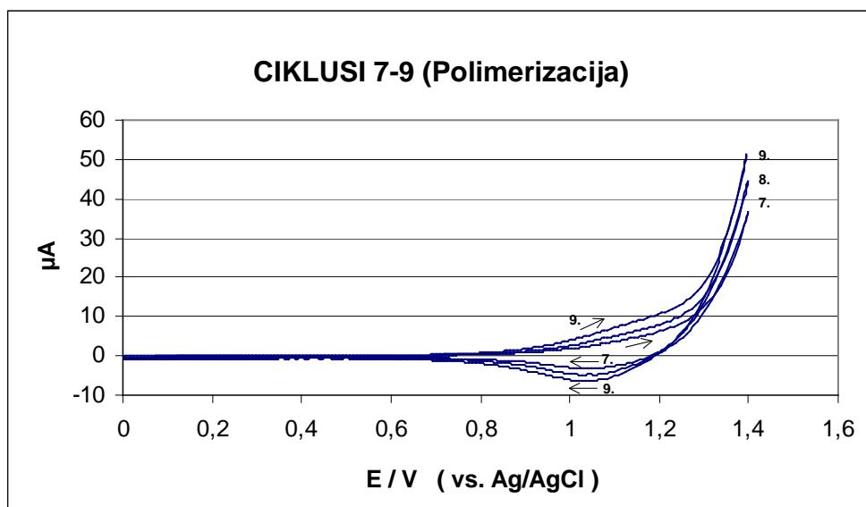
**Slika 70.** Željezna elektroda s nenesenim BTHPS– SOM–om u propilenkarbonatu s  $0,1 \text{ M} \text{ NBu}_4\text{ClO}_4$  (odzračen); CV s  $50 \text{ mVs}^{-1}$  s rotacijom od  $1000 \text{ o/min}$  ( $A = 0,35 \text{ cm}^2$ ); ciklusi 7 – 9 do  $1,4 \text{ V}$  (nastavak polimerizacije).
