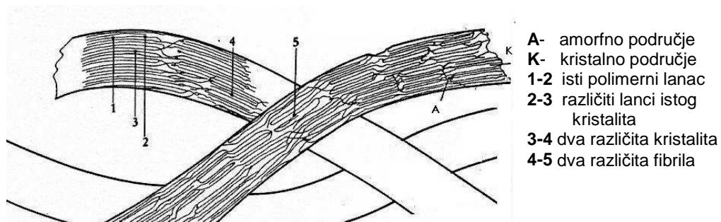
**Slika 33.** Shematski prikaz morfološke građe polimera [6]
