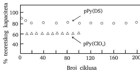
**Slika 38.** Cikliranje litij baterija upotrebom standardnih pPy(ClO<sub>4</sub>) polipirolnih elektrodi i modificiranih pPy(DS) elektrodi
