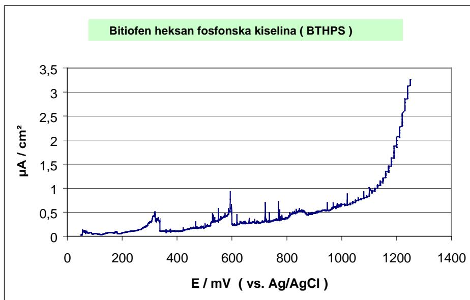
**Slika 55.** Krivulja gustoće struje i potencijala željezne elektrode (predobrada u dušičnoj kiselini) dobivena u 0,1 M  $\text{NaClO}_4$  s prethodno odstranjenim kisikom uz  $50 \text{ mV min}^{-1}$  nakon nanesenog monosloja s BTHPS kiselinom.
