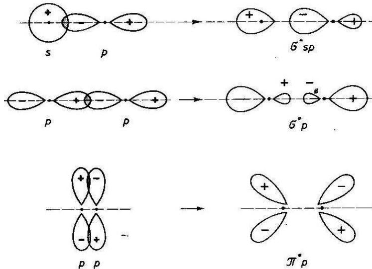
**Slika 15.** Preklapanje atomskih orbitala suprotnog predznaka i nastajanje protuveznih molekulske orbitala, tj.  $\sigma^*$  i  $\pi^*$  veze
