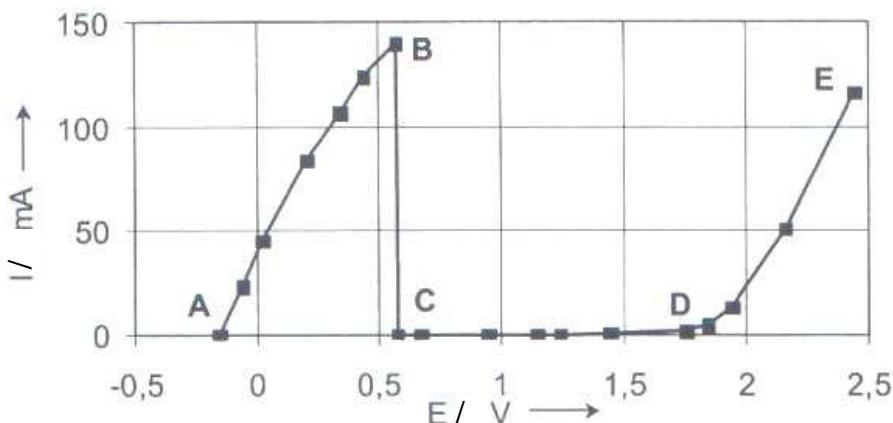
Slika 6. Anodne krivulje struja – napon čistog željeza u sumpornoj kiselini
