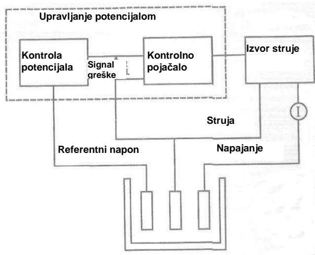
Slika 48. Blok dijagram potencijostata
