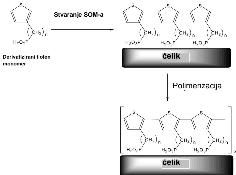
**Slika 66.** Shematski prikaz elektropolimerizacije tiofenskih funkcionalnih grupa s heksan fosfonskom kiselinom, nakon uspješno provedenog stvaranja SOM-a na površini željeza [66].
