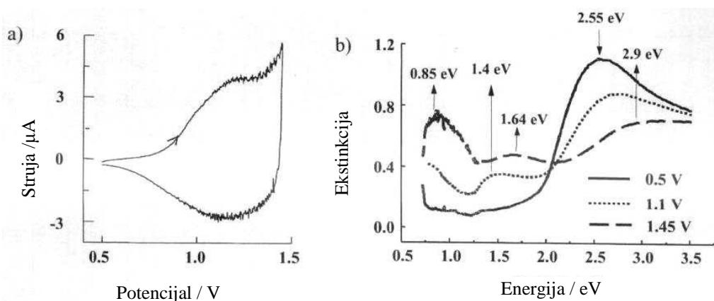
**Slika 36.** Ispitivanja na elektrokemijski sintetiziranom politiofenu na ITO u 0,1 M  $TBABF_4$ / acetonitril otopina; a) ciklički voltamogram ( $v = 0,005$  V/s; 0,5 V – 1,45 V vs. Ag/AgCl); b) UV-Vis-NIR-spektri politiofena u različitim redoks stanjima [44]
