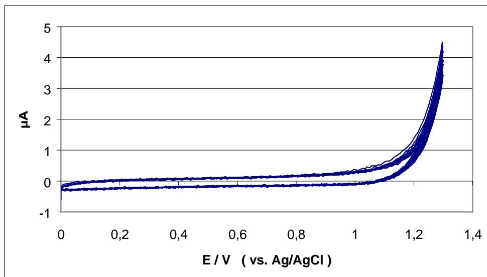
**Slika 67.** Željezna elektroda (predobrađena u dušičnoj kiselinici) s nanesenim BTHPS –SOM –om u propilenkarbonatu s 0,1 M  $\text{NBu}_4\text{ClO}_4$  (odzračen); CV s  $50 \text{ mVs}^{-1}$  s rotacijom od 1000 o/min ( $A = 0.35 \text{ cm}^2$ ); prvo mjerjenje s 5 ciklusa do 1,3 V (bez polimerizacije) [66].
