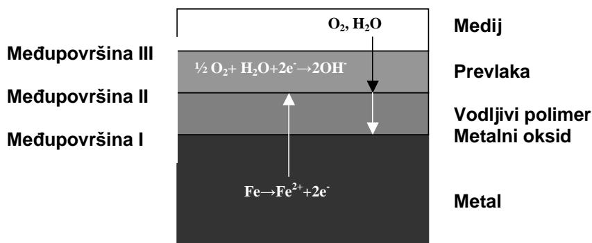
**Slika 39.** Mehanizam razdvajanja anodnih i katodnih mesta reakcija [46]
