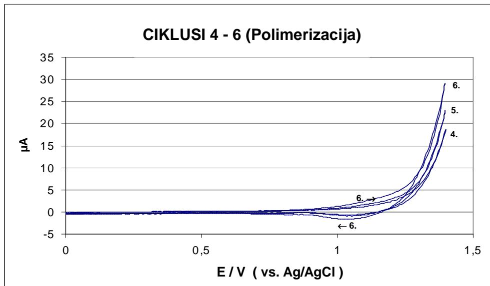
**Slika 69.** Željezna elektroda (predobrađena u dušičnoj kiselinii) s nanesenim BTHPS – SOM –om u propilenkarbonatu s  $0,1 \text{ M} \text{ NBu}_4\text{ClO}_4$  (odzračen); CV s  $50 \text{ mVs}^{-1}$  s rotacijom od  $1000 \text{ o/min}$  ( $A = 0,35 \text{ cm}^2$ ); ciklusi 4 – 6 do  $1,4 \text{ V}$  (nastavak polimerizacije).
