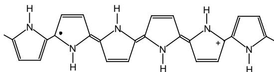
Slika 29. Formiranja pozitivnog naboja lokaliziranog u lancu polimera-radikal kationa
