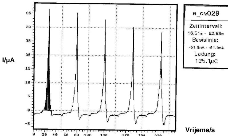
**Slika 73.** Mjerjenje naboja oksidacije i redukcije nakon završetka elektropolimerizacije
