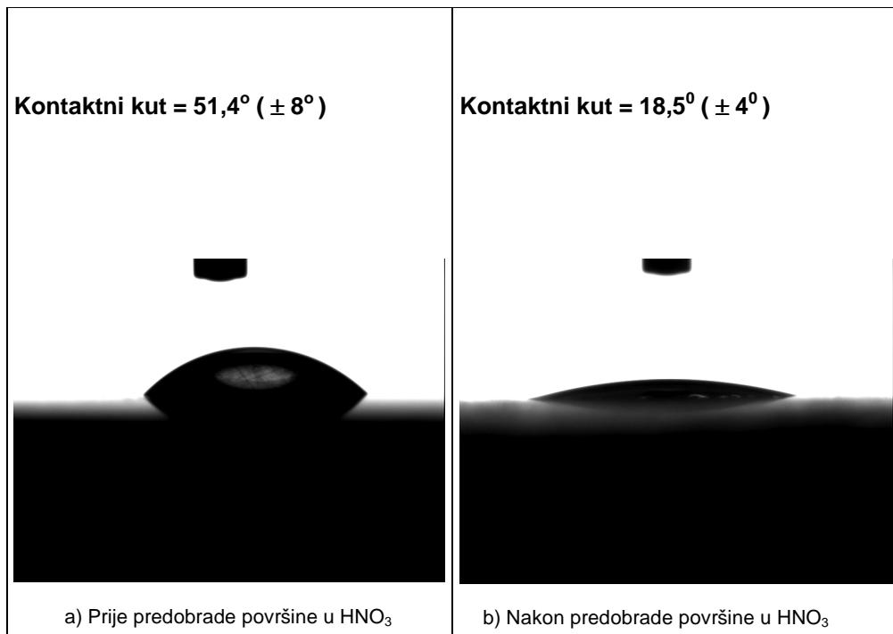
**Slika 57.** Kontaktni kut površine željezne elektrode prije (lijevo) i nakon (desno) predobrade u  $\text{HNO}_3$ . Navedene vrijednosti kontaktnog kuta su srednje vrijednosti dobivene iz 4 – 8 mjerena.
