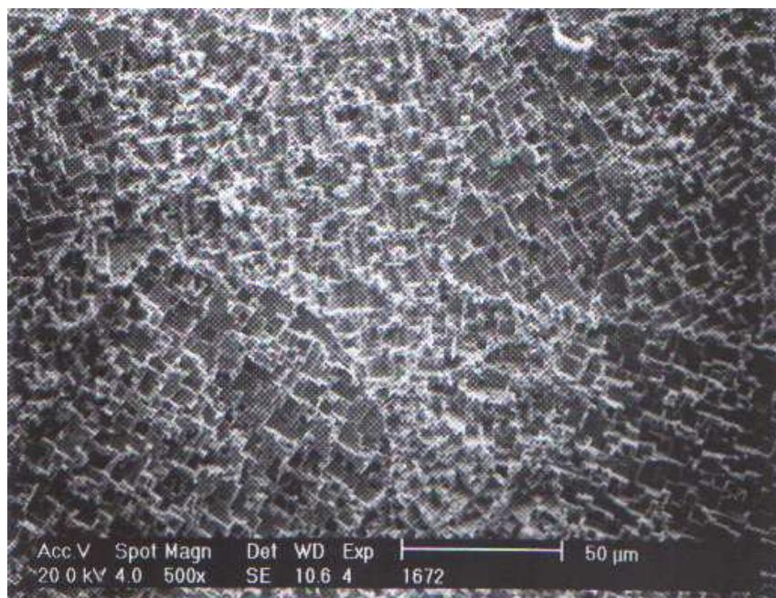
**Slika 83.** Dugo polimerizirana površina elektrode (500x)
