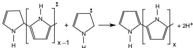
**Slika 25.** Shematski prikaz reakcija polimerizacije
