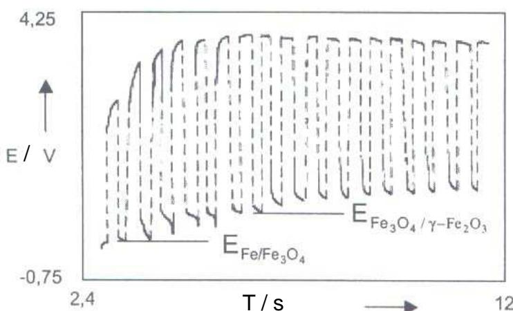
Slika 7. Intermittirajuća krivulja naponskog opterećenja željeza u kalij-nitratnoj otopini s  $\text{H}_2\text{SO}_4$  [20]
