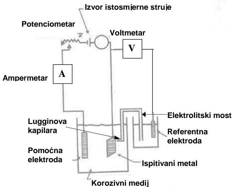
**Slika 47.** Mjerni uređaj za elektrodni sustav za mjerjenje struja-potencijal karakteristike
