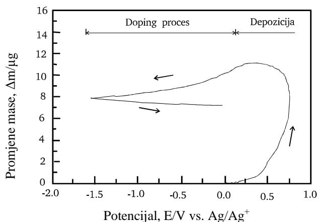
**Slika 32.** Promjene mase zabilježene uz pomoć EQCM za vrijeme elektrodepozicije i kasnijeg procesa dopiranja polipirola u  $\text{TBACIO}_4\text{-CH}_3\text{CN}$  otopini [33]
