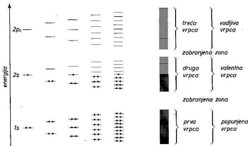
**Slika 20.** Shematski prikaz nastajanja elektronskih vrpca u metalu [23]
