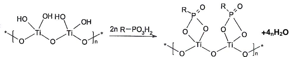
**Slika 10.** Model vezanja fosfonske kiseline na površinu  $\text{TiO}_2$ ,  $\text{R}$  = alkilni lanac s funkcionalnom grupom [12, 36].
