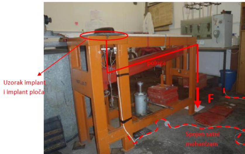
Slika 3.10. Prikaz opterećenja implant uzorka.
