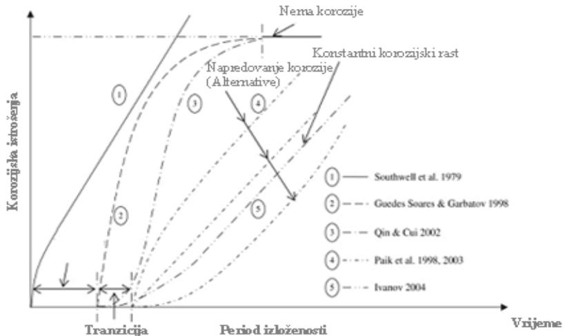
Slika 2.8 - Shematski prikaz modela koroziskog istrošenja različitih autora [10]
