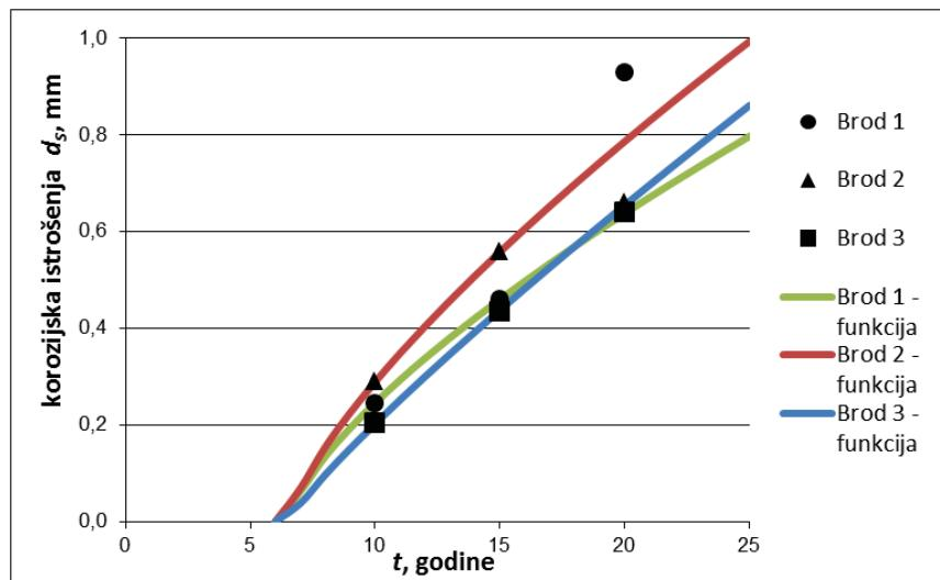
Slika 2.21 - Izmjerena i predviđena srednja vrijednost korozionskog istrošenja ploča palube balastnih tankova
