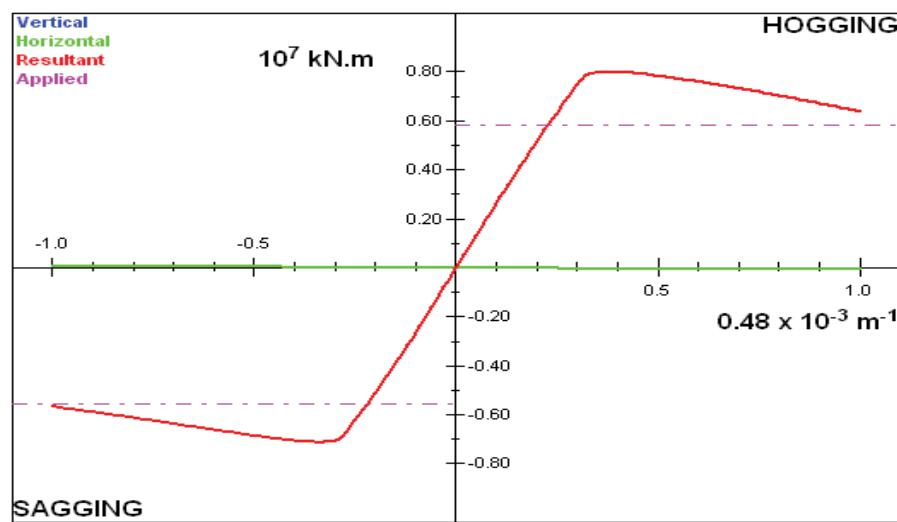
**Slika 4.5** - Ovisnost momenta savijanja  $M_U$  o zakrivljenosti  $k$  brodskog trupa za stanje trupa AS BUILT (novi brod) Brod 1
