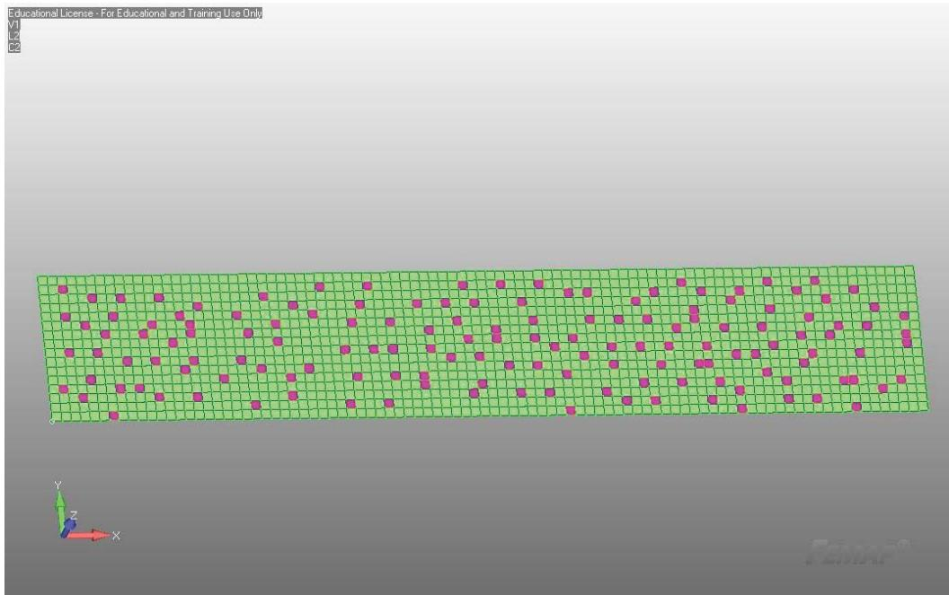
**Slika 3.38 - Rupičasta korozija ploče, 10% površine**
