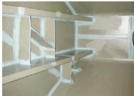
**Slika 2.5** - Naneseni zaštitni premaz (epoksi tip) u tankovima balasta naftnog tankera [31]
