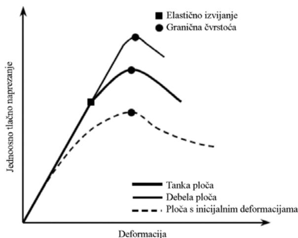
Slika 3.1 - Krivulja naprezanje/deformacija čeličnih ploča pod tlačnim opterećenjem [18]
