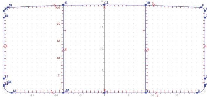
**Slika 2.11 - Glavno rebro tankera s jednostrukom oplatom**
