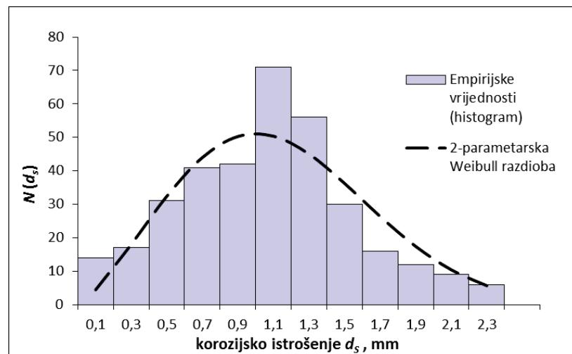
Slika 2.16 - Razdioba opažanja aproksimirana Weibull-ovom distribucijom korozijskih istrošenja palubnih opločenja u tankovima tereta za Brod br. 2 u 20. godini
