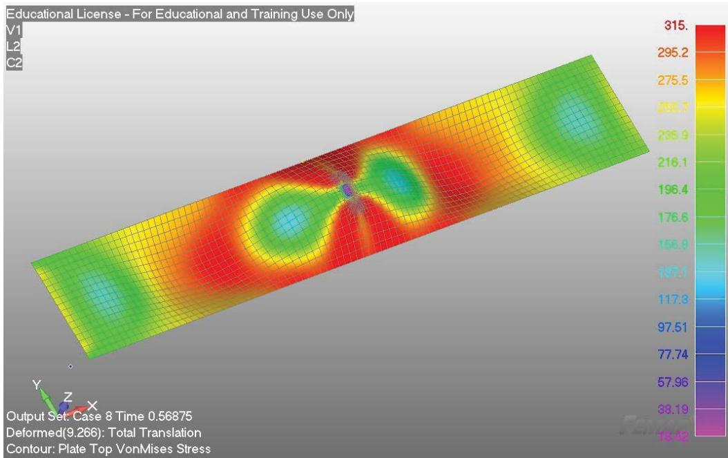
**Slika 3.29** - Kolaps ploče s pukotinom od 200 mm
