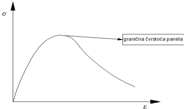
Slika 3.7 - Izgled krivulje  $\sigma - \varepsilon$  za slom putem gredno – štapnog izvijanja [1]
