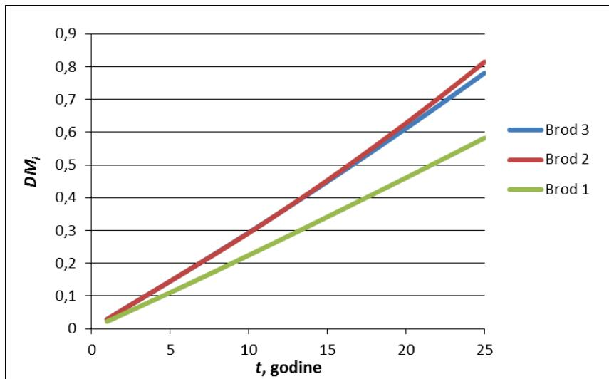
Slika 5.31 - Rezultati akumuliranog oštećenja dobiven proračunom S-N pristupa [49]
