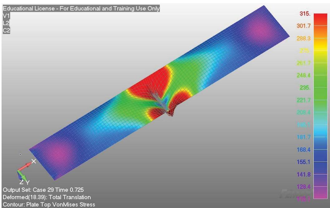
Slika 3.28 - Porast naprezanja kod ploče s pukotinom
