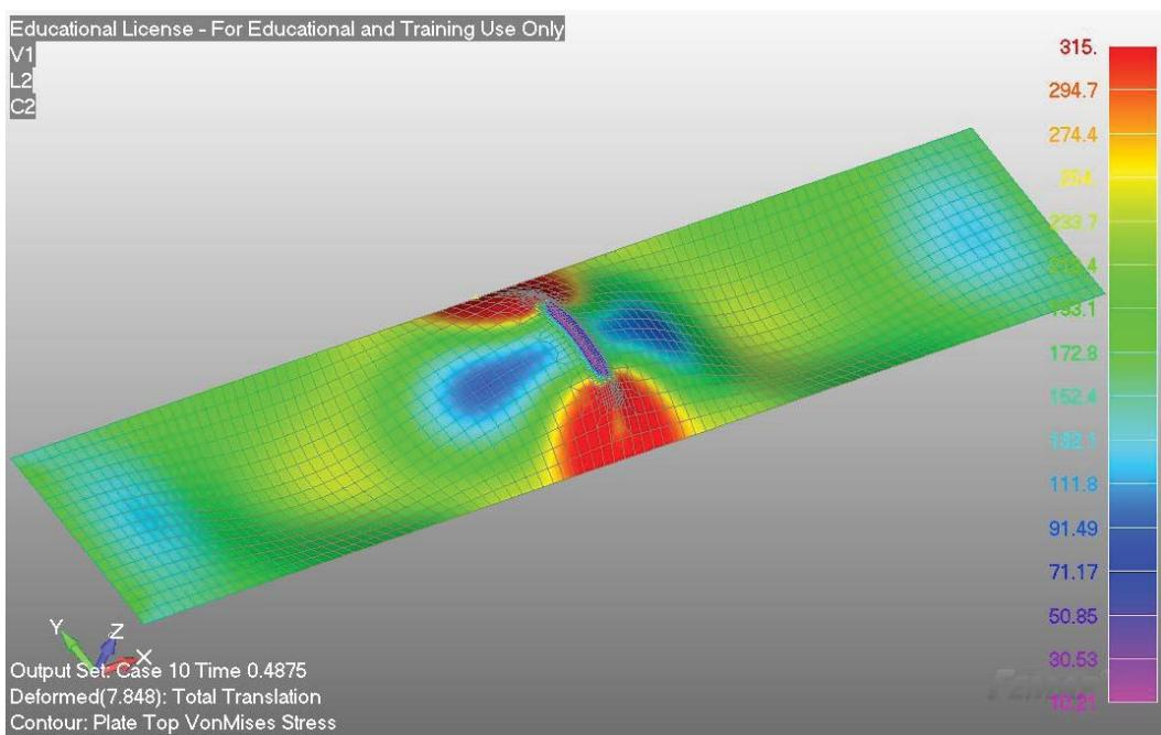
**Slika 3.30** - Kolaps ploče s pukotinom od 400 mm
