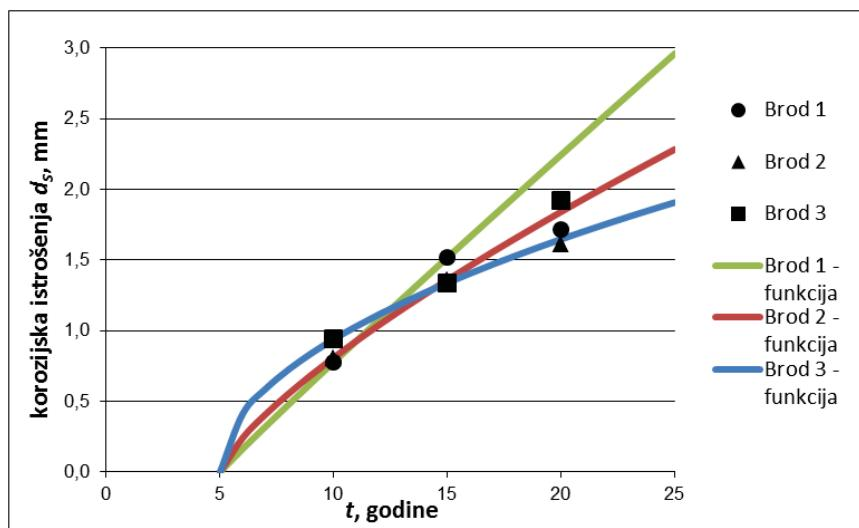
Slika 2.24 - Izmjerena i predviđena ekstremna vrijednost koroziskog istrošenja uzdužnjaka palube balastnih tankova
