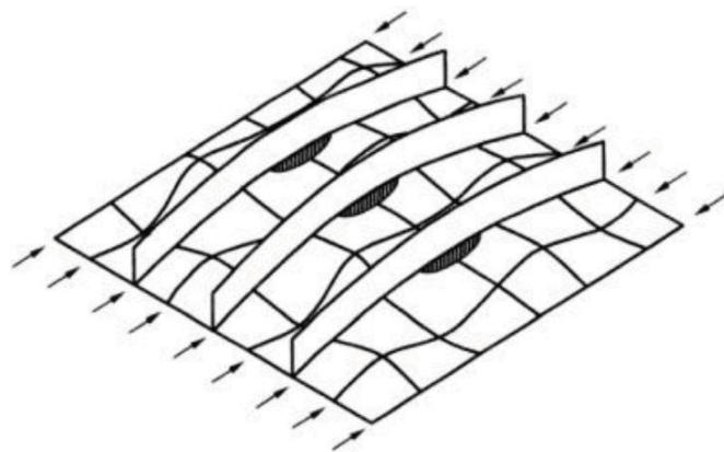
Slika 3.4 - Gredno-štapno izvijanje ukrepljenog panela [11]
