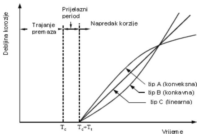
Slika 2.7 - Shematski prikaz korozionskog procesa [18]
