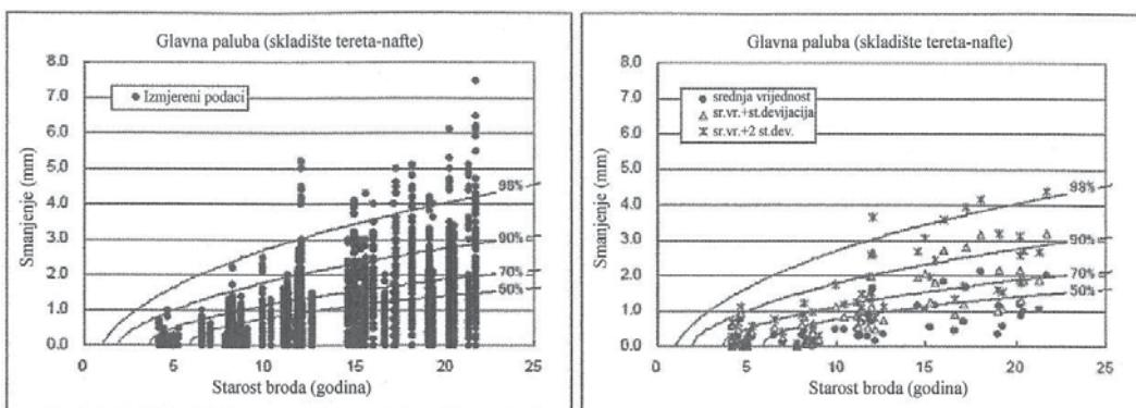
**Slika 1.1** - Statistički podaci mjerjenja debljina strukturalnih elemenata glavne palube naftnih tankera [12].
