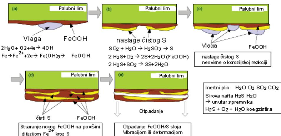
Slika 2.3 - Mehanizam opće korozije na unutarnjoj strani palubnog lima tankera za naftu [6]
