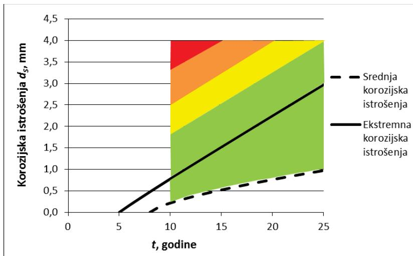
Slika 5.2 - Korozionska mapa palubnih uzdužnjaka u tankovima balasta za Brod 1
