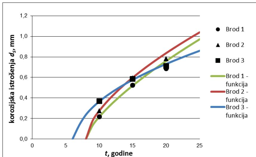
Slika 2.23 - Izmjerena i predviđena srednja vrijednost koroziskog istrošenja uzdužnjaka palube balastnih tankova
