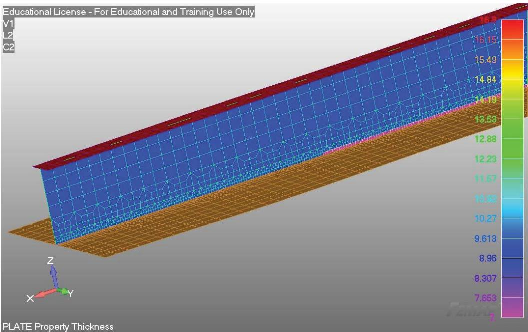
Slika 3.43 - Žljebasta korozija u području zavara duž pola duljine struka uzdužnjaka
