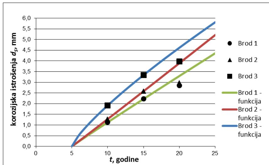
Slika 2.20 - Izmjerena i predviđena ekstremna vrijednost korozijskog istrošenja uzdužnjaka palube tankova tereta
