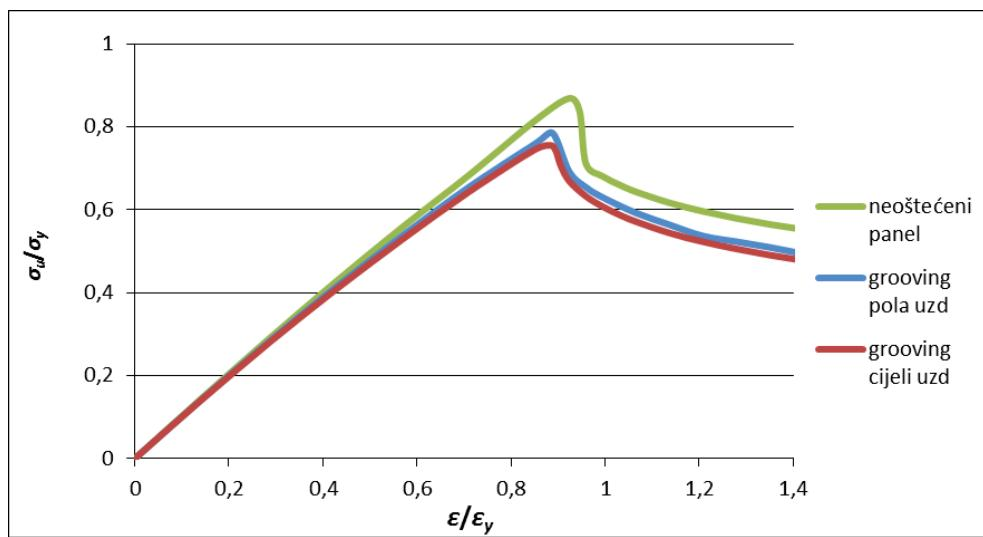
Slika 3.47 - Izgled krivulje  $\sigma - \varepsilon$  za ukrepljeni panel s korozijom u žlijebu zavarenog spoja dužine pola struka uzdužnjaka, cijelog struka uzdužnjaka, i neoštećeni panel
