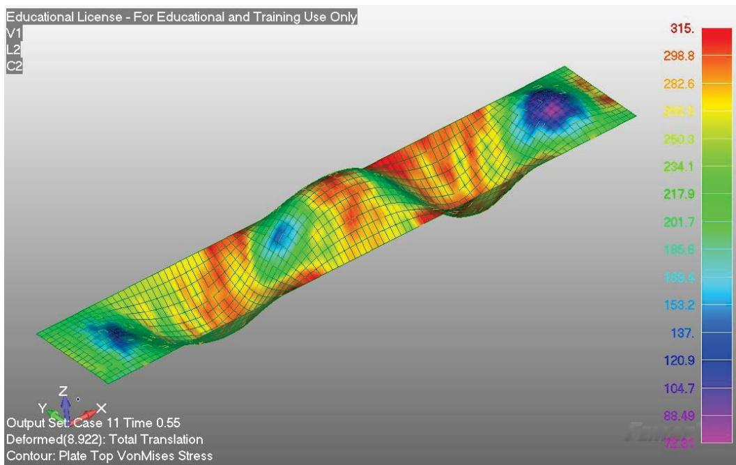
Slika 3.40 - Kolaps ploče s 10% rupičaste korozije
