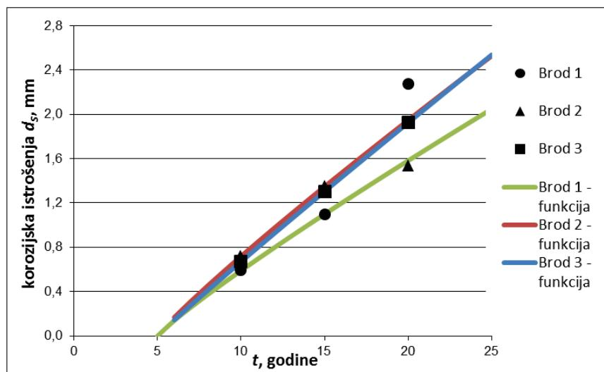
Slika 2.22 - Izmjerena i predviđena ekstremna vrijednost korozionskog istrošenja ploča palube balastnih tankova
