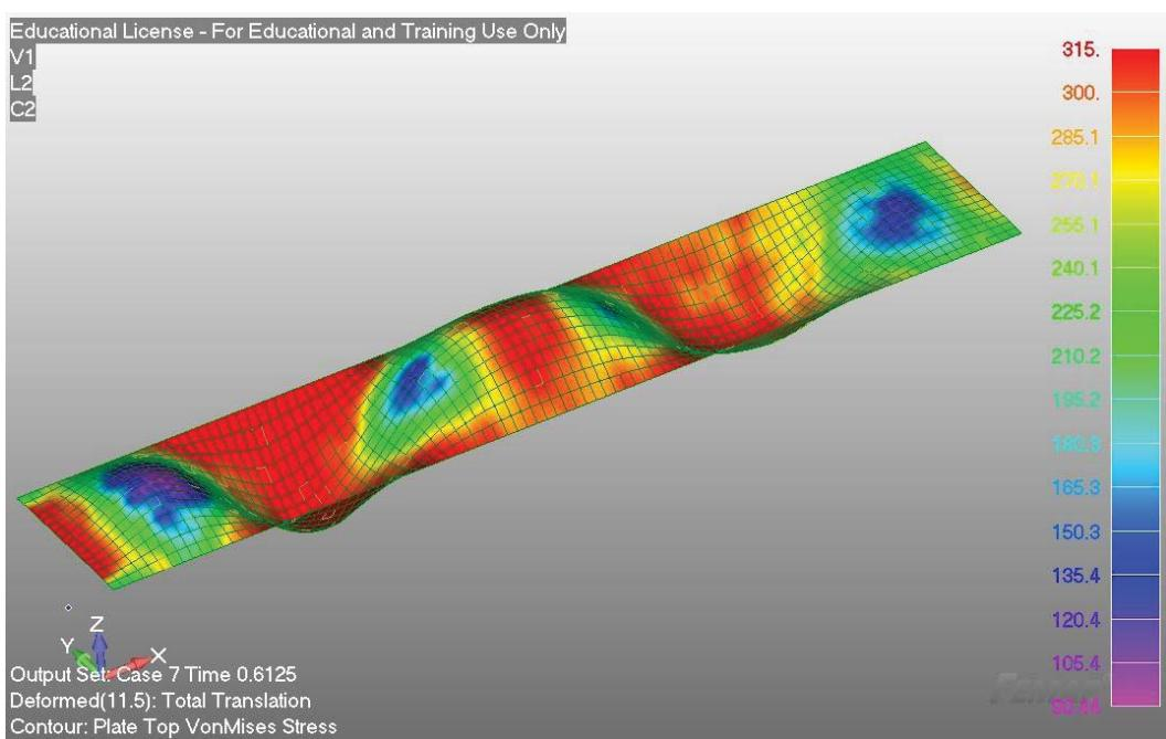
**Slika 3.39 - Kolaps ploče s 5% rupičaste korozije**
