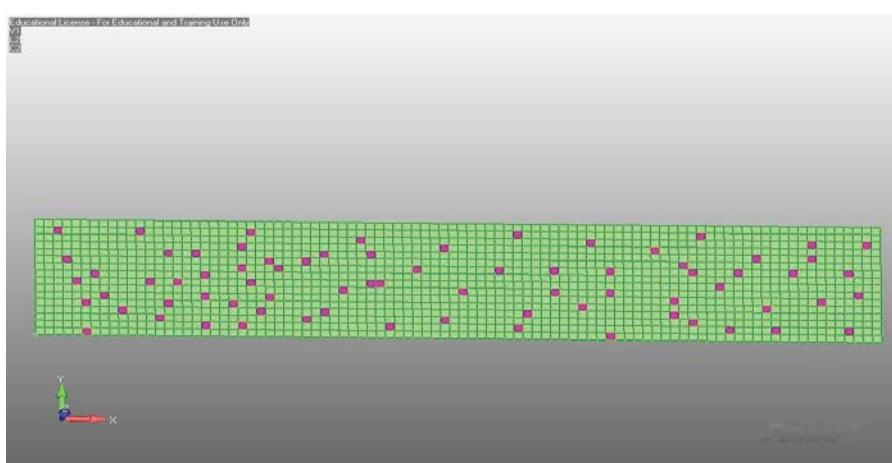
**Slika 3.37** - Rupičasta korozija ploče, 5% površine
