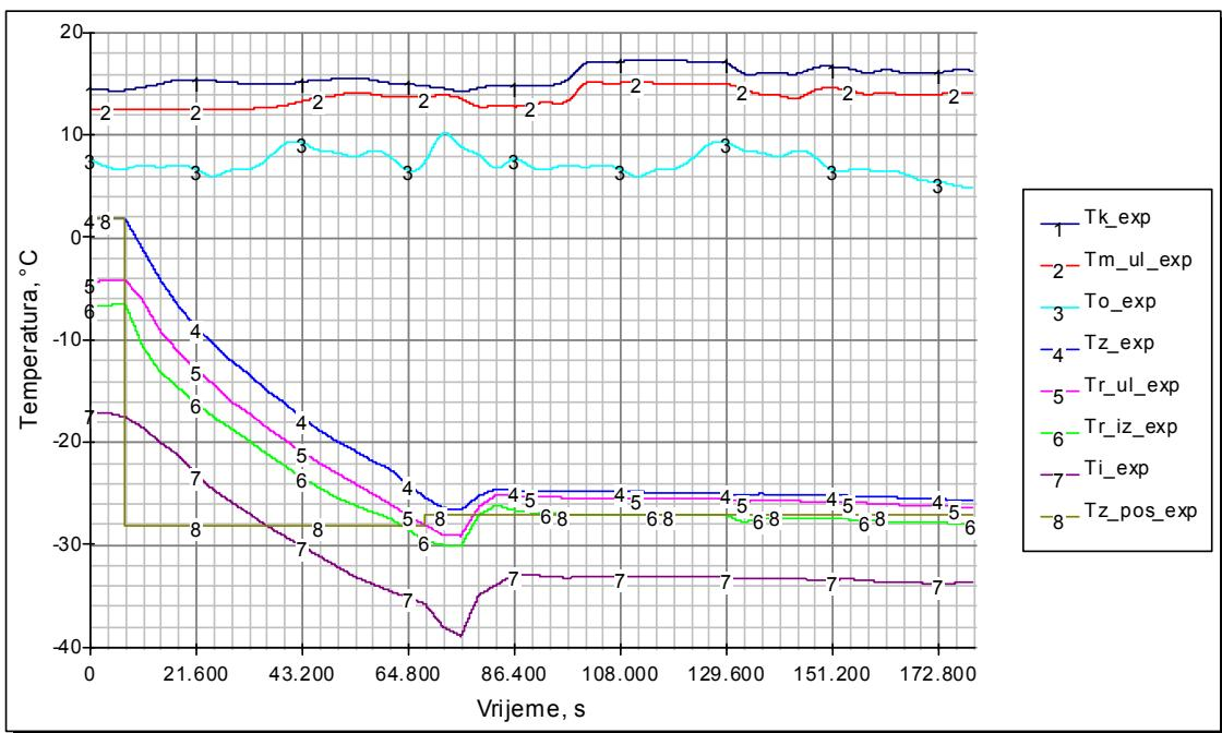
**Sl. 6.24. Rezultati mjerena temperatura ( $T_{\text{exp}}$ ) pri testu ohlađivanja praznih brodskih skladišta: kondenzacije (k), morske vode na ulazu u kondenzator (m\_ul), okolišnog zraka (o), hlađenog zraka u skladištu (z), rasola na ulazu (r\_ul) i na izlazu (r\_iz) iz isparivača, isparivanja (i) i postavljena temperatura hlađenja (z\_pos)**
