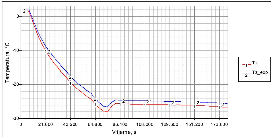
SI. 6.28. Usporedni rezultati simulacije ( $Tz$ ) i mjerena ( $Tz_{exp}$ ) temperature hlađenoga vlažnog zraka u odjeljku 3A
