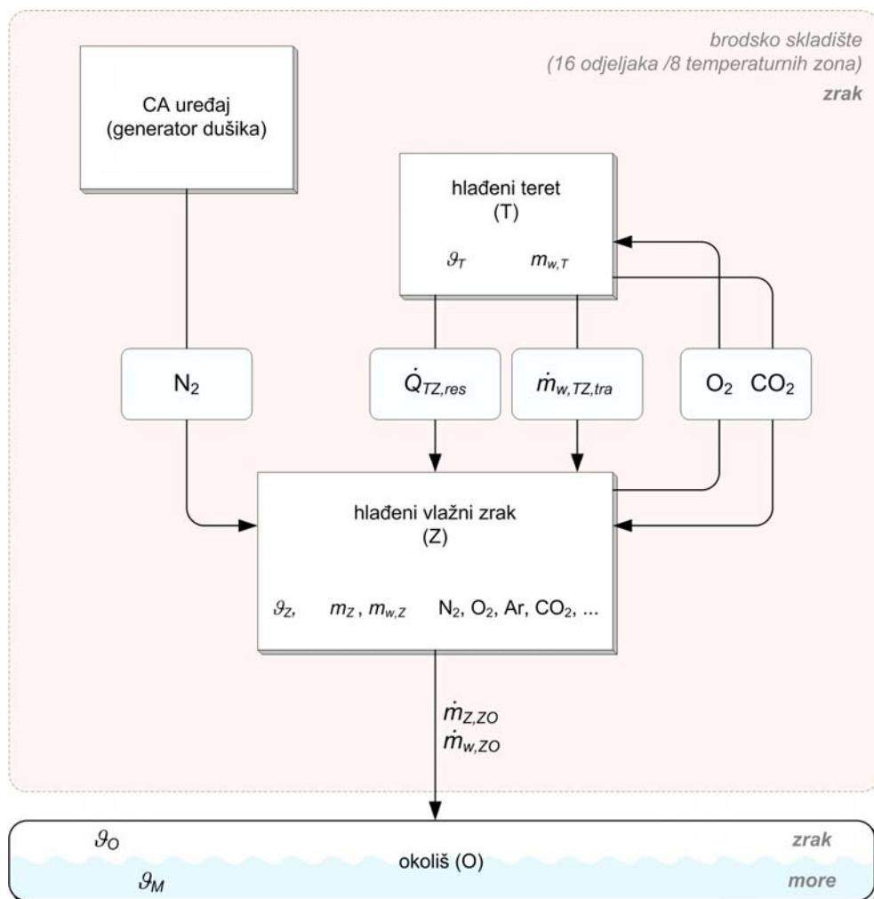
Sl. 5.1. Strukturalni model sustava metaboličnih procesa i nadzirane atmosfere
