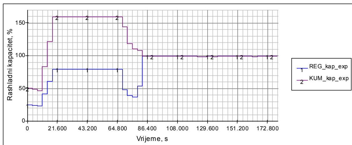
Sl. 6.26. Rezultati mjerjenja prosječnog opterećenja ( $REG\_kap\_exp$ ) i ukupni rashladni kapacitet što ga ostvaruju svi kompresori u istodobnom radu ( $KUM\_kap\_exp$ )
