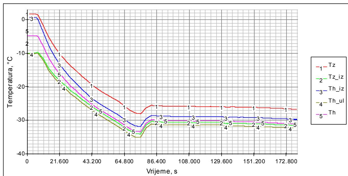
SI. 6.29. Rezultati simulacije temperatura zraka na ulazu ( $Tz$ ) i na izlazu ( $Tz_{iz}$ ) iz hladnjaka, temperaturne rasole na ulazu ( $Th_{ul}$ ) i na izlazu ( $Th_{iz}$ ) iz hladnjaka i srednja temperatura površine hladnjaka zraka ( $Th$ )
