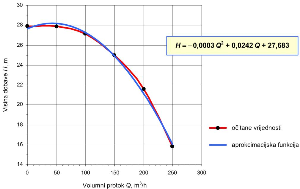
**Sl. 4.14. Radna karakteristika centrifugalne pumpe rasola
