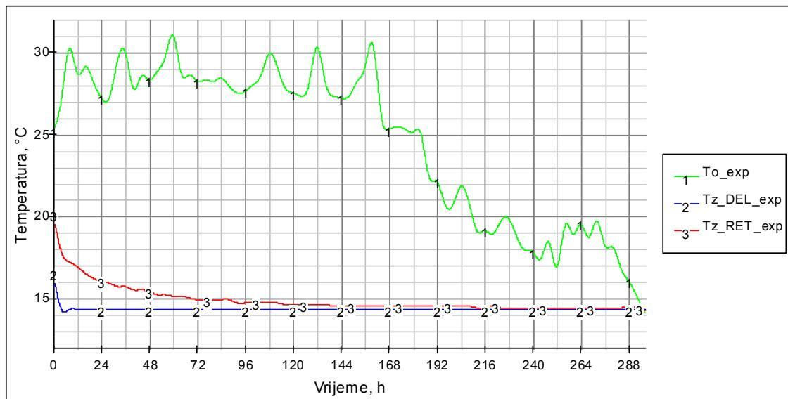
**Sl. 6.35. Rezultati mjerjenja okolišne temperature ( $To_{exp}$ ) i temperatura dovodne ( $Tz_{DEL\_exp}$ ) i povratne ( $Tz_{RET\_exp}$ ) zračne struje u odjeljku 3A tijekom plovidbe od Turba do Antwerpena**
