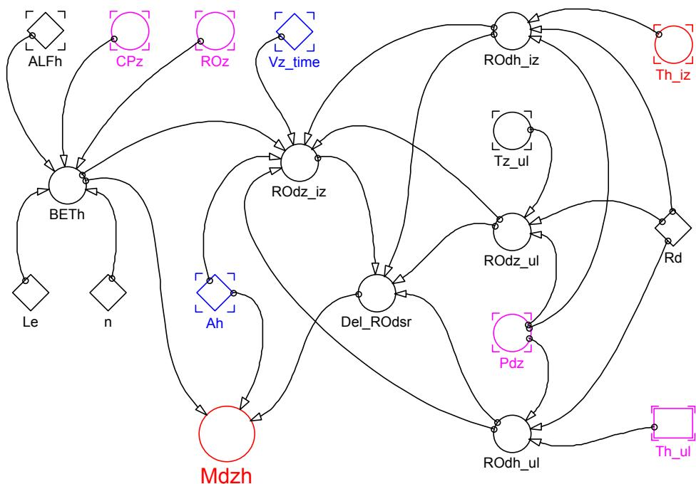
**Sl. 6.9. Dijagram simulacijskog modela hladnjaka zraka – 2. dio**
