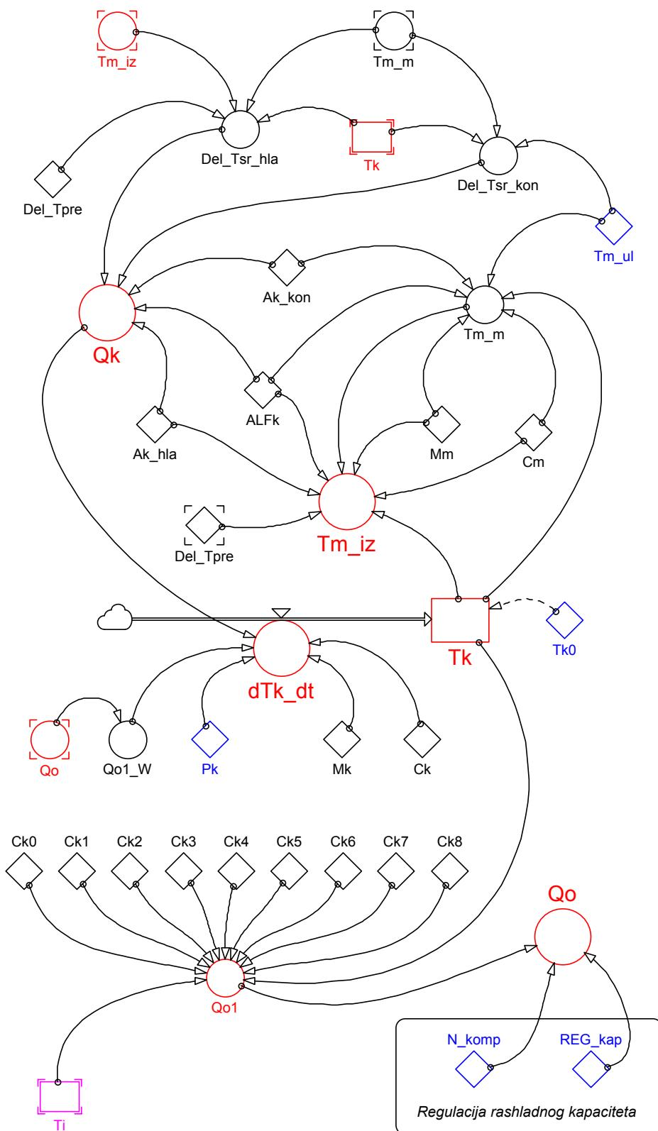
SI. 6.15. Dijagram simulacijskog modela kondenzacijske jedinice rashladnika rasola
