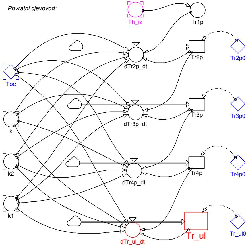
SI. 6.13. Dijagram simulacijskog modela sustava razvoda rasola – 3. dio
