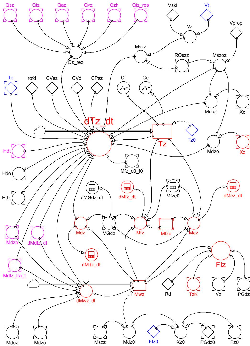
SI. 6.3. Dijagram simulacijskog modela hlađenoga vlažnog zraka – 2. dio
