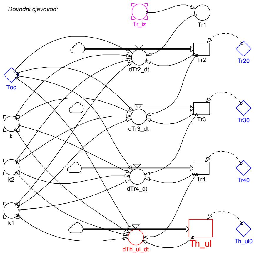
SI. 6.12. Dijagram simulacijskog modela sustava razvoda rasola – 2. dio
