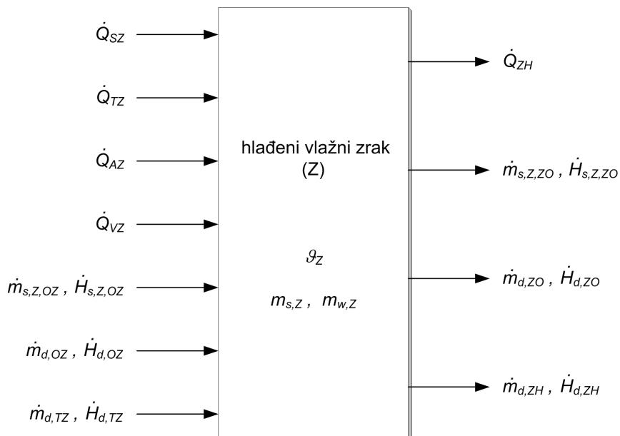
Sl. 4.5. Strukturalni model hlađenoga vlažnog zraka
