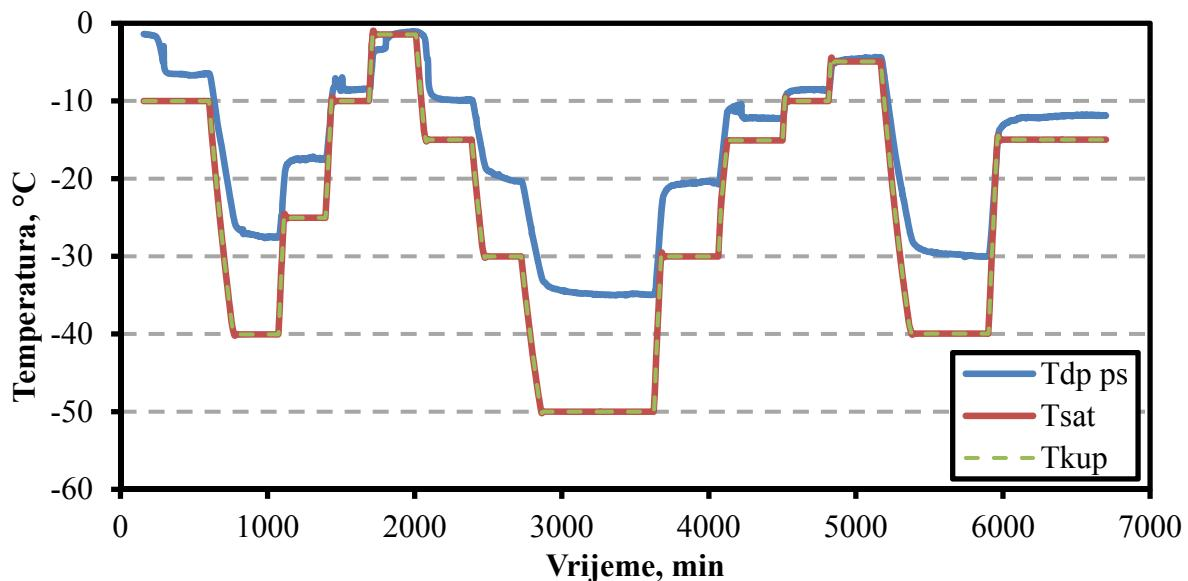
Slika 37. Rezultati ispitivanja učinkovitosti predsaturatora u LPM-u.
