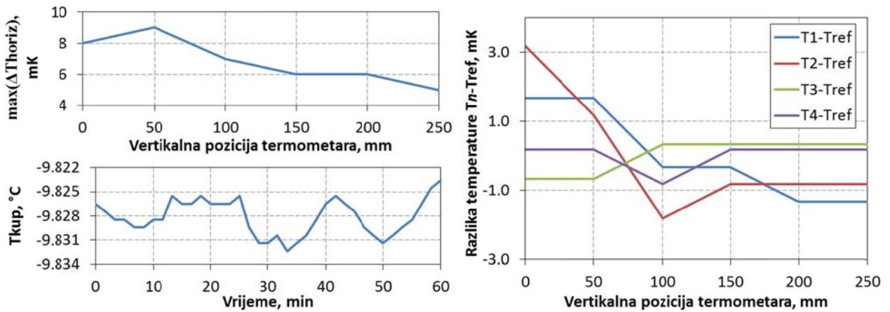
d) Rezultati ispitivanja kupke pri temperaturi  $T_{kup} = -10^{\circ}\text{C}$
