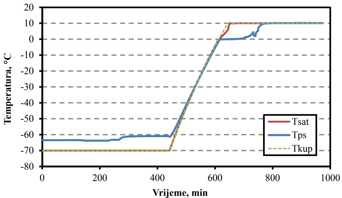
Slika 35. Rezultati ispitivanja temperature predsaturatora u LPM-u.
