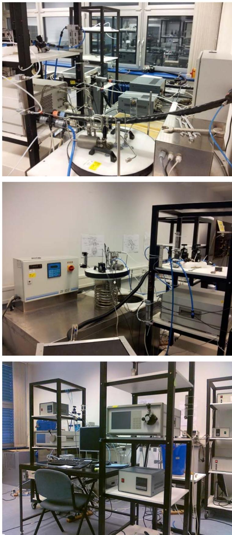
Slika 7. Fotografije sastavljenog primarnog niskotemperaturnog generatora injišta/rošića zraka (plina).
