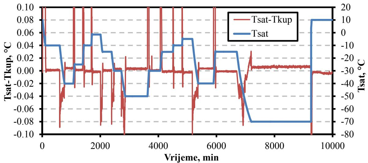
Slika 41. Razlike temperature izmjereneh unutar komore saturatora i temperatura radne tekućine kupke u blizini komore saturatora, za vrijeme ispitivanja u LPM-u. Temperatura kupke prikazana je debelom plavom linijom na sekundarnoj ordinate (desno).
