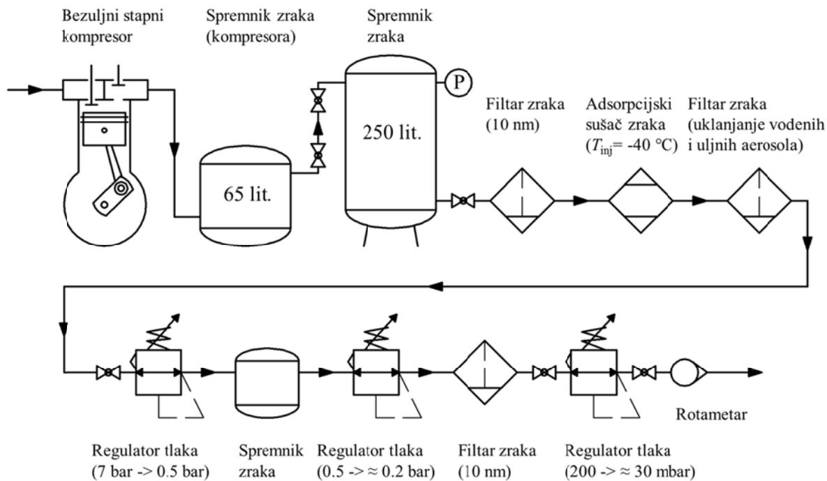
Slika 23. Shematski prikaz sustava za napajanje saturatora zrakom.
