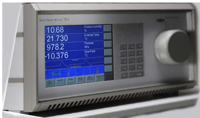
Slika 21. Higrometar točke rose MBW-373L, iz [51].
