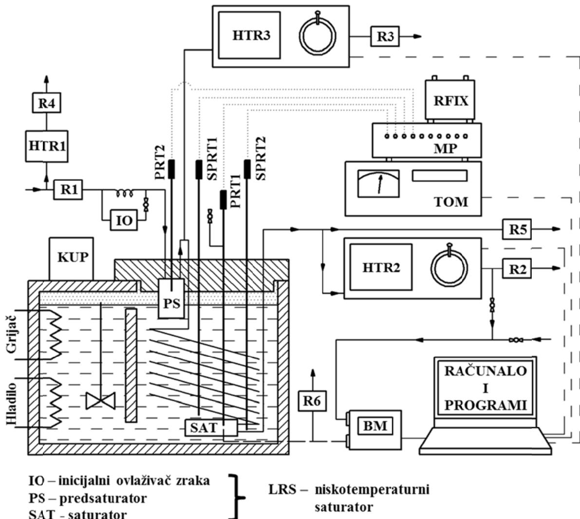
Slika 33. Shematski prikaz mjerne linije za ispitivanje LRS-a.
