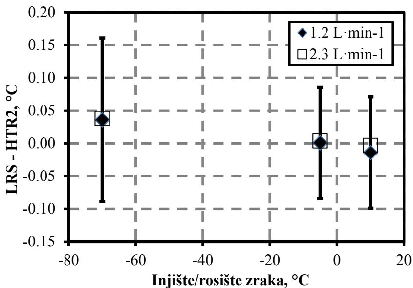
Slika 39. Razlike injišta/rošišta zraka dobivenih na temelju očitanja temperature i tlaka LRS-a i vrijednosti izmjerene pomoću preciznog higrometra točke rose (HTR2), za vrijeme ispitivanja u LPM-u. Krilca prikazuju proširenu nesigurnost ( $k=2$ ) mjerena, koja uključuje nesigurnost realizacije kao i nesigurnost higrometra.
