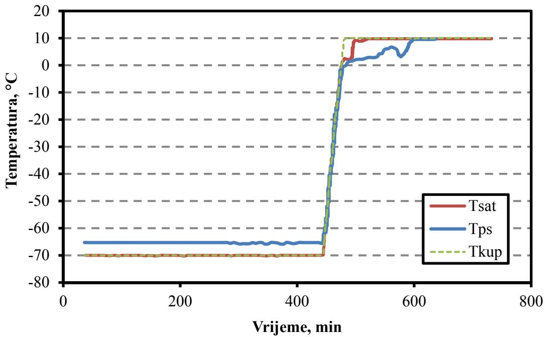
Slika 34. Rezultati ispitivanja temperature predsaturatora u MIKES-u.
