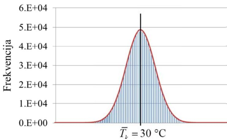
Slika 48. Dijagram frekvencija Monte Carlo simulacija za temperaturu  $\bar{T}_k = 30^\circ\text{C}$ . Crvenom linijom označena je teorijska normalna razdioba.
