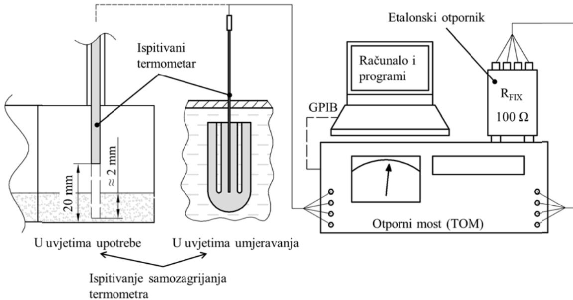
Slika 57. Linija za ispitivanje samozagrijavanja termometra za mjerjenje temperature zraka u komori saturatora.
