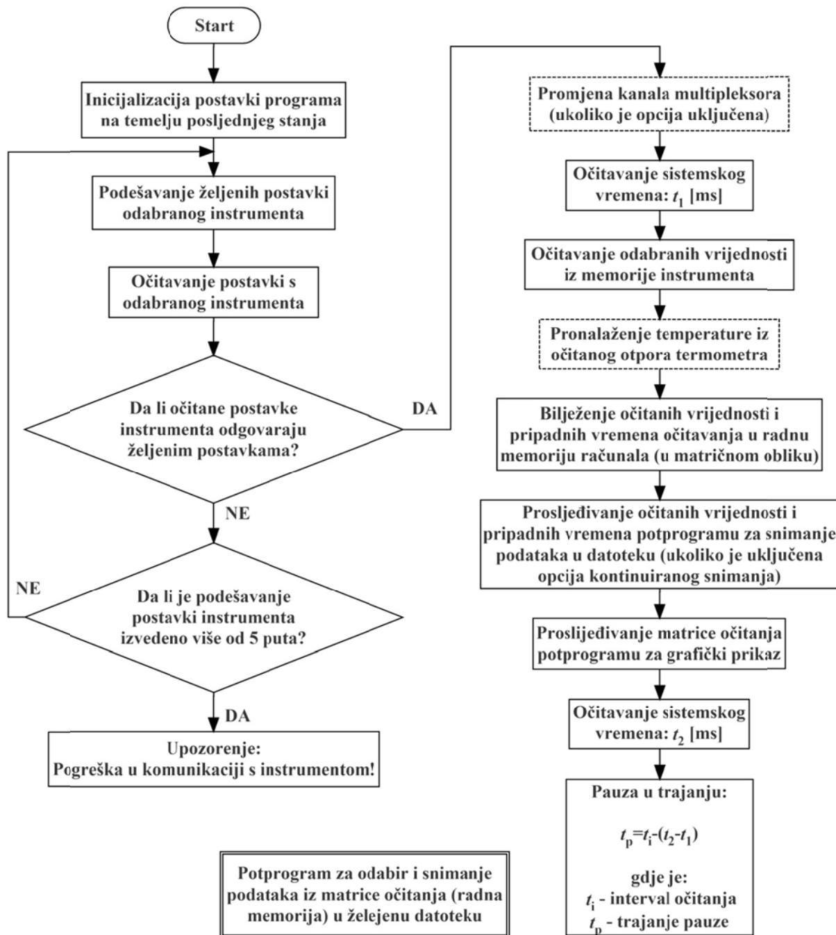
Slika 28. Dijagram toka programa za bilježenje očitanja instrumenata (crtkani blokovi se odnose samo na program za otporne mostove).
