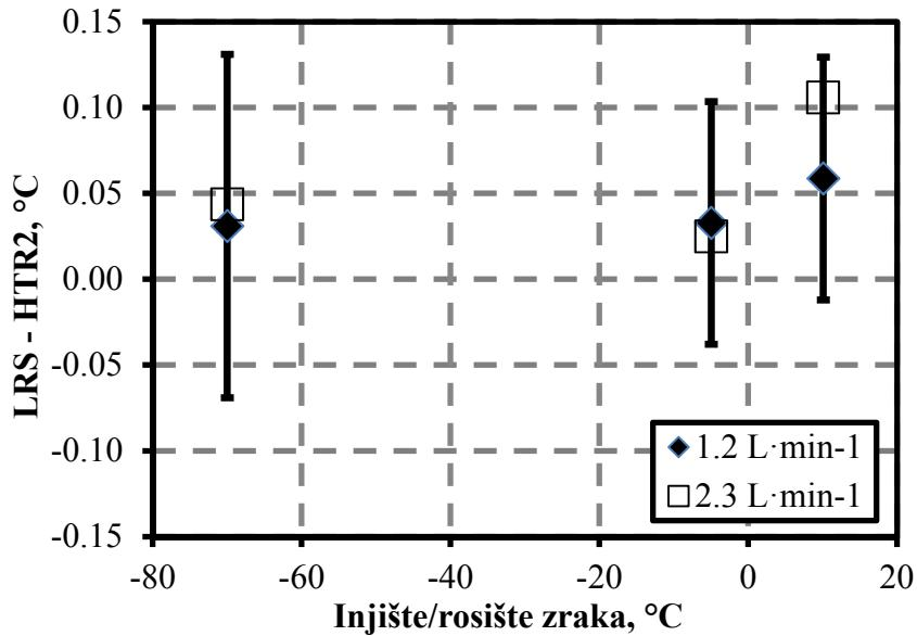
Slika 38. Razlika injišta/rošišta zraka dobivenih na temelju očitanja temperature i tlaka LRS-a i vrijednosti izmjerene pomoću preciznog higrometra točke rose (HTR2), za vrijeme ispitivanja u MIKES-u. Krilca prikazuju proširenu nesigurnost ( $k=2$ ) mjerena, koja uključuje nesigurnost realizacije kao i nesigurnost higrometra.
