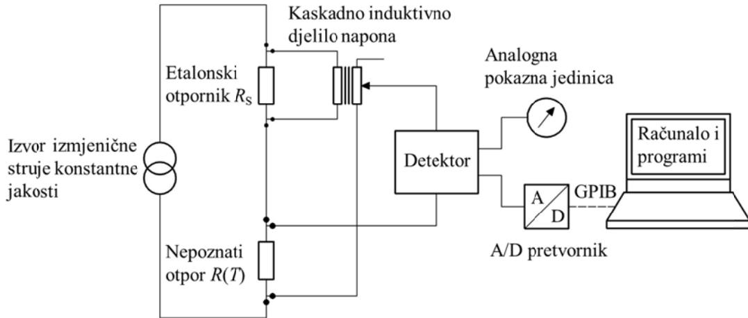
Slika 18. Shematski prikaz osnovnih komponenata izmjeničnog otpornog mosta ASL F700, prema [45].
