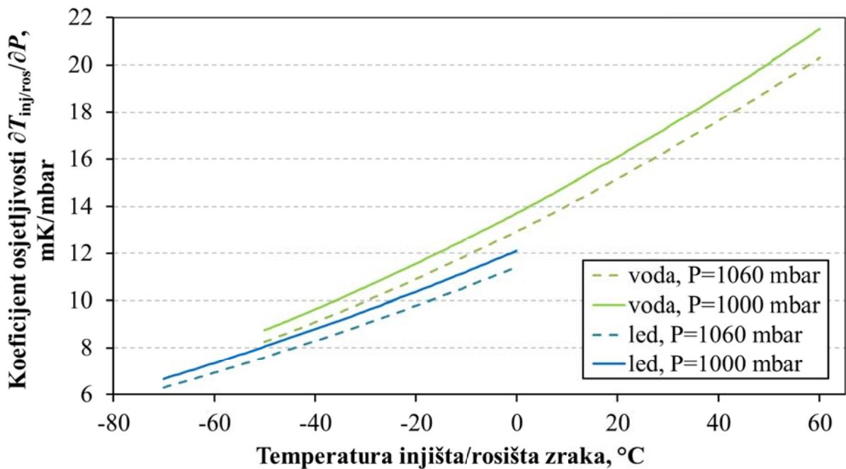
Slika 32. Dijagram za određivanje koeficijenata osjetljivosti temperature injišta/rošića o tlaku zraka  $\partial T_{\text{inj/ros}} / \partial P$ . Dijagram je izrađen za absolutni tlak 1030 mbar.
