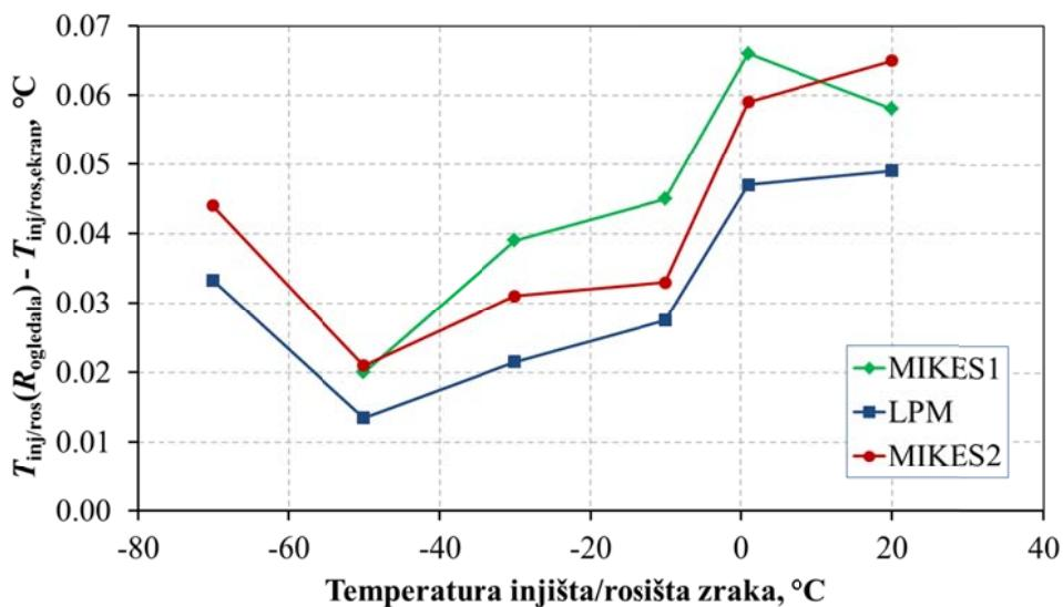
Slika 71. Razlike između temperatura injišta/rosišta dobivenih mjeranjem otpora i očitanjem s ekrana instrumenta.
