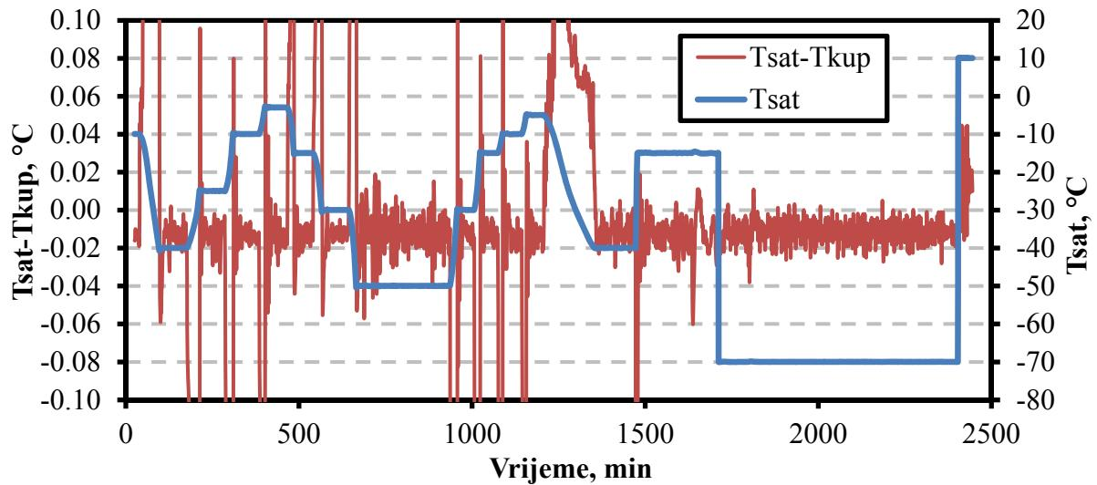
Slika 40. Razlike temperature izmjereneh unutar komore saturatora i temperatura radne tekućine kupke u blizini komore saturatora, za vrijeme ispitivanja u MIKES-u. Temperatura kupke prikazana je debelom plavom linijom na sekundarnoj ordinate (desno).
