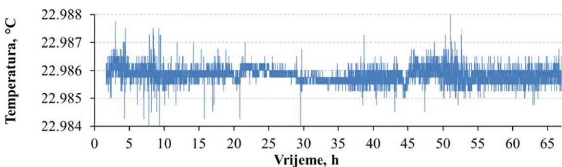
Slika 67. Rezultati mjerjenja stabilnosti temperature ulja u kupki za etalonske otpornike pri čemu je mjerjenje izvršeno istovremeno s mjerenjem stabilnosti etalonskog otpornika.
