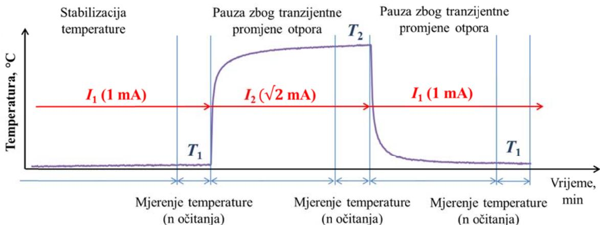
Slika 51. Prikaz procesa mjerjenja samozagrijavanja termometra postupkom s dvije struje.
