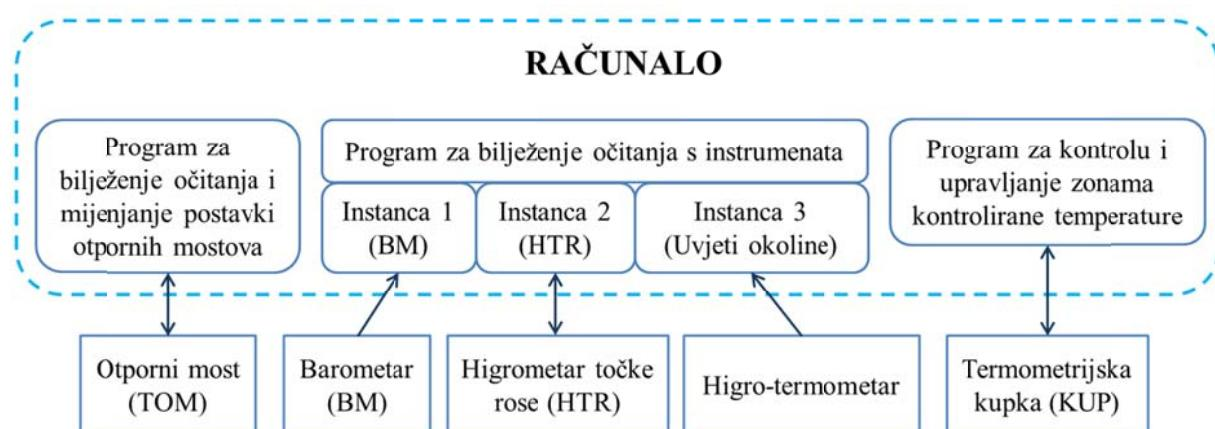
Slika 26. Shematski prikaz računalnih programa razvijenih za potrebe bilježenja očitanja i upravljanje instrumentima.
