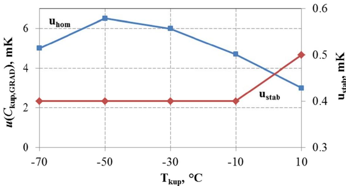
Slika 46. Doprinos standardnoj nesigurnosti temperature kupke zbog postojanja prostornih gradijenata  $u(C_{\text{kup},\text{GRAD}})$  i vremenske nestabilnosti temperature  $u_{\text{stab}}(T_{\text{kup}})$  u ovisnosti o temperaturi kupke  $T_{\text{kup}}$ .
