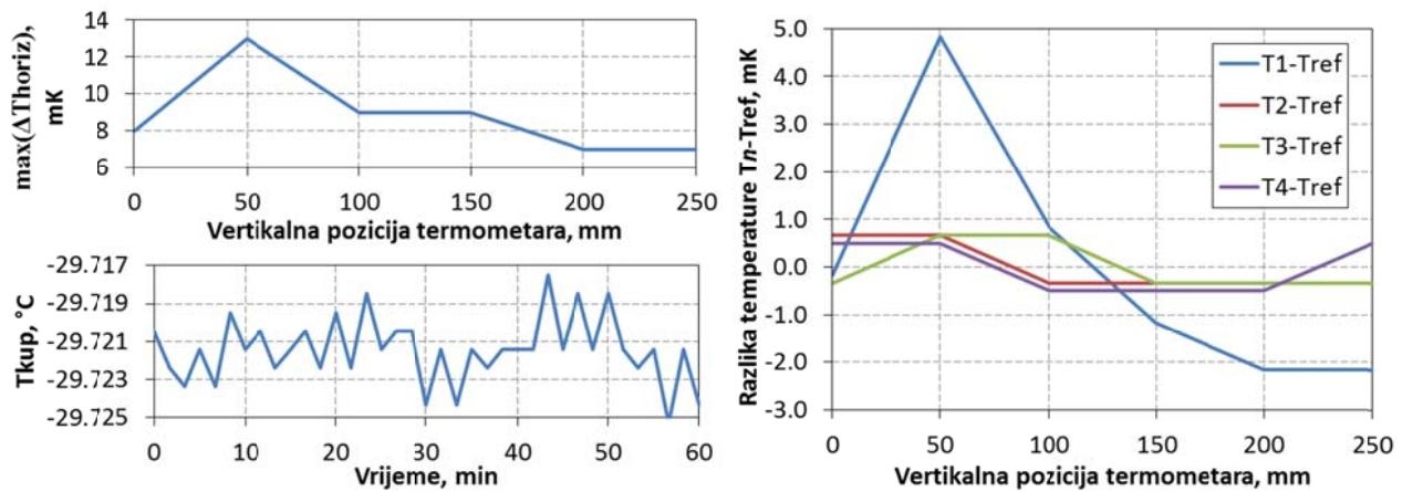
c) Rezultati ispitivanja kupke pri temperaturi  $T_{\text{kup}} = -30^{\circ}\text{C}$
