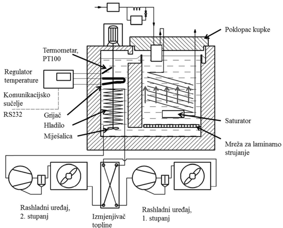
Slika 14. Shematski prikaz kupke za regulaciju temperature saturatora.
