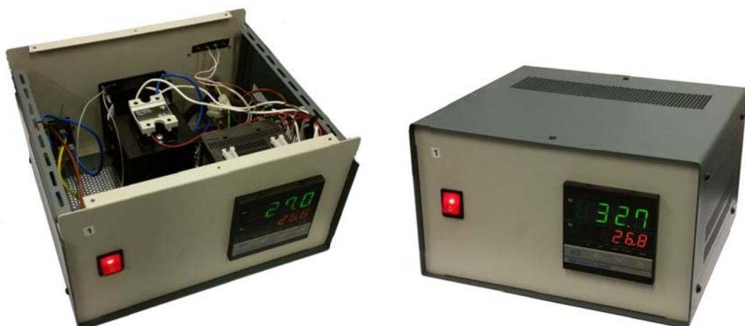
Slika 13.Regulator temperature grijaca izlazne cijevi LRS-a.
