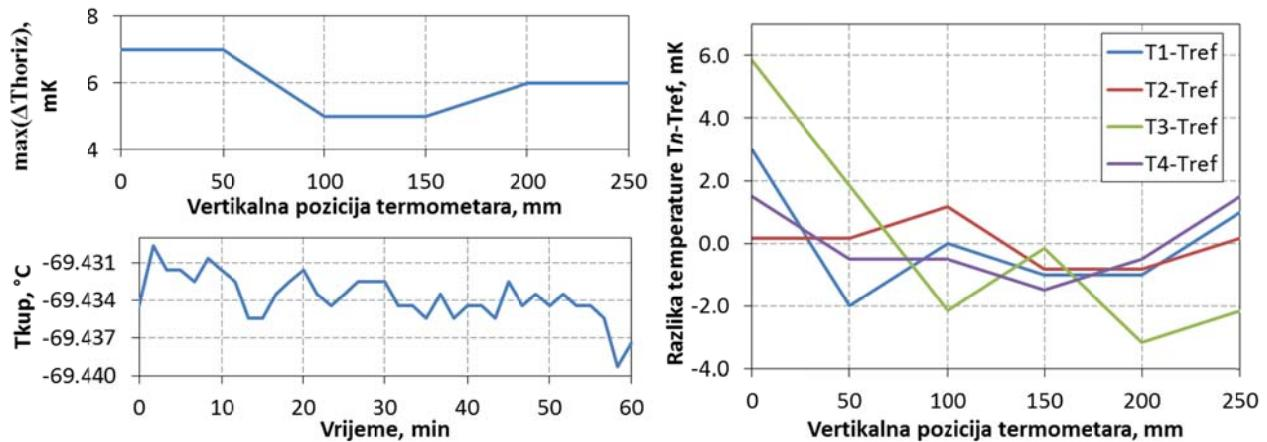
a) Rezultati ispitivanja kupke pri temperaturi  $T_{\text{kup}} = -70^{\circ}\text{C}$
