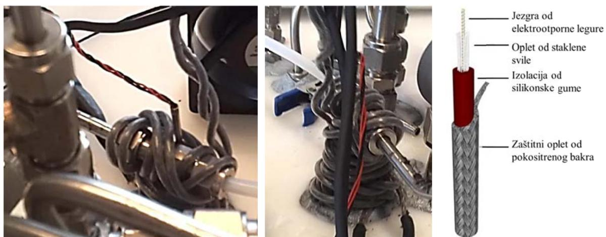
Slika 12.Grijaci kabel na izlaznoj cijevi LRS-a, ilustracija desno iz [43].
