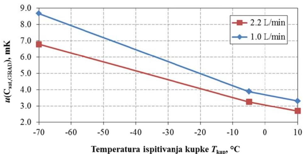
Slika 43. Standardna nesigurnost mjerenja temperature u komori saturatora zbog postojanja vertikalnih temperaturnih gradijenata.
