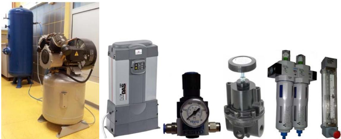
Slika 24. Pojedinačne komponente sustava: bezuljni kompresor i spremnik zraka, adsorpcijski sušač zraka, precizni regulatori tlaka, čestični filter, rotametar.
