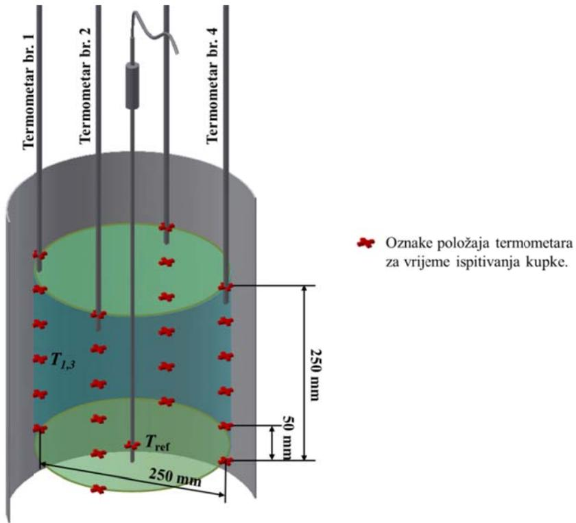
Slika 44. Ispitivanje temperaturnih gradjenata i stabilnosti kupke za LRS.
