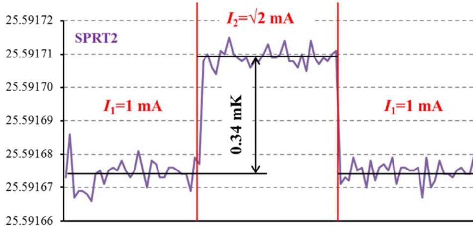
Slika 53. Primjer rezultata ispitivanja samozagrijavanja termometara SPRT1 i SPRT2 u trojnoj točci vode.
