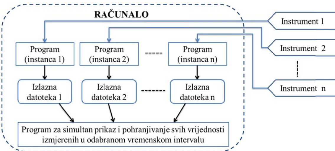
Slika 27. Shematski prikaz više instanci računalnih programa za bilježenje očitanja otpornih mostova/instrumenata.
