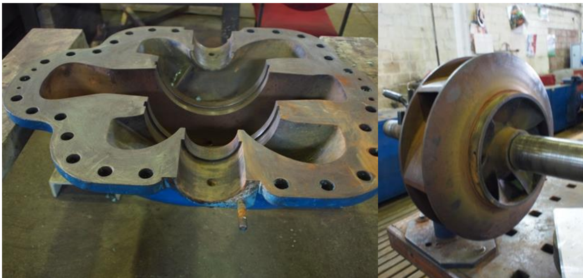
Slika 5.5. Remont booster crpke
