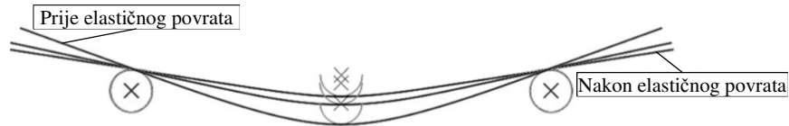
Slika 43: Postupak savijanja u tri točke [79].
