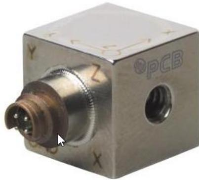
Slika 4.4 Senzor akceleracije PCB 356B21
