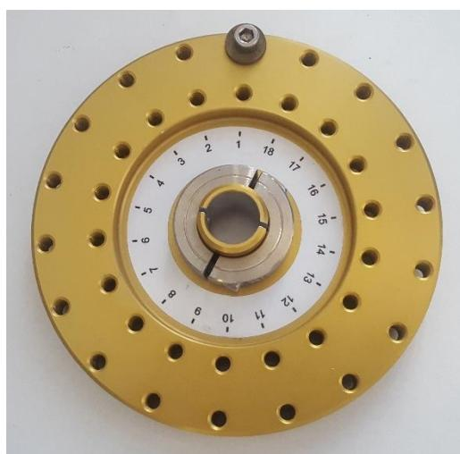
Slika 5.1 Rotor za simulaciju debalansa
