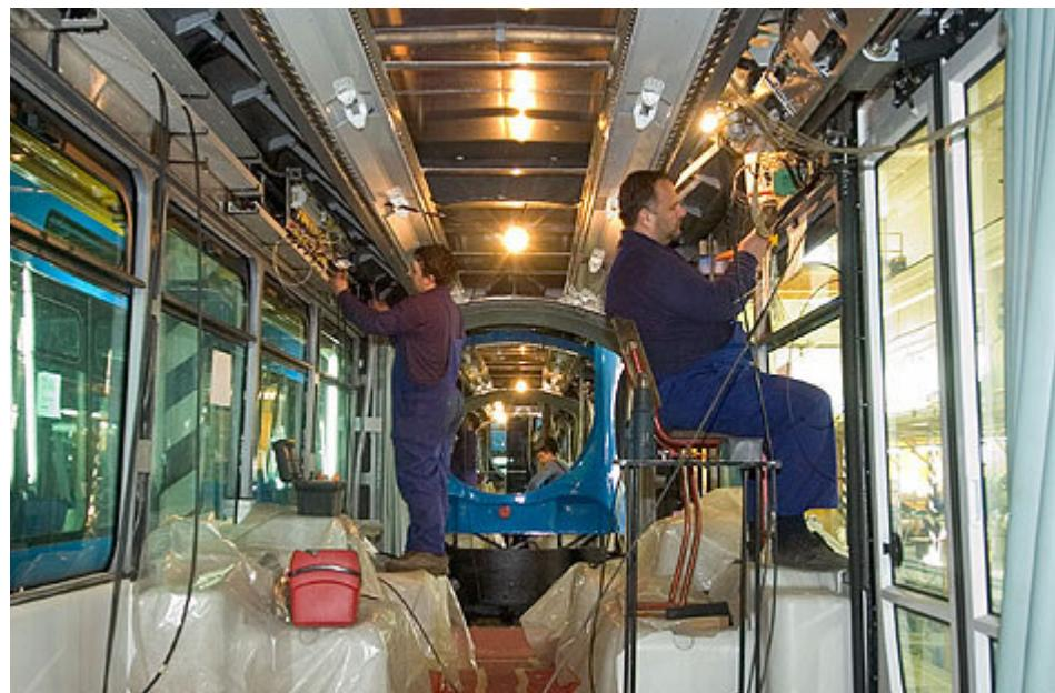
*Slika 22: Ugradnja elektronike [20]*
