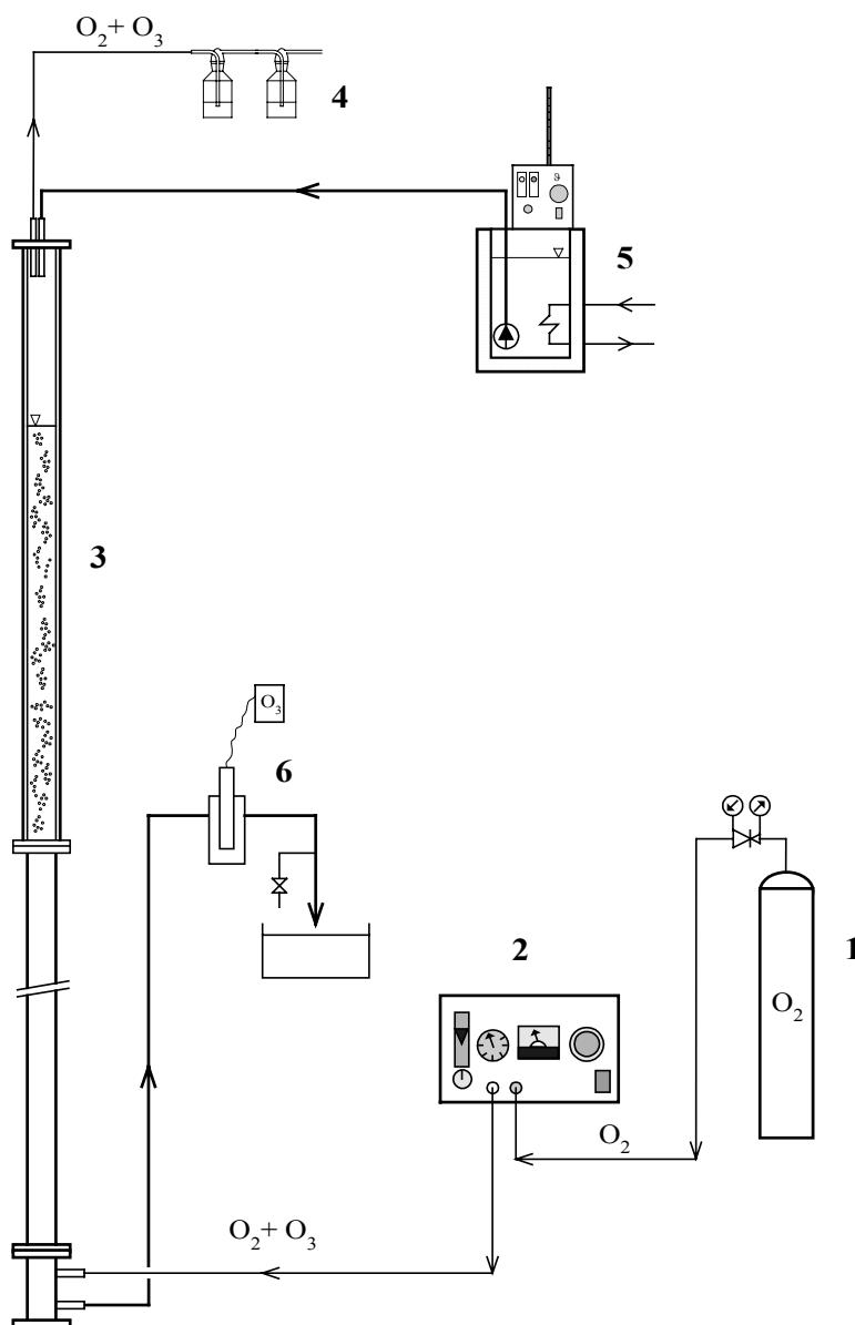
**Slika 23.** Laboratorijski eksperimentalni sustav za protočni način rada
