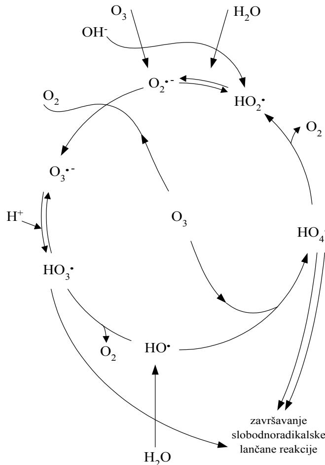
**Slika 7.** Shematski prikaz reakcijskog mehanizma raspada ozona
