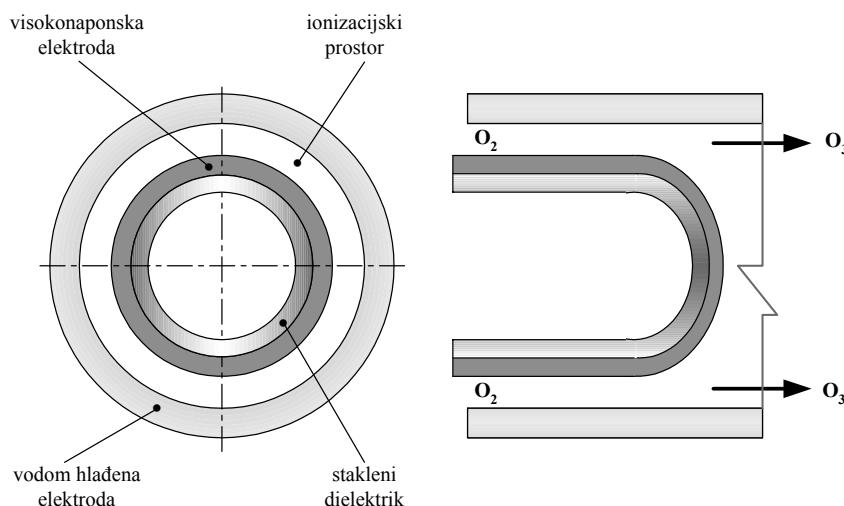
**Slika 16.** Princip rada tipičnog cijevnog generatora ozona
