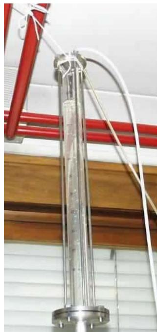
**Slika 24.** Fotografija staklenog vršnog dijela reaktora za ozonizaciju
