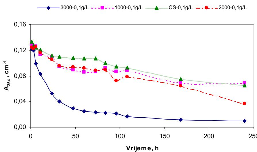
**Slika 65.** Promjena UV apsorbancije kod 254 nm organskih tvari u filtriranoj osječkoj vodi tijekom adsorpcije na četiri aktivna ugljena u granulama jednake koncentracije 0,1 g/l
