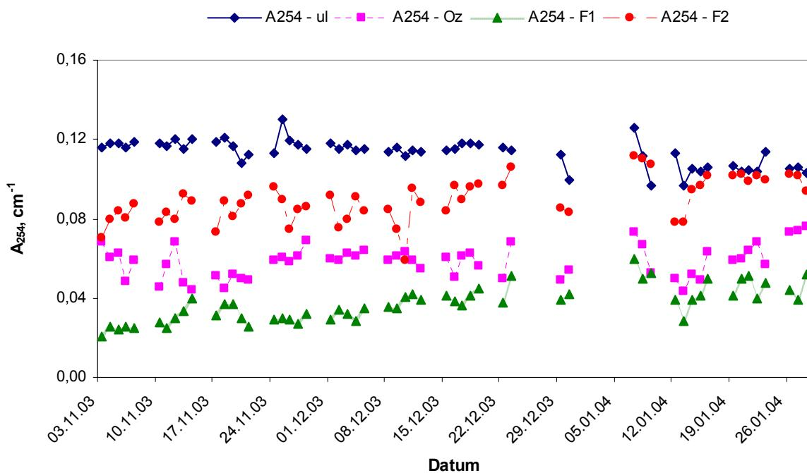
Slika 74. Promjena UV apsorbancije kod 254 nm mjerene na četiri karakteristična mjesta pilot uređaja tijekom tromjesečnog pilotiranja
