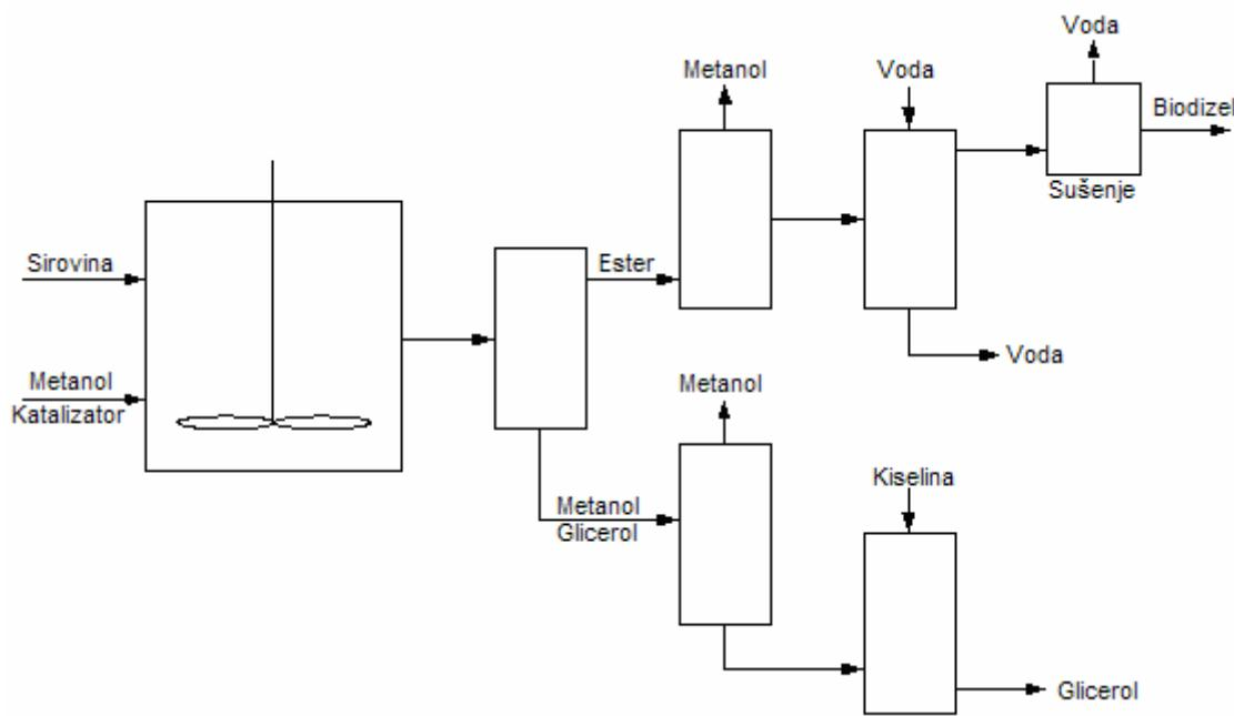
Slika 4.3. Blok shema šaržnog procesa proizvodnje biodizela
