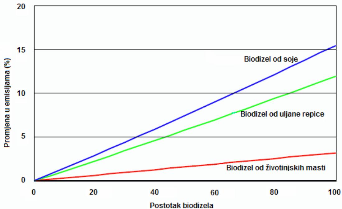
Slika 6.4. Promjena emisija NO<sub>x</sub> u ovisnosti o izvoru sirovine i postotku biodizela u gorivu [6.3]
