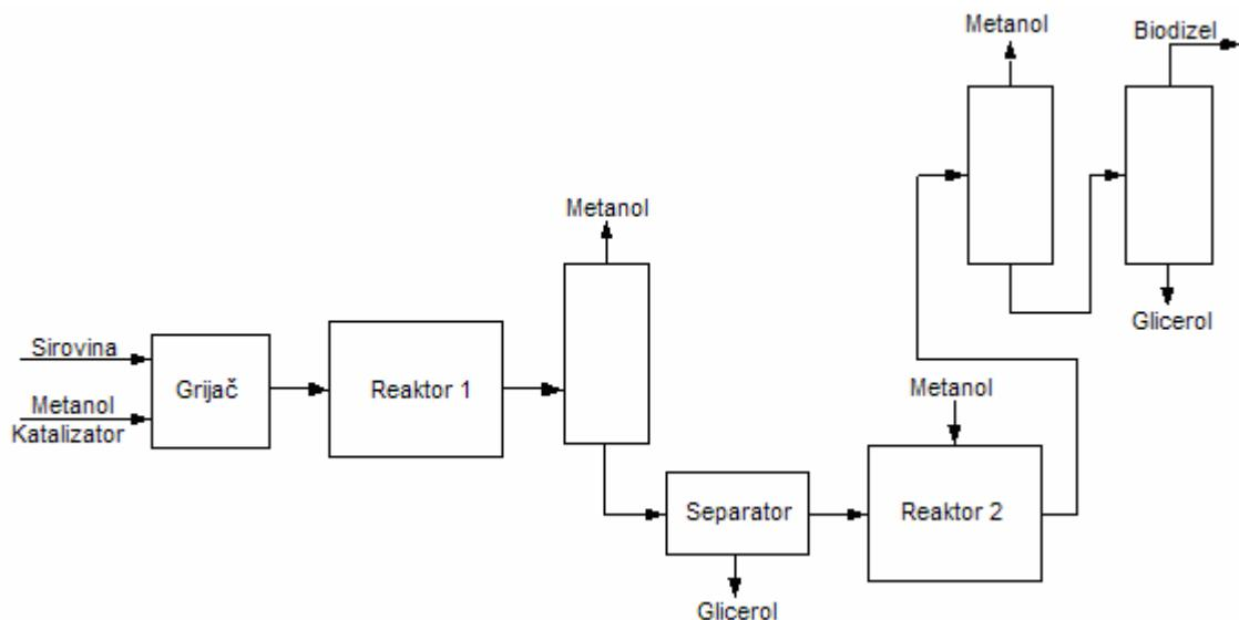
Slika 4.4. Blok shema kontinuiranog procesa proizvodnje biodizela
