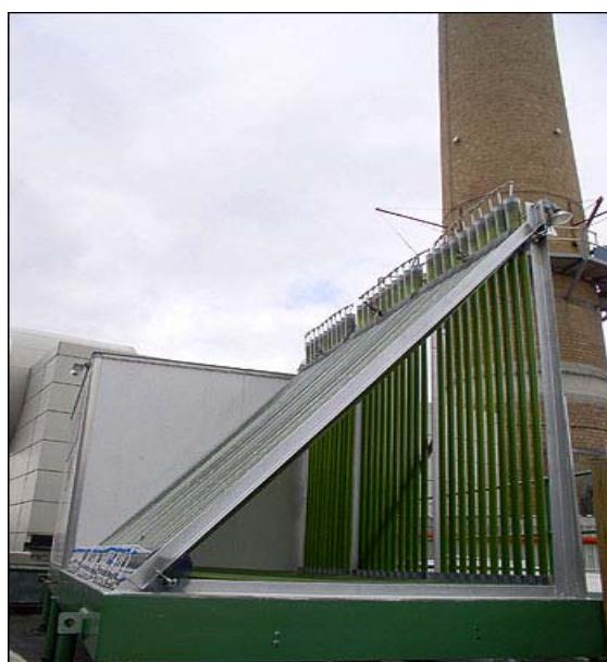
Slika 4.8. Bioreaktor za proizvodnju biodizela od algi
