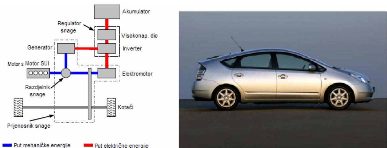
Slika 2.13. Shema pogonskog sustava hibridnog automobila Toyota Prius THS II [2.13]
