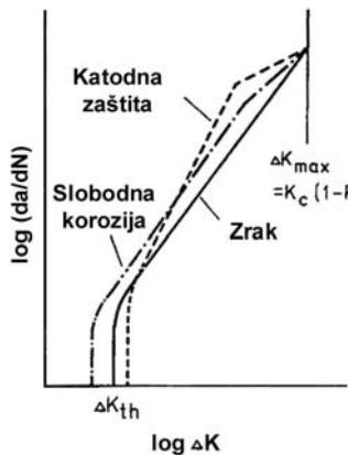
Slika 2.41 Učinak korozije na brzinu rasta pukotine [20]
