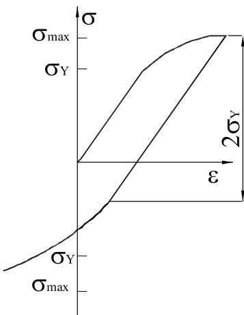
**Slika 3.2:** Bauschingerov efekt
