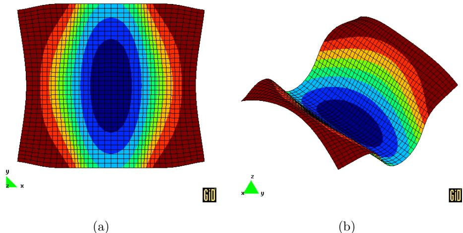
**Slika 7.52:** CILINDRIČNI KROV: deformirani oblik pri zakretu materijalnih osi za  $0^\circ$  a) prikaz u ravnini 12 i b) izometrijski prikaz
