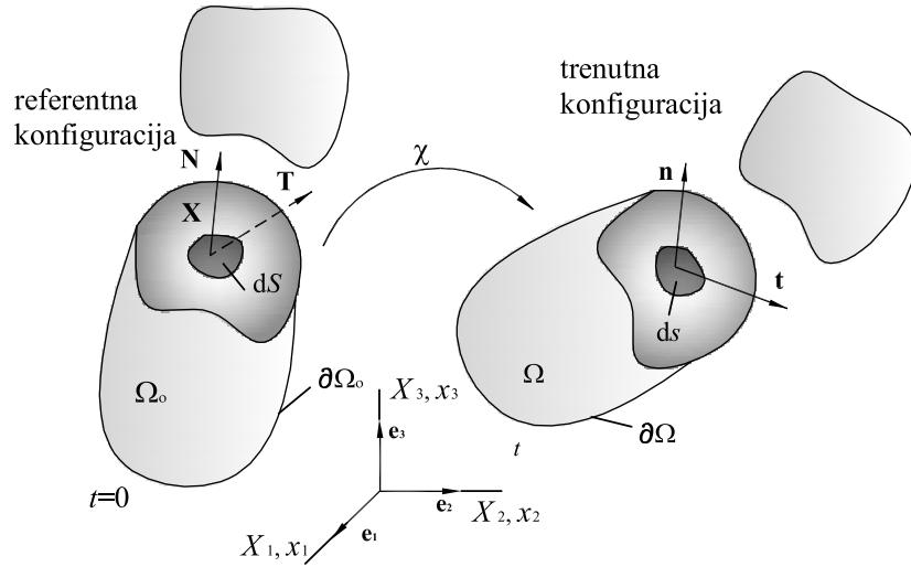
**Slika 2.6:** Vektor naprezanja za referentnu i trenutnu konfiguraciju
