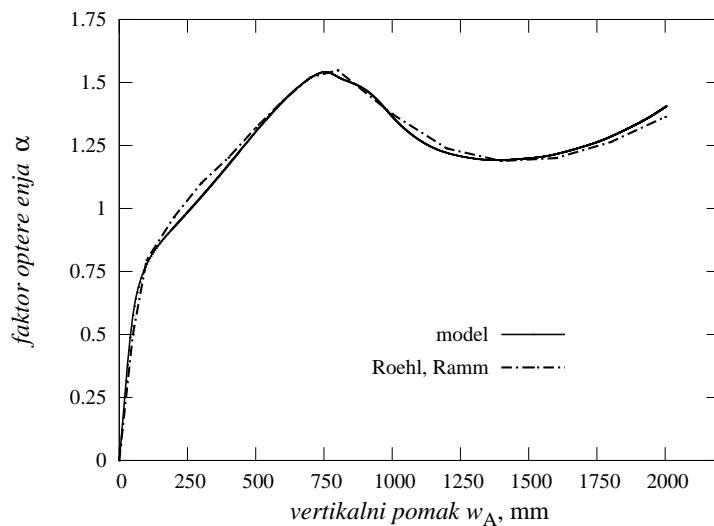
**Slika 7.21:** SCORDELIS-LO: usporedba rezultata izloženog modela za izotropne materijale s rezultatima dobivenim materijalnim modelom izloženim u ROEHL & RAMM [3] za elastičan idealno plastičan slučaj
