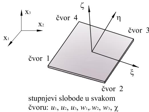
**Slika 6.2:** Četveročvorni ljudkasti konačni element s 28 stupnjeva slobode
