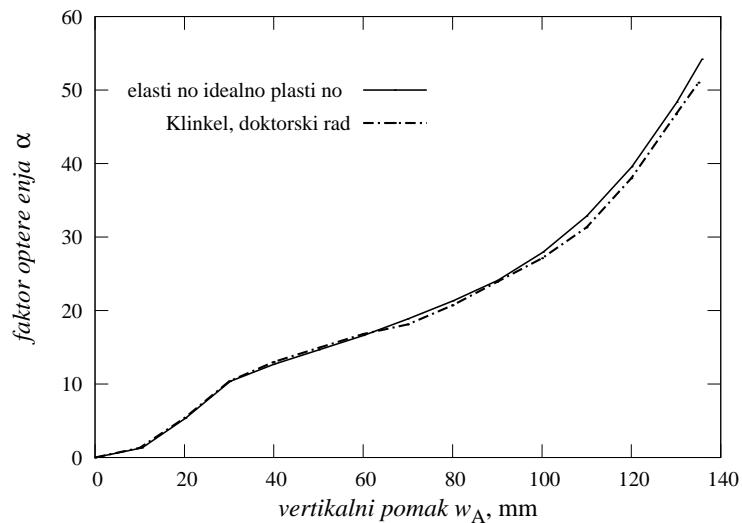
**Slika 7.17:** NAPUHIVANJE KVADRATNE PLOČE: usporedba rezultata izloženog modela za izotropne materijale s rezultatima dobivenim materijalnim modelom izloženim u KLINKEL [2] za elastično-idealnoplastičan slučaj
