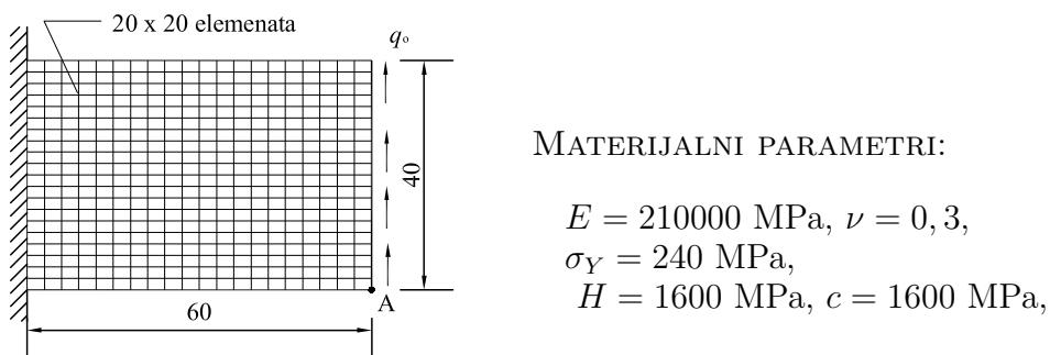
**Slika 7.10:** PRAVOKUTNA PLOČA: geometrija i materijalni parametri
