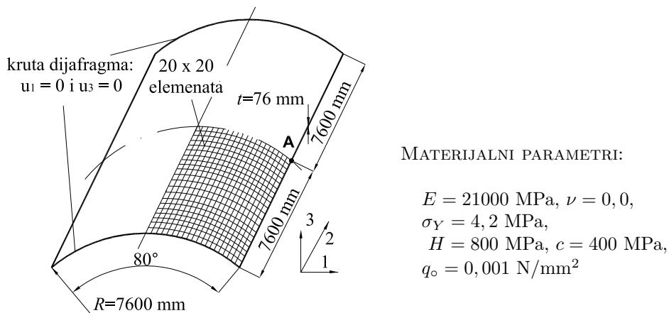
Slika 7.20: SCORDELIS-LO: a) geometrija, b) materijalni parametri
