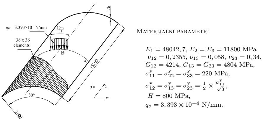
**Slika 7.51:** CILINDRIČNI KROV: geometrija i materijalni parametri
