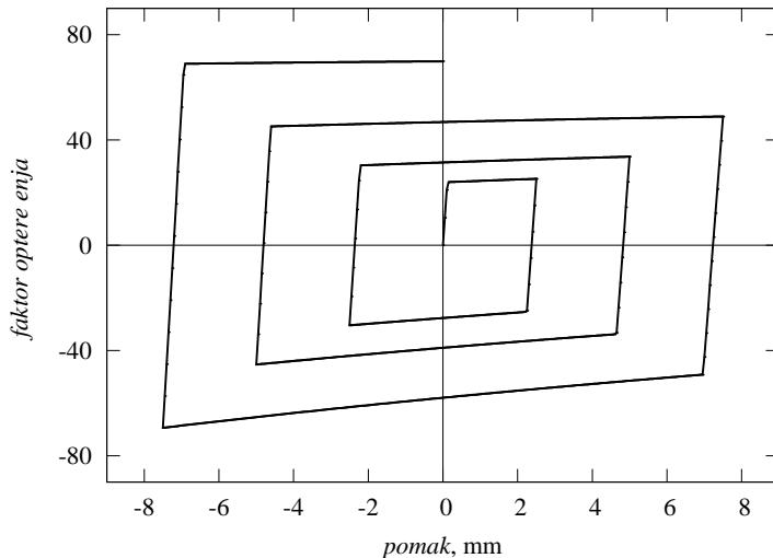
**Slika 7.3:** JEDNOOSNO OPTEREĆENA MEMBRANA: krivulje opterećenja za slučaj kinematičkog očvršćenja
