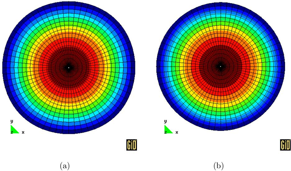
**Slika 7.41:** 'NAPUHIVANJE' KRUŽNE PLOČE: deformirani oblik pri pomaku središnje točke 25 mm za a) materijal A i b) materijal C
