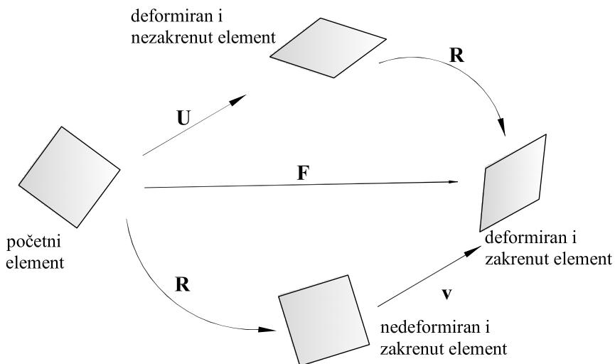
Slika 2.3: Prikaz polarnog razlaganja tenzora gradijenta deformiranja
