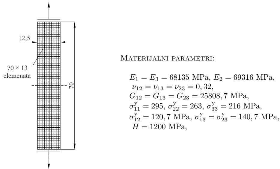
Slika 7.32: JEDNOOSNO OPTEREĆENA EPRUVETA: geometrija i materijalni parametri
