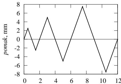
**Slika 7.2:** JEDNOOSNO OPTEREĆENA MEMBRANA: način opterećivanja membrane
