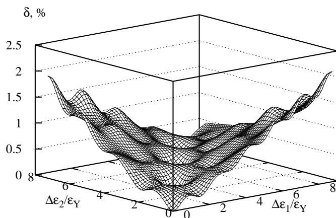
**Slika 7.36:** ISOERROR POSTUPAK: Numerička greška integracijskog postupka u ovisnosti o primijenjenim inkrementima deformacije - slučaj B
