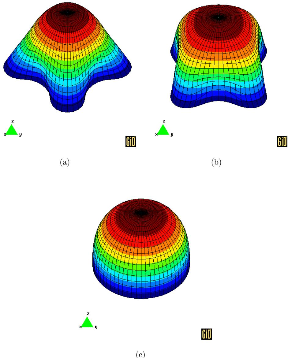
**Slika 7.45:** 'NAPUHIVANJE' KRUŽNE PLOČE: izometrijska projekcija deformirane konfiguracije za a) materijal A, b) materijal C i c) materijal B
