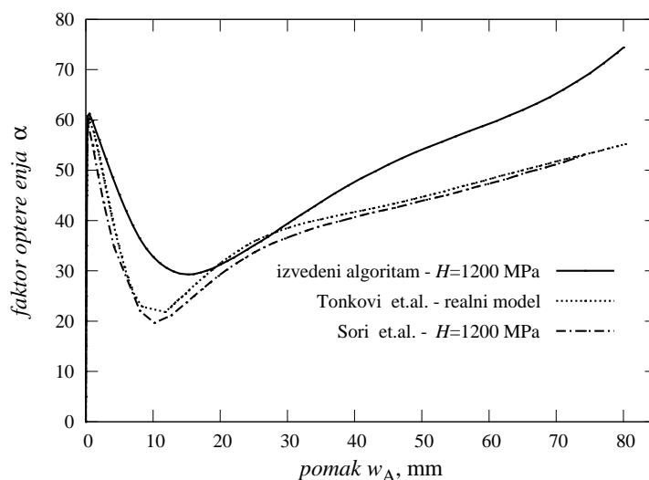
**Slika 7.25:** SFERA: usporedba rezultata izloženog modela za izotropne materijale s rezultatima dobivenim materijalnim modelom izloženim u SORIĆ ET AL. [4] and TONKOVIĆ ET AL. [5] pri izotropnom očvršćenju i uz slobodne rotacije gornjeg ruba
