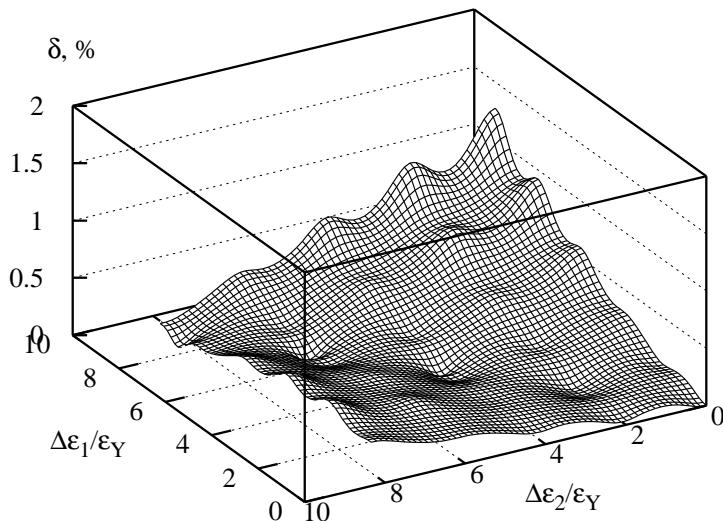
**Slika 7.37:** ISOERROR POSTUPAK: Numerička greška integracijskog postupka u ovisnosti o primijenjenim inkrementima deformacije - slučaj C
