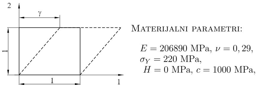
**Slika 7.6:** ČISTO SMICANJE: geometrija i materijalni parametri
