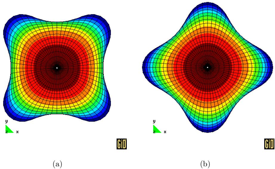
**Slika 7.43:** 'NAPUHIVANJE' KRUŽNE PLOČE: deformirani oblik pri pomaku središnje točke 75 mm za a) materijal A i b) materijal C
