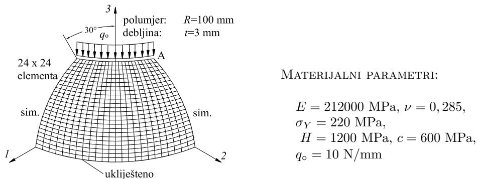
**Slika 7.24:** SFERA: geometrija i materijalni parametri
