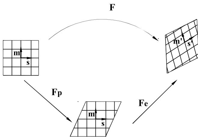
**Slika 2.4:** Mikromehanički efekti deformiranja na klizne sustave
