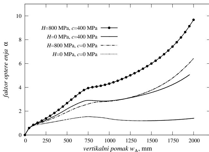
**Slika 7.22:** Scordelis-Lo: usporedba rezultata izloženog modela za izotropne materijale za elastičan idealno plastičan slučaj, za slučaj izotropnog, kinematičkog očvršćenja kao i izotropnog i kinematičkog očvršćenja
