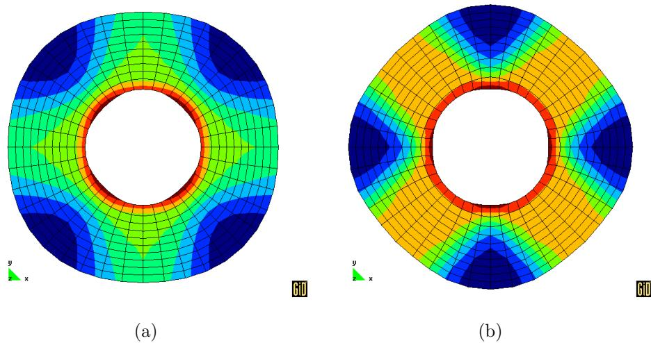
**Slika 7.48:** RADIJALNO OPTEREĆENA PLOČA: deformirani oblik pri pomaku točke T od 40 mm za a) materijal A i b) materijal C
