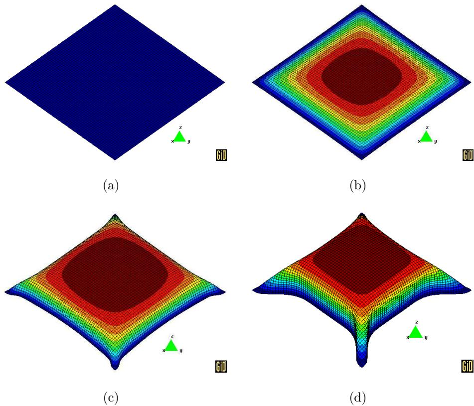
**Slika 7.19:** NAPUHVANJE KVADRATNE PLOČE: deformirani oblik materijala s izotropnim i kinematičkim očvršćenjem za pomak a)  $w_A = 0$  mm, b)  $w_A = 33$  mm, c)  $w_A = 85$  mm i d)  $w_A = 140$  mm
