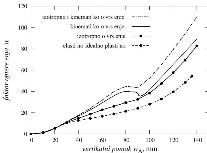
**Slika 7.18:** NAPUHIVANJE KVADRATNE PLOČE: usporedba rezultata izloženog modela za izotropne materijale za elastičan idealno plastičan slučaj, za slučaj izotropnog, kinematičkog očvršćenja kao i izotropnog i kinematičkog očvršćenja
