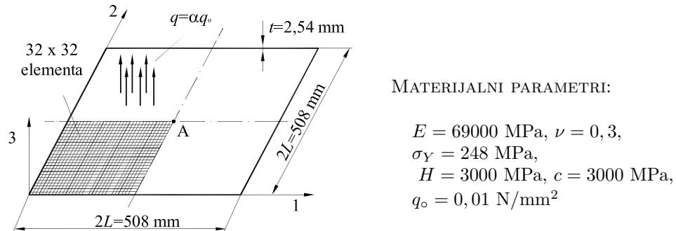
**Slika 7.16:** NAPUHIVANJE KVADRATNE PLOČE: geometrija i materijalni parametri
