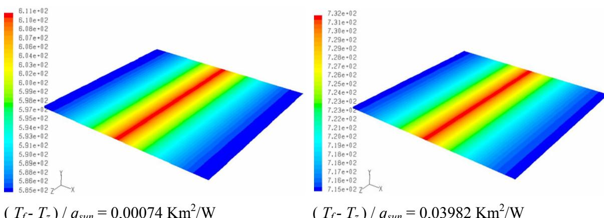
*Slika 5.26 Prikaz raspodijele toplinskog toka  $q_{kol}$  ( $\text{W}/\text{m}^2$ ) koji se predaje vodi u cijevi koja je zavarena cijelom duljinom za segment apsorbera*
