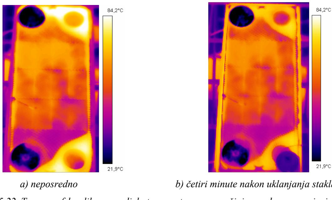
*Slika 5.22 Termografska slika raspodjela temperatura po površini apsorbera nezasjenjenog prototipa a) neposredno i b) nekoliko minuta nakon uklanjanja pokrovног stakla*
