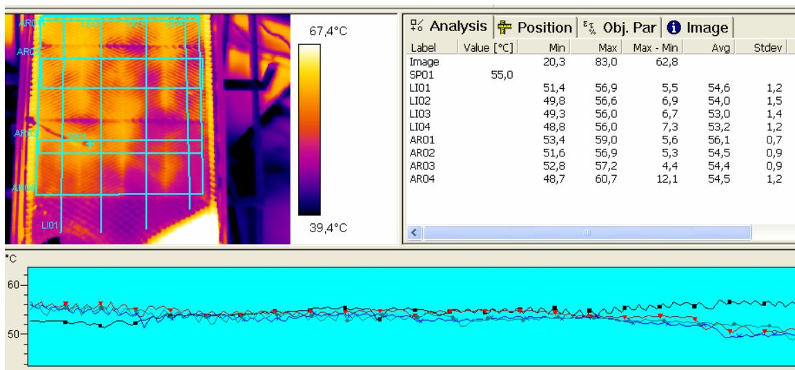
Slika 5.23b Termografska slika raspodjele temperaturnog polja provedenoj u ThermaCam Researcher (emisivnost površine određena kao  $\varepsilon = 0,89$ ). Dijagram prikazuje temperature koje odgovaraju paralelnim linijama LI01÷LI04, dok su AR01÷AR04 površine, a SP01 je oznaka za točku.
