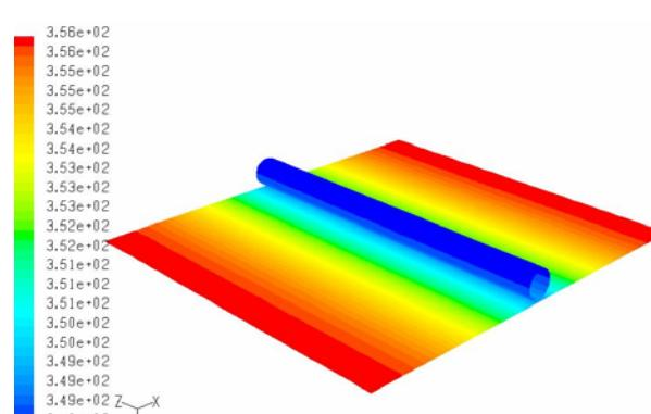
*Slika 5.25 Prikaz raspodijele temperature (K) na segmentu apsorbera sa cijevi zavarenom za ploču apsorbera cijelom duljinom*
