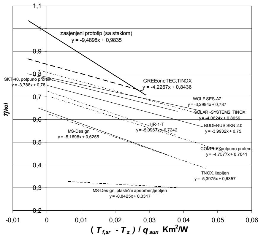
Slika 3.17 Usporedba mjerjenjem dobivenih vrijednosti  $\eta_{kol}$  zasjenjenog prototipa i raznih tipova cijevnih kolektora
