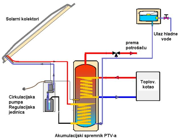
Slika 1.2 Shema sustava za zagrijavanje PTV-a
