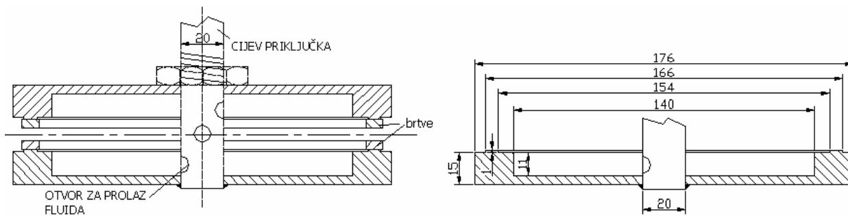
Slika 3.5 Izgled i dimenzije prirubnica sa brtvama na ulaznim/izlaznim otvorima ploča prototipa
