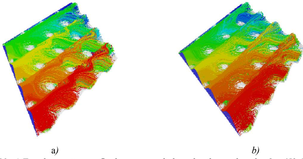
Slika 7.11 a) Trajektorije čestica fluida na putu od ulaza do izlaza iz kanala,  $\beta = 65^\circ$ ,  $Re = 705$
