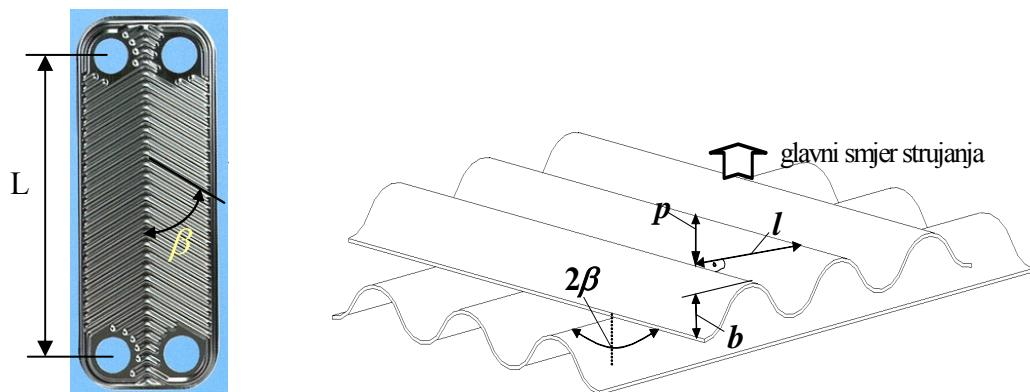
*Slika 1.6 Geometrija kanala pločastog izmjenjivača,  $\beta$  - kut žlijebova u odnosu na uzdužnu os ploče;  $b$ -dubina žlijeba;  $p$  – širina žlijeba u smjeru strujanja,  $l$  - širina žlijeba okomito na smjer pružanja žlijeba,  $L$  proračunska duljina ploče*
