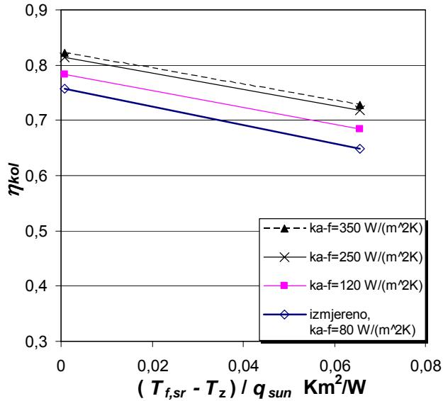
Slika 2.18 Rezultati mjerena i simulacija rada kolektora SKT-40 za različite kvalitete kontakta apsorbera i cijevi opisane uz pomoć  $k_{a,f}$  pri  $\varepsilon = 0.106$  i  $\tau = 0.9$ .
