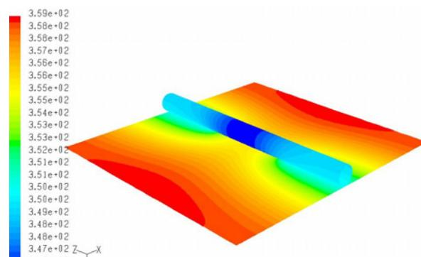
Slika 5.27 Prikaz raspodijele temperature (K) na segmentu apsorbera s djelomično zavarenom cijevi
