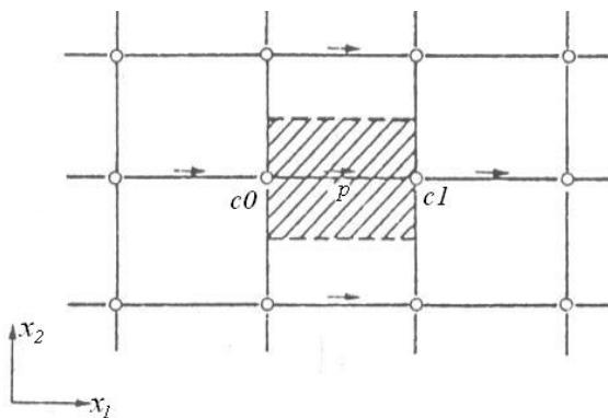
Slika 6.2 Pomaknuti "staggered" kontrolni volumen korišten za diskretizaciju jednadžbe količine gibanja, [36]
