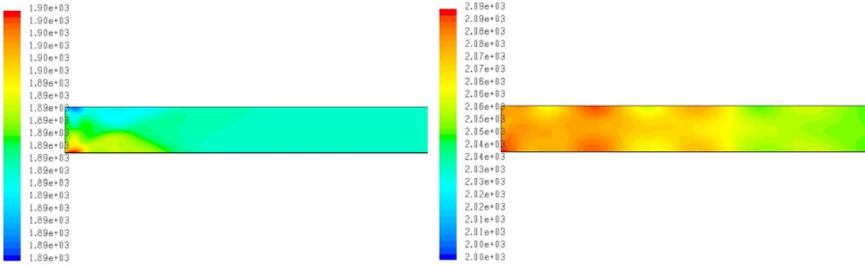
Slika 5.9 Raspodjela ukupnog dolaznog zračenja  $q_{zr}$  ( $\text{W}/\text{m}^2$ ) na plohe pojedinog kontrolnog volumena u numeričkoj domeni drugog modela kolektor (apsorber  $\varepsilon = 0.06$ , staklo  $\varepsilon = 0.88$ )
