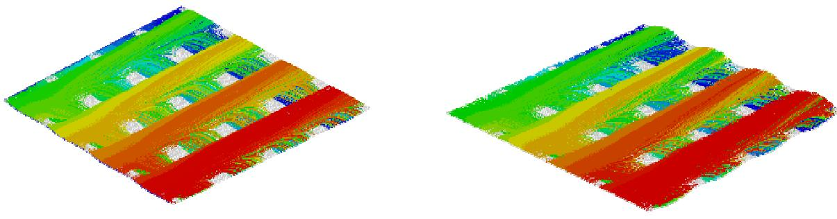
Slika 7.15 a) Trajektorije čestica fluida na putu od ulaza do izlaza iz kanala,  $\beta = 28^\circ$ ,  $Re = 885$ ,
