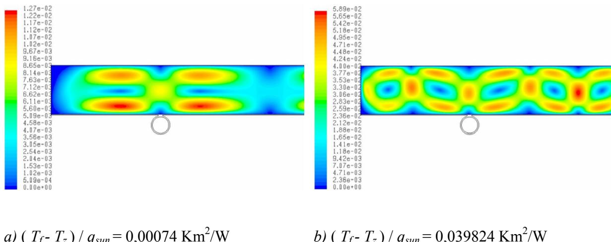
Slika 5.2 Profil brzina (m/s) između apsorbera i stakla
