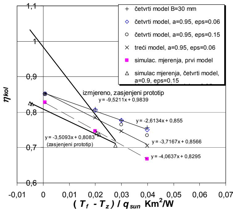
Slika 5.12 Usporedba vrijednosti  $\eta_{kol}$  dobivenih iz rezultata mjerena i simulacija za prvi, treći i četvrti model kolektora
