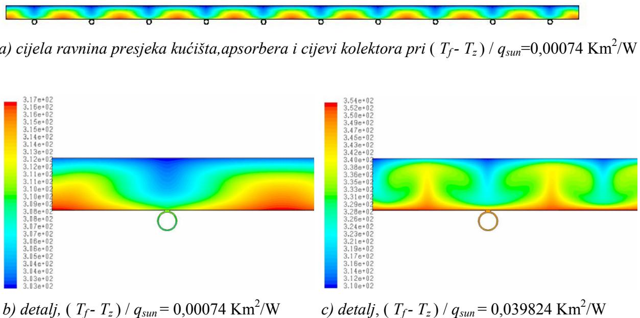
Slika 5.1 Raspodjela temperatura (K) u numeričkoj domeni prvog modela cijevnog kolektora
