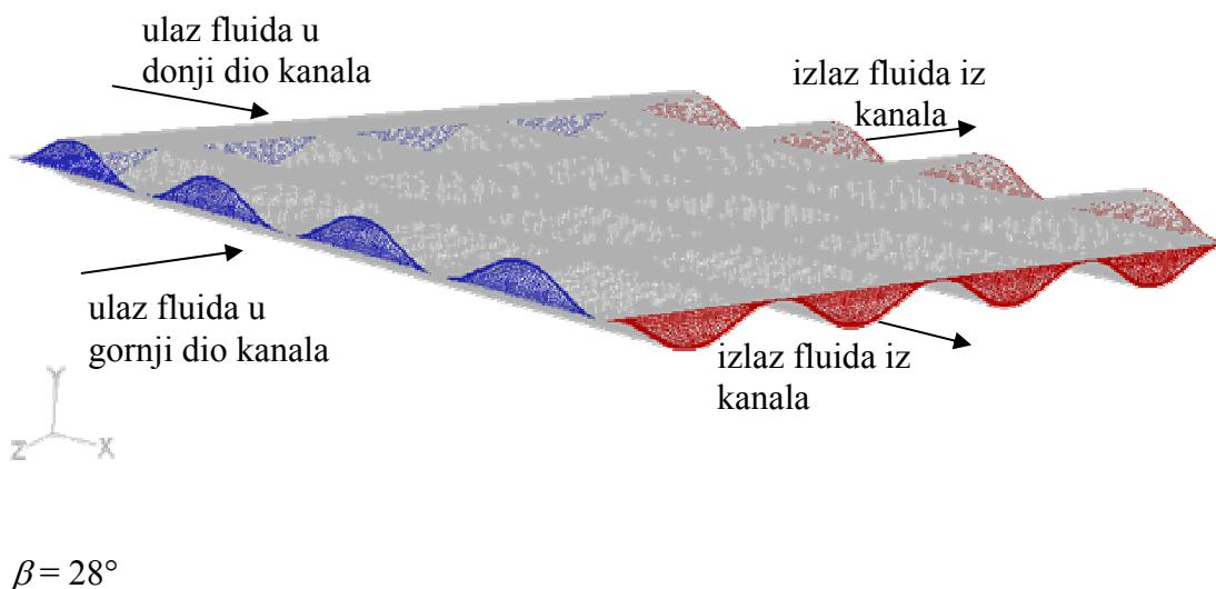
Slika 7.1b Prikaz modela kanala pločastog izmjenjivača sa  $\beta = 28^\circ$  od kojih se svaki sastoji od 16 čelija dubine žlijeba  $b = 2.05 \text{ mm}$  i širine  $l = 8 \text{ mm}$
