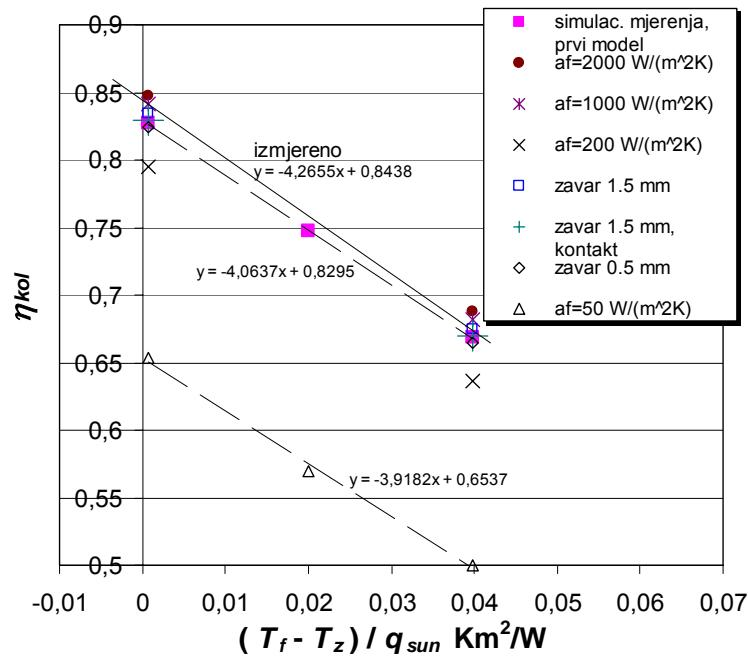
Slika 5.3 Usporedba vrijednosti  $\eta_{kol}$  dobivenih iz rezultata mjerjenja i simulacija za prvi model cijevnog kolektora
