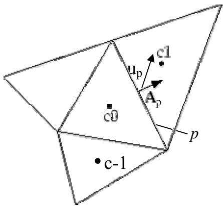
Slika 6.1 Dvodimenzionalni prikaz kontrolnih volumena korištenih za ilustraciju diskretizacije transportne jednadžbe (6.5)
