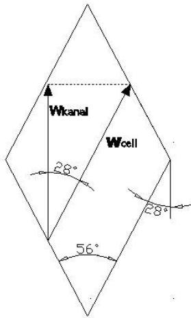
Slika 7.7 Međusobni odnos vektora brzina u čeliji s  $\beta = 28^\circ$
