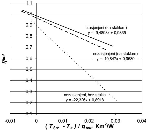
Slika 3.15 Usporedba rezultata svih mjerena na prototipu
