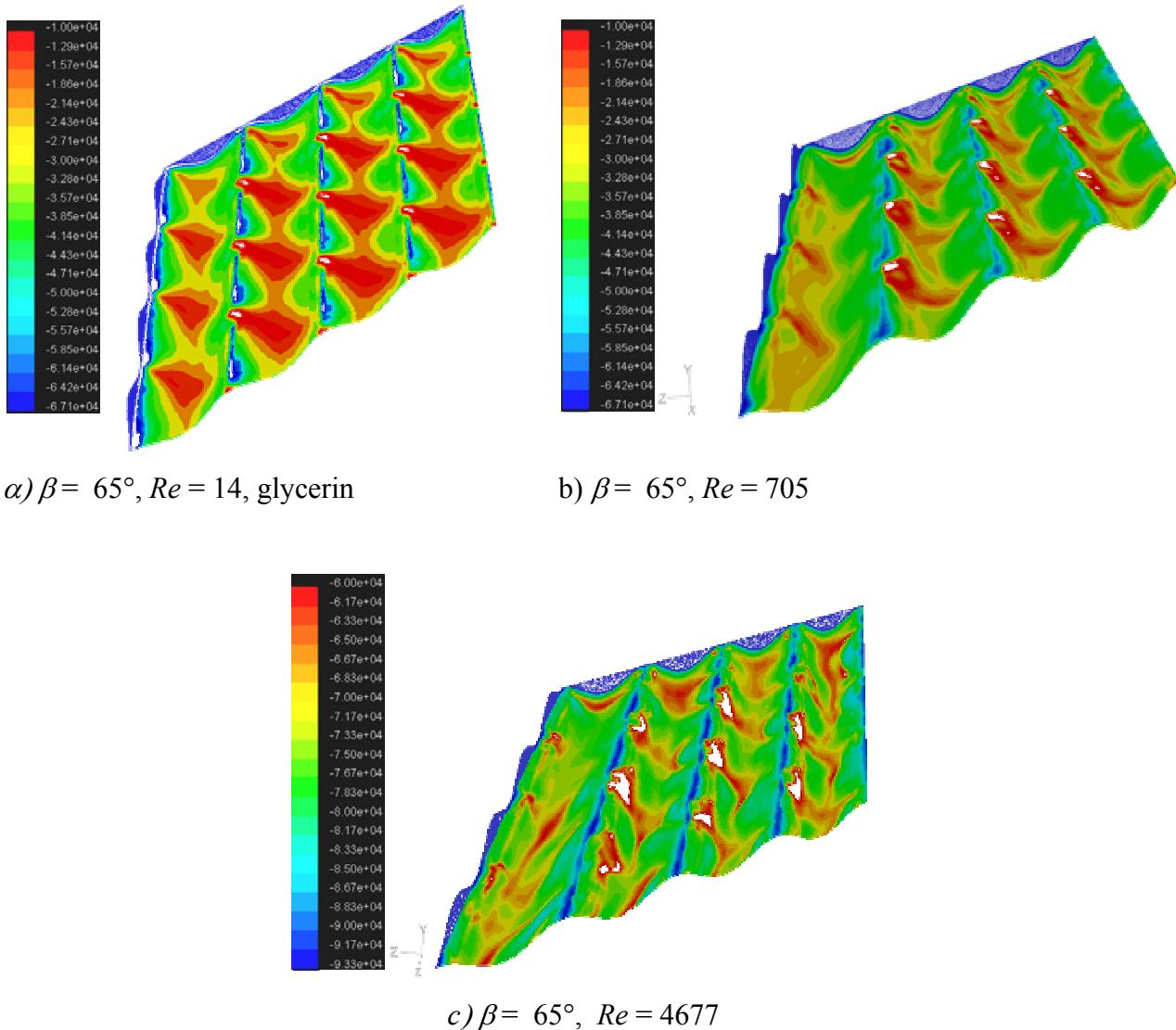
*Slika 7.22a Raspodjela izmijenjenog specifičnog toplinskog toka  $q$  ( $W/m^2$ ) pri laminarnim, prijelaznim i turbulentnim uvjetima strujanja*
