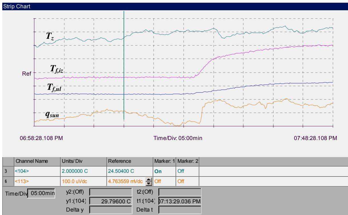
Slika 3.11 Prikaz stacioniranja temperatura tijekom mjerena učina prototipa kolektora, prikaz sučelja programskog paketa "Agilent BenchLink Data Logger"
