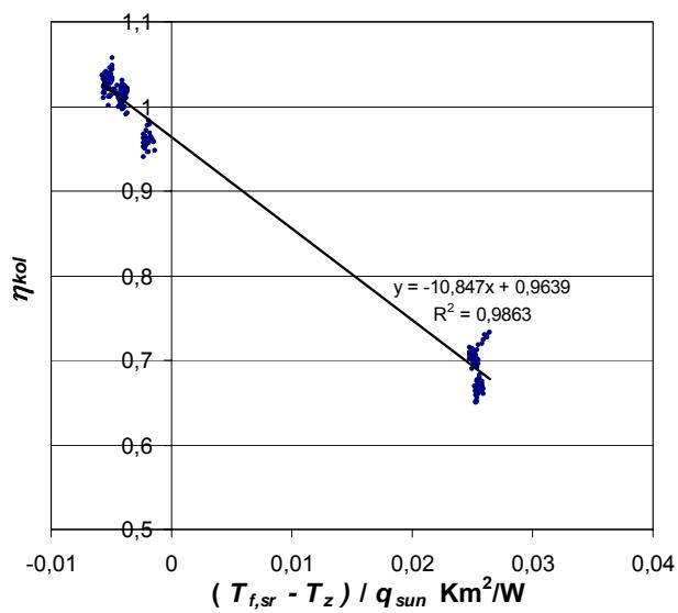
Slika 3.13 Rezultati mjerena učinkovitosti nezasjenjenog prototipa sa pokrovnim staklom
