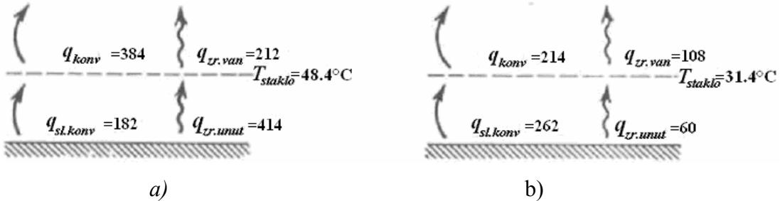
Slika 2.10 Utjecaj koeficijenta emisije neselektivnog apsorbera ( $\varepsilon = 0.95$ ) (a) i selektivnog ( $\varepsilon = 0.1$ ) (b) na toplinske gubitke kolektora ( $\text{W}/\text{m}^2$ ) pri temperaturi apsorbera od  $100^\circ\text{C}$  i okolišnog zraka od  $10^\circ\text{C}$ ,  $\beta = 45^\circ$ , [26]
