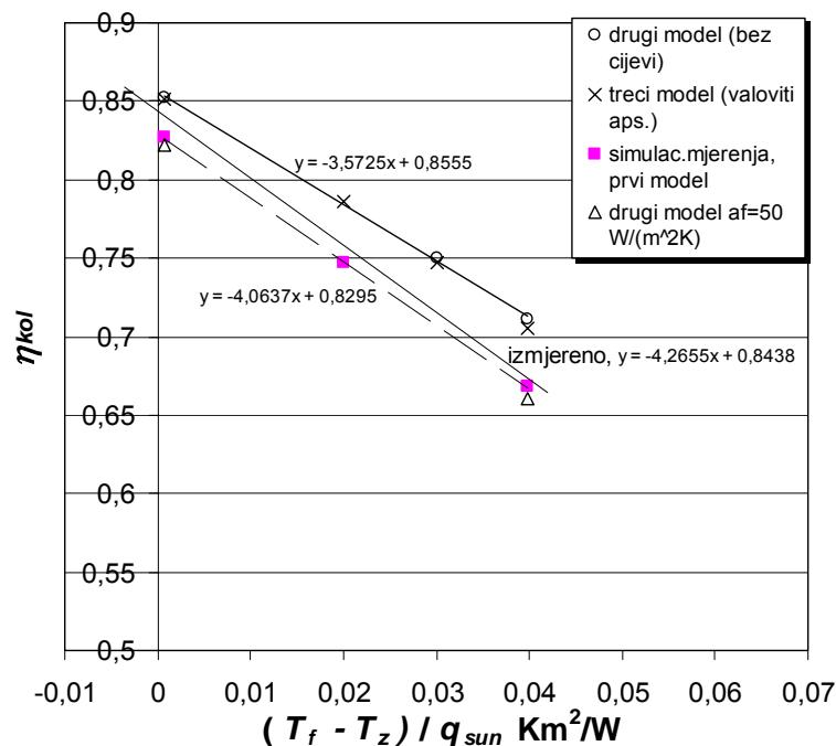
Slika 5.10 Usporedba vrijednosti  $\eta_{kol}$  dobivenih iz rezultata mjerena i simulacija za prvi, drugi i treći model kolektora
