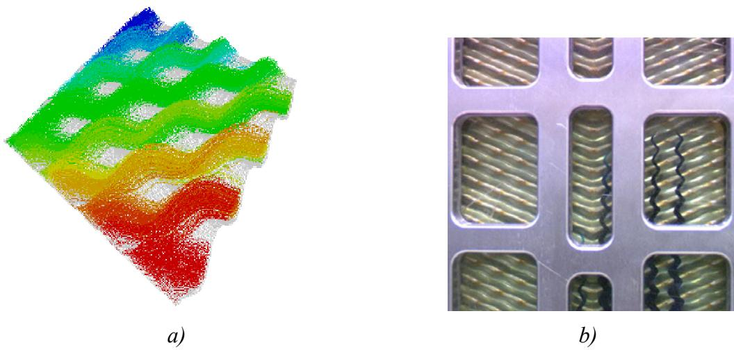
Slika 7.9 a) Trajektorije čestica fluida na putu od ulaza do izlaza iz kanala,  $\beta = 65^\circ$ ,  $Re = 14$ ,
