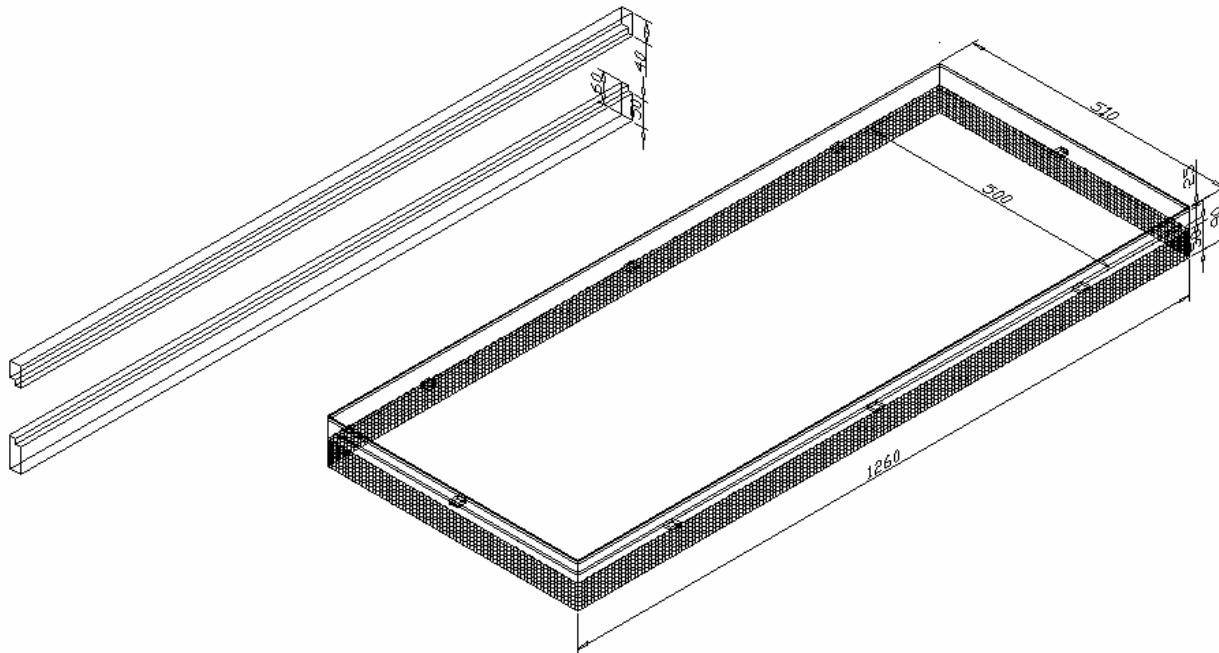
Slika 3.6 Dimenzije kućišta prototipa
