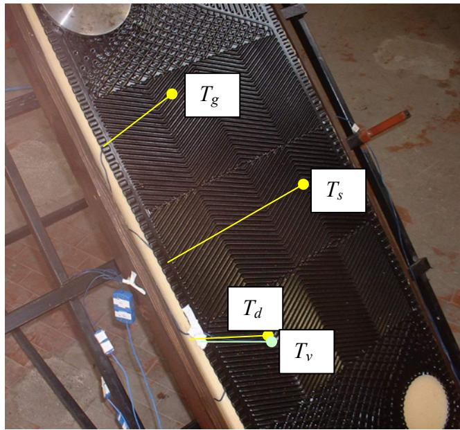
*Slika 3.10 Pozicija termoparova koji mjere temperature ploče apsorbera,  $T_g$ ,  $T_s$ ,  $T_d$  - temperature izolirane donje ploče,  $T_v$  - temperaturna ploča apsorbera*
