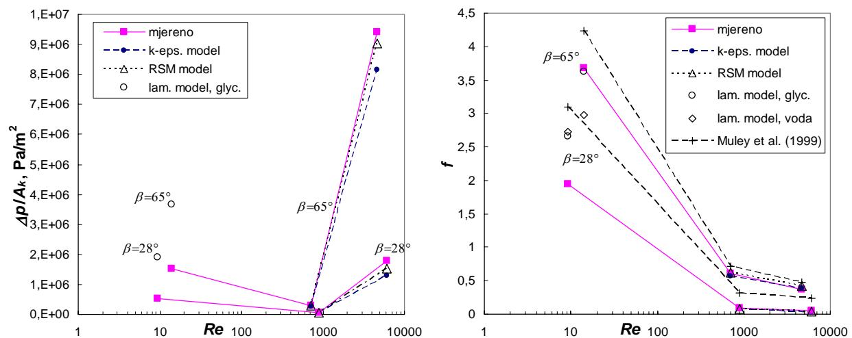
Slika 7.20 Usporedba simuliranog i mjerenoj pada tlaka
