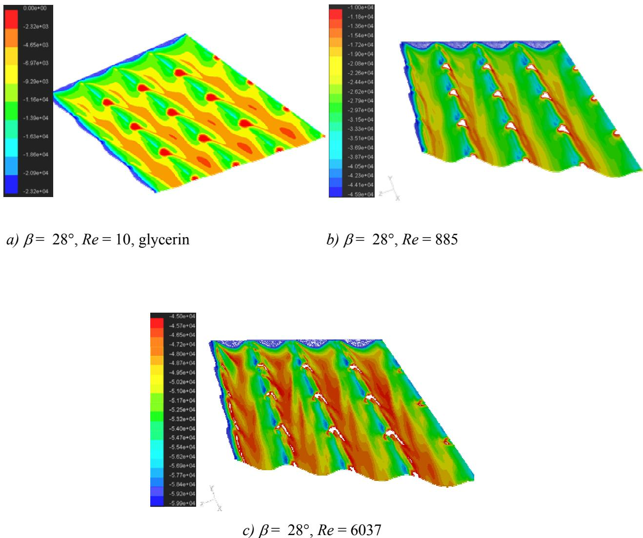
Slika 7.22b Raspodjela izmijenjenog specifičnog toplinskog toka  $q$  ( $W/m^2$ ) pri laminarnim, prijelaznim i turbulentnim uvjetima strujanja
