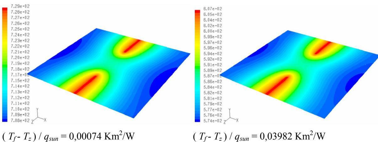
Slika 5.28 Prikaz raspodijele toplinskog toka  $q_{kol}$  ( $\text{W}/\text{m}^2$ ) koji se predaje vodi u cijevi koja je djelomično zavarena za segment apsorbera
