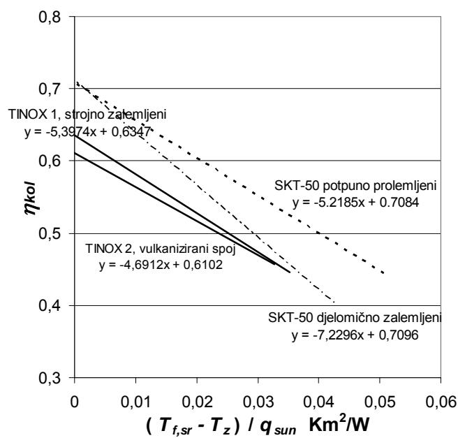
Slika 2.16 Rezultati mjeranja na modelu SKT-50 i geometrijski identičnim modelima s TINOX premazom apsorbera, te na različite načine ostvarenim spojevima apsorbera i cijevnog registra
