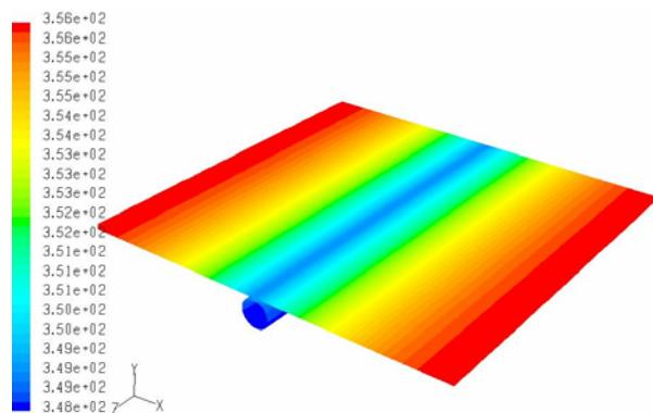
Slika 2.5 Prikaz rebra pojedine cijevi i raspodijele temperatura (K)
