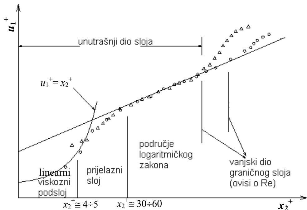
Slika 6.3 Raspodjela brzine u turbulentnom graničnom sloju uz prikaz podjele graničnog sloja
