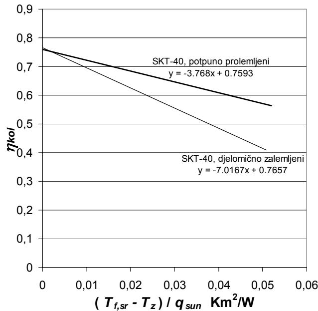
Slika 2.15 Rezultati mjeranja na dva različito prolemjena kolektora s cijevnom serpentinom
