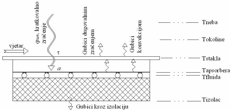
*Slika 2.1 Prikaz izmjene topline u cijevnom kolektoru s pokrovnim stakлом*
