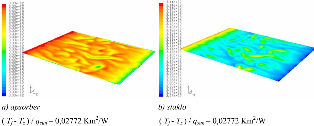
*Slika 5.17 Prikaz raspodijele temperature (K) na apsorberu i staklu zasjenjenog prototipa kolektora (peti model)*
