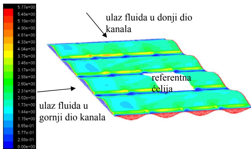
Slika 7.23 Položaj celije na koju se odnose vrijednosti toplinskog toka u dijagramu uz prikaz raspodjela bezdimenzionalne udaljenosti središta prvog kontrolnog volumena od stjenke  $x_2^+$  po površini gornje ploče kanala ( $\beta = 28^\circ$ ,  $Re = 6037$ )
