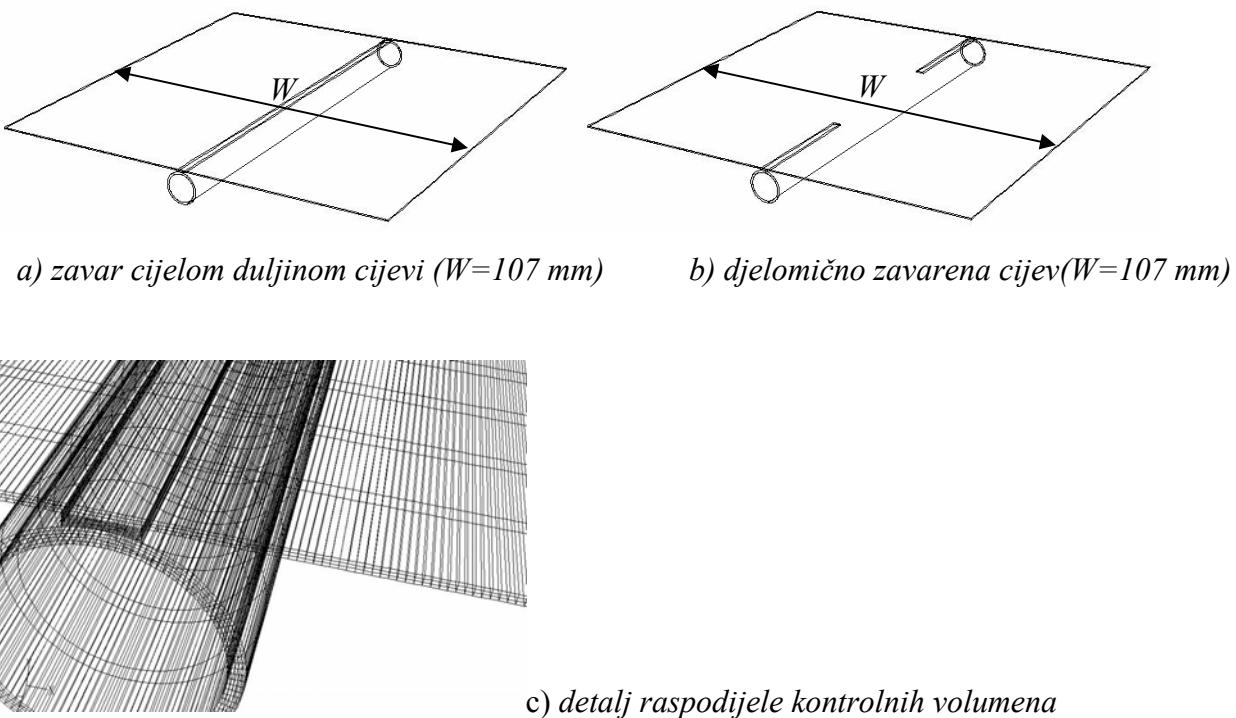
Slika 4.13 3D numerička domena modela segmenta ispitanih cijevnog kolektora (sedmi model)
