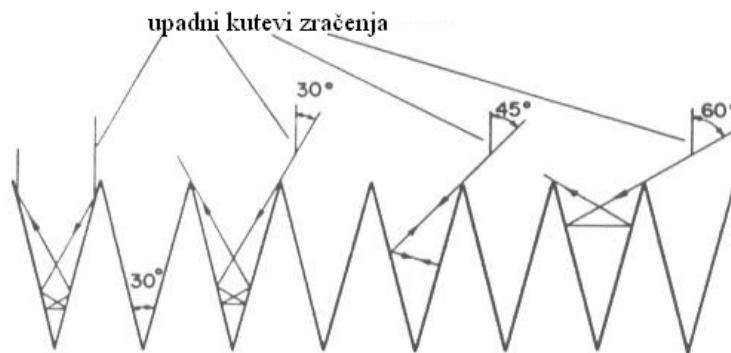
Slika 2.21 Apsorpcija odbijenog zračenja od stijenki V-utora, kut otvora žlijebova  $30^\circ$ , [26]
