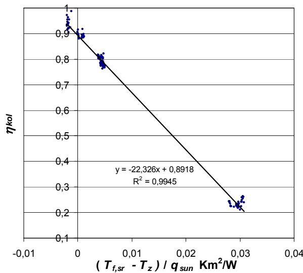
Slika 3.12 Rezultati mjerena učinkovitosti nezasjenjenog prototipa kada je uklonjeno pokrovno staklo
