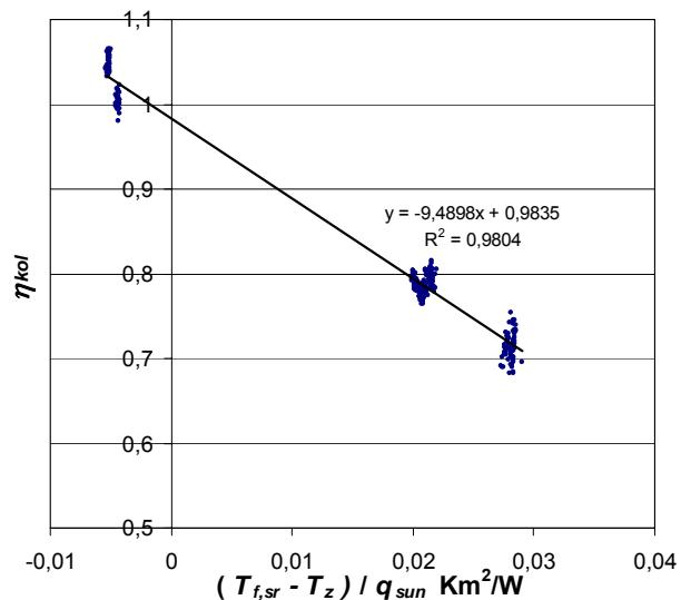
Slika 3.14 Rezultati mjerena učinkovitosti zasjenjenog prototipa sa pokrovnim staklom
