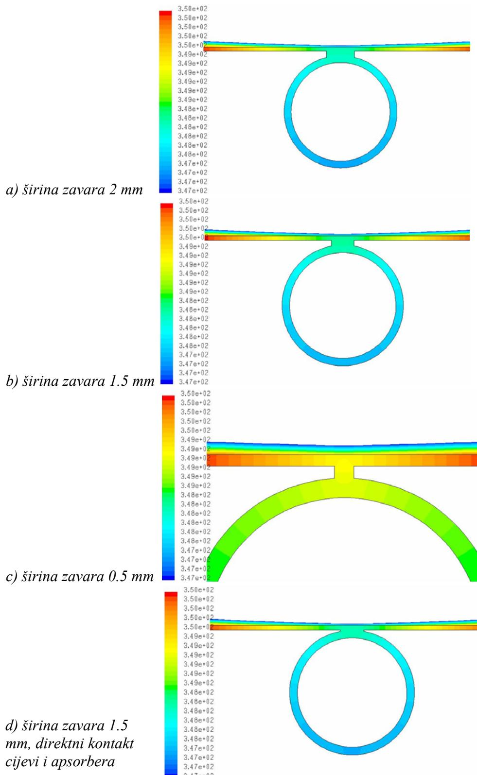
Slika 5.4 Utjecaj dimenzije zavara na temperaturnu raspodjelu (K) u području spoja cijevi i apsorbera pri  $(T_f - T_z) / q_{sun} = 0,039824 \text{ Km}^2/\text{W}$
