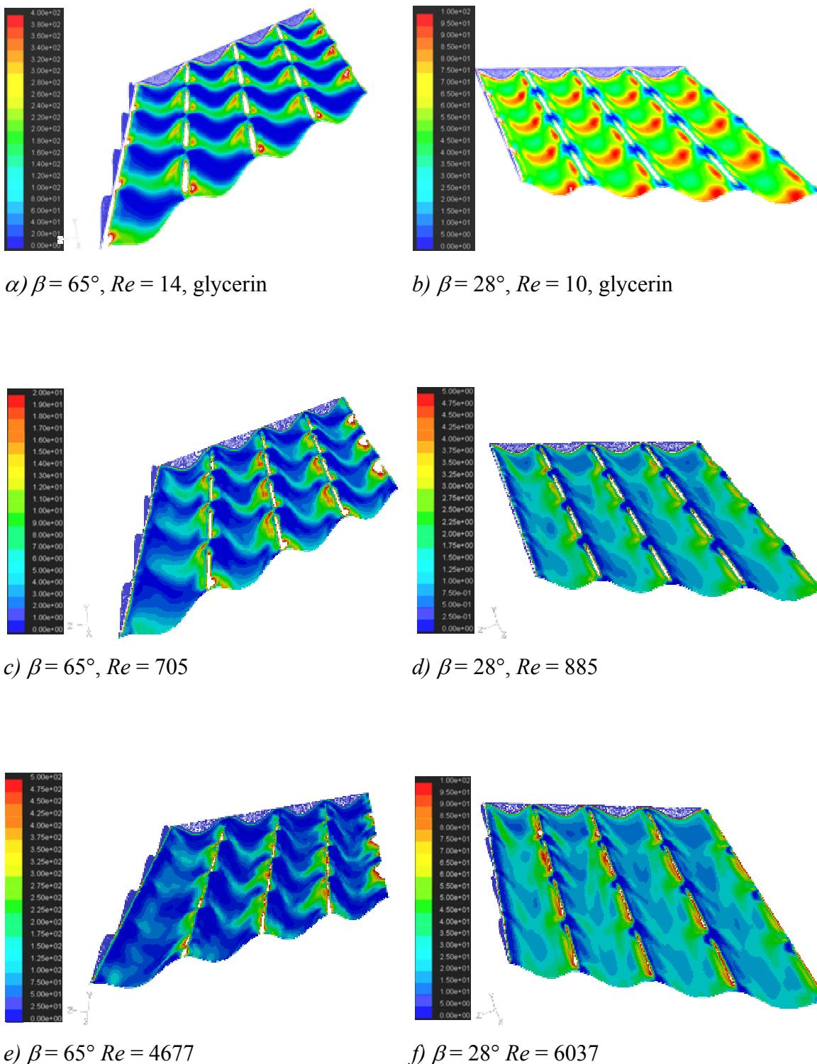
Slika 7.21 Raspodjela naprezanja u fluidu uz stjenku  $\tau_{sij}$  ( $N/m^2$ )
