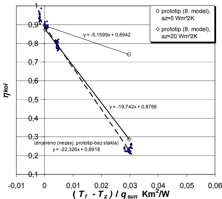
Slika 5.32 Usporedba vrijednosti  $\eta_{kol}$  dobivenih iz rezultata mjerena i simulacija za osmi model otkrivenog kolektora
