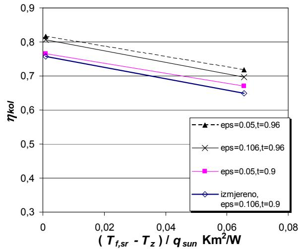
Slika 2.11 Rezultati mjerjenja i simulacije rada kolektora SKT-40 (Tehnomont, HR) za razne koeficijente emisije selektivnog premaza  $\varepsilon$  i koeficijente transmisije stakla  $\tau$ , uz nepromijenjeni koeficijent apsorpcije  $a = 0.95$ .
