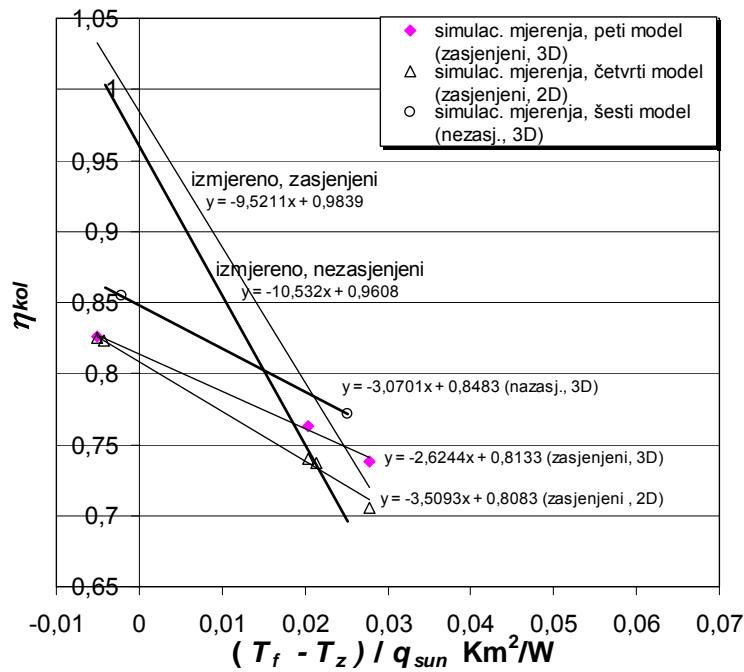
Slika 5.24 Usporedba vrijednosti  $\eta_{kol}$  dobivenih iz rezultata mjerena i simulacija za četvrti, peti i šesti model prototipa kolektora
