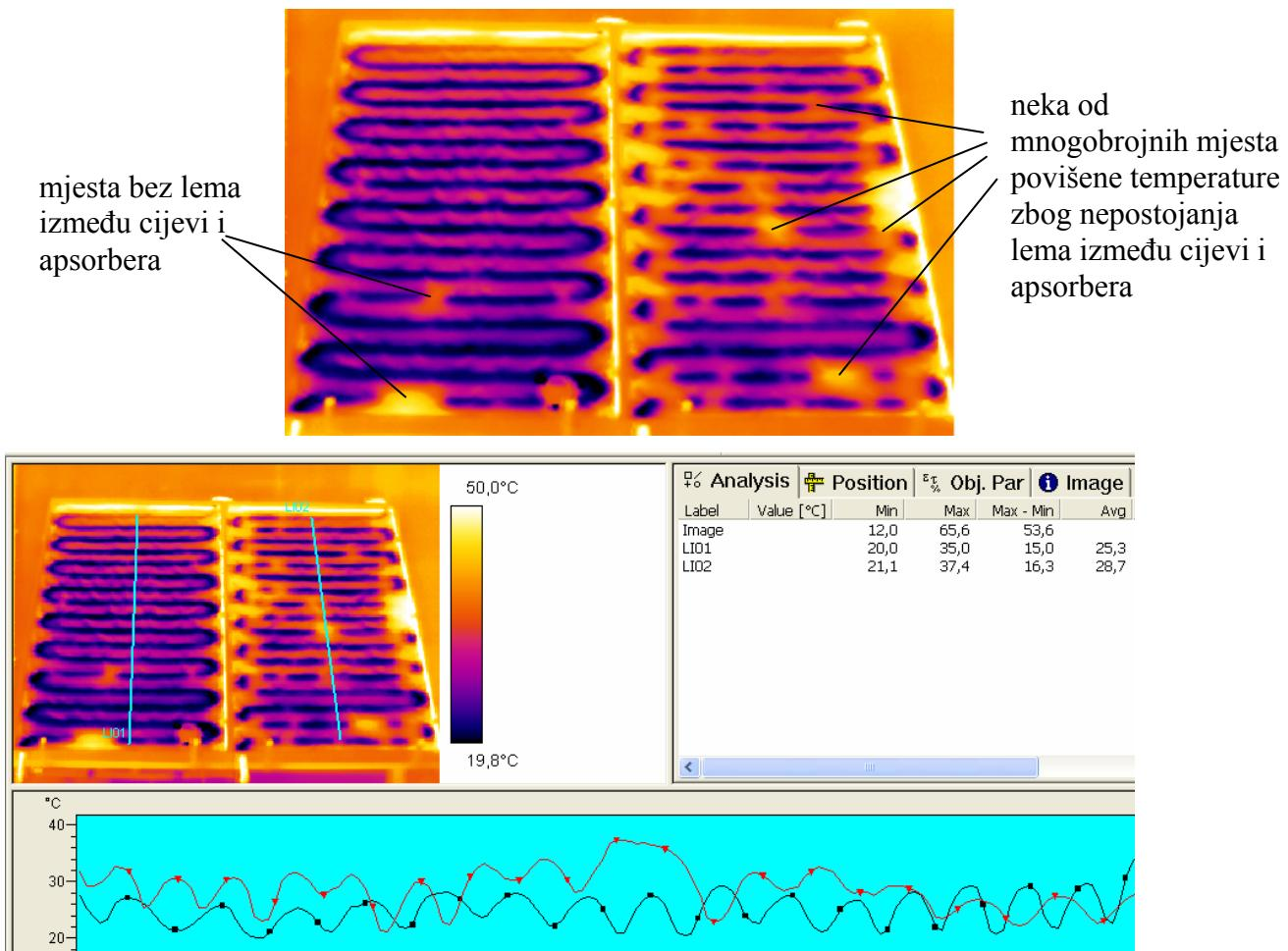
Slika 5.29 Termografska snimka raspodijele temperature na apsorberu cijevnog kolektora tip Tehnomont SKT, lijevi kolektor je uglavnom u potpunosti prolemlijen dok je desni tek djelomično
