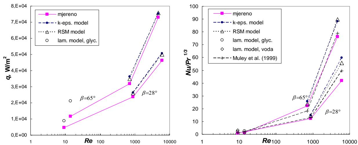
Slika 7.24 Rezultati simulacije izmjenjene topline, usporedba s mjeranjima i [11,12]
