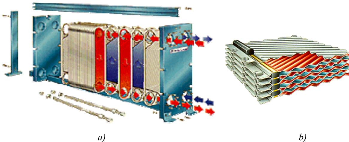
Slika 3.2 a) Rasprodjela dviju struja koje izmjenjuju toplinu u pločastom izmjenjivaču topline s brtvama, b) detalj zavarenih ploča u "kazete" odvojenih složenih u izmjenjivački paket i međusobno odvojenih brtvama paketa-tzv. "poluzavarena" izvedba
