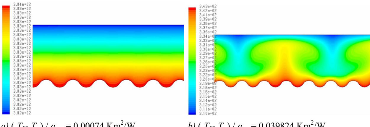
Slika 5.7 Raspodjela temperaturna (K) u numeričkoj domeni trećeg modela kolektora (valoviti apsorber)
