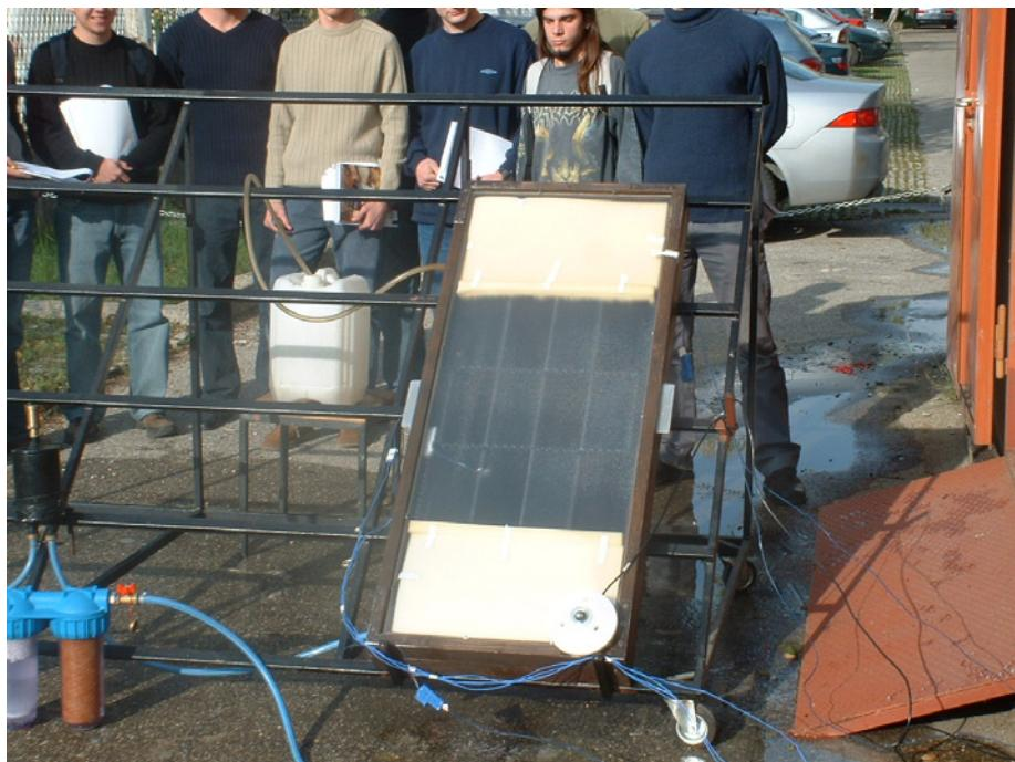
Slika 3.9 Fotografija dijela mjerne linije pri mjerenu zasjenjenog prototipa
