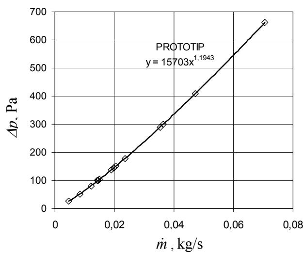
Slika 3.18 Rezultati mjerena pada tlaka fluida kroz kanal prototipa
