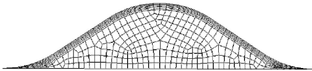
Slika 7.4 Prikaz nestrukturirane mreže kontrolnih volumena na površini presjeka jedne ćelije paralelnoj sa ulaznom/izlaznom površinom kanala kreiranoj od elemenata oblika kvadra metodom "pave" i "tri primitive" (u kutovima)
