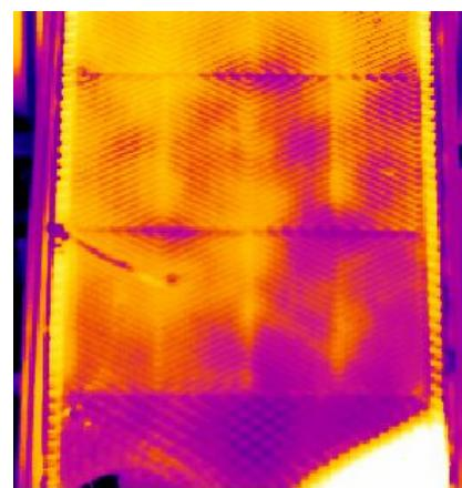
*Slika 5.23a Termografska slika raspodjela temperature po površini apsorbera nezasjenjenog prototipa*
