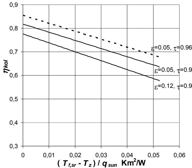
Slika 2.12 Krivulje učinkovitosti dobivene mjeranjima na tri kolektora tip EURO C20 različitim svojstava selektivnog premaza i pokrovног stakla
