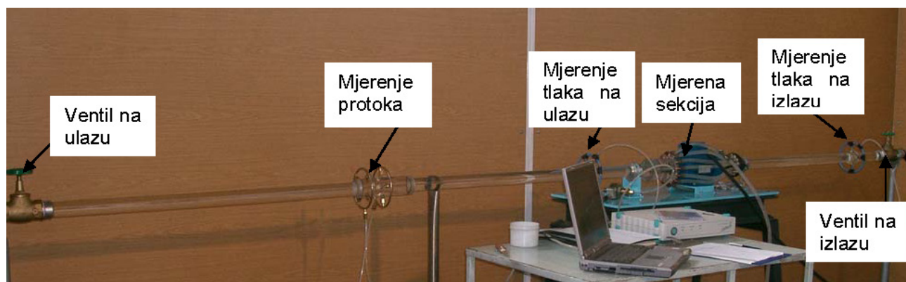
Slika 25 Eksperimentalna linija za ispitivanja CV i V pumpe
