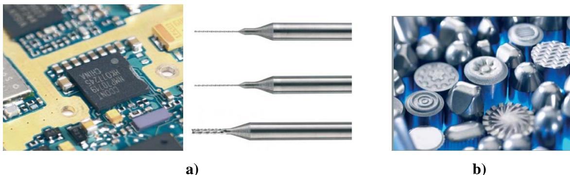
**Slika 4.4. - Primjeri primjene tvrdih metala [34]**
