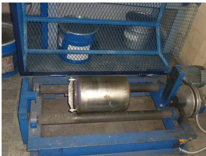
**Slika 5.8. - Horizontalni kuglični mlin korišten pri postupku sinteriranja u vodiku**
