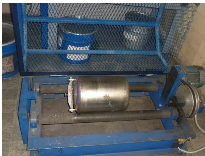
Slika 5.8. - Horizontalni kuglični mlin korišten pri postupku sinteriranja u vodiku
