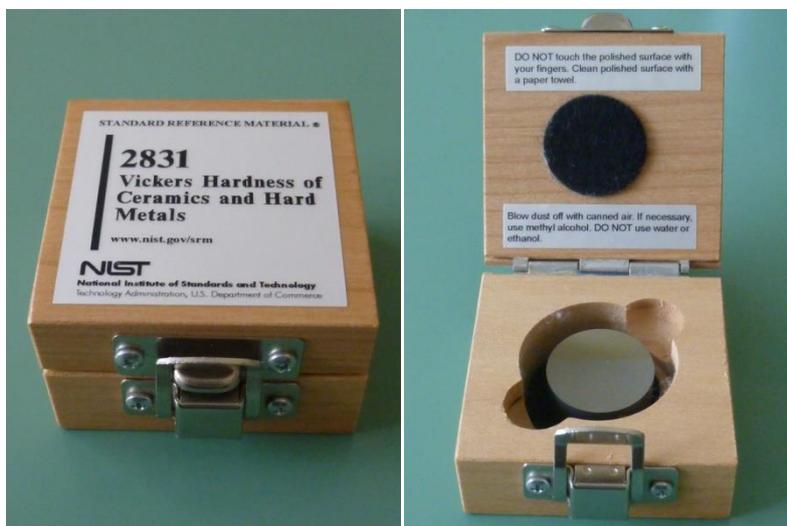
Slika 3.3. - Referentna pločica tvrdoće po Vickersu SRM 2831
