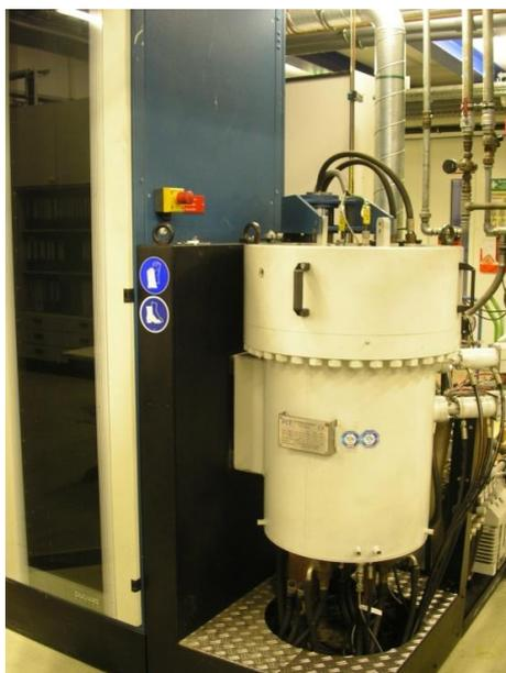
Slika 5.16. - Peć za sinter HIP oznake DS2 Ofen
