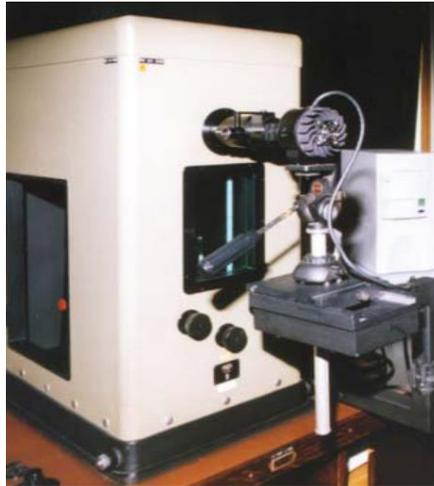
**Slika 5.54.** - Interferencijski mikroskop za provjeru ravnoće površine [5]
