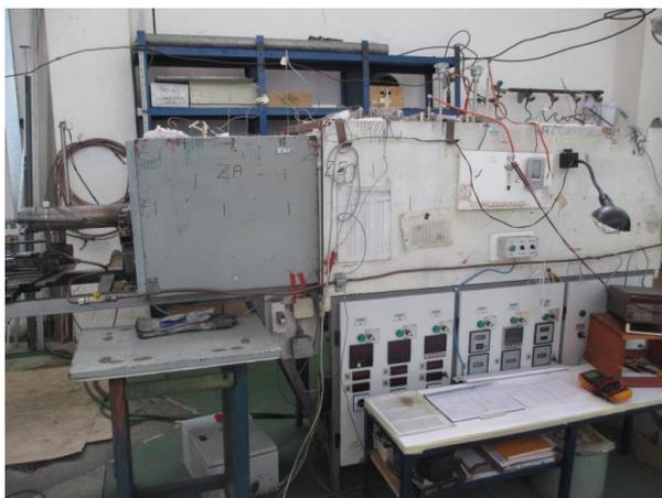
**Slika 5.11. - Peć za sinteriranje u atmosferi vodika**
