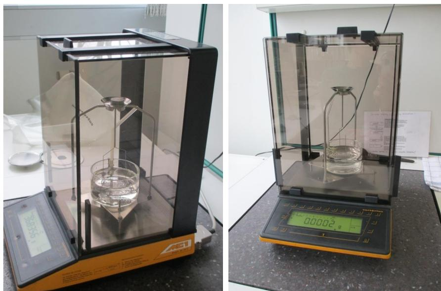
**Slika 5.20. - Uređaj za mjerenje gustoće proizvođača Sartorius
