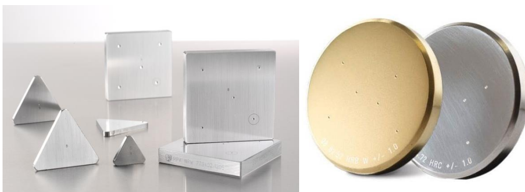
Slika 3.1. - Referentne pločice tvrdoće raznih oblika i materijala [22]
