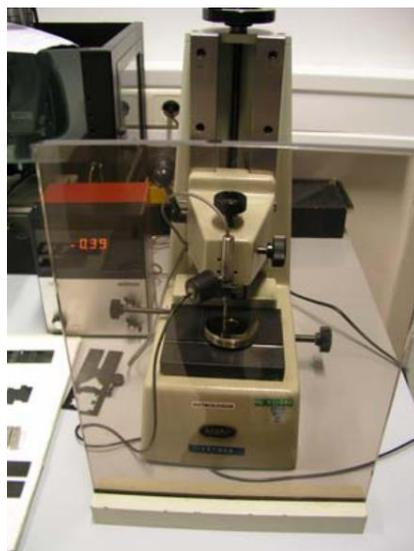
**Slika 5.53. - Uređaj za mjerenje planparalelnosti površine [5]**
