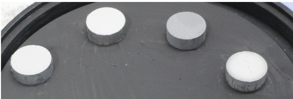
Slika 5.17. - Uzorci nakon izlaska iz sinter HIP- peći
