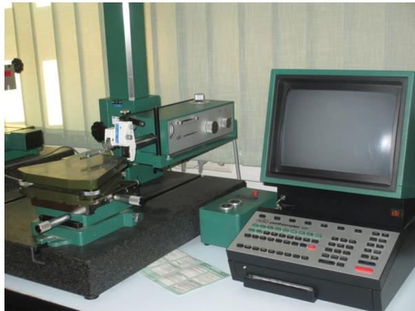
Slika 5.52. - Uređaj za ispitivanje hrapavosti površina [5]
