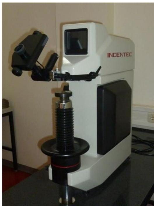
**Slika 5.40. - Referentni etalon tvrdoće proizvođača Indentec**
