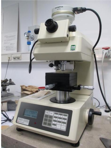
**Slika 5.49. - Primarni etalon mikrotvrdoće u PTB-u**
