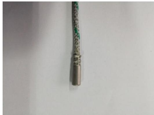
**Slika 65. Termometar tip K**
