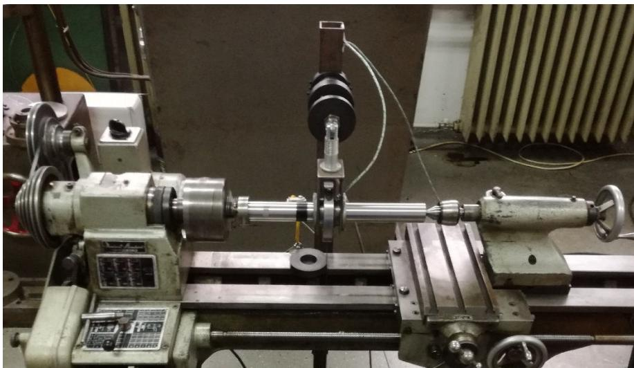
Slika 56. Uredaj za ispitivanje kliznih ležaja
