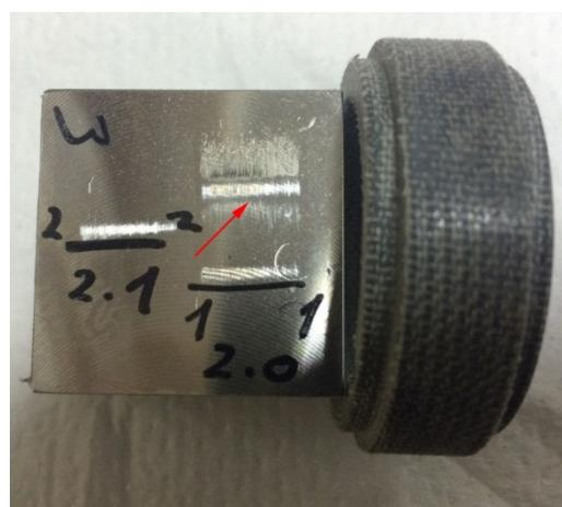
Slika 48. Ravnomjeran dodir ispitnog uzorka i pritisne pločice
