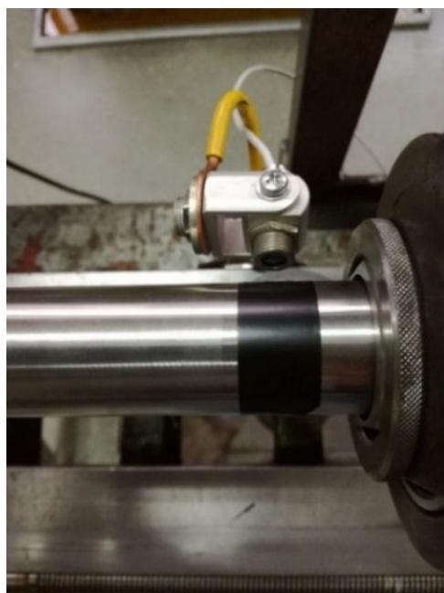
**Slika 66. Beskontaktno mjerilo temperature**
