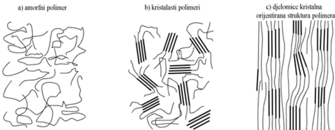
Slika 23. Strukture plastomera [25]
