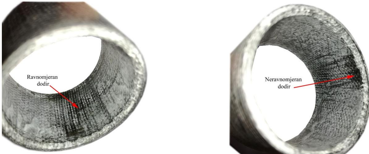
Slika 75. Ravnojeran i neravnomjeran dodir između kliznog ležaja s dodatkom maziva i rukavca
