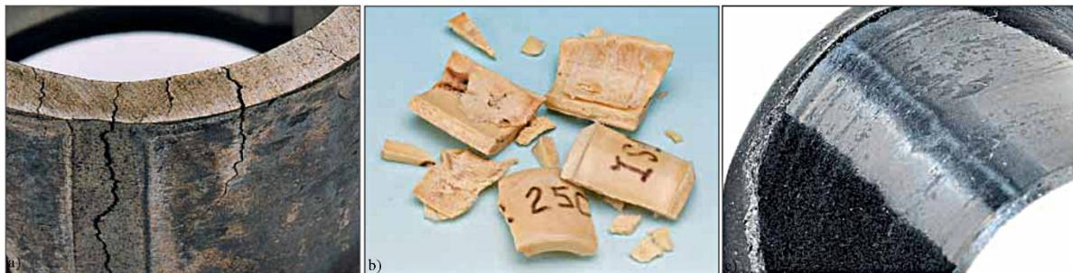
Slika 31. a) Oštećenje sinterirane bronce, b) oštećenje polimera sa staklenim vlaknima,
