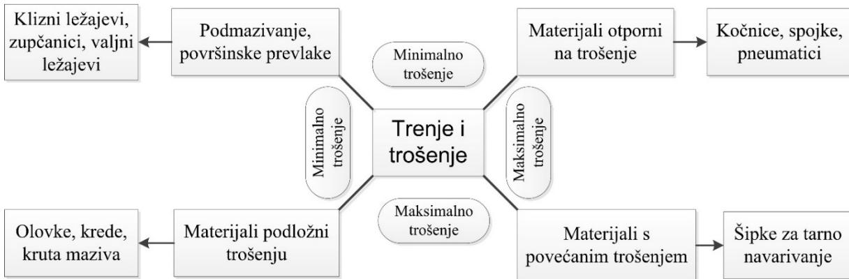
Slika 4. Trenje i trošenje
