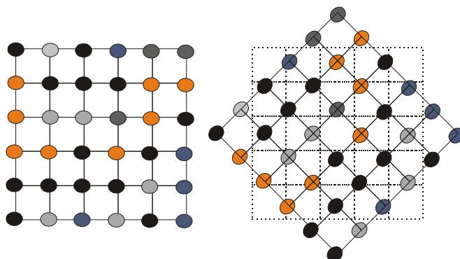
Slika 53. Rotacija elemenata slike za  $\alpha = -45^\circ$
