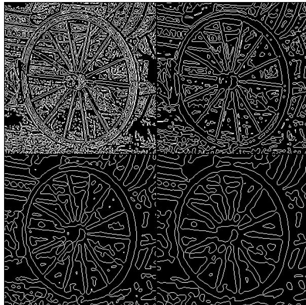
Slika 15. LoG vrijednost  $\sigma=1, \sigma=2, \sigma=3, \sigma=4$
