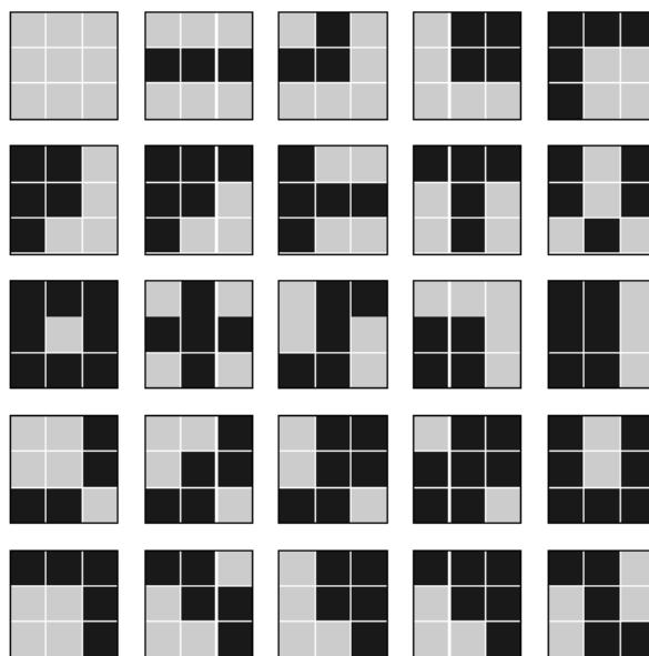
Slika 33. MCT za 25 od 511 mogućih kombinacija uzoraka za blok  $3 \times 3$  piksela (Froba i Ernst, 2004.)
