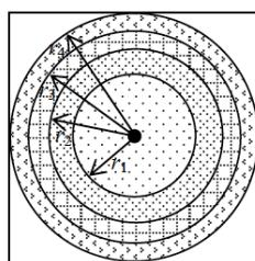
Slika 6. Prstenaste pregrade oko centralnog piksela slike (Tang et al., 2012.)
