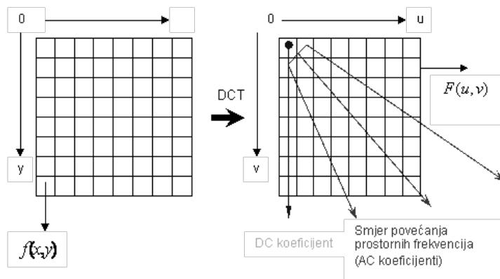
Slika 8. Ulazni i izlazni parametri DCT transformacije (Jančić, 2002.)
