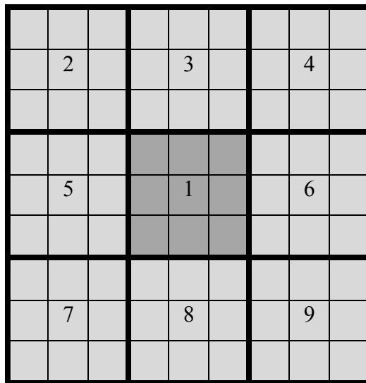
Slika 39. Regija od devet blokova ( $3 \times 3$  piksela) za svaku biometrijsku točku
