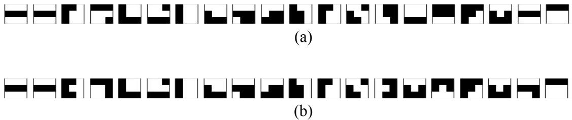
Slika 49. Usporedba MCT uzoraka (a) originalne slike biometrijske karakteristike lica i (b) slike na kojoj je izvršen napad Gaussovim šumom ( $\sigma = 20$ )
