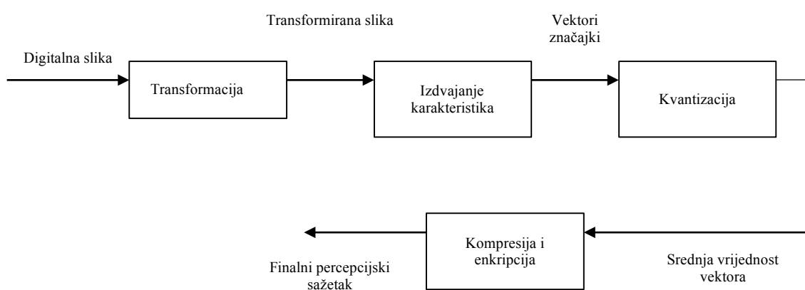
Slika 4. Dodatne faze izrade percepcijskog sažetka (prilagođeno prema Hadmi et al., 2012.)
