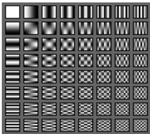
Slika 7. Osnovni valni oblici DCT transformacije (Jančić, 2002.)
