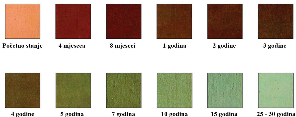
Slika 2.1. Prikaz nastanka i promjene boje patine na bakru kroz period od 30 godina. 5
