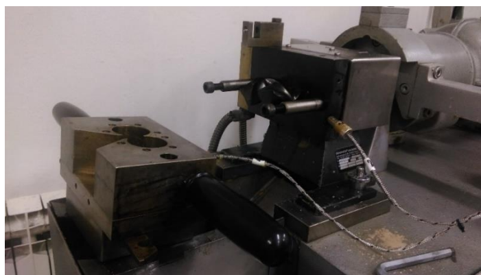
Slika 21. Gnjetilica proizvođača Brabender
