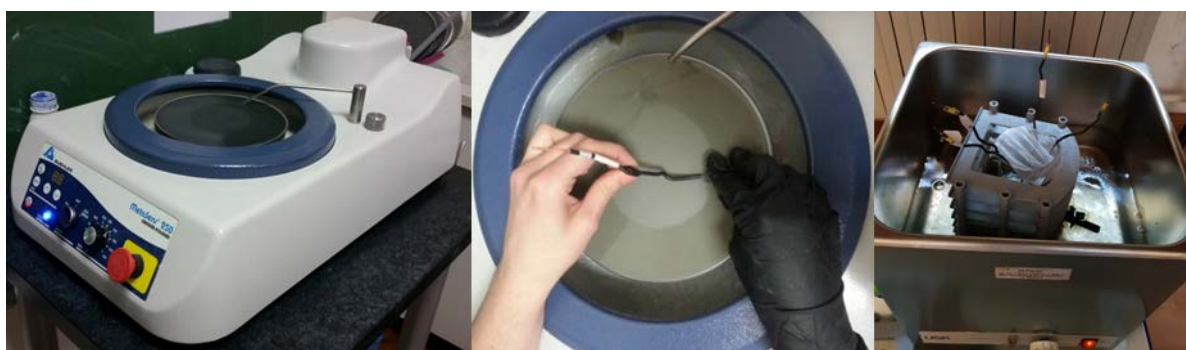
Slika 3.3. Mehaničko strojno poliranje uzoraka i odmašćivanje u ultrazvučnoj kupelji. 69
